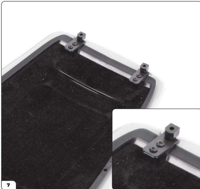
Encaje las bisagras en el bastidor auxiliar, como se muestra en la imagen, comprobando que la parte redondeada de las articulaciones estén orientadas en sentido opuesto al capó. Asegure las bisagras usando 4 tornillos DS20.
