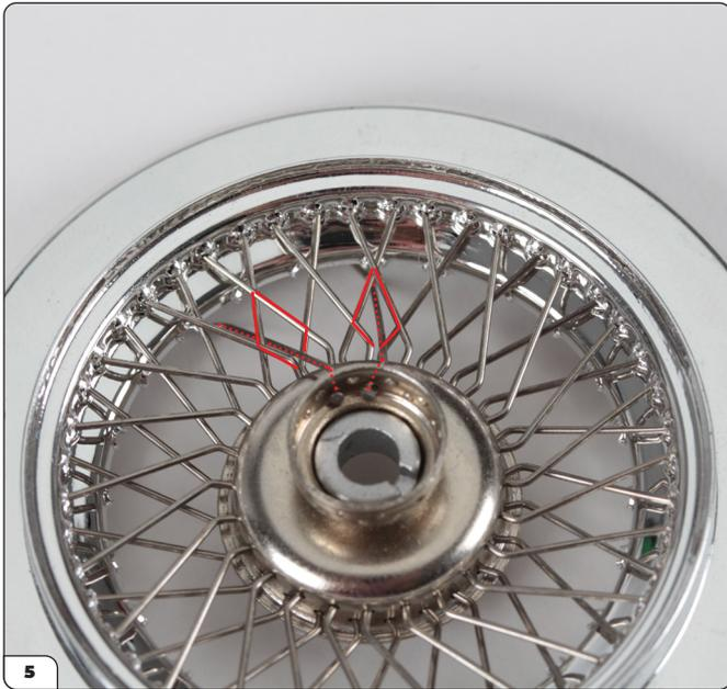
Una vez esté satisfecho con el ajuste del primer radio, introduzca otro radio tipo A en el siguiente orificio de la fila superior y a través de la segunda forma de rombo a partir de la primera, es decir, dejando un rombo sin usar, como se indica en la imagen. En esta fase, puede dejar sueltas las puntas en el lado opuesto.
