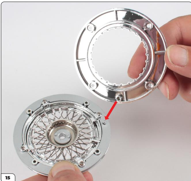
Alinee la llanta interna (3-A) con el montaje, usando el orificio y el pasador como guía.
