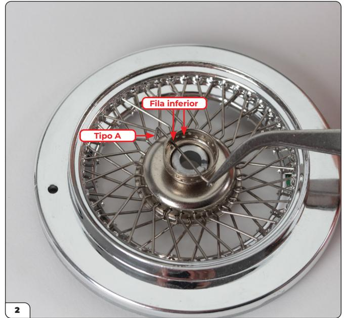
Dé la vuelta al montaje e introduzca la punta de uno de los radios tipo A (3-C) a través de uno de los orificios de la fila inferior del extremo más delgado del centro de rueda.
