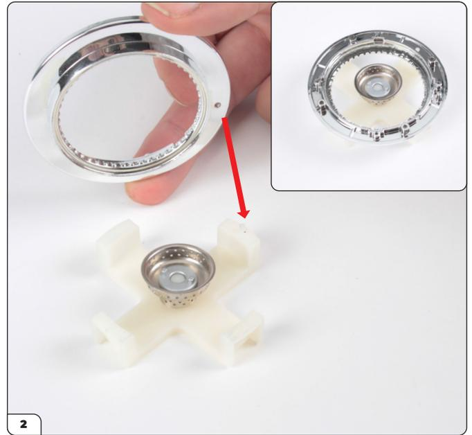
Encaje la llanta externa (2-C) en la plantilla, usando el pasador como guía. Presione firmemente para fijar la llanta en su lugar.
