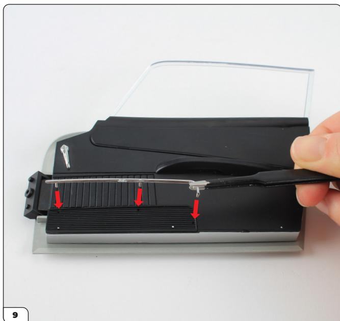
Una vez posicionado, presione firmemente el listón inferior. Luego, alinee el listón en forma de L (7-B) con los 3 orificios en el listón inferior.
