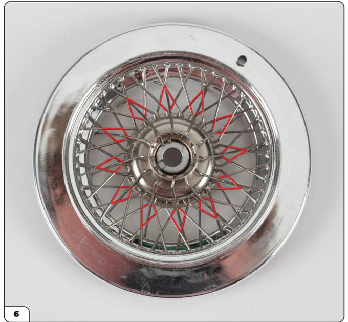
Continúe ensartando los radios tipo A en la fila inferior, introduciendo la otra punta a través de los rombos en forma alternada (uno sí y uno no), como se indica en la imagen. Por ahora, siga dejando las otras puntas sueltas, todavía no es necesario encajarlas en los dientes anchos.
