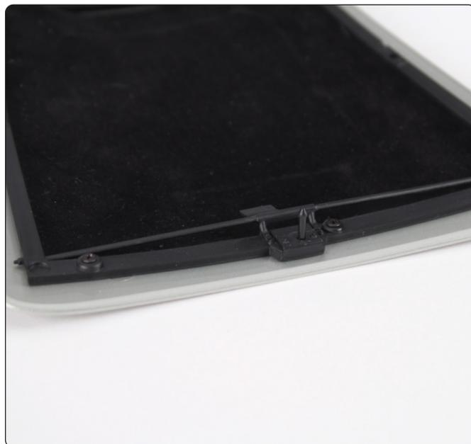
Encaje el cierre del capó en el orificio del bastidor auxiliar.
