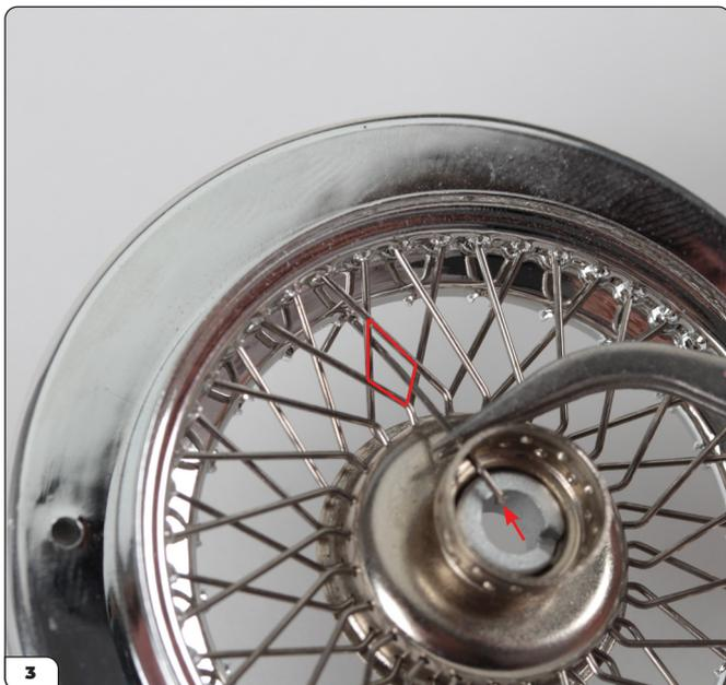
Tire del radio y guíe la punta a través de la forma de rombo (resaltada en la imagen) que se encuentra inmediatamente a la izquierda del orificio, hasta llegar al lado opuesto.
