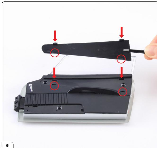
Alinee el listón superior (7-D) con la ranura en el panel de la puerta, tal y como se muestra en la imagen. Primero encaje las dos pestañas del listón en las aberturas inferiores (rodeadas con círculos), luego presione firmemente las otras pestañas para introducirlas en las aberturas superiores (flechas).
