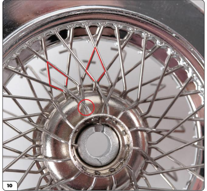
Vuelva a dar la vuelta al montaje e introduzca otro radio tipo B en el siguiente orificio de la fila superior, páselo por encima del radio tipo A a su izquierda y a través del siguiente rombo vacío a la izquierda.
