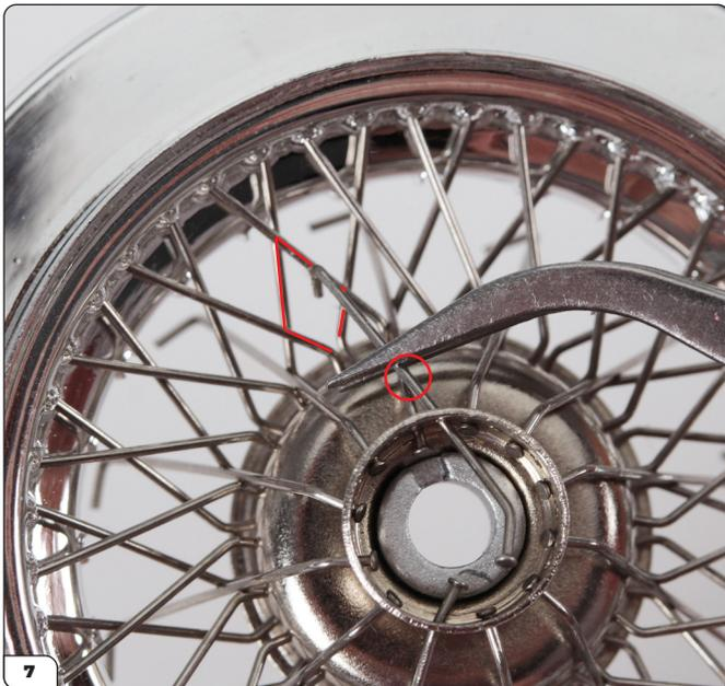
Ahora coge un radio tipo B (3-D) y pásalo por un agujero de la fila superior. Crúzalo sobre el radio de la fila inferior a su izquierda (marcado con un círculo) y guía la punta hasta el diamante vacío sin radio que lo atraviesa (resaltado).
