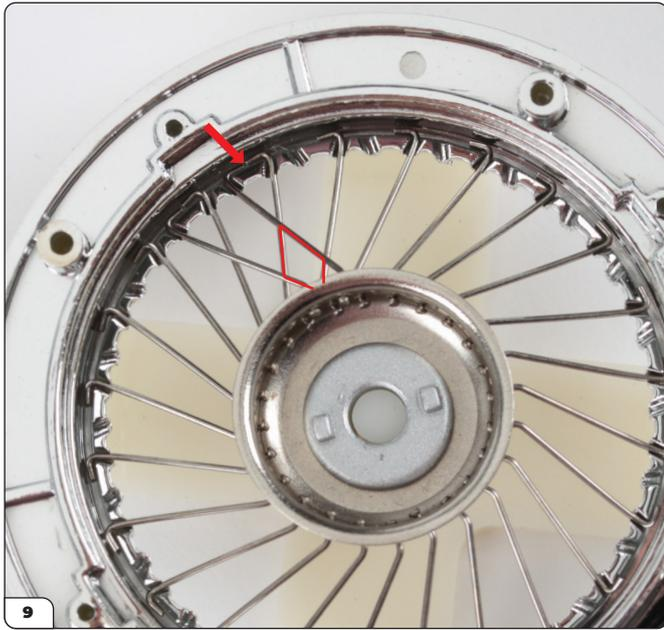
Introduzca otro radio en el siguiente orificio de la fila superior del centro de rueda y enganche la otra punta alrededor del siguiente diente ancho de la llanta externa (flecha). Observe como los radios forman un rombo, resaltado en la imagen.
