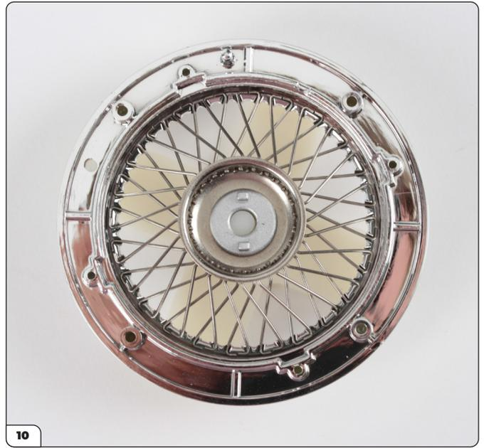
Continúe con la secuencia hasta haber encajado todos los radios. Luego, compruebe cada uno de los dientes anchos para asegurarse de que los radios estén en la posición correcta.
