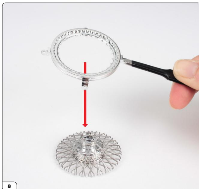
8 Posicione el anillo retenedor de los radios (2VB-H) sobre el montaje, en la orientación que se muestra en la imagen.
