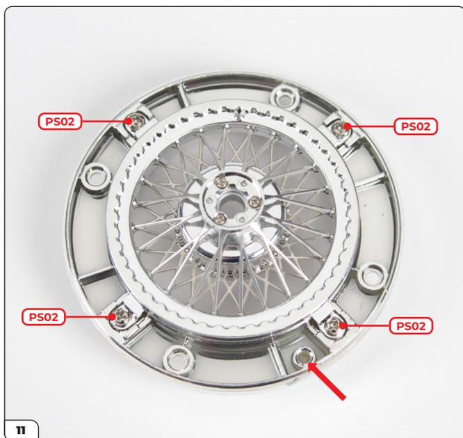
Fissa con quattro viti PS02. Il foro indicato dalla freccia servirà per inserire il perno nel passaggio successivo.
