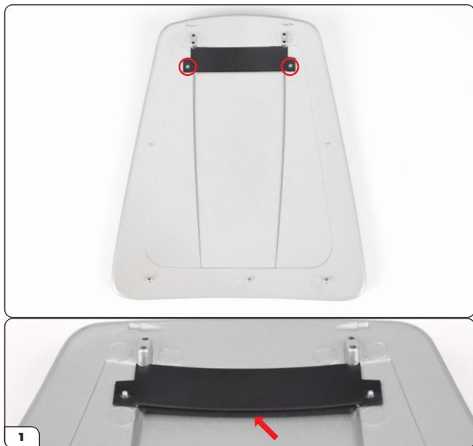
Prima di iniziare a lavorare sul cofano, assicurati di avere un panno morbido per evitare di graffiare la vernice. Prendi il cofano (1-A) e la piastra della presa d'aria (1-C). Con il lato inferiore del cofano rivolto verso di te, posiziona la piastra della presa d'aria come illustrato, infilando i fori della piastra nei perni (1a, cerchiati). Assicurati di inserire bene la piastra nell'incavo del cofano.
