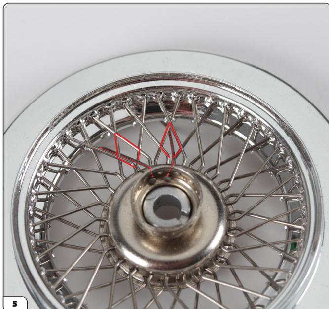
Una volta montato correttamente il primo raggio, infilane un altro di tipo A nel foro inferiore successivo e fallo passare attraverso non il diamante successivo ma quello dopo ancora, come evidenziato nell'immagine. Per ora le punte al lato opposto possono essere lasciate libere.
