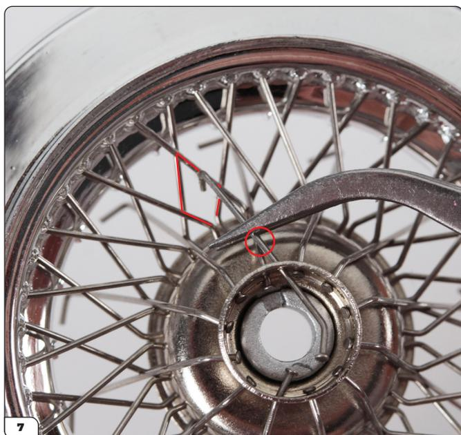
Ora prendi un raggio di tipo B (3-D) e infilalo in un foro della fila superiore. Incrocialo sul raggio della fila inferiore alla sua sinistra (cerchiato) e guida la punta verso il primo diamante vuoto senza raggio (evidenziato).
