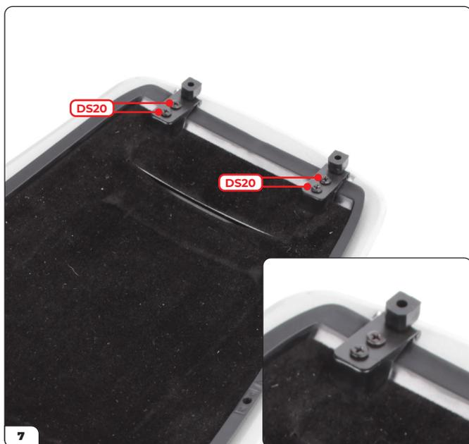
Monta le cerniere sul telaio come illustrato, controllando che la faccia arrotondata del giunto sia rivolta verso il cofano. Fissa la cerniera con quattro viti DS20.
