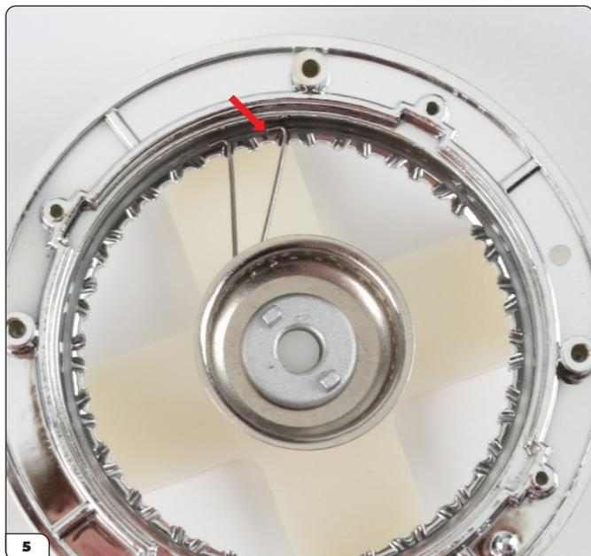
Infila un altro raggio attraverso il foro successivo della fila inferiore e aggancia la punta a un altro dentino largo (freccia). Mentre inserisci i raggi, è possibile regolare delicatamente la tensione ruotando il centro della ruota con il pollice.
