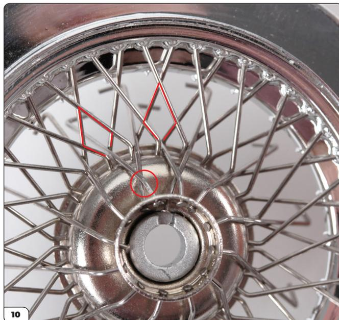
Torna indietro e infila un altro raggio di tipo B nel foro successivo della fila superiore, facendolo passare sopra il raggio di tipo A alla sua sinistra e attraverso il primo diamante vuoto, sempre alla sua sinistra.
