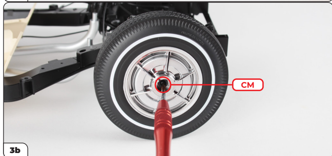
Ziehen Sie den Dreifach-Spinner vom originalen rechten Vorderrad (3a) ab, lösen Sie dann die CM-Schraube und ziehen Sie die Unterlegscheibe ab, die das Vorderrad an seinem Platz halten (3b). Verwalten Sie die entfernten Teile an einem sicheren Ort.
