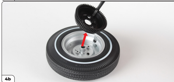
Ziehen Sie das Rad von der Nabe ab und lösen Sie dann die RM-Schrauben (4a). Verwalten Sie die Schrauben an einem sicheren Ort. Ziehen Sie dann die Bremstrommel ab (4b).
