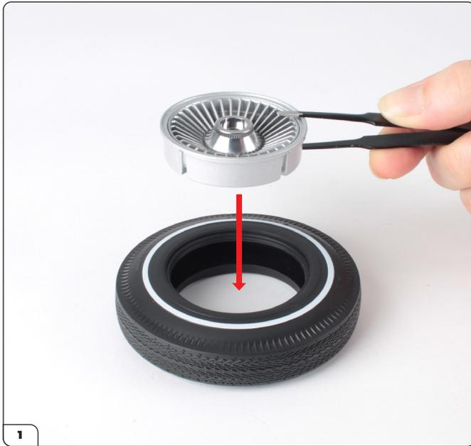
Pour assembler la version 1964 de la roue de secours, insérez la jante Kelsey Hayes dans l'un des pneus (cf. flèche).
