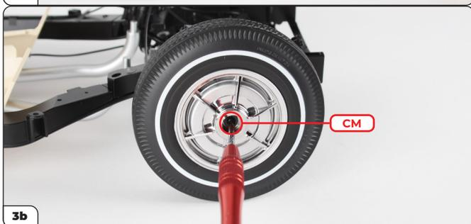
Retirez le tourniquet trois barres de la roue avant droite d'origine (3a), puis dévissez la vis CM et la rondelle qui la maintiennent en place (3b). Mettez les pièces retirées de côté.
