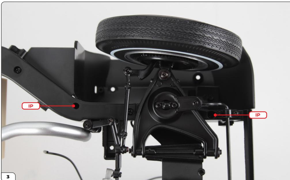
Retournez l'ensemble et enfoncez 2 vis IP dans les pas de vis indiqués pour fixer l'aile.
