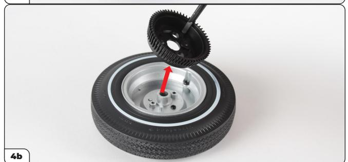
Retirez la roue du moyeu, puis dévissez les vis RM (4a). Mettez les vis de côté, puis retirez le tambour de frein (4b).
