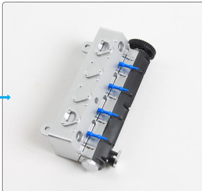
Alignez le cache-arbre à cames droit (avec le bouchon d'huile) et la culasse du moteur comme indiqué, puis mettez le cache-arbre en place. La position de l'ergot noir signifie que les pièces ne peuvent s'emboîter que d'une seule manière.
