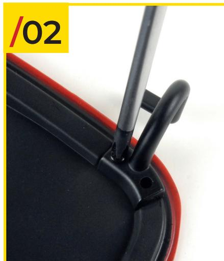
01/02 Coloca la primera bisagra y asegúrala en el interior del capó delantero con dos tornillos tipo A.
