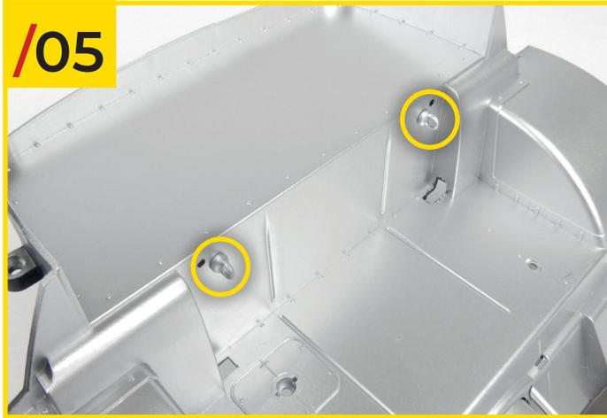
05/05 Inserta dos de los ganchos del cinturón en los agujeros que se muestran en la foto, en la mitad trasera del suelo. Las piezas solo pueden encajar en una posición.
