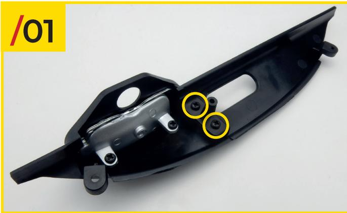
03/01 Recupera el panel de instrumentos que ensamblaste en la etapa 02 y únelo al salpicadero recibido en esta etapa. Fija las piezas con dos tornillos tipo B.
