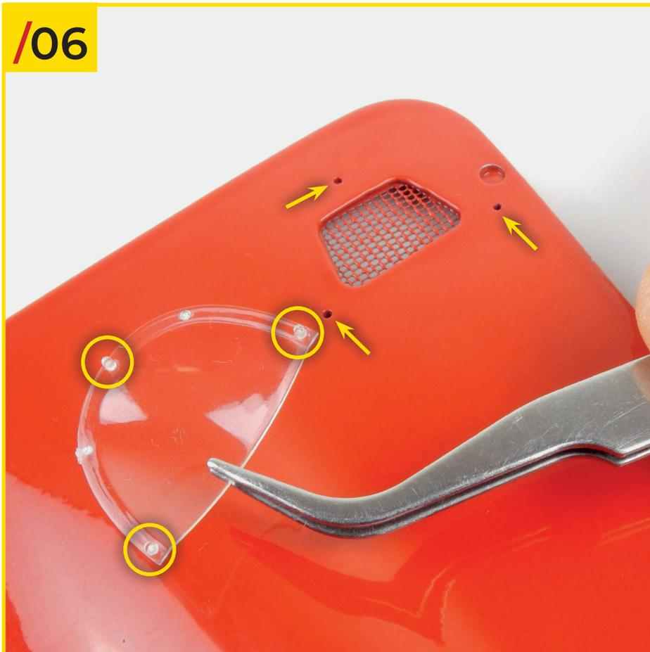
01/06 Utilizando unas pinzas, instala la cubierta de la toma de aire de la izquierda en el capó. Notarás que estas piezas no son simétricas: usa la foto para emparejar los pines en la parte inferior de la cubierta izquierda con los agujeros correspondientes. Presiona ligeramente para unir las dos piezas.
