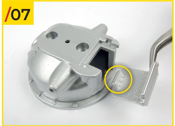
04/07 Dale la vuelta a la campana del embrague e inserta la lengüeta del panel de la campana del embrague (resaltado por el círculo en la foto) en la abertura de la campana del embrague y la muesca en la placa de sellado.
