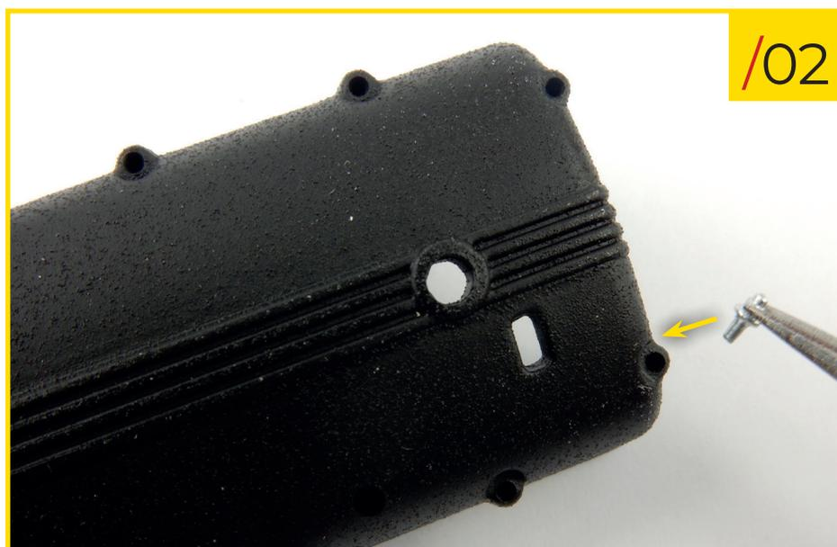
15/02 Placez le boulon dans l'un des trous sur le bord externe du couvercle d'arbre à cames gauche. Si vous le souhaitez, vous pouvez mettre une goutte de colle à l'intérieur du trou avant d'insérer le boulon.
