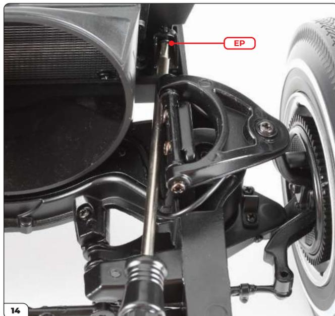
Befestigen Sie die rechte Seite, indem Sie mit einem langen Schraubendreher eine EP-Schraube durch die Halterung hineindrehen.
