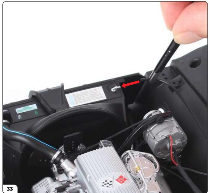
Stecken Sie das lose Ende des Kabels für den Kühlflüssigkeitsbehälter auf den Verbinder für das Wasserrohr an der Gebläseabdeckung (siehe Pfeil).
