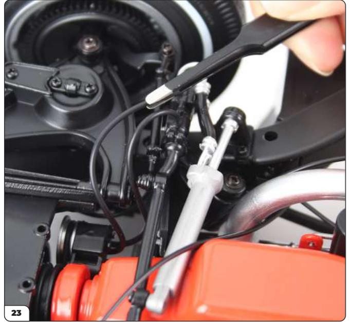
Suchen Sie das lose Ende des 62 mm langen Kabels, das in Bauphase 47 an der Kappe für die Lenkungspumpe angebracht wurde.
