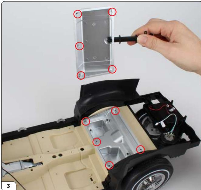
Legen Sie den Tankdeckel auf den Tank. Richten Sie dabei die Schraublöcher auf die entsprechenden Schraubzapfen aus.
