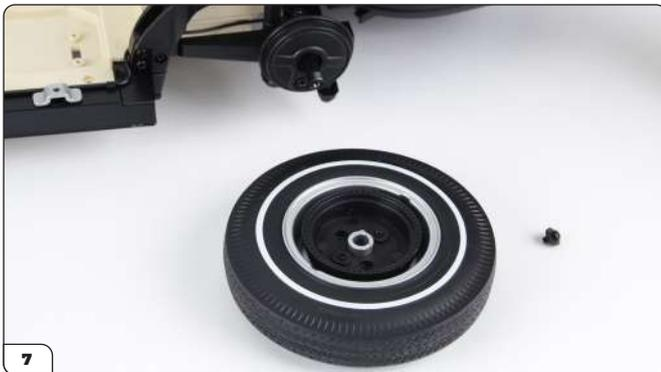
Ziehen Sie das Rad ab und verwahren Sie dann die Schraube, die Unterlegscheibe und den Dreifach-Spinner an einem sicheren Ort. Legen Sie das Rad wie gezeigt auf Ihren Arbeitstisch.
