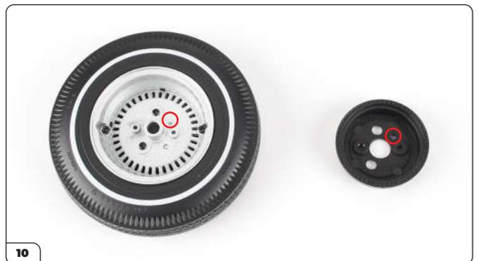
Richten Sie die Bremstrommel auf das neu zusammengebaute Rad aus. Der Montagestift und das Loch dienen dabei zur Orientierung.
