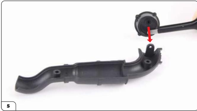
Legen Sie den Diffuserkegel wie gezeigt auf das Ende des unteren Ansaugkrümmerrohrs.
