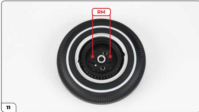
Legen Sie die Bremstrommel auf die Felge und befestigen Sie sie mit 2 RM-Schrauben.
