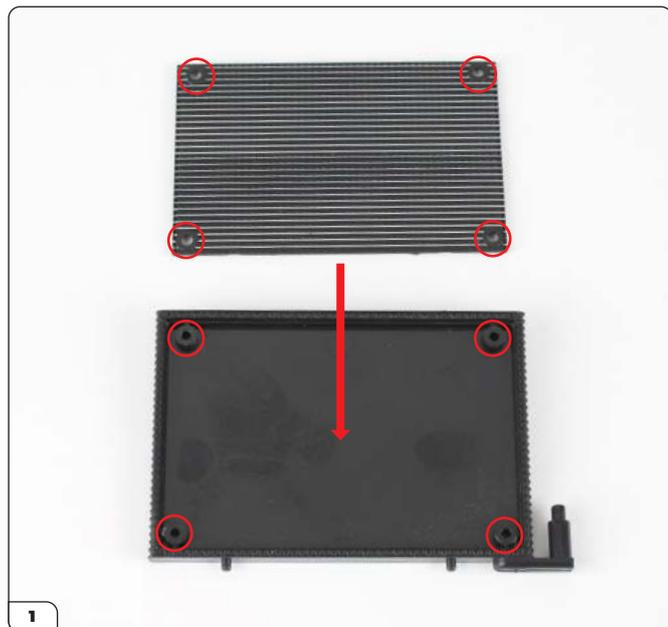
Stecken Sie die Rückseite und die Vorderseite des Kühlers mit Hilfe der Schraubzapfen und den Schraublöchern (eingekreist) zusammen.
