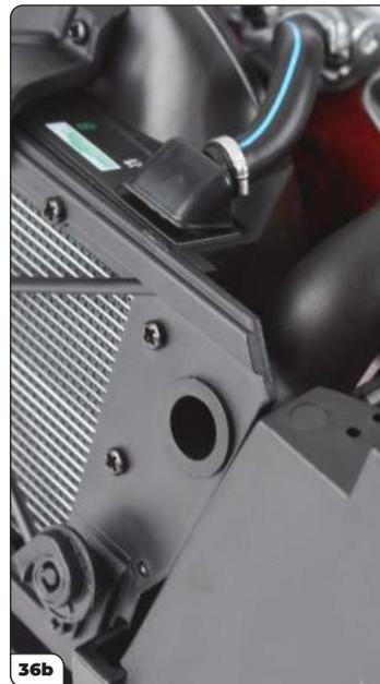
Justieren Sie das Ansaugkrümmerrohr so, dass das offene Ende auf das Loch im Verstärkungsrahmen ausgerichtet ist. Stecken Sie dann die Befestigung für den Ansaugkrümmer in das Loch, um den Ansaugkrümmer an seinem Platz zu halten (36a). Stecken Sie die Befestigung fest hinein, bis sie bündig anliegt (36b).
