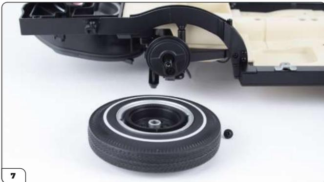
Ziehen Sie das Rad ab und verwahren Sie dann die Schraube, die Unterlegscheibe und den Dreifach-Spinner an einem sicheren Ort. Legen Sie das Rad wie gezeigt auf Ihren Arbeitstisch.
