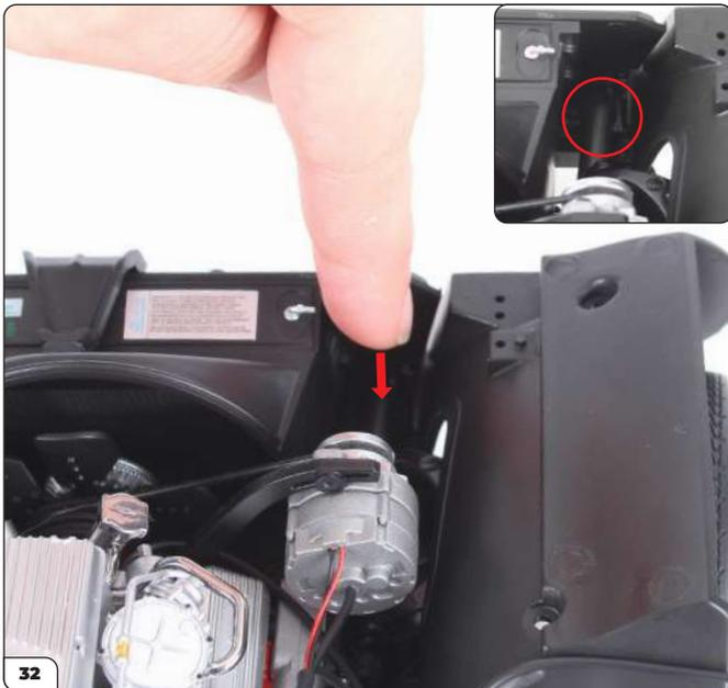
Stecken Sie das Wasserzulaufrohr auf den Zapfen auf dem Verstärkungsrahmen (siehe Pfeil), bis das Rohr fest aufgesteckt ist (siehe kleines Bild, eingekreist).
