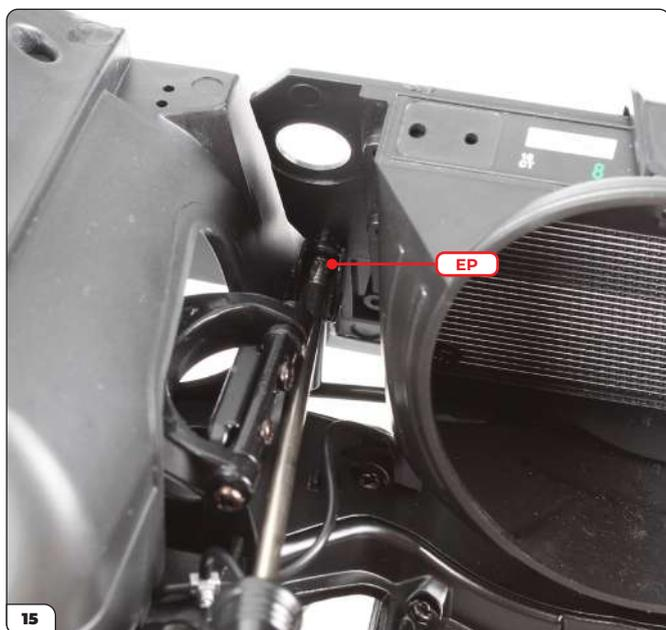
Befestigen Sie die linke Seite auf die gleiche Weise mit einer weiteren EP-Schraube.
