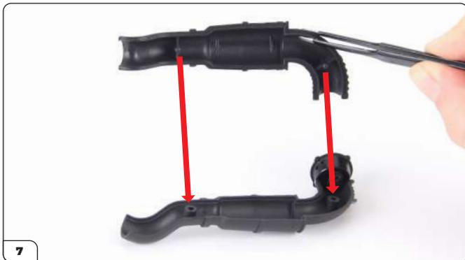
Stecken Sie die Stifte am oberen Ansaugkrümmerrohr in die Löcher am unteren Rohr, um die beiden Teile zusammenzusetzen.
