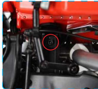
Drehen Sie 2 CM-Schrauben die die Motor-Halterungen hinein, um den Motor an seinem Platz zu halten. Die kleinen Bilder zeigen eine Nahaufnahme der Schrauben (eingekreist).
