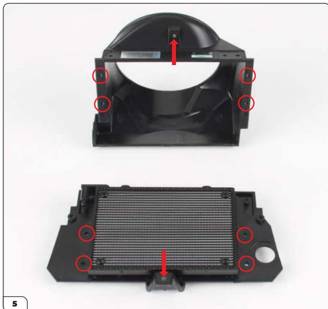
Halten Sie die Gebläseabdeckung und den Rahmen wie gezeigt und befestigen Sie dann die Verbindungspunkte: vier Löcher an den Kanten (eingekreist) und ein Schraubloch, das für die Halterung passt (siehe Pfeil).
