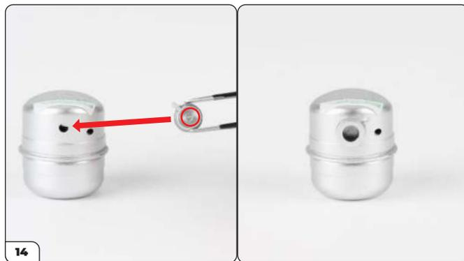
Stecken Sie den Klemmverbinder, der einen geformten Stift (eingekreist) hat, in das geformte Loch des Behälters (siehe Pfeil).
