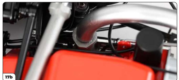
Wiederholen Sie diese Schritte für den Auspuffkrümmer auf der anderen Seite, ziehen Sie die Schutzfolie vom Sticker ab (17a) und stecken Sie dann das Rohr fest hinein (17b).
