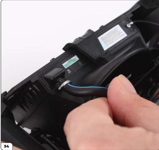
Stecken Sie das Ende des Kühlwasserschlauchs in seinen Verbinder. Wenn der Schlauch lose am Motor sitzt, kleben Sie ihn mit einem Tropfen Klebstoff an.
