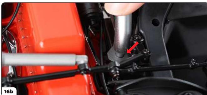
Ziehen Sie das Auspuffrohr heraus und ziehen Sie dann mit einer Pinzette die Schutzfolie vom Sticker am Auspuffkrümmer ab (16a). Stecken Sie den Stift des Rohrs fest in das Loch des Auspuffkrümmers (16b).
