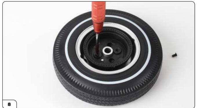
Lösen Sie die beiden RM-Schrauben, die die Bremstrommel an ihrem Platz halten (siehe Abbildung).
