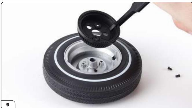
Ziehen Sie die Bremstrommel ab und verwahren Sie dann die Schrauben an einem sicheren Ort.
