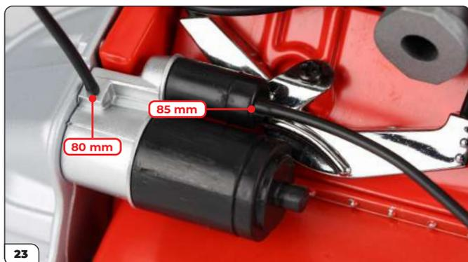
Dieses Bild zeigt, wie die Baugruppe mit den beiden angebrachten Kabeln (80 mm und 85 mm) aussehen sollte.
