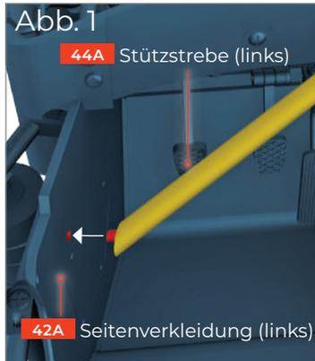
Beide Stützstreben sollen unter dem mittleren Hebelarm für die Haubentriegelung (30D) aus der Stirnwand hervortreten.
