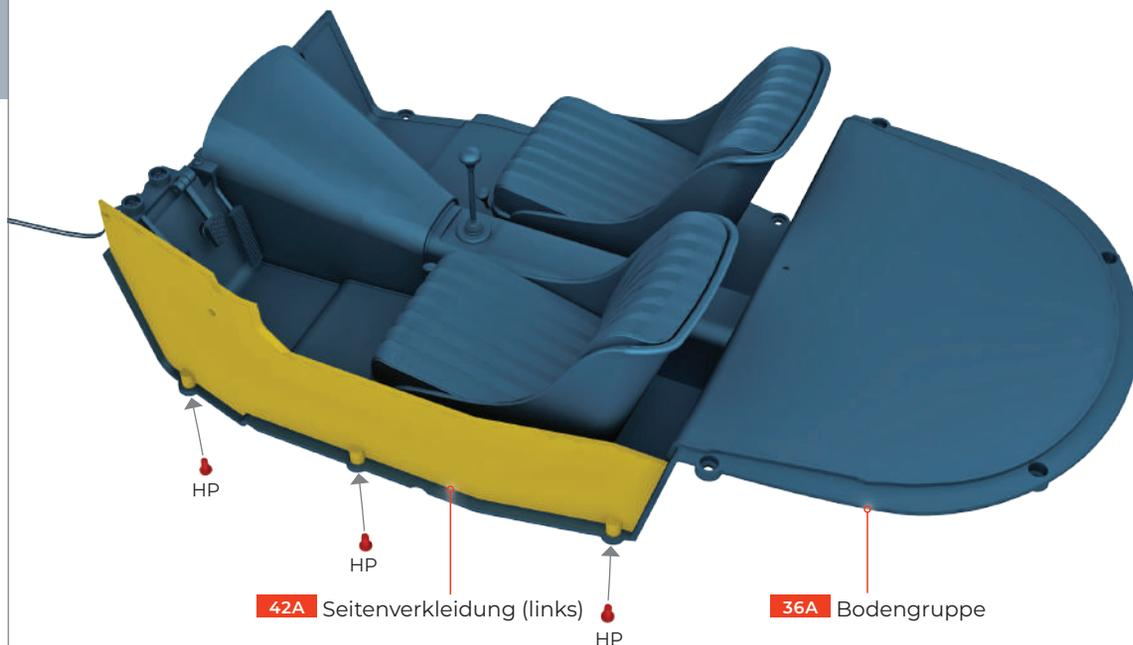
Stützen Sie die Bodengruppe beim Verschrauben der Seitenverkleidungen auf keinen Fall auf dem Schalthebel ab.
