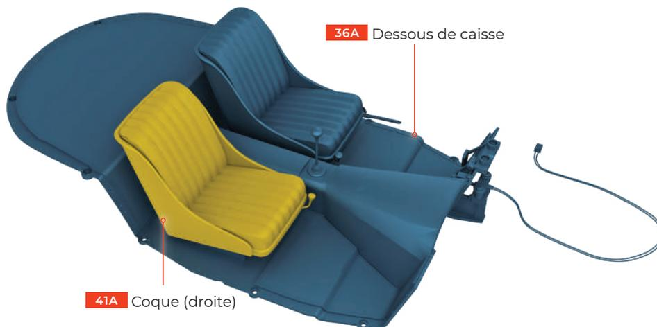
■ Positionnez la coque droite **41A** dans la partie droite du dessous de caisse **36A**, en plaçant les cinq socles qui se trouvent sous le siège dans les trois glissières de la partie saillante du plancher. Retournez le module et positionnez la rondelle **41D** sur l'alésage de la glissière centrale. Insérez une vis **NP** dans l'alésage, à travers la rondelle, puis serrez-la jusqu'en butée avant de la desserrer d'un demi-tour (fig. 1).
