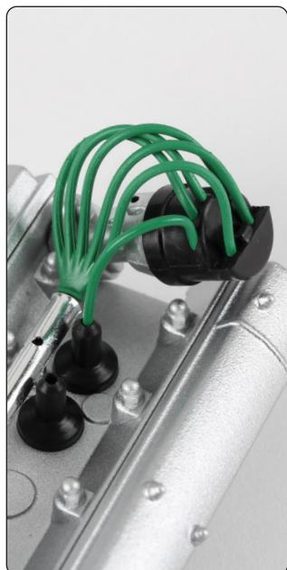
Löse das längere Elektrokabel (9-D) von den fünf kürzeren Kabeln und biege es in eine U-Form.
