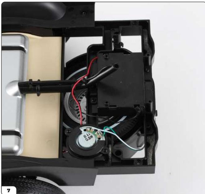
Bevor Sie die Platine einbauen, vergewissern Sie sich, dass das schwarze und das rote Kabel wie gezeigt neben dem Batteriefach liegen.
