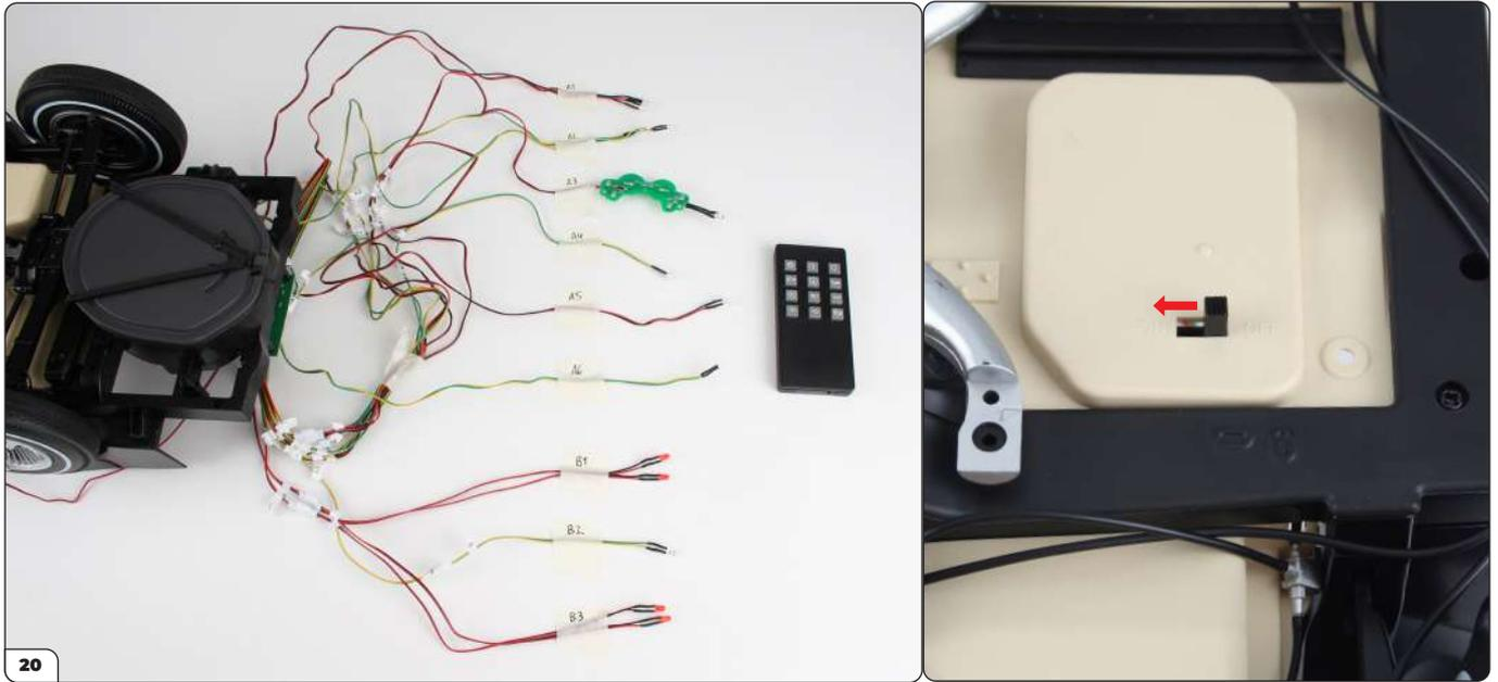
Um die Elektrik zu testen, kennzeichnen Sie die LEDs deutlich mit ihrer Beschriftung auf einem Stück Abdeckband, damit Sie die LEDs leicht identifizieren können. Sie können so auch das Licht in Ihrem Zimmer abdunkeln! Denken Sie daran, dem Ein/Aus-Schalter von „OFF“ auf „ON“ zu schieben.
