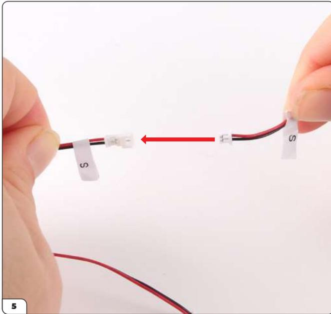
Stecken Sie das Kabel am Ein/Aus-Schalter und das Verlängerungskabel (beide sind mit „S“ beschriftet) wie gezeigt zusammen.
