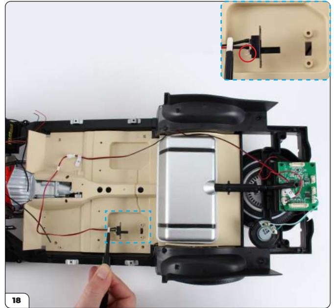
Führen Sie das Kabel für den Ein/Aus-Schalter um den Kraftstofftank herum und richten Sie dann den Schalter wie gezeigt auf die Aussparung im Cockpit-Boden aus. Vergewissern Sie sich, dass der Schalter richtig herum ausgerichtet ist (siehe kleines Bild).
