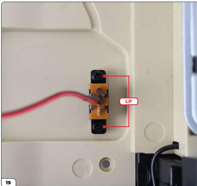
Bringen Sie den Schalter an und befestigen Sie ihn mit 2 LP-Schrauben.
