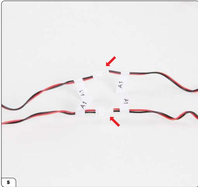
Stecken Sie die beiden LED-Kabel in die Buchsen der Verlängerungskabel (alle mit „A1“ beschriftet).
