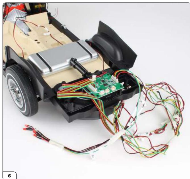
Bündeln Sie genau wie beim vorherigen Kabelsatz auch diese Kabel mit Abdeckband, wenn Sie das Modell beiseite legen.
