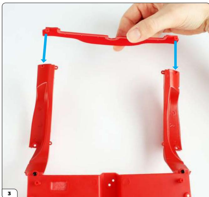
Drehen Sie den Innenboden um und legen Sie ihn auf den Arbeitstisch. Legen Sie dann das hintere Paneel an den Schraubzapfen an.
