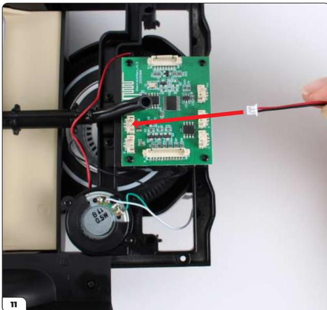
Stecken Sie das Verlängerungskabel für den Ein/Aus-Schalter in die Buchse „S“.
