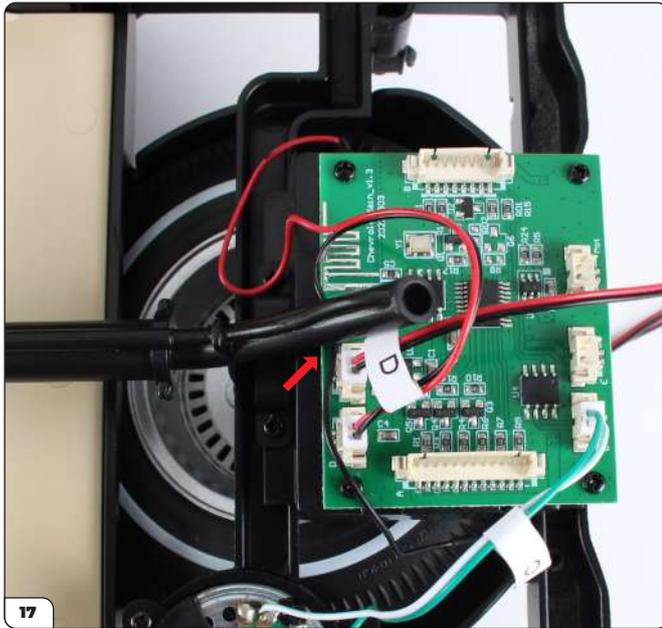
Schieben Sie das „D“-Kabel wie gezeigt unter den Kraftstoffschlauch.
