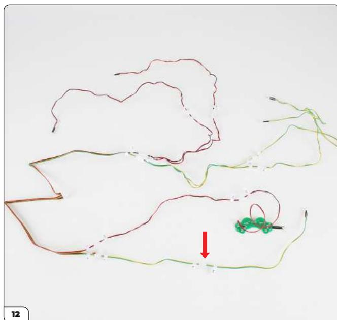
Stecken Sie das LED-Kabel „A4“ in seine Verlängerung.
