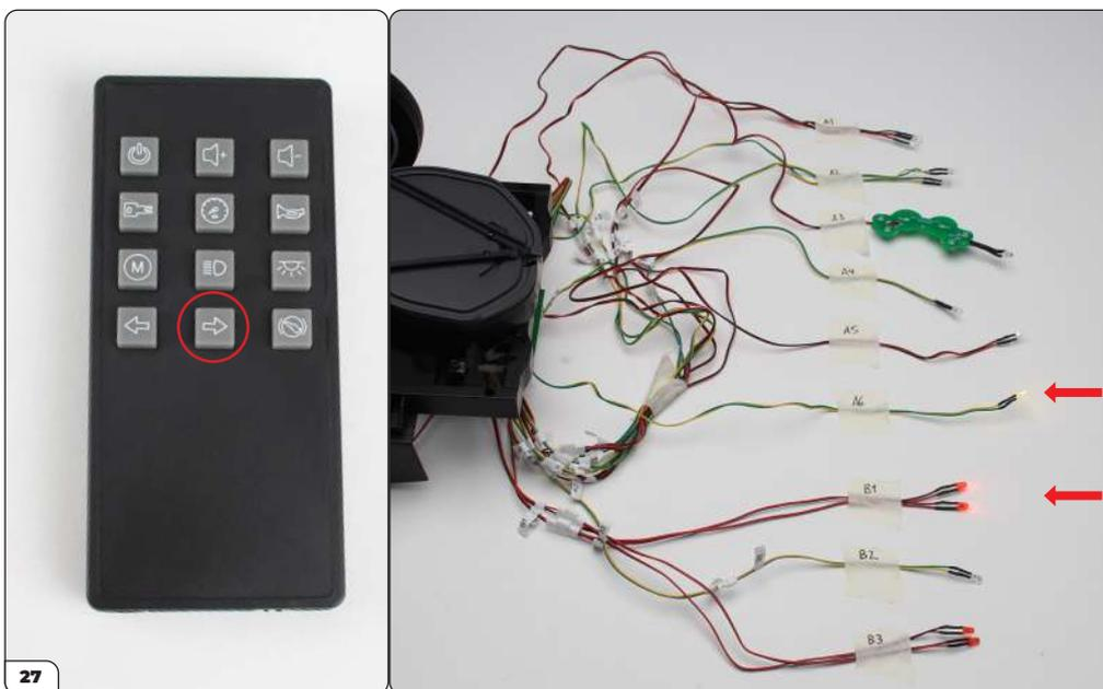
Drücken Sie jetzt auf die Taste für den rechten Blinker. Die LEDs A6 und B1 müssten blinken. Drücken Sie erneut auf die Taste. Die LEDs müssten erlöschen.
