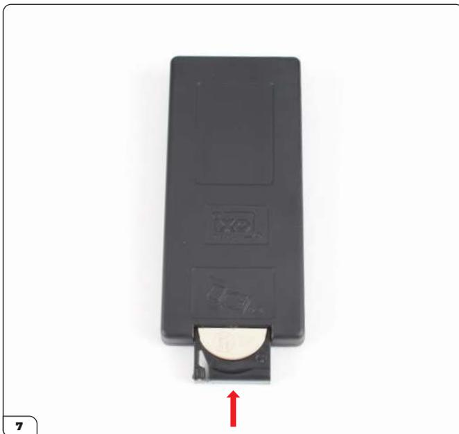
Schieben Sie den Batterieträger in die Fernbedienung.
