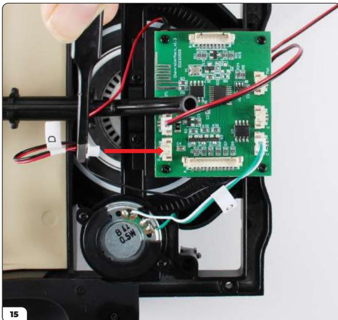
Stecken Sie das schwarze und rote Batteriekabel in die Buchse „D“.
