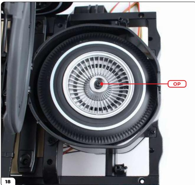
18 Bringen Sie die in Schritt 11 entfernte Unterlegscheibe wieder an und befestigen Sie das Rad dann mit einer mit dieser Bauphase gelieferten OP-Schraube.
