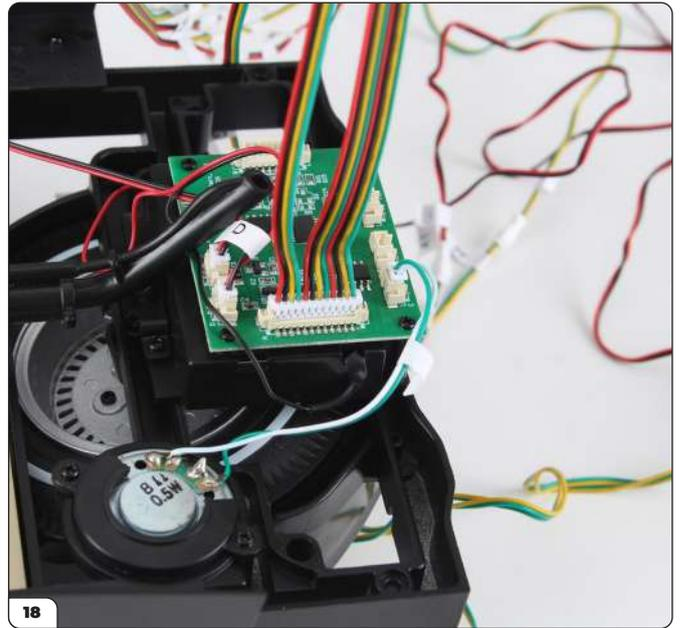
Stecken Sie den Stecker am Splitter-Kabel in die Buchse auf der Platine, die mit „A“ beschriftet ist.
