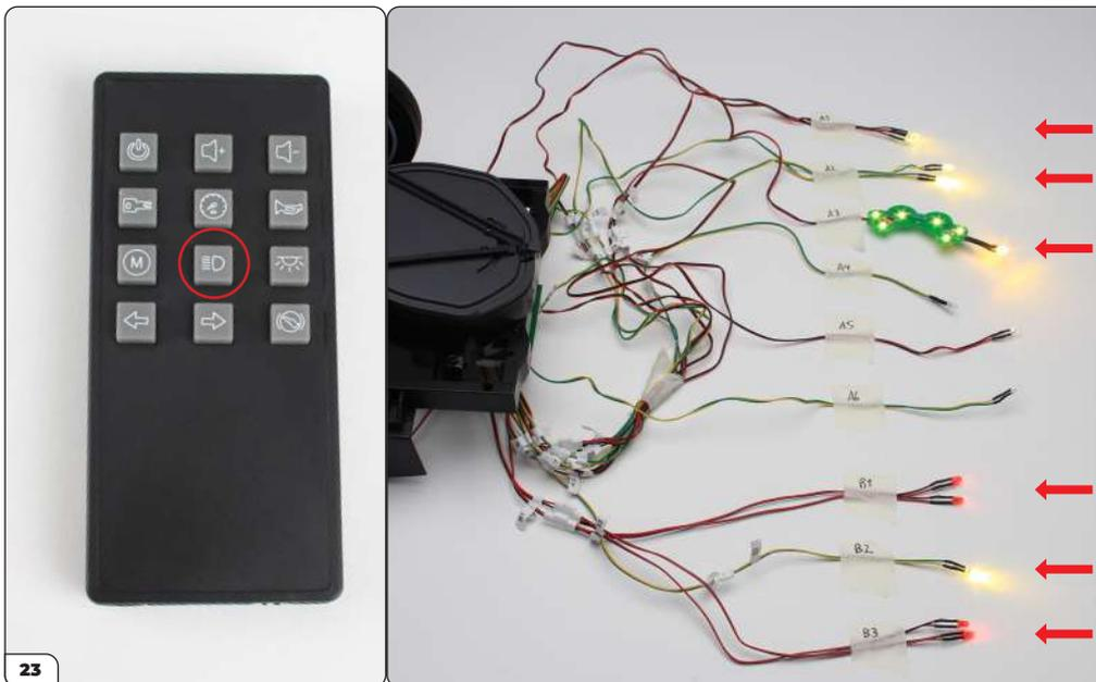
Drücken Sie ein drittes Mal auf die Scheinwerfer-Taste. Die LEDs von A1, A2, A3, B1, B2 und B3 müssten leuchten.
