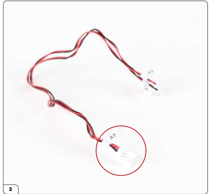
Zum Verbinden der Kabel stecken Sie die Buchse des beschrifteten Verlängerungskabels und den entsprechenden Stecker des Splitter-Kabels zusammen. Anschließend schließen Sie das jeweilige LED-Kabel am Verlängerungskabel an. Nehmen Sie das Verlängerungskabel „A1“.
