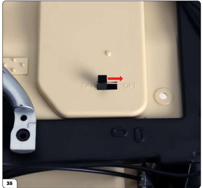
Denken Sie nach dem Testen der elektrischen Funktionen daran, den Ein/Aus-Schalter von ON auf OFF zu schieben.
