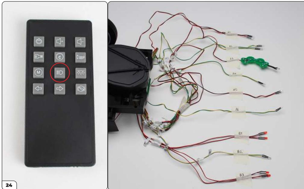
Drücken Sie ein viertes Mal auf die Scheinwerfer-Taste. Alle LEDs müssten erlöschen.
