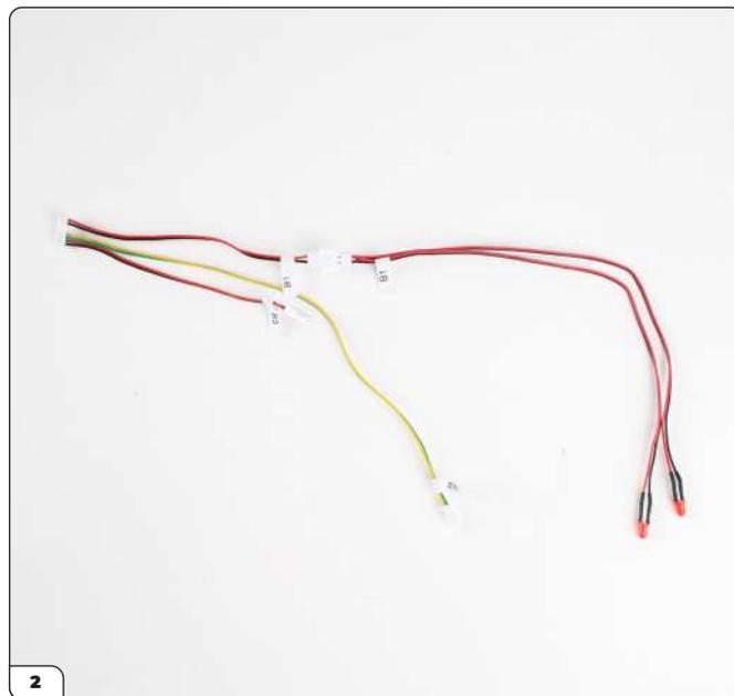
Verbinden Sie das LED-Kabel „B1“ mit der entsprechenden Buchse am Splitter-Kabel.
