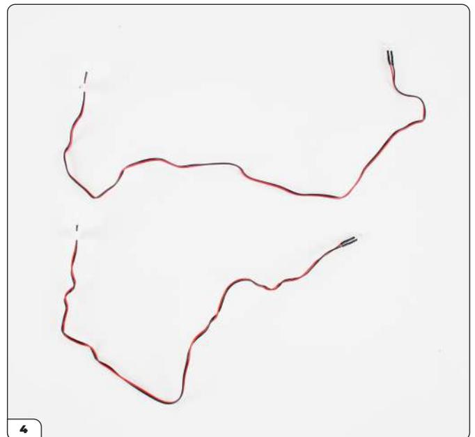
Nehmen Sie die LED-Kabel „A1“. Ein Kabel ist länger als das andere, aber die Kabel können in eine beliebige der zwei Buchsen am Verlängerungskabel gesteckt werden.
