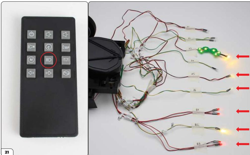
Drücken Sie einmal auf die Scheinwerfer-Taste. Die LEDs von A3, A5, A6, B1, B2 und B3 müssten aufleuchten.
