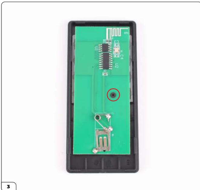
Legen Sie die Platine wie gezeigt über das Tastenfeld. Das Loch muss über dem Zapfen liegen.
