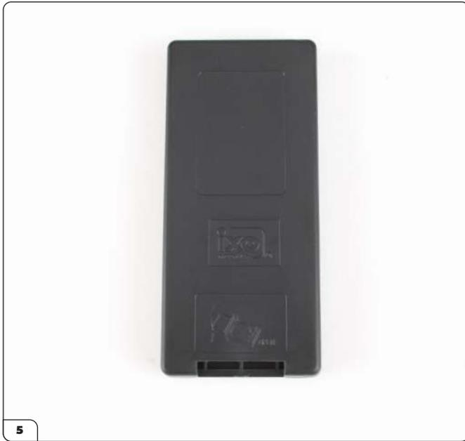
Stecken Sie die Rückseite auf die Vorderseite, bis sie hörbar einrastet.
