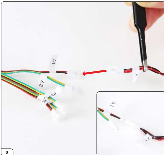
Verbinden Sie das Verlängerungskabel „A1“ mit dem Splitter-Kabel.
