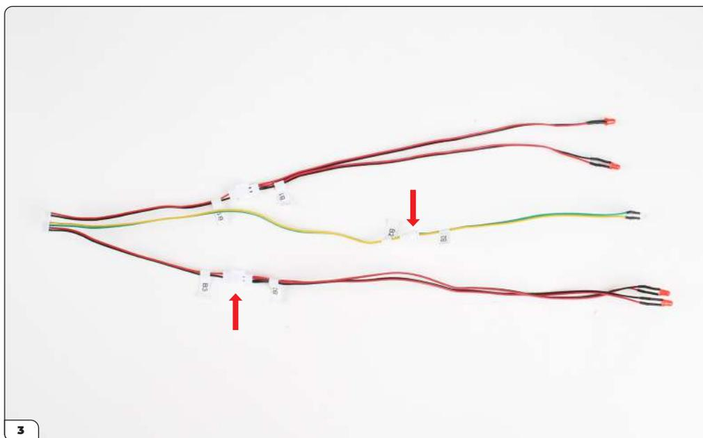
Verbinden Sie die LED-Kabel „B2“ und „B3“ auf die gleiche Weise mit dem Splitter-Kabel.
