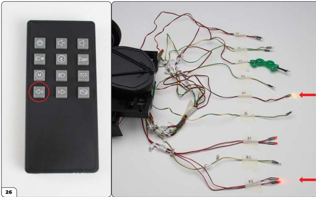
Drücken Sie jetzt auf die Taste für den linken Blinker. Die LEDs A5 und B3 müssten blinken. Drücken Sie erneut auf die Taste. Die LEDs müssten erlöschen.
