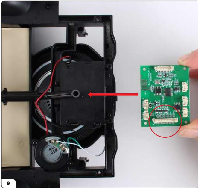
Richten Sie die Platine auf das Batteriefach aus. Die Klemmleiste „A“ muss auf der linken Seite des Autos sein (eingekreist).
