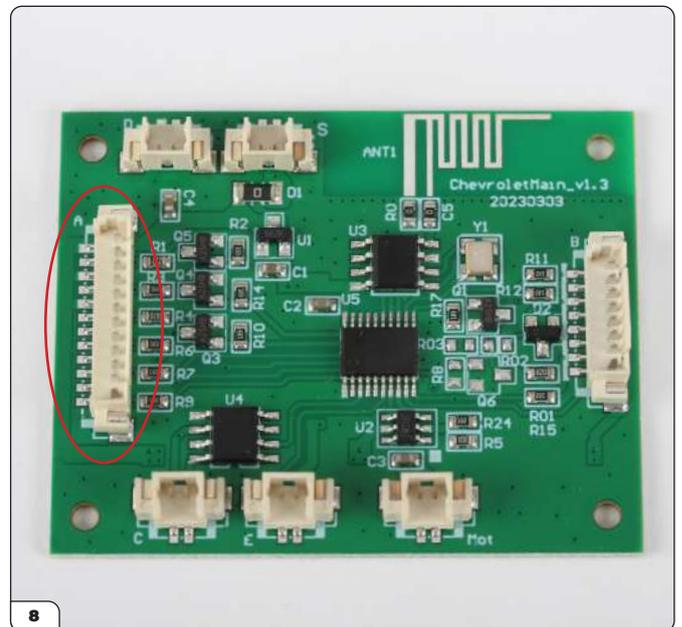
Nehmen Sie die Platine. Jede Klemmleiste/Buchse ist mit dem Buchstaben des entsprechenden Kabels beschriftet. Beachten Sie die Klemmleiste „A“ (eingekreist).
