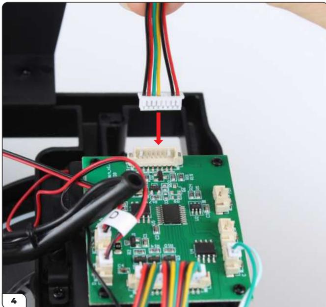
Stecken Sie das Splitter-Kabel in die Buchse auf der Platine, die mit „B“ beschriftet ist.
