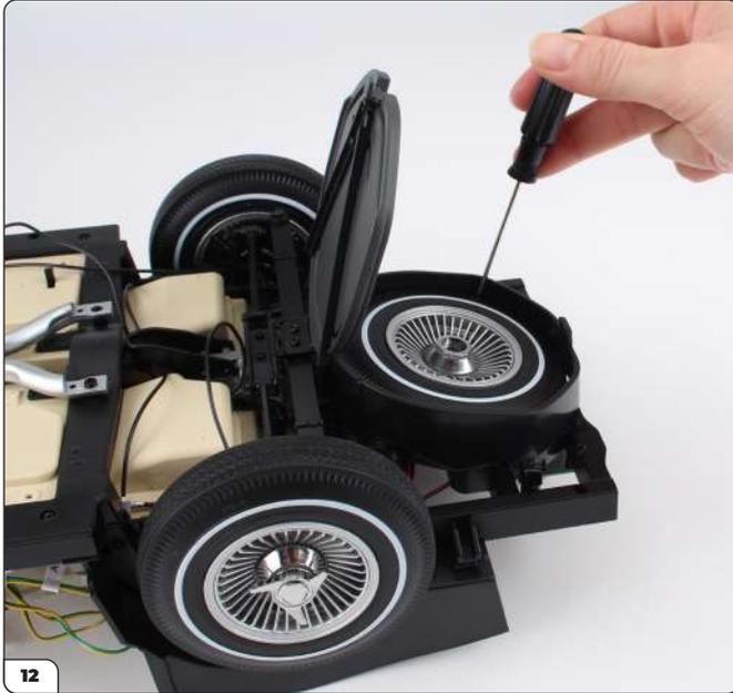
Heben Sie das Reserverad mit einem Schraubendreher oder einem ähnlichen Werkzeug aus dem Halter und legen Sie das Reserverad beiseite.
