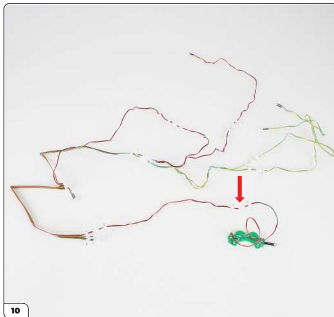
Stecken Sie das LED-Kabel „A3“ in seine Verlängerung.
