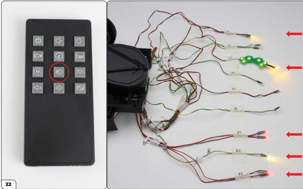
Drücken Sie ein zweites Mal auf die Scheinwerfer-Taste. Die LEDs von A1, A3, B1, B2 und B3 müssten leuchten.
