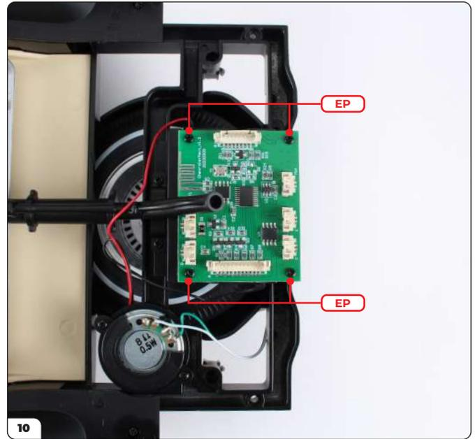
Befestigen Sie die Platine mit 4 EP-Schrauben.
