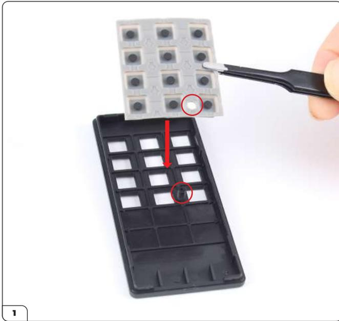
Setzen Sie das Tastenfeld in die Vorderseite der Fernbedienung ein. Der Zapfen (eingekreist) dient hierbei zur Orientierung.
