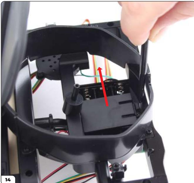
Drücken Sie mit einer Pinzette auf die Klemme, um die Abdeckung für das Batteriefach zu entfernen.
