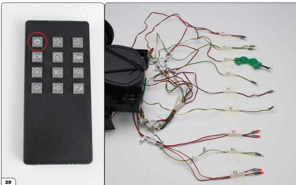
Drücken Sie auf die Scheinwerfer-Taste (wie in Schritt 21), um die LEDs einzuschalten. Drücken Sie dann die Aus-Taste. Die LEDs müssten erlöschen. Diese Taste kann zum Ausschalten aller elektrischen Funktionen am Modell verwendet werden.
