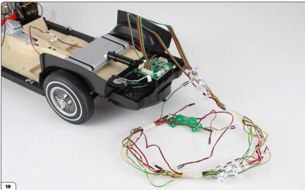
Wenn Sie das Modell beiseite legen, bündeln Sie die Kabel und kleben Sie sie mit Abdeckband zusammen, damit die Kabel nicht beschädigt werden.
