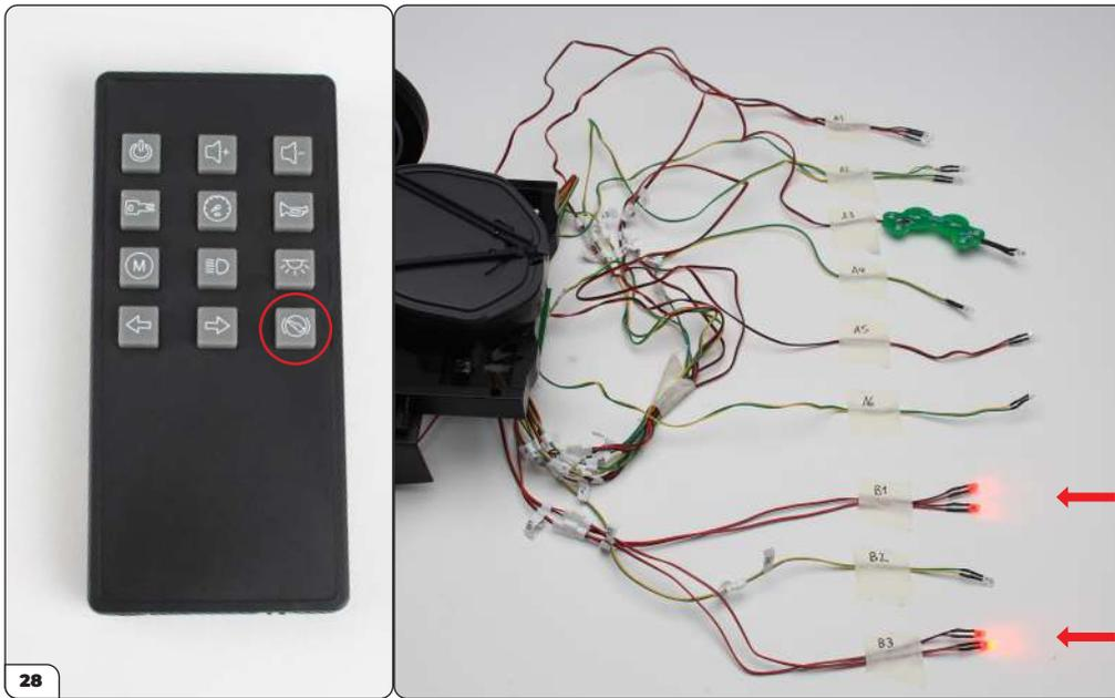
Halten Sie die Taste für die Bremslichter gedrückt. Die LEDs B1 und B3 müssten aufleuchten. Lassen Sie die Taste los. Die LEDs erlöschen.
