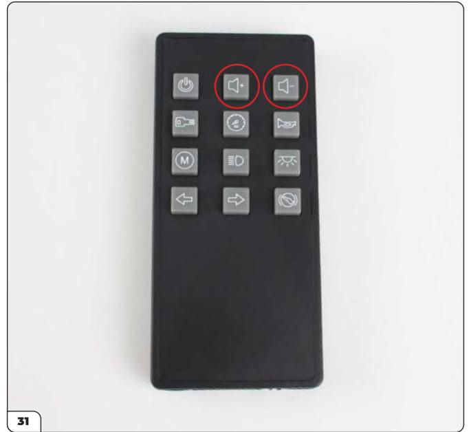
Drücken Sie die Tasten zum Erhöhen/Verringern der Lautstärke, um die Lautstärkeregelung zu testen.
