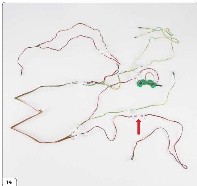
Stecken Sie das LED-Kabel „A5“ in seine Verlängerung.
