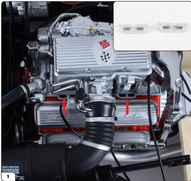
Sur l'ensemble principal, repérez les deux emplacements destinés aux bornes de support moteur (cf. encadré). Les bornes sont identiques et peuvent être utilisées de manière interchangeable.
