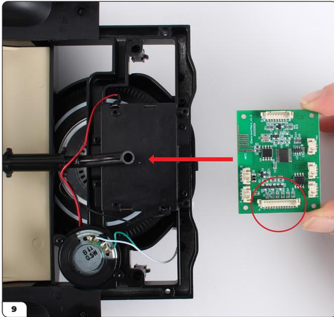
Alignez le circuit imprimé sur le compartiment à pile. La fiche A doit se trouver sur le côté gauche de la voiture (entourée).
