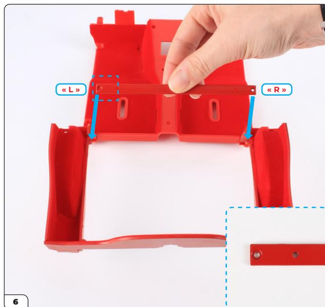
Placez le plancher sur la surface de travail et alignez la traverse avec celui-ci tel qu'indiqué. Les lettres « L » et « R » doivent être placées à gauche et à droite, respectivement. Les pas de vis encastrés de la traverse doivent être orientés vers le haut (cf. encadré).
