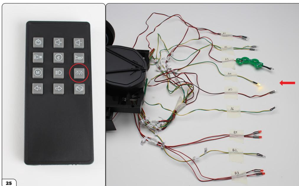
Appuyez ensuite sur le bouton d'éclairage intérieur. La LED A4 doit s'allumer. Appuyez à nouveau sur le bouton d'éclairage intérieur : la LED doit s'éteindre.
