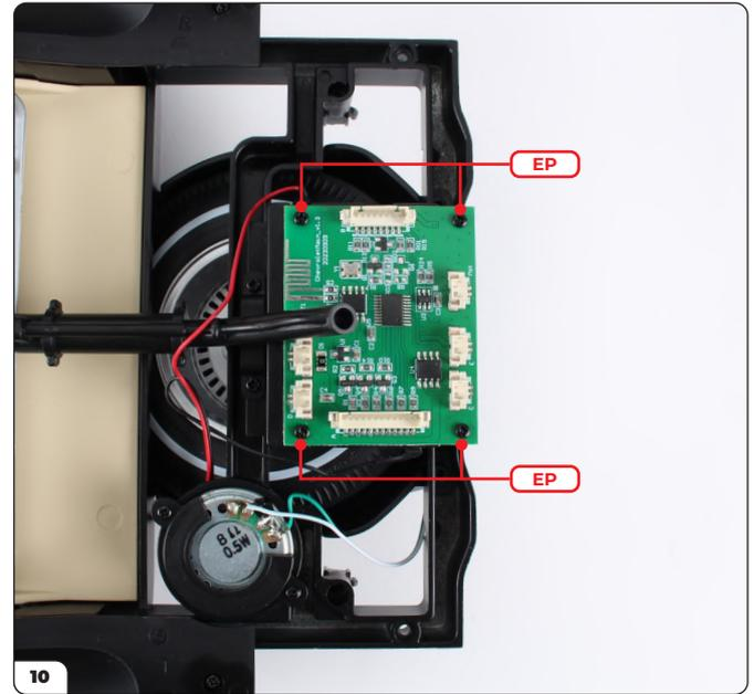
Fixez le circuit imprimé avec 4 vis EP.
