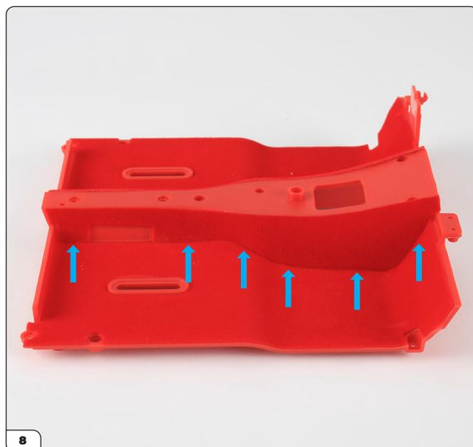
Posez la moquette droite de la même manière que la moquette gauche, en appuyant fermement avec une pince à épiler de façon à obtenir un bord lisse.
