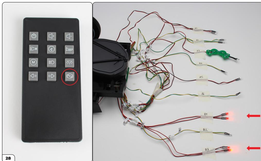
Appuyez et maintenez enfoncé le bouton des feux stop. Les LED B1 et B3 doivent s'allumer. Relâchez le bouton : les LED doivent s'éteindre.
