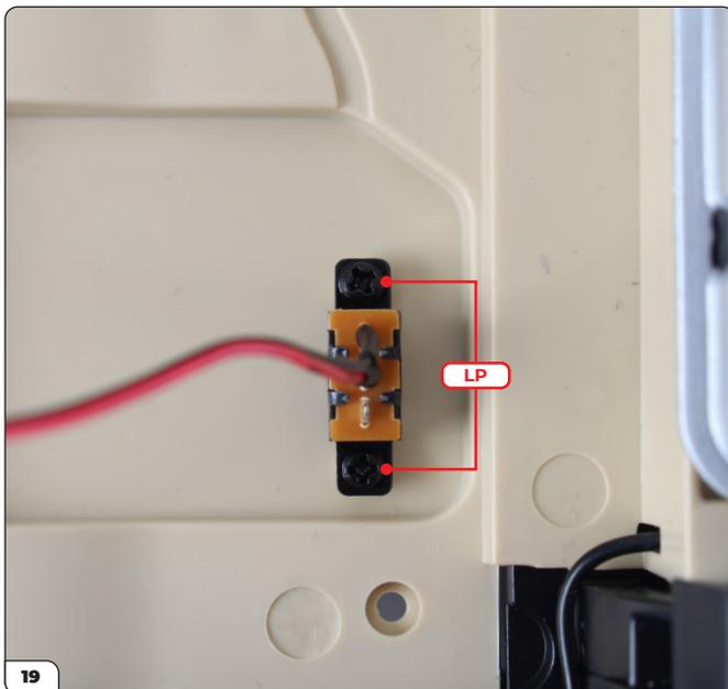
Installez l'interrupteur et fixez-le avec 2 vis LP.
