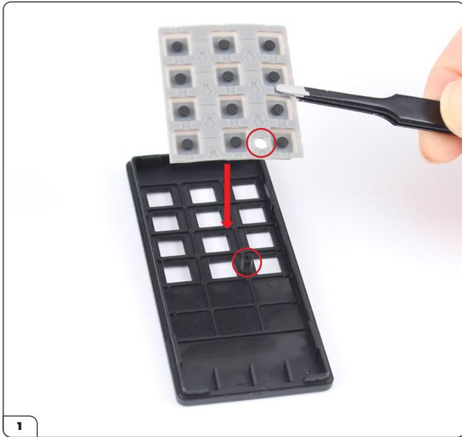
Insérez le clavier dans la face avant de la télécommande, en vous guidant avec la colonne (entourée).
