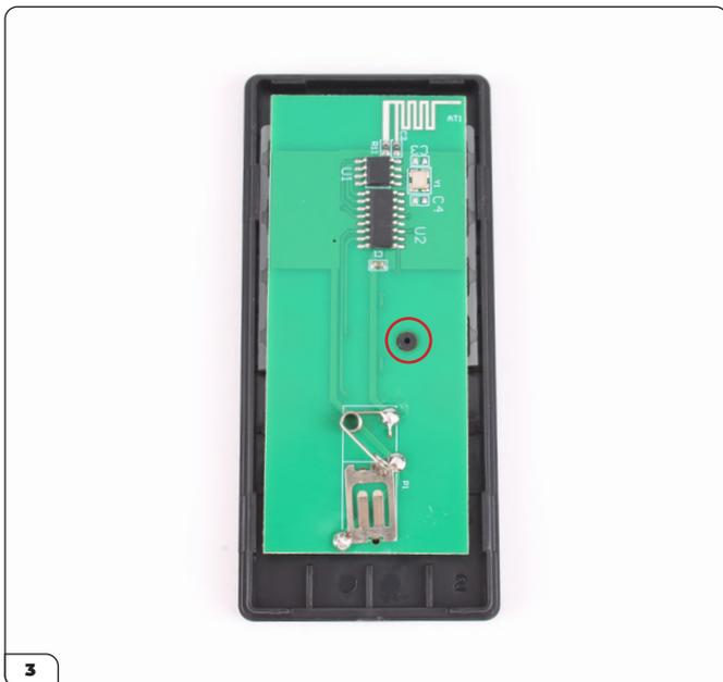
Placez la carte de circuit imprimé sur le clavier tel qu'indiqué, en passant la colonne dans le trou.
