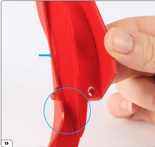
À l'aide d'une pince à épiler, appuyez fermement sur la moquette sur le panneau (entouré) tout en étirant délicatement l'extrémité fine aussi loin que possible (cf. flèche).
