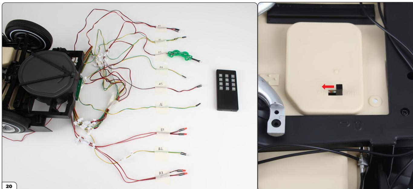
Pour tester les circuits électriques, marquez clairement les LED avec leur étiquette sur un morceau de ruban adhésif afin de pouvoir les identifier aisément. Il pourra également être utile de baisser l'éclairage dans la pièce ! Pensez également à régler l'interrupteur sur la position « ON ».
