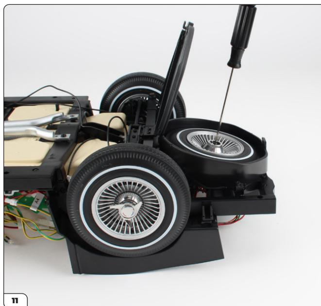
Dévissez la rondelle et la vis IP qui maintiennent la roue de secours en place. Mettez la rondelle de côté en lieu sûr.
