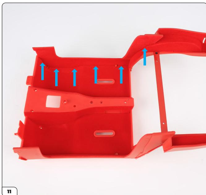
Mettez le panneau en place et vérifiez que les bords de la moquette sont correctement joints.
