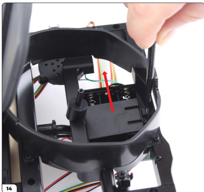
Utilisez une pince à épiler pour exercer une pression sur le clip et retirez le couvercle du compartiment à pile.
