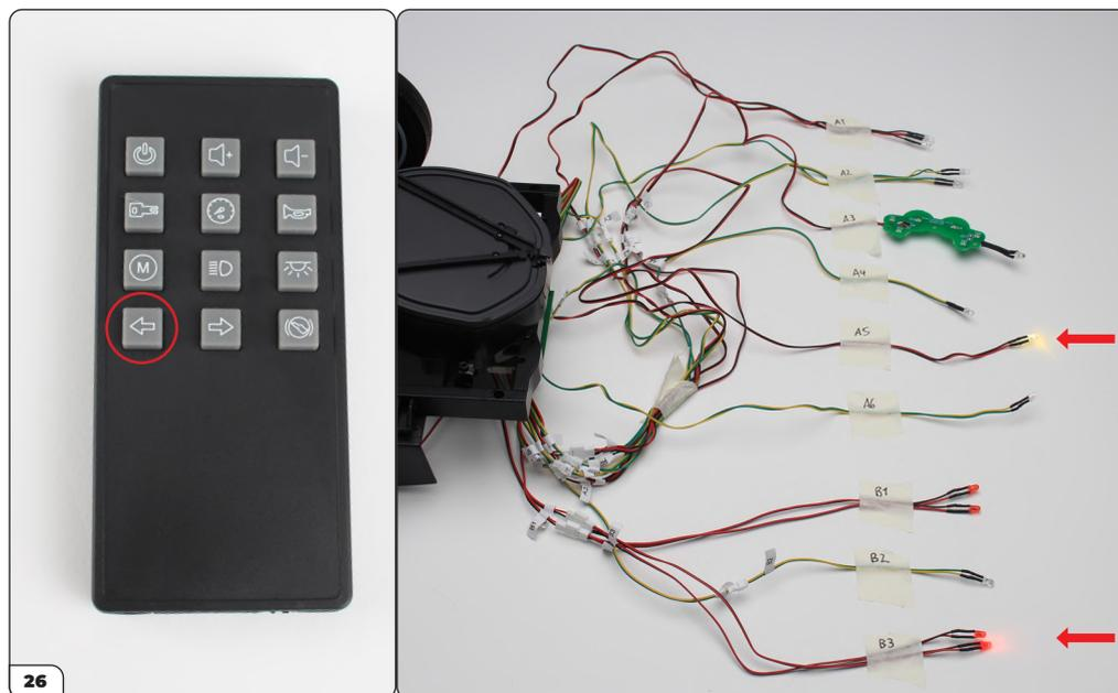
Appuyez ensuite sur le bouton du clignotant gauche. Les LED A5 et B3 doivent se mettre à clignoter. Appuyez à nouveau sur le bouton et les LED doivent s'éteindre.
