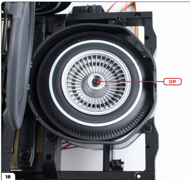
Remplacez la rondelle retirée à l'étape 11, puis fixez la roue avec une vis OP (fournie avec cette étape).
