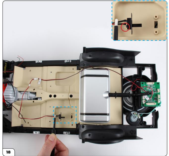
Passez le fil de l'interrupteur autour du réservoir de carburant, puis alignez l'interrupteur sur l'ouverture du plancher du cockpit, tel qu'indiqué. Veillez à ce que l'interrupteur soit orienté dans le bon sens (cf. encadré).
