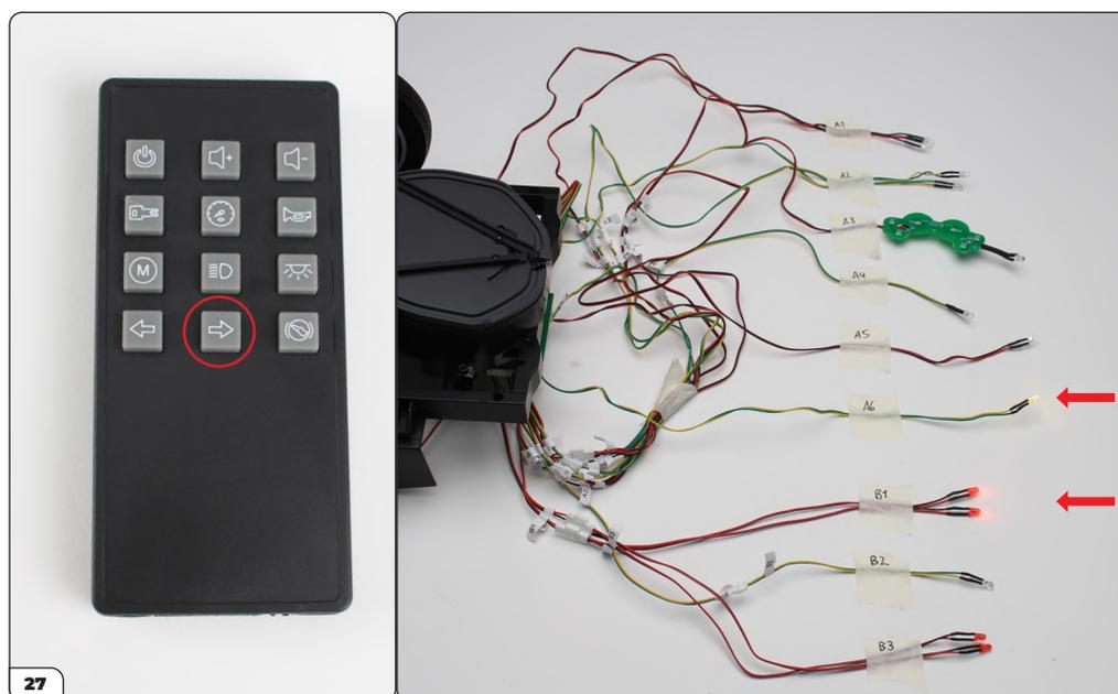
Appuyez ensuite sur le bouton du clignotant droit. Les LED A6 et B1 doivent se mettre à clignoter. Appuyez à nouveau sur le bouton et les LED doivent s'éteindre.
