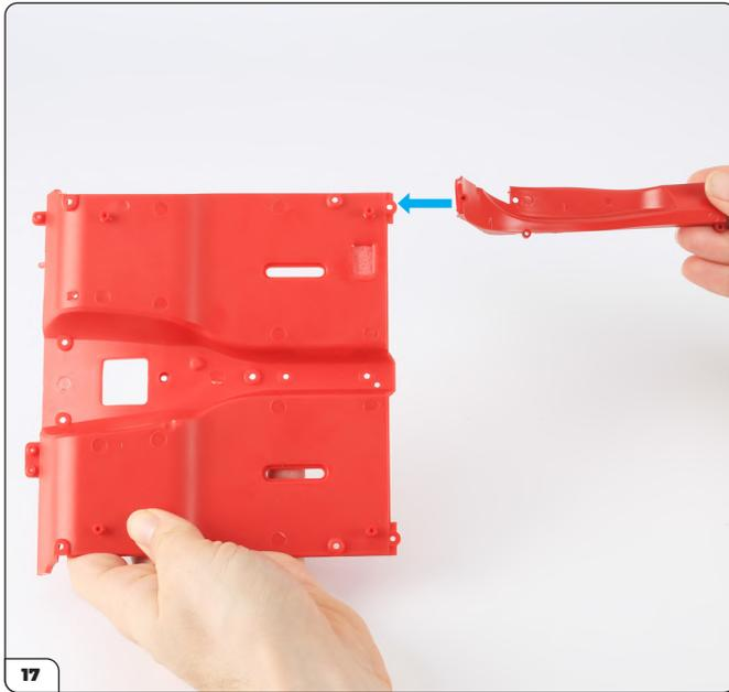
Alignez le panneau latéral arrière gauche avec le plancher intérieur. Le côté moquetté des deux pièces doit être orienté dans le sens opposé au vôtre.
