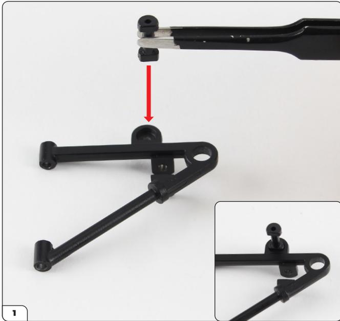
Montez le support de la barre stabilisatrice (23-E) sur le bras inférieur de la suspension (23-A) via le support en forme de D pour assurer une orientation correcte.
