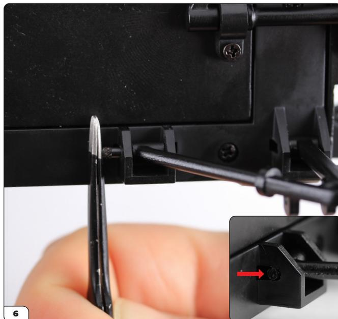
Spingi quindi i due perni in modo da forzare le loro estremità scanalate nei relativi fori. Per facilitare l'operazione, si può usare una pinzetta.
