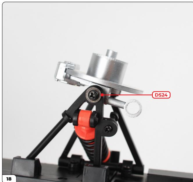
Solleva l'assieme così montato e fissa il mozzo al braccio inferiore dal basso tramite una vite DS24.
