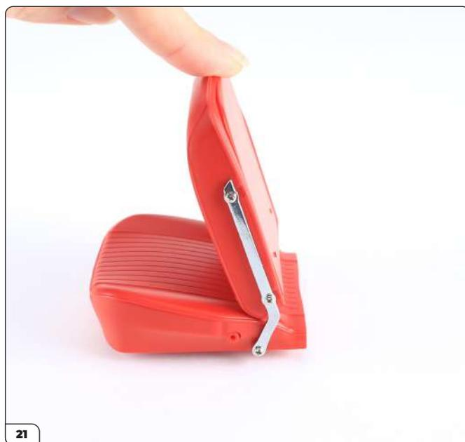
Vérifiez que le dossier peut bouger et ajustez le serrage des vis RP si nécessaire.
