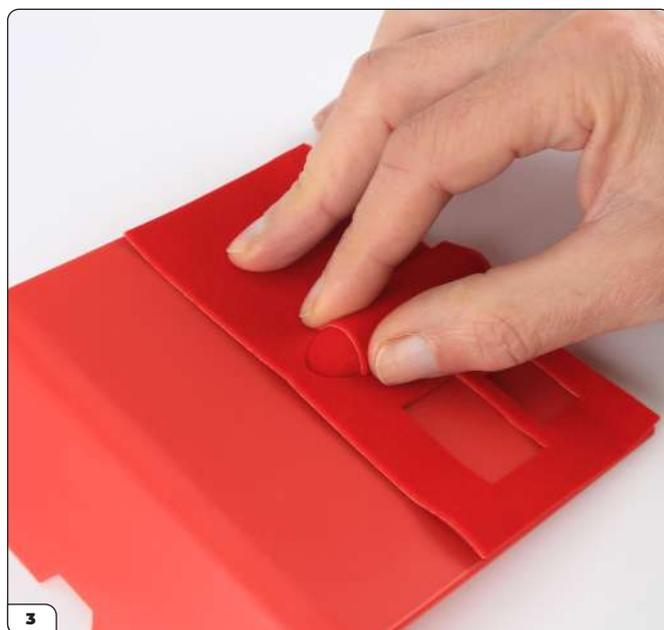
Positionnez la moquette 3 en maintenant les autres en place. Vérifiez l'espace nécessaire pour le faire passer sous les moquettes 4 et 5.
