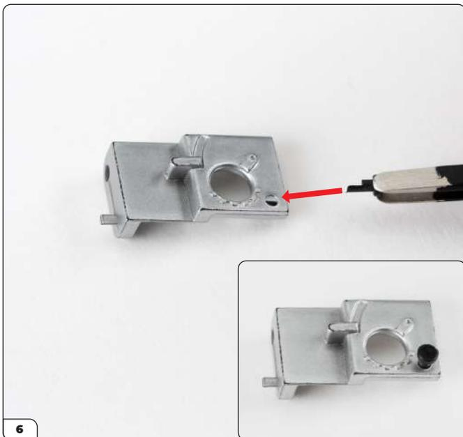
Installez l'un des butoirs de capot dans une charnière à l'aide de la broche façonnée à cet effet.
