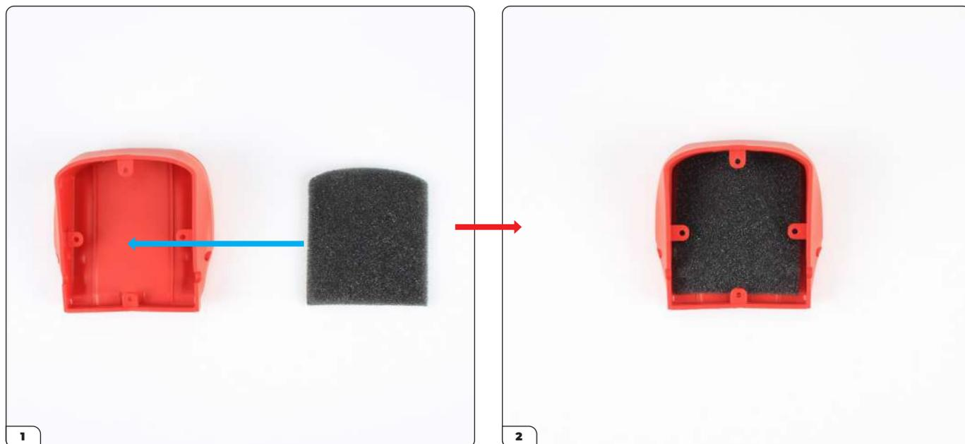
Insérez la mousse dans le coussin de siège
