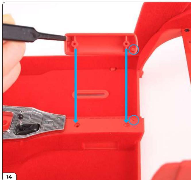
Montez l'accoudoir sur le plancher. Notez la petite broche et le trou lorsque vous alignez les pièces (entourées sur la photo).
