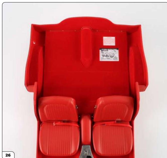
Quatre broches (entourées sur la photo) situées sous le cache du réservoir de carburant s'insèrent dans les trous du cockpit (cf. flèches).
