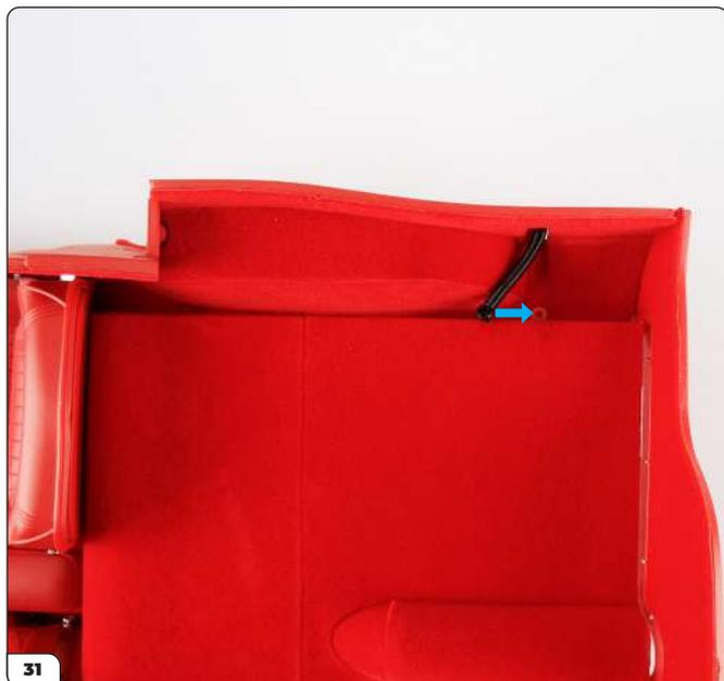
Localisez le pas de vis à côté du cache du réservoir de carburant.
