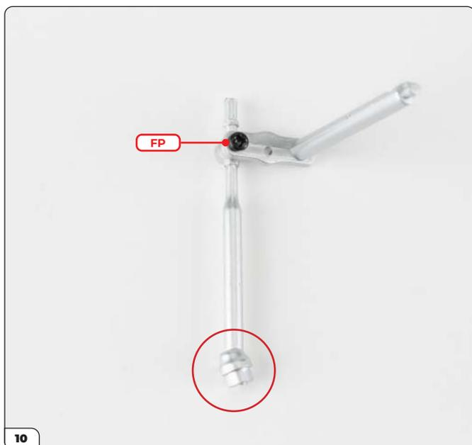
Reliez la tige-poussoir et l'arbre transversal avec une vis FP. Notez l'orientation de la tige-poussoir (entourée sur la photo). Ne serrez pas trop la vis.
