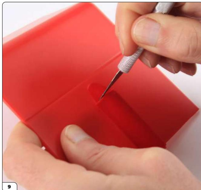
Il pourra y avoir un chevauchement entre les deux morceaux de moquette. Vous pourrez utiliser un couteau de précision pour découper des parties de la moquette 5, en utilisant le bord pour guider la lame de façon à obtenir une jonction lisse.
