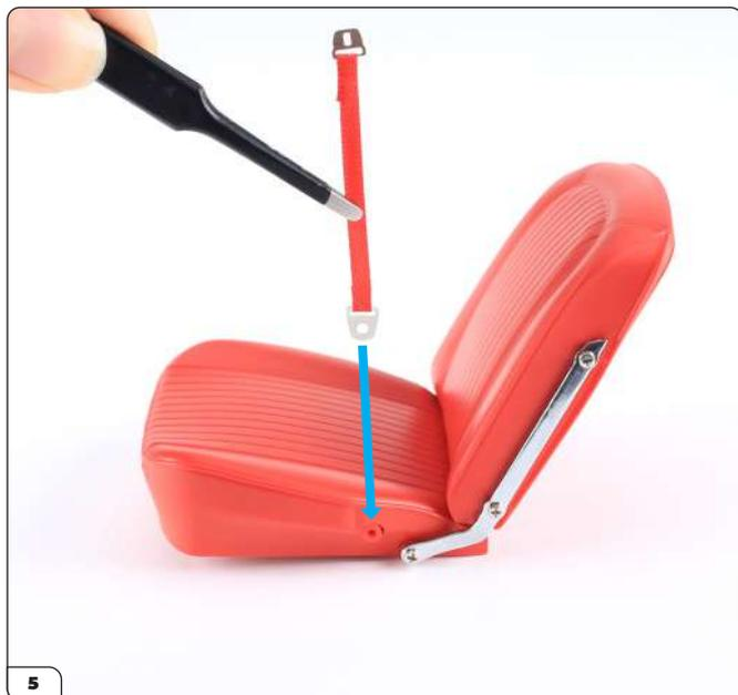
Prenez l'une des languettes de la ceinture de sécurité et alignez-la tel qu'indiqué. Positionnez le trou arrondi de la ceinture par-dessus le montant fileté.
