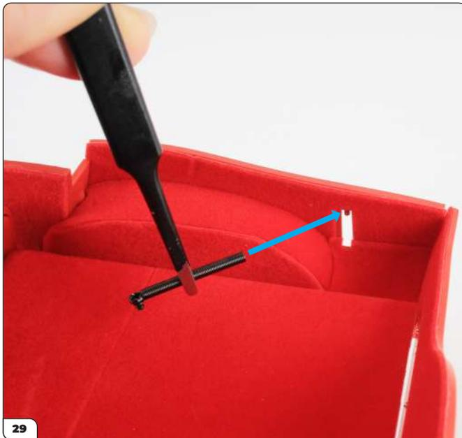
Sur le cockpit, localisez la broche à l'intérieur de l'ouverture sur le côté arrière droit.
