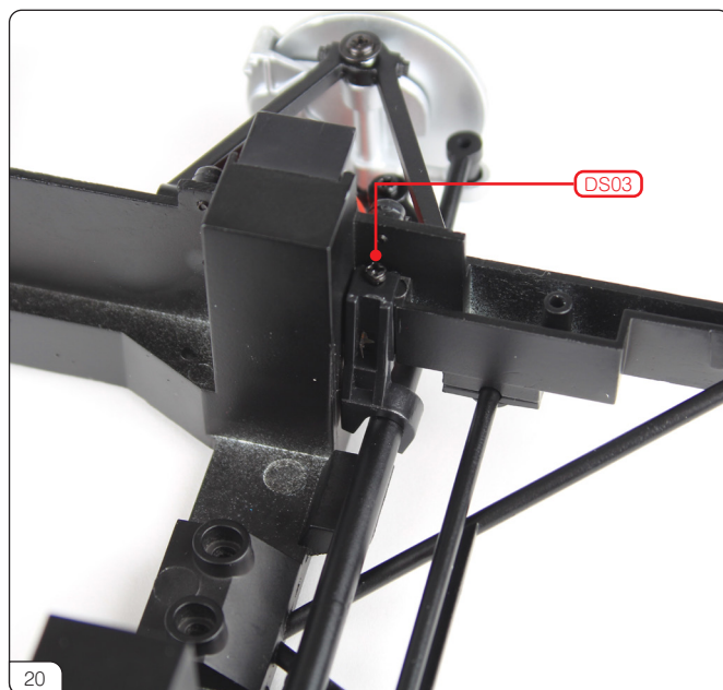
20 左ステアリングロッドホルダー (26-F) も同様に配置し、DS03ネジで固定します。
