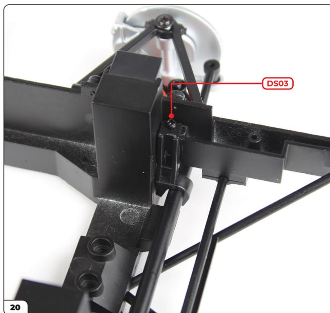
Monta allo stesso modo il supporto sinistro, fissandolo con una vite DS03.
