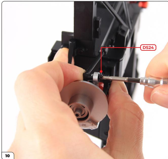
Prendi una vite DS24, schiaccia con decisione la sospensione, come mostrato nella foto, e avvitala sulla barra dello sterzo, per fissarla sul mozzo della ruota destra.
