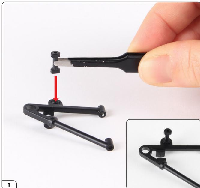
Monta il supporto della barra antirollio (25-E) sul braccio inferiore della sospensione (25-A) tramite l'attacco a D che ne garantisce l'orientamento corretto.
