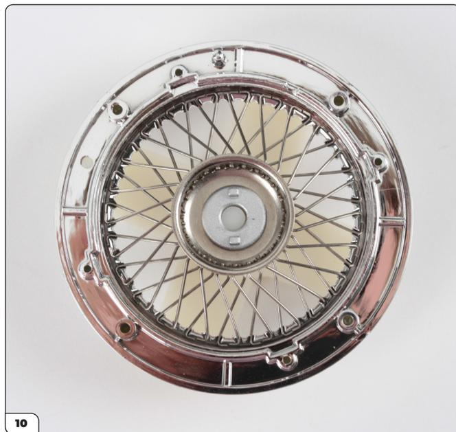
Ripeti l'operazione finché hai montato tutti i raggi e controlla poi che si trovino correttamente in tutte le loro sedi sul cerchio esterno.
