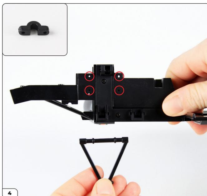
Prepara i due supporti (24-E) e quattro viti DS27. Allinea il braccio superiore sinistro (24-B) con il lato sinistro del telaio anteriore (fase 23). Quindi individua i quattro fori delle viti di fissaggio dei supporti.
