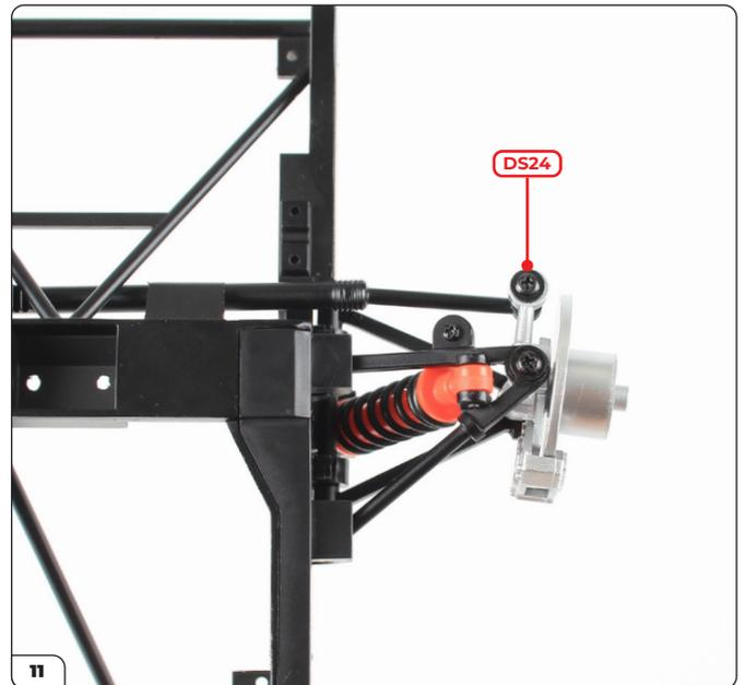
Ripeti l'operazione dall'altro lato usando una vite DS24 per fissare la barra dello sterzo sul mozzo della ruota sinistra.
