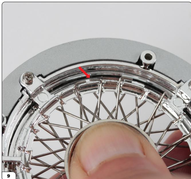
Capovolgi l'assieme e controlla che l'estremità del raggio sia posizionata sulla parte più esterna dell'anello per stare di fronte a uno dei raggi che partono dai fori della fila inferiore.
