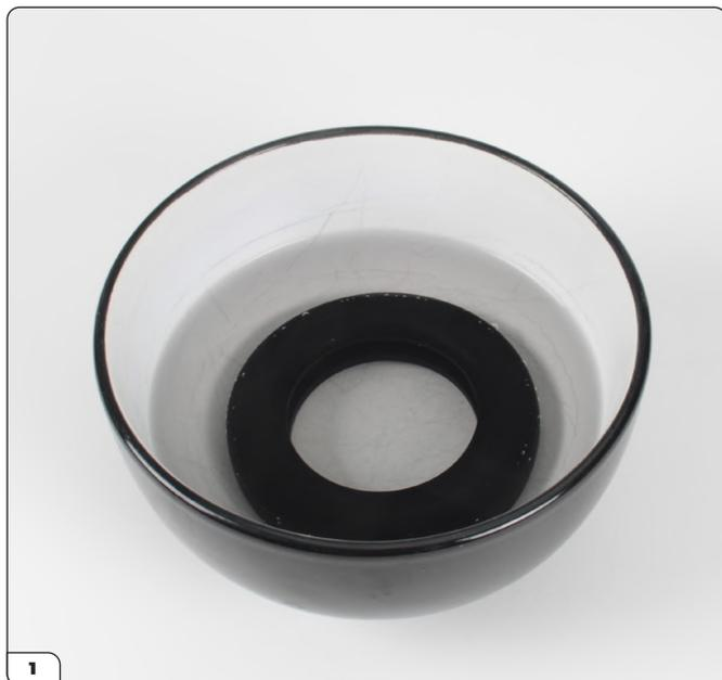
Immergi delicatamente lo pneumatico (38-A) in un recipiente riempito di acqua calda per ammorbidirlo. Fai attenzione, immergendolo, a non far schizzare l'acqua calda.
