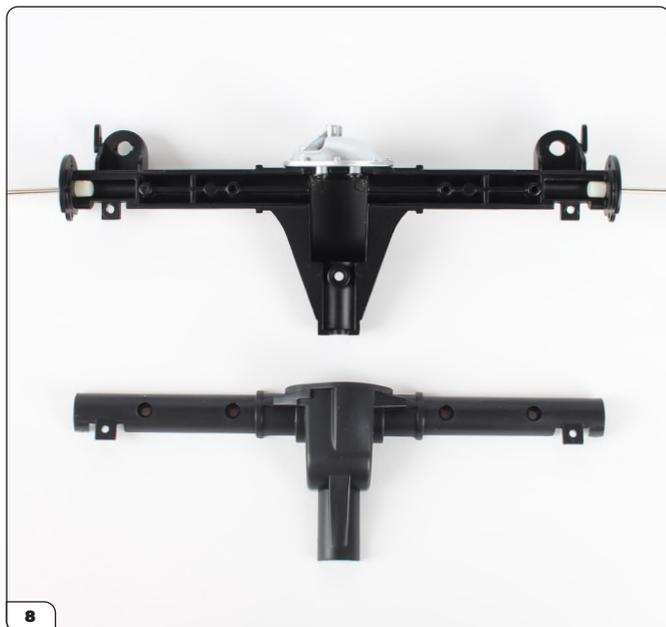
Allinea la parte superiore del ponte (32-B) con l'assieme appena montato.
