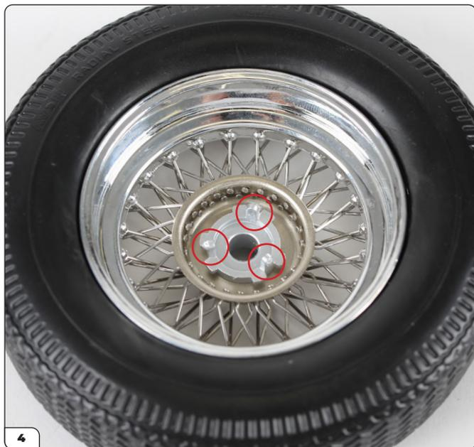
Le ruote posteriori hanno una particolare flangia di montaggio dotata di tre attacchi, indicati dai cerchi nella foto.
