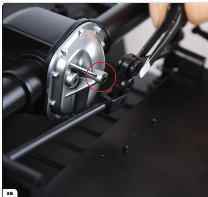
Monta la connessione delle barre sul coperchio del differenziale utilizzando l'attacco sagomato.
