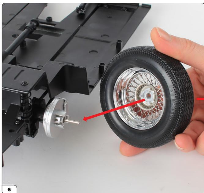
Monta la ruota sul mozzo posteriore destro, accertandoti che gli attacchi sulla ruota stessa siano allineati con le linguette sul mozzo. Premi con decisione finché gli attacchi non risultano montati correttamente.
