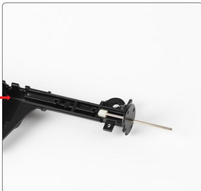
Inserisci l'estremità scanalata dell'asse (32-E) nel foro del portamozzo e calzala con forza nel fermo.
