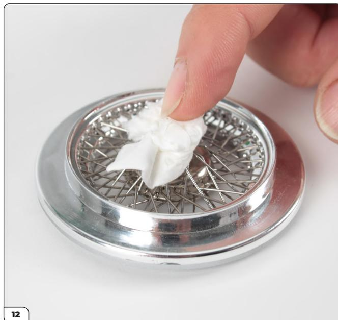
Una volta verificato che tutti i raggi sono stati montati in modo corretto, essi possono essere fissati sulla parte più esterna dell'anello. Comincia l'operazione spingendo un pezzo di panno carta nel foro del mozzo per mantenere in posizione i raggi.
