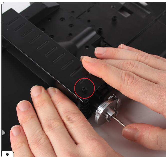
Spingi verso il basso il telaio in modo da far entrare l'estremità inferiore filettata dell'ammortizzatore telescopico nel relativo foro.
