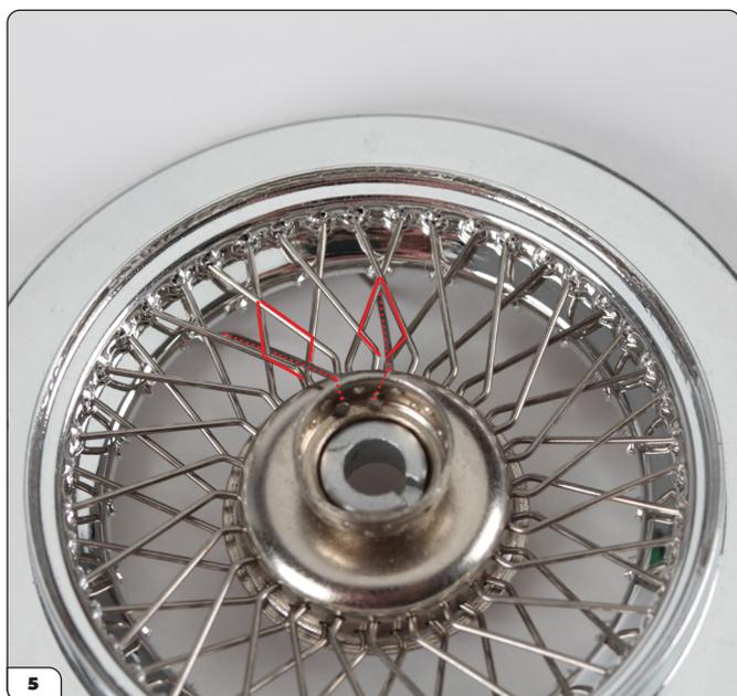
Una volta soddisfatto del montaggio del primo raggio, fanne passare un altro del tipo A attraverso il successivo foro della fila inferiore e attraverso la seconda forma di diamante dopo la prima, evidenziata nella foto. In questa fase, le estremità possono essere lasciate libere sul lato opposto.
