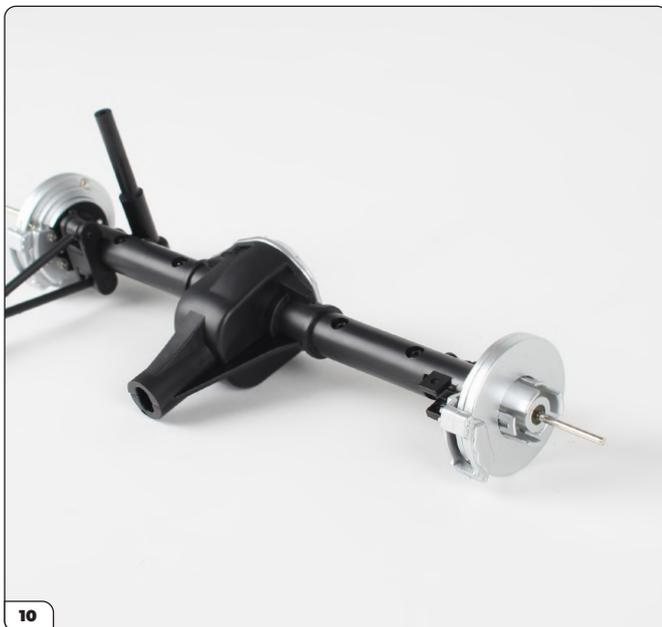
Monta il freno a disco sul ponte calzandolo sul perno predisposto.
