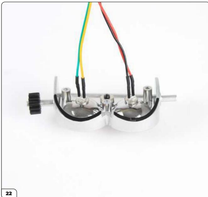
Setzen Sie die LEDs ein. Stecken Sie die LEDs nicht vollständig hinein (siehe nächster Schritt).
