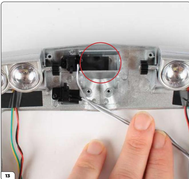
Legen Sie die Schalterkabel so hin, dass sie nicht über dem Motorgehäuse (eingekreist) und über den Schraubzapfen liegen.
