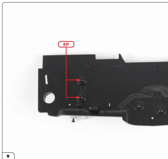
Drehen Sie die Baugruppe um und befestigen Sie die Heizung mit 2 EP-Schrauben.
