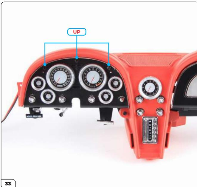
Befestigen Sie die Instrumententafel mit 3 UP-Schrauben.
