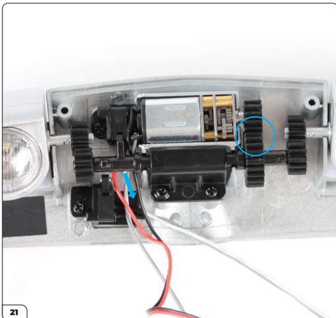
Ziehen Sie die Motorkabel bei Bedarf vorsichtig unter der Welle durch (siehe Pfeil) und bauen Sie dann den Motor in sein Gehäuse ein. Das Zahnrad muss in die Welle greifen (eingekreist).
