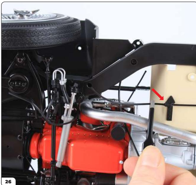
Nehmen Sie die Chassis-Baugruppe und ziehen Sie den Schlauch vom Handbremsseil ab.
