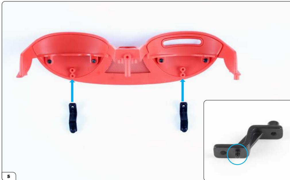
Nehmen Sie die beiden Halterungen für die Spritzwand und richten Sie sie wie gezeigt aus. Stecken Sie die Stifte (eingekreist) in die Löcher im Armaturenbrett.
