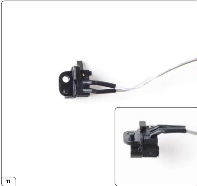
11 Nehmen Sie den Schalter mit dem angebrachten Träger A und biegen Sie die Kabel vorsichtig wie gezeigt flach.
