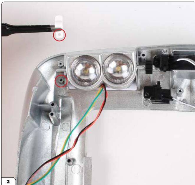
Setzen Sie den Scheinwerfer wie gezeigt ein. Nehmen Sie dann eine der Halterungen und richten Sie sie auf die Löcher an der äußeren Kante aus.
