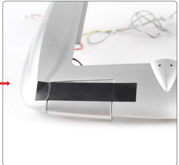
Kleben Sie ein langes Klebebandstück über die Abdeckung, damit die Abdeckung nicht verrutscht.
