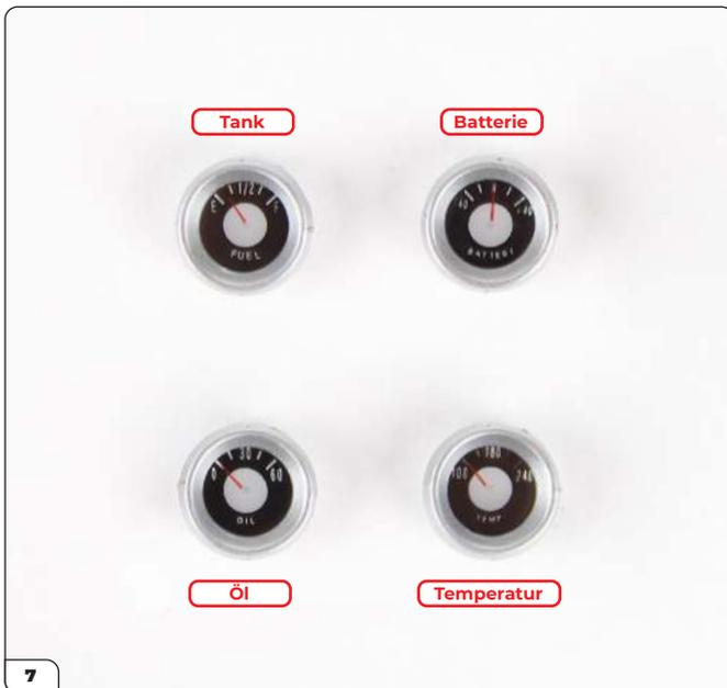
Wiederholen Sie den Schritt für die anderen drei kleinen Instrumente. Beachten Sie die Oberseiten der einzelnen Instrumente, damit Sie sie in den nächsten Schritten richtig einbauen.
