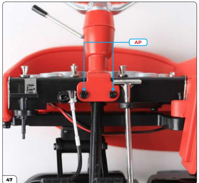
Befestigen Sie die Basis mit 2 AP-Schrauben. Prüfen Sie, ob sich das Lenkrad frei bewegen lässt.
