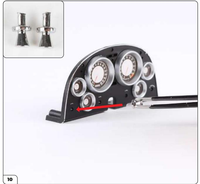
Nehmen Sie einen der Knöpfe (siehe kleines Bild) und stecken Sie ihn in das Loch auf der linken Seite der Instrumententafel.
