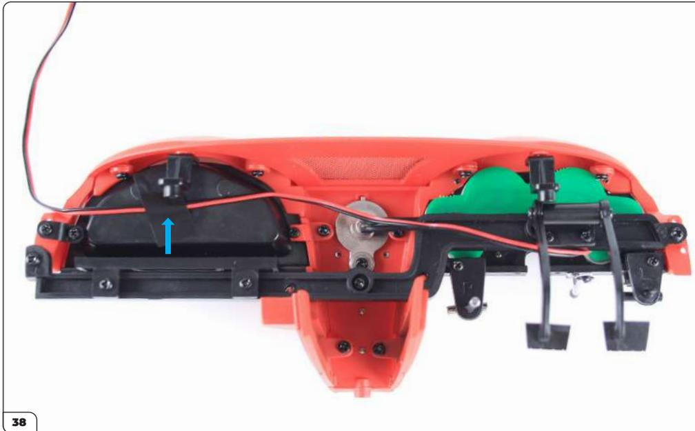
Verlegen Sie das Kabel und befestigen Sie es wie gezeigt mit dem Klebeband am Handschuhfach.
