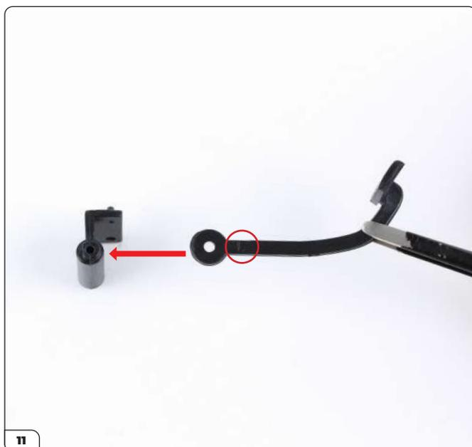
Nehmen Sie das Kupplungspedal (mit „L“ beschriftet, eingekreist) und richten Sie es auf das Fußpedalgestänge aus.
