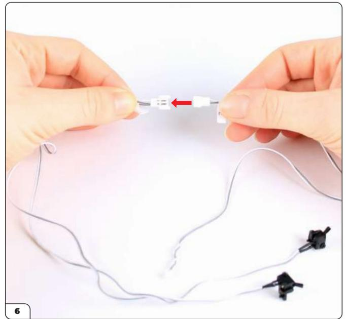
Verbinden Sie die Schalterverlängerung mit den Schaltern.
