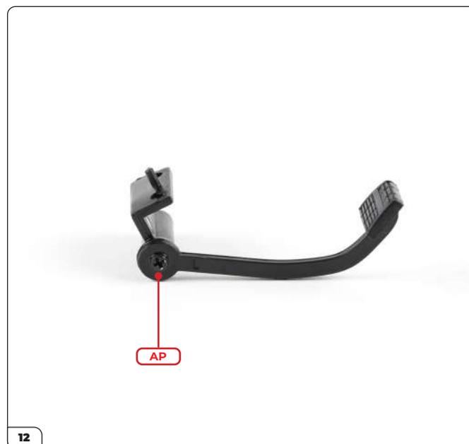
Legen Sie das Kupplungspedal über das geformte Schraubloch und befestigen Sie es dann mit einer AP-Schraube.
