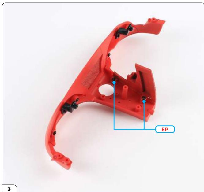
Befestigen Sie das Paneel mit 2 EP-Schrauben.
