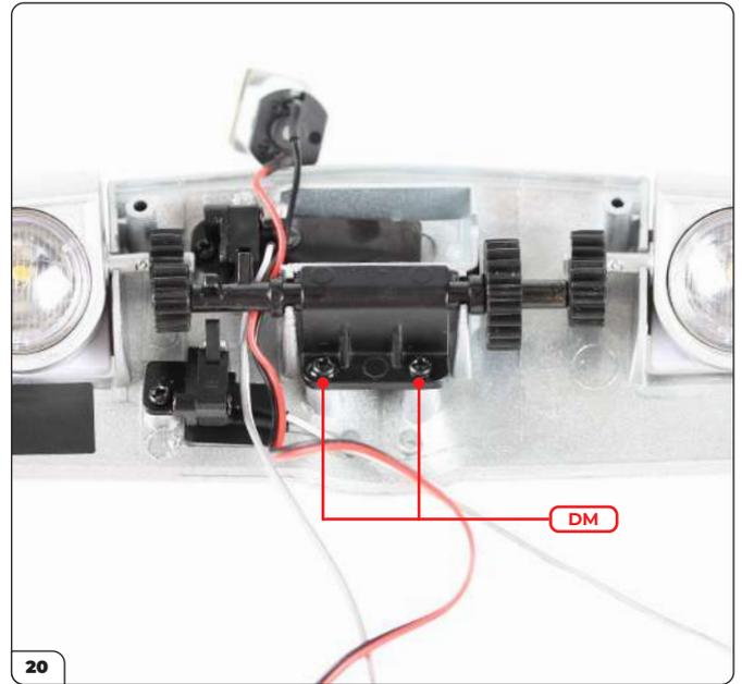
Befestigen Sie die Halterung mit 2 DM-Schrauben.
