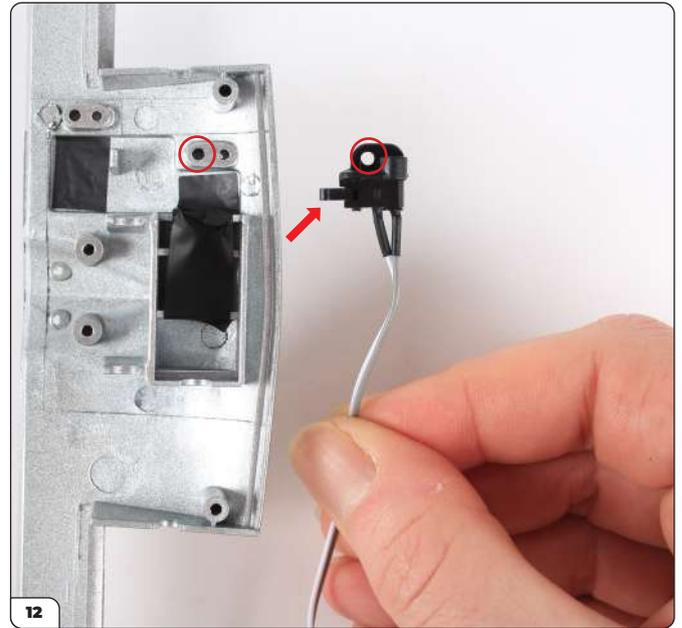
12 Richten Sie den Schalter auf die vordere Karosserie aus. Die großen Schraublöcher (eingekreist) müssen aufeinander ausgerichtet sein und der Schalterhebel (siehe Pfeil) muss zum Heck der Karosserie zeigen.
