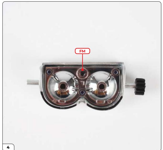
Setzen Sie den Reflektor ein und befestigen Sie ihn mit einer FM-Schraube.
