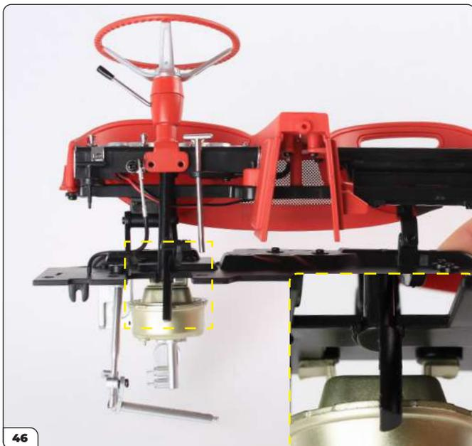
Stecken Sie die Lenkwelle in die Aussparung in der Spritzwand (siehe kleines Bild).
