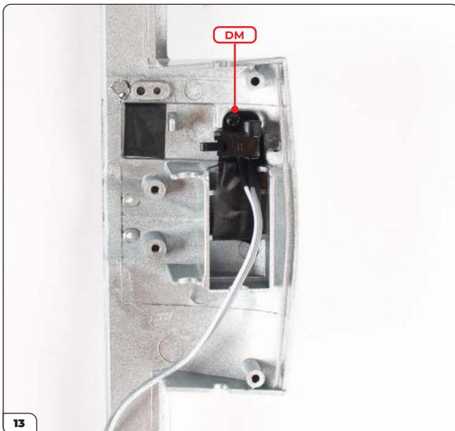
13 Bauen Sie den Schalter ein und befestigen Sie ihn mit einer DM-Schraube.
