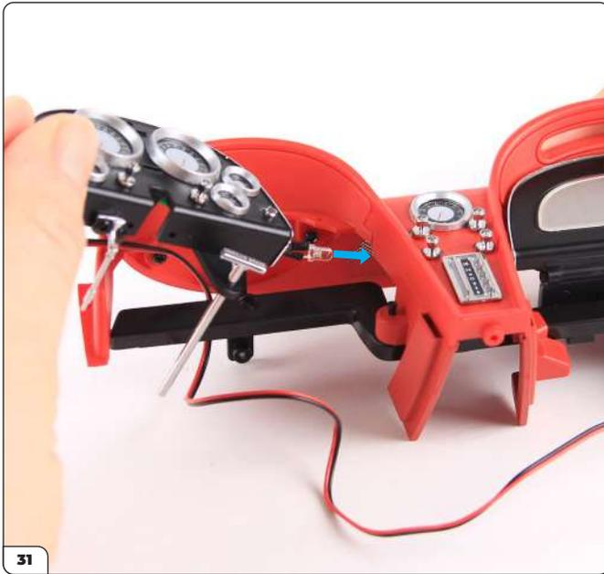
Bringen Sie die LED unter dem Mittelteil des Armaturenbretts an.
