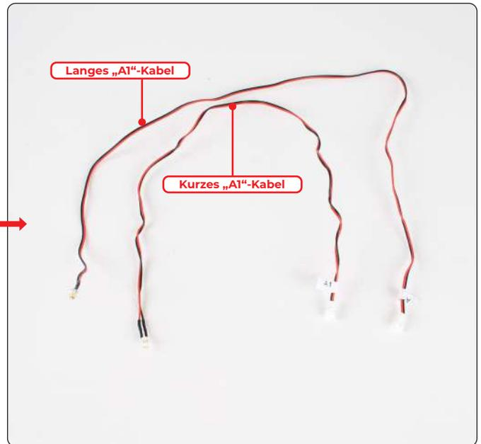
Nehmen Sie die Chassis-Baugruppe und suchen Sie die zwei mit „A1“ beschrifteten LEDs. Ziehen Sie dann diese Stecker ab. Beachten Sie, dass ein Kabel lang und das andere Kabel kurz ist.
