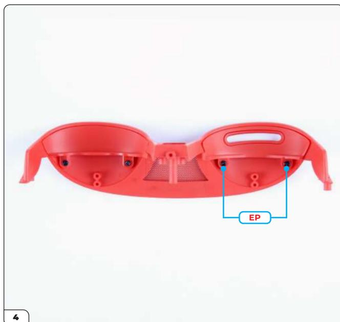
Legen Sie das Paneel auf das Armaturenbrett und befestigen Sie es mit 2 EP-Schrauben.
