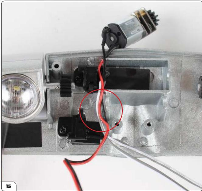
Drücken Sie die Motorkabel über die Schalterkabel und legen Sie dann den Motor vorsichtig wie gezeigt neben sein Gehäuse.
