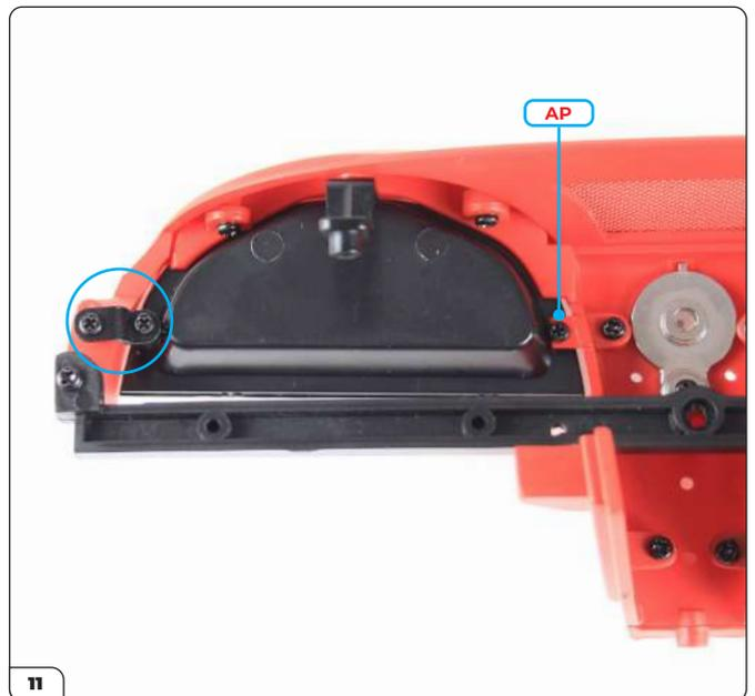
Befestigen Sie dieses Teil mit einer weiteren AP-Schraube. Sie können die Position des Handschuhfachs justieren, sobald der Deckel eingebaut ist (siehe Schritt 15), und dann die Schrauben in der Halterung (eingekreist) festziehen.
