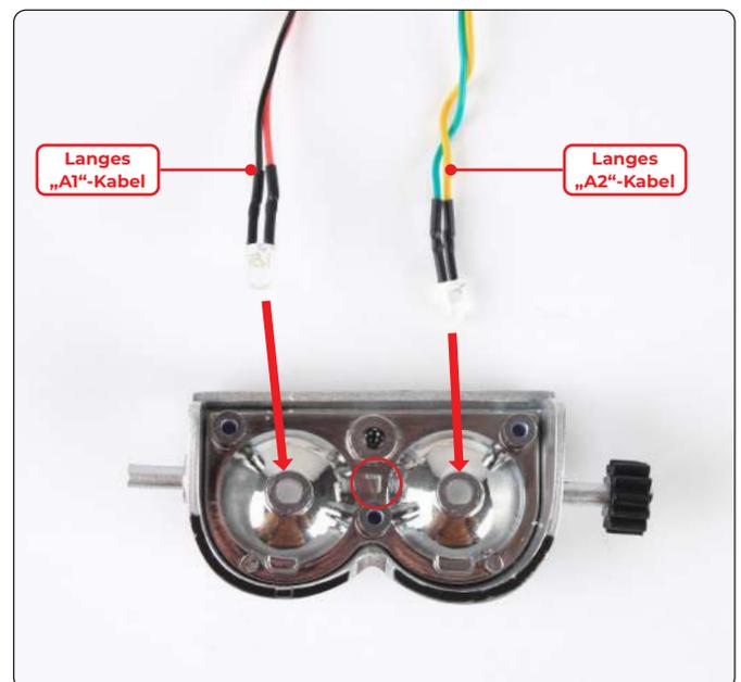
Richten Sie die LEDs an den langen Kabeln wie gezeigt auf den Reflektor der linken Scheinwerfer aus. „A1“ ist für den äußeren Scheinwerfer, „A2“ für den inneren Scheinwerfer.
