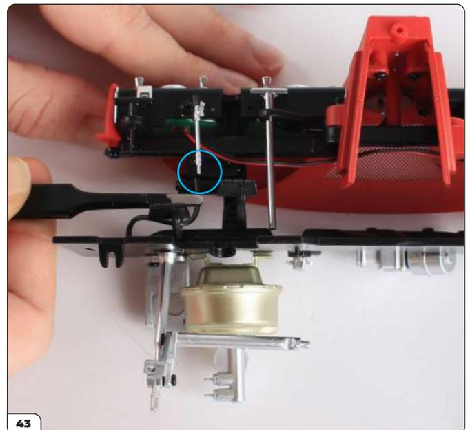
Stellen Sie die Baugruppe auf den Kopf und stecken Sie den Schlauch von der Spritzwand auf die Motorhaubenverriegelung.
