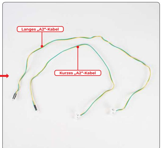
Suchen Sie die zwei mit „A2“ beschrifteten LEDs. Ziehen Sie dann diese Stecker ab. Auch hier ist wieder ein Kabel lang und ein Kabel kurz.
