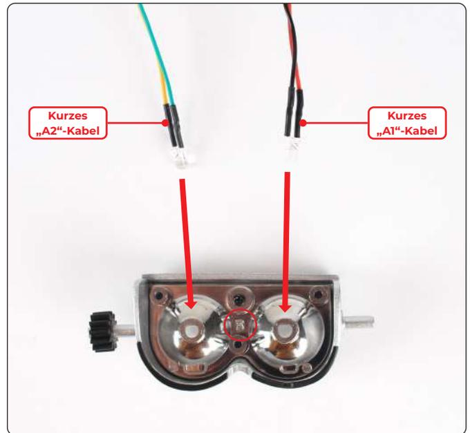
Richten Sie die LEDs an den kurzen Kabeln wie gezeigt auf den Reflektor der rechten Scheinwerfer aus. „A1“ ist für den äußeren Scheinwerfer, „A2“ für den inneren Scheinwerfer.
