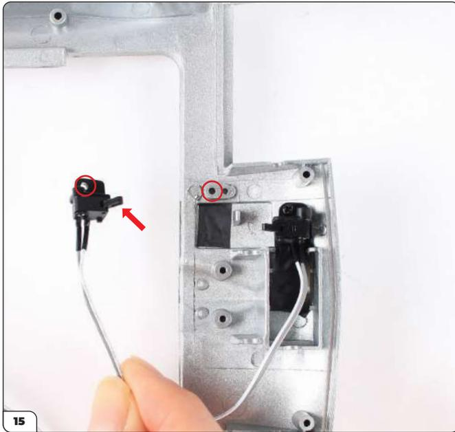
Richten Sie den Schalter wie gezeigt auf die vordere Karosserie aus. Die großen Schraublöcher müssen aufeinander ausgerichtet sein und der Schalterhebel muss zur Vorderseite der Karosserie zeigen.
