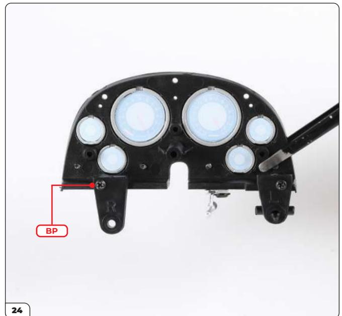
Befestigen Sie die Halterung mit einer BP-Schraube.
