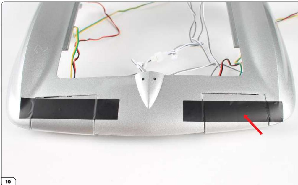
Drehen Sie die Baugruppe um und setzen Sie die Abdeckung auf die gleiche Weise wie zuvor ein. Die Kanten der Abdeckung müssen auch hier wieder bündig mit der vorderen Karosserie abschließen. Kleben Sie die Abdeckung wie gezeigt mit einem langen Klebebandstück fest.
