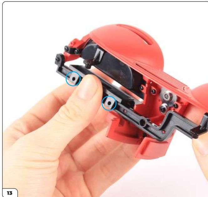
Richten Sie die Schraublöcher am Deckelscharnier auf die Schraublöcher am Rahmen (eingekreist) aus.
