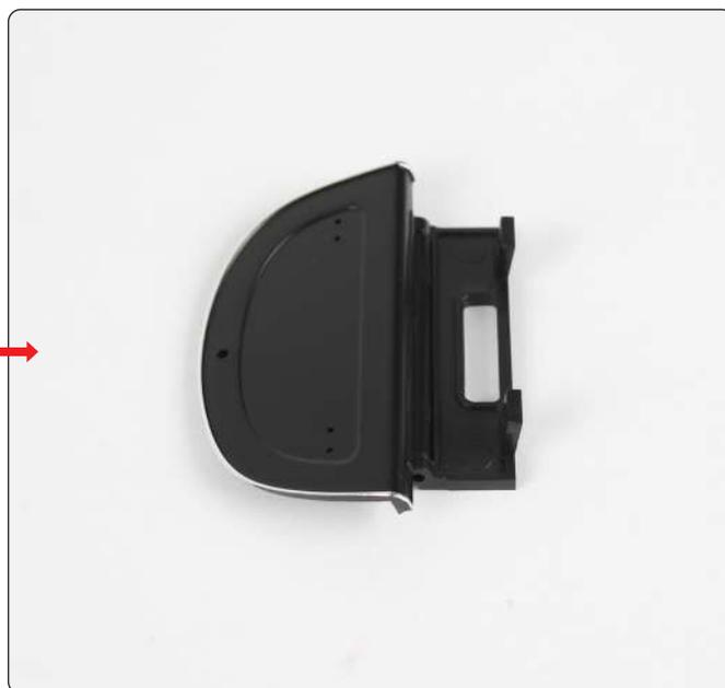
Nehmen Sie den Handschuhfachdeckel, richten Sie ihn wie gezeigt auf das Deckelscharnier aus und setzen Sie die beiden Teile dann wie gezeigt zusammen.
