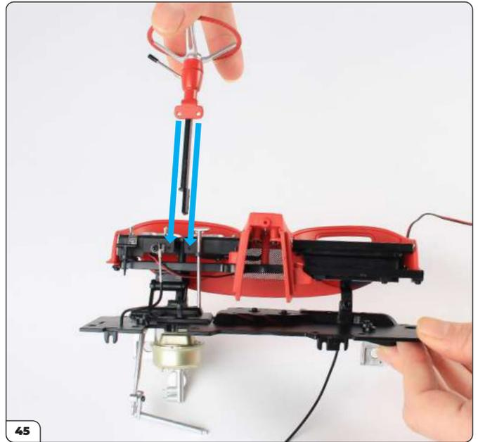
Nehmen Sie die Lenkrad-Baugruppe (Bauphase 74) und positionieren Sie die Basis über den zwei Schraublöchern in der Instrumententafel.
