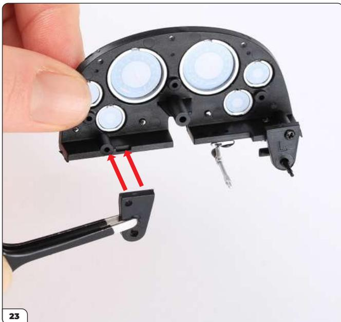
Positionieren Sie die Halterung für die Handbremse (mit „R“ beschriftet) auf die gleiche Weise.
