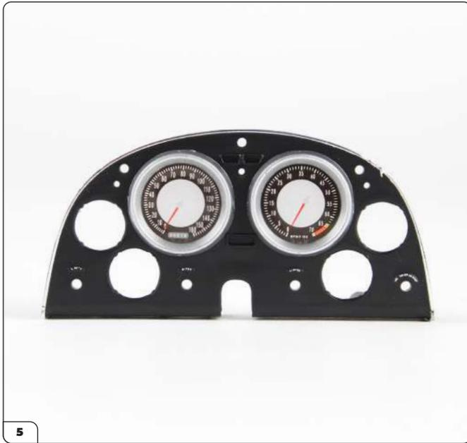
Der Tacho und der Drehzahlmesser sind damit angebracht. Als Nächstes verbauen Sie die kleinen Instrumente.
