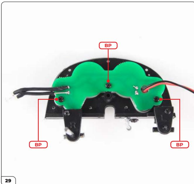
Befestigen Sie die Teile mit 3 BP-Schrauben.
