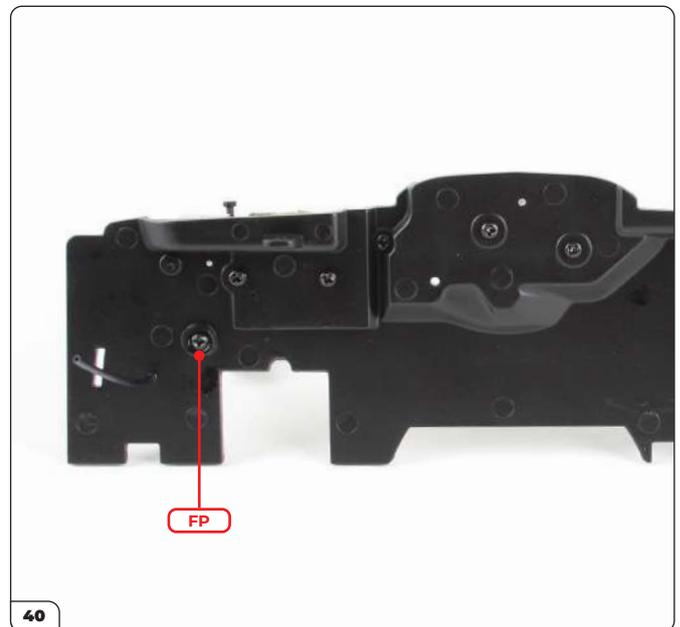
Befestigen Sie die Kupplungsumlenkhebel-Baugruppe von der anderen Seite mit einer FP-Schraube.
