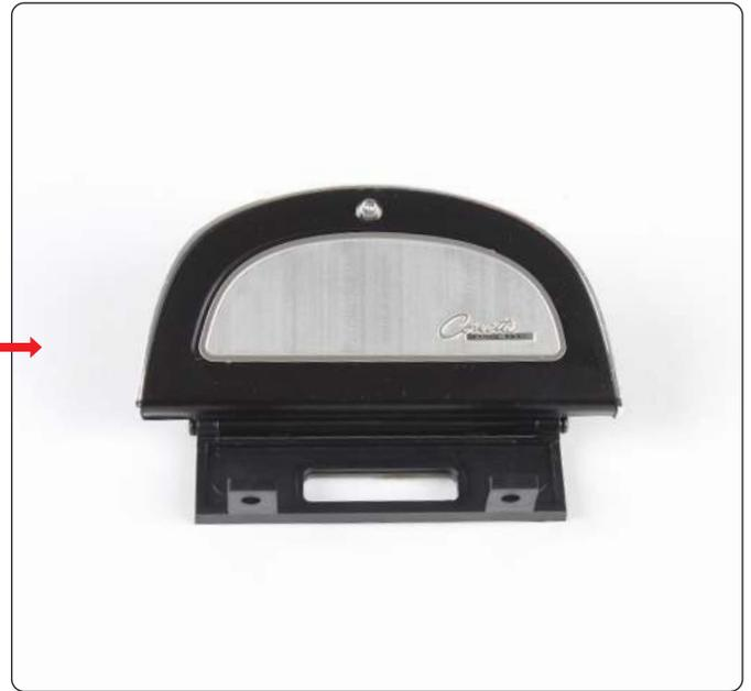
Ziehen Sie die Schutzfolie von der Verzierung für das Handschuhfach ab und kleben Sie die Verzierung dann in die Vertiefung. Drücken Sie die Verzierung fest an.
