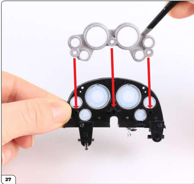
Richten Sie die Verzierung für die Instrumententafel wie gezeigt aus und legen Sie sie dann so auf, dass sie auf den drei Schraubzapfen liegt.
