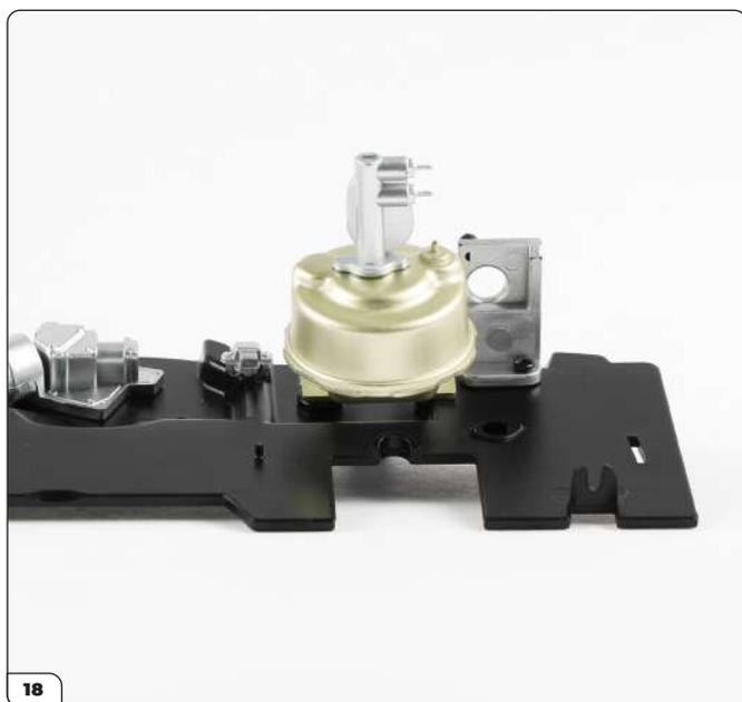
Stecken Sie den Bremskraftverstärker auf.
