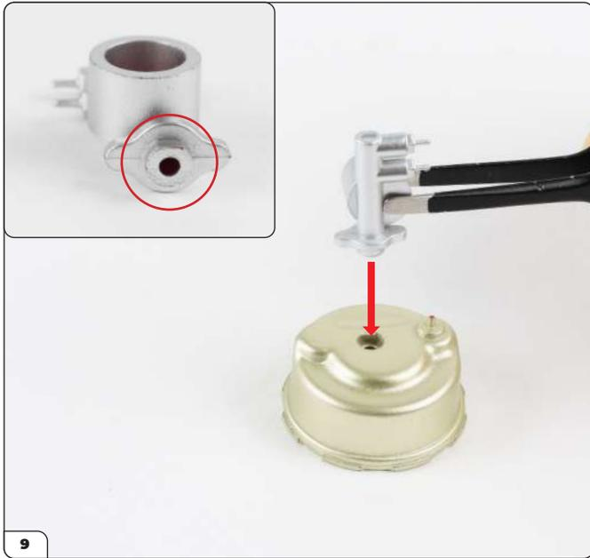
Bringen Sie die Kupplungspumpe mittels des geformten Schraublochs (eingekreist) am Bremskraftverstärker 1 an.
