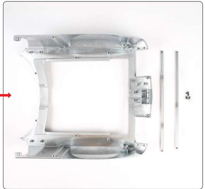
Nehmen Sie die vordere Karosserie und entfernen Sie die eingekreisten Schrauben. Nehmen Sie dann die Stützstangen ab. Die entfernten Stangen und Schrauben können entsorgt werden.
