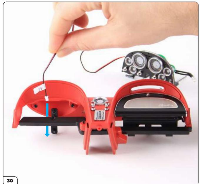
Nehmen Sie die Armaturenbrett-Baugruppe (Bauphase 76) und fädeln Sie den Stecker von LED-Kabel „A3“ wie gezeigt durch die Lücke zwischen dem Rahmen und dem Panel.
