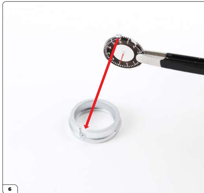
Legen Sie das Zifferblatt für die Uhr mit der Ziffernseite nach unten in den Chromring. Die Lasche am Zifferblatt kommt in die Aussparung im Chromring.
