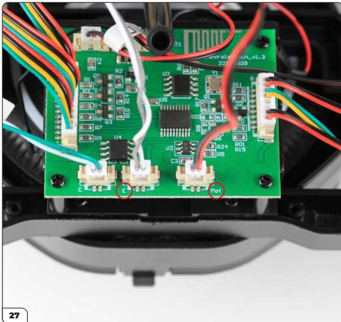
Stellen Sie die Chassis-Baugruppe auf den Arbeitstisch und stecken Sie den Stecker am Schalter in die Buchse auf der Platine, die mit „E“ beschriftet ist. Stecken Sie das Motorkabel in die Buchse, die mit „Mot“ (eingekreist) beschriftet ist.
