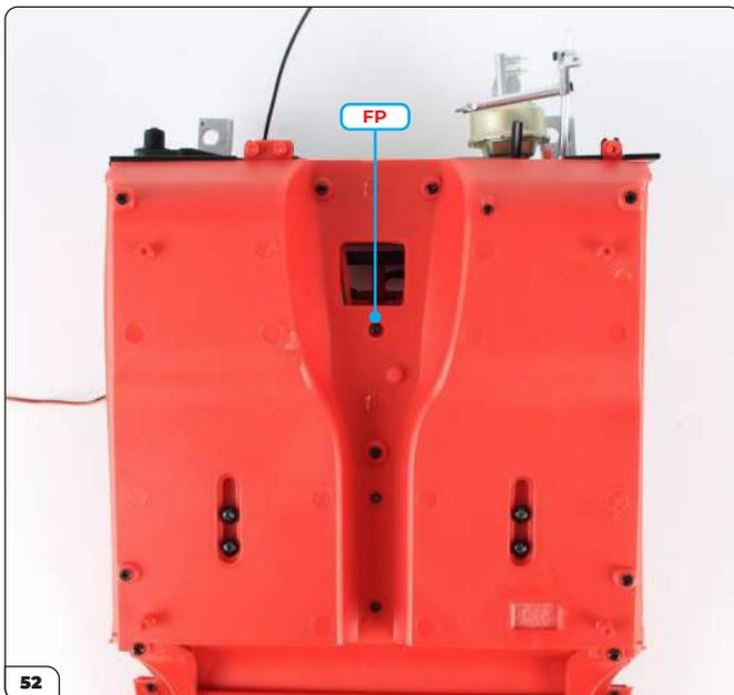
Drehen Sie die Baugruppe um und befestigen Sie das mittlere Paneel mit einer FP-Schraube.
