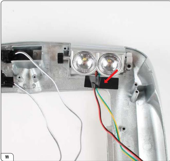
Kleben Sie die Kabel mit einem kurzen Klebebandstück fest.
