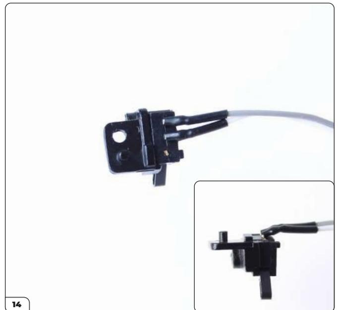
14 Nehmen Sie den Schalter mit dem angebrachten Träger B und biegen Sie die Kabel auf die gleiche Weise wie zuvor.
