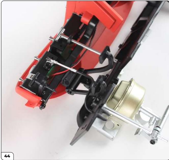
Dieses Bild zeigt den Schlauch, der auf die Motorhaubenverriegelung gesteckt wurde.
