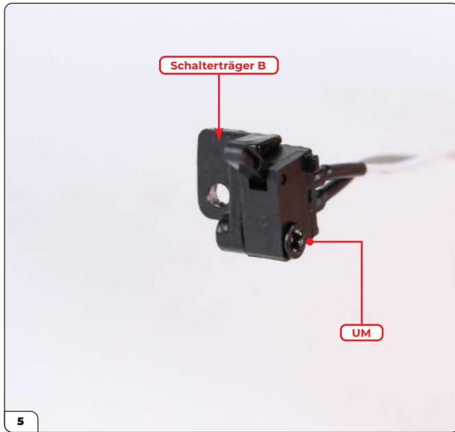
Halten Sie den Träger an den Schalter und befestigen Sie ihn dann, indem Sie eine UM-Schraube in der gleichen Weise von der anderen Seite eindrehen.
