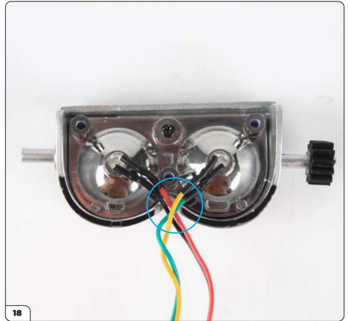
Drehen Sie die LEDs, sodass die Kabel zur Mitte zeigen (eingekreist). Biegen Sie dann die Kabel vorsichtig in die Aussparung. Stecken Sie nun die LEDs fest hinein.
