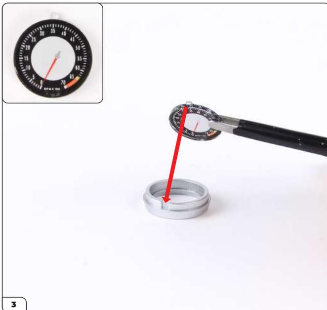
Setzen Sie den Drehzahlmesser (siehe kleines Bild) auf die gleiche Weise mit der Oberseite nach unten in den noch übrigen großen Instrumentring ein.
