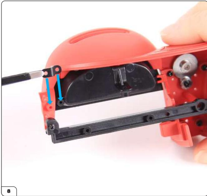
Halten Sie das Handschuhfach fest, drehen Sie die Baugruppe um und positionieren Sie die Halterung über den Schraublöchern.
