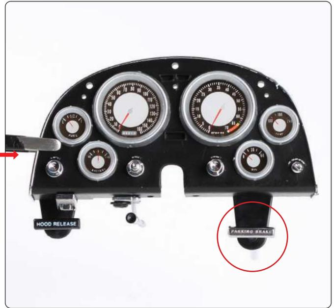
Stecken Sie die Stange der Handbremse in die Halterung. Vergewissern Sie sich, dass der Text richtig herum ausgerichtet ist (siehe Abbildung).
