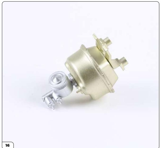
Der Bremskraftverstärker ist damit zusammengebaut.
