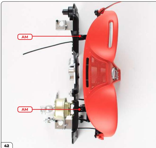
Verschrauben Sie die beiden Baugruppen mit 2 AM-Schrauben.
