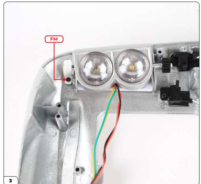
Befestigen Sie die Halterung mit einer FM-Schraube. Vergewissern Sie sich, dass die Halterung fest sitzt.
