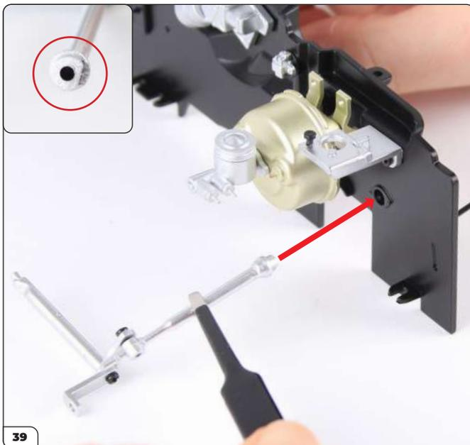
Nehmen Sie die Kupplungsumlenkhebel-Baugruppe (Bauphase 72) und stecken Sie den geformten Pfosten (eingekreist) in das Loch in der Spritzwand (Bauphase 75).
