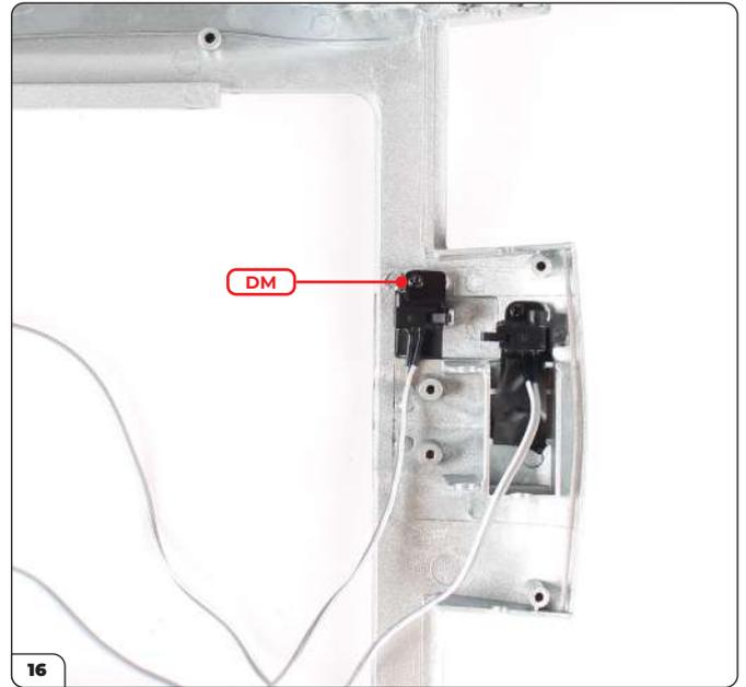
Befestigen Sie den Schalter mit einer DM-Schraube.
