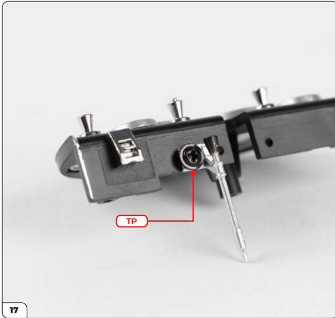
Befestigen Sie die Motorhaubenverriegelung mit einer TP-Schraube.
