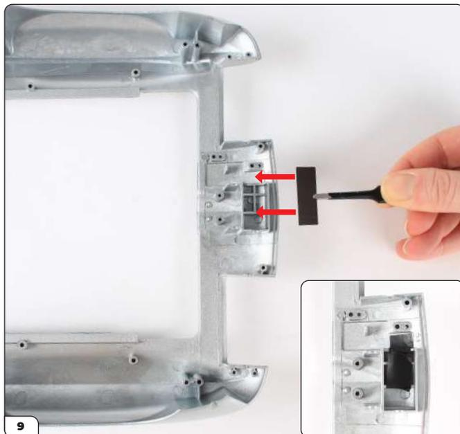
Ziehen Sie die Schutzfolie vom großen Klebebandstück ab und kleben Sie das Klebebandstück wie im kleinen Bild gezeigt an die vordere Karosserie.
