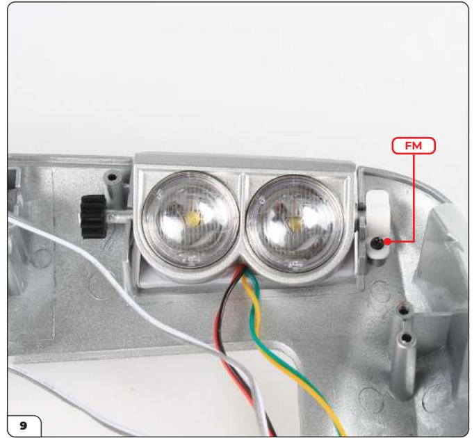
Befestigen Sie die Halterung mit einer FM-Schraube.
