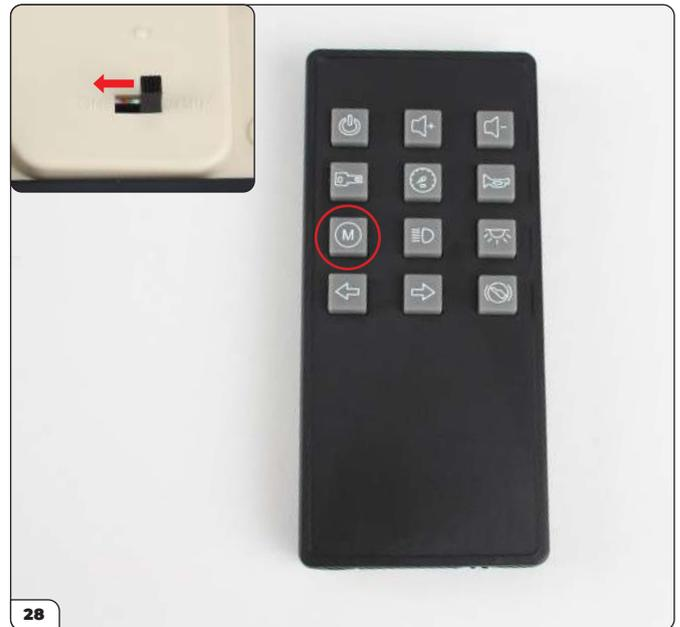
Schieben Sie den Ein/Aus-Schalter auf „EIN“ (siehe kleines Bild) und nehmen Sie die Fernbedienung. Sie testen die Scheinwerfer mit der Taste „M“ (eingekreist).
