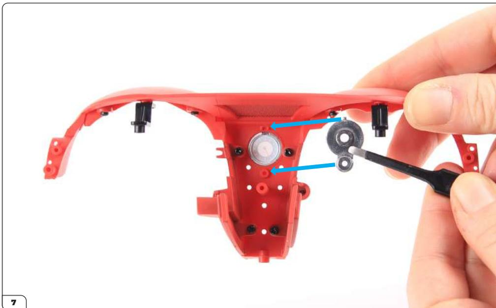
Bringen Sie den Reflektor für die Uhr auf der Rückseite des Armaturenbretts an.
