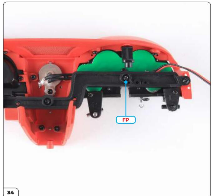
Halten Sie die Instrumententafel fest, drehen Sie die Baugruppe um und befestigen Sie die Instrumententafel dann mit einer FP-Schraube.
