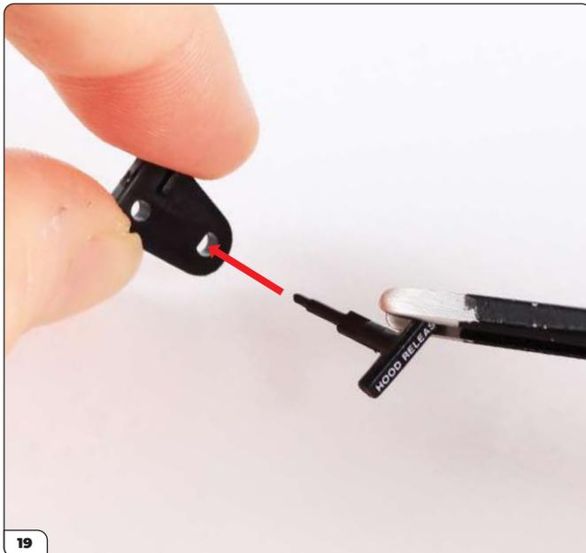
Richten Sie die Teile wie gezeigt aus und stecken Sie dann den Hebel in das geformte Loch in der Halterung.
