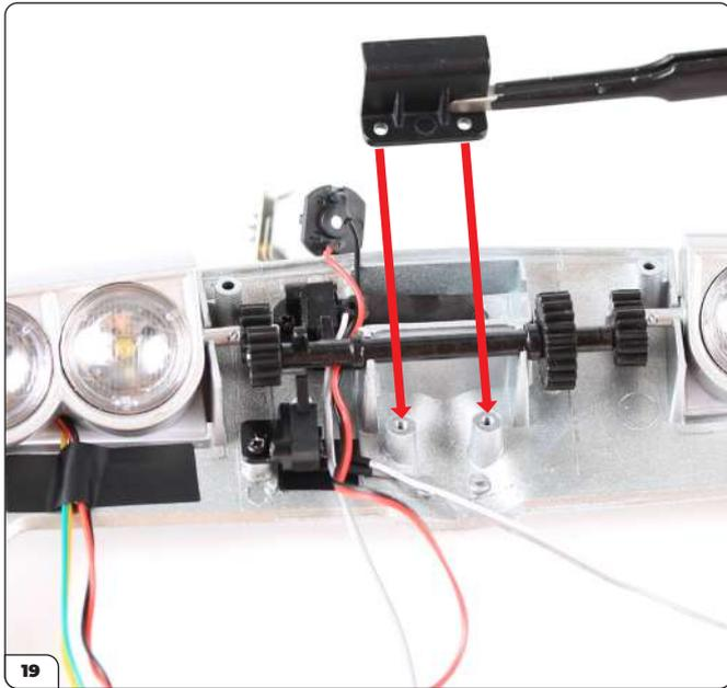
Legen Sie die Halterung für die Welle auf die Schraubzapfen.
