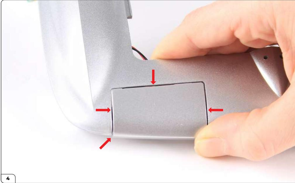
Drehen Sie die Baugruppe vorsichtig um und positionieren Sie die Scheinwerferabdeckung dann wie im Bild gezeigt. Die Kanten der Abdeckung müssen bündig mit der vorderen Karosserie abschließen.
