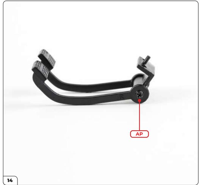
Befestigen Sie das Bremspedal mit einer AP-Schraube.
