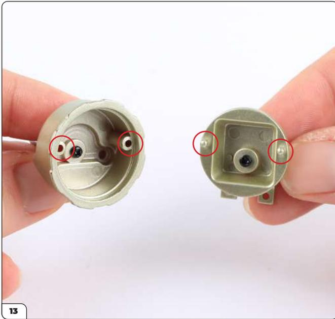
Stecken Sie die Stifte an Bremskraftverstärker 2 in die Löcher an Teil 1.
