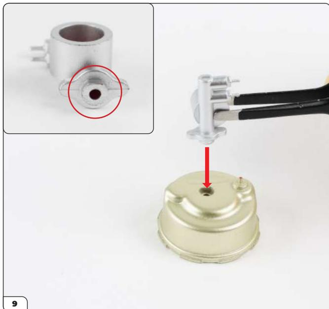
Montez la pompe d'embrayage sur le servofrein 1 à l'aide du trou de vis profilé (entouré sur la photo).
