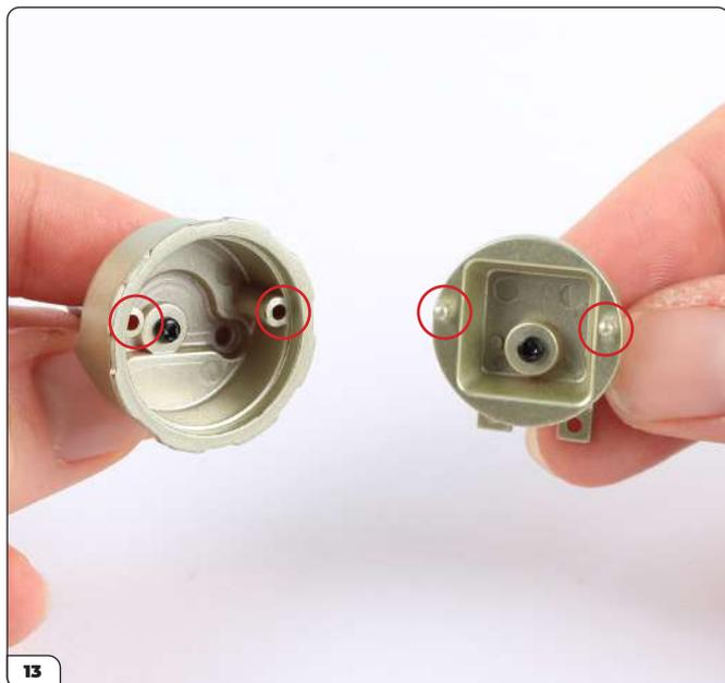
Pressez les broches sur le servofrein 2 dans les trous sur la pièce 1.
