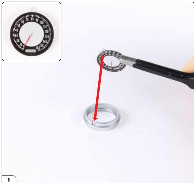
Prenez le compteur de vitesse (cf. encadré) et pressez-le face vers le bas dans une garniture de grand gabarit en enfonçant la languette dans l'ouverture.
