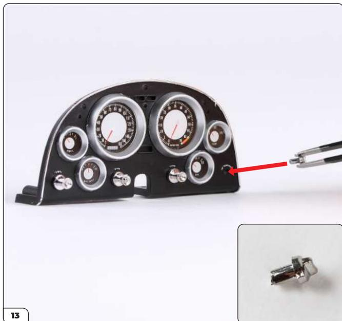
Installez le contacteur de démarrage (cf. encadré) dans le dernier trou.
