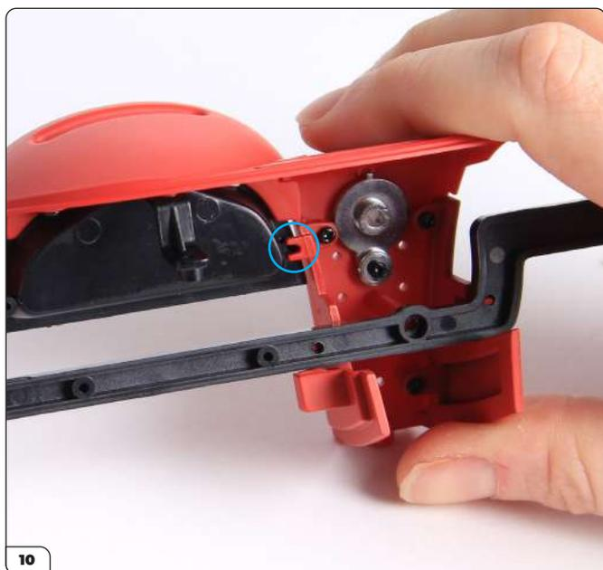
Ajustez la position jusqu'à ce que les trous de vis soient alignés avec la languette (entourée sur la photo).
