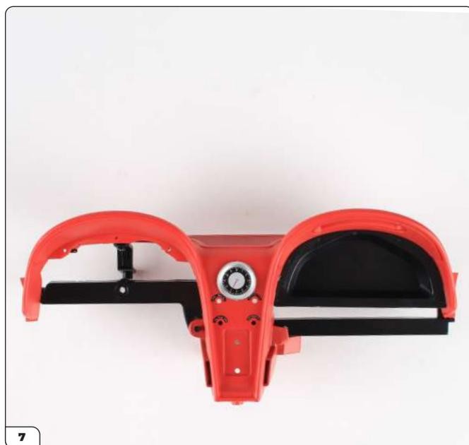
Positionnez l'intérieur de la boîte à gants sur le tableau de bord.
