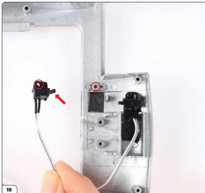
Alignez l'interrupteur avec la carrosserie avant, tel qu'illustré. Les gros trous de vis correspondent et le levier de l'interrupteur est dirigé vers l'avant de la carrosserie.
