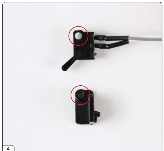
Prenez le support de microrupteur B et alignez-le avec l'autre microrupteur tel qu'indiqué.
