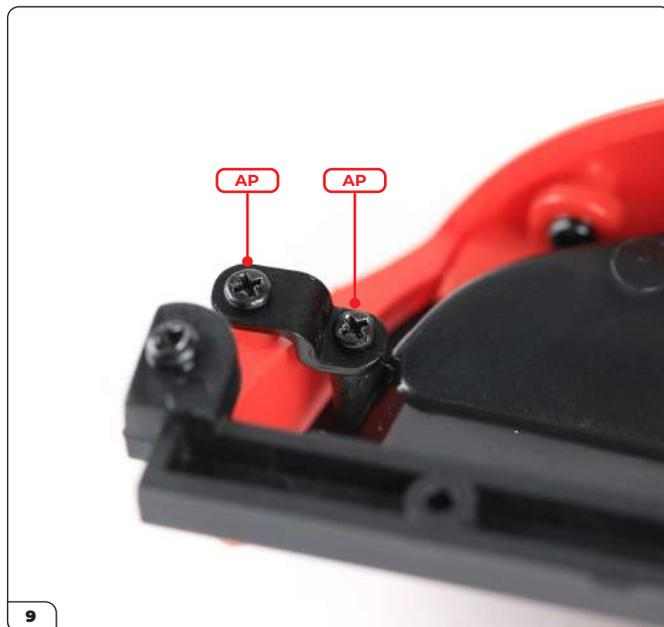
Enfoncez 2 vis AP dans le support. Ne serrez pas encore les vis à fond.
