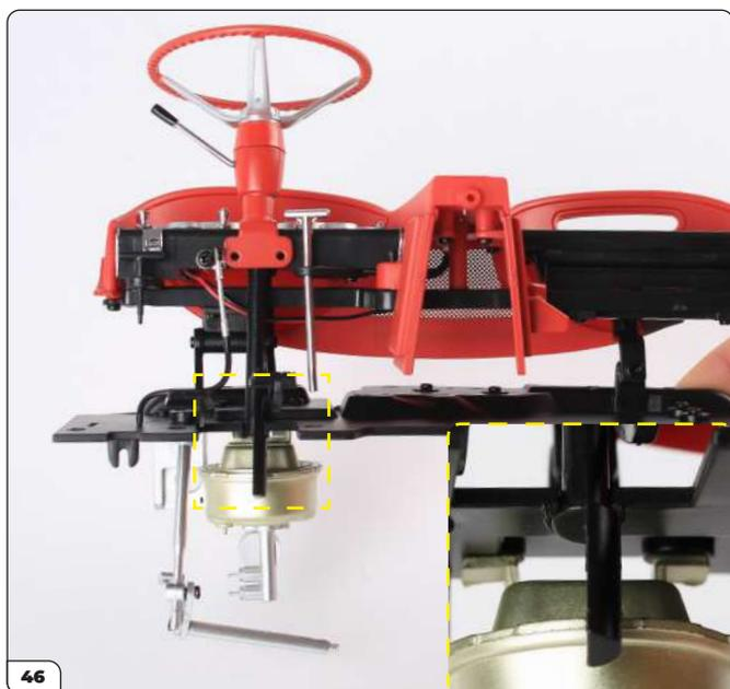
Insérez la colonne de direction dans le renforcement prévu à cet effet sur le tablier (cf. encadré).
