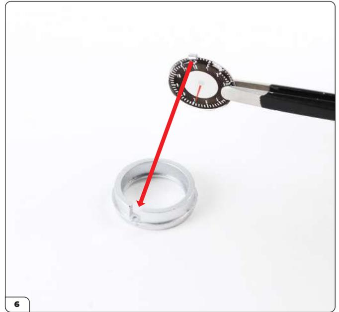
Montez la lentille d'horloge face vers le bas dans le cerclage chromé en pressant la languette dans l'ouverture.
