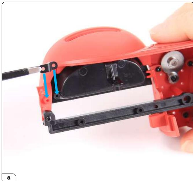
Tout en maintenant l'intérieur de la boîte à gants en place, tournez l'ensemble et positionnez le support au-dessus des trous de vis.
