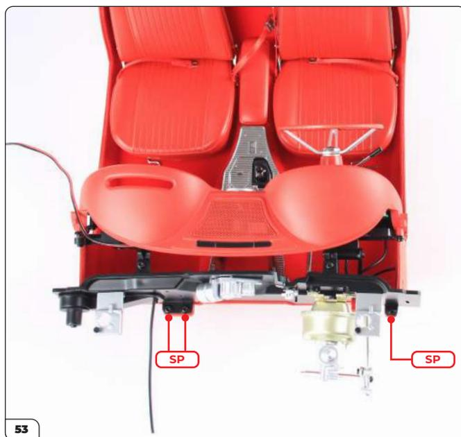
Redressez l'ensemble et fixez le tablier au cockpit avec 3 vis SP.
