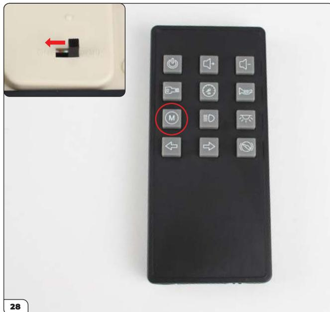
Faites glisser l'interrupteur sur « ON » (cf. encadré) et prenez la télécommande. Vous allez mettre à l'essai les phares avec la touche « M » (entourée).
