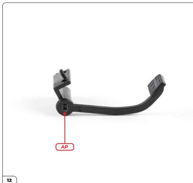
Positionnez la pédale d'embrayage sur le trou de vis profilé puis fixez-la avec une vis AP.
