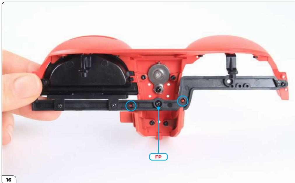
Fixez en enfonçant une vis FP dans le milieu du cadre. Pour maintenir les panneaux latéraux fermement en place, vous pouvez appliquer une petite goutte de superglue sur les broches (entourées sur la photo).
