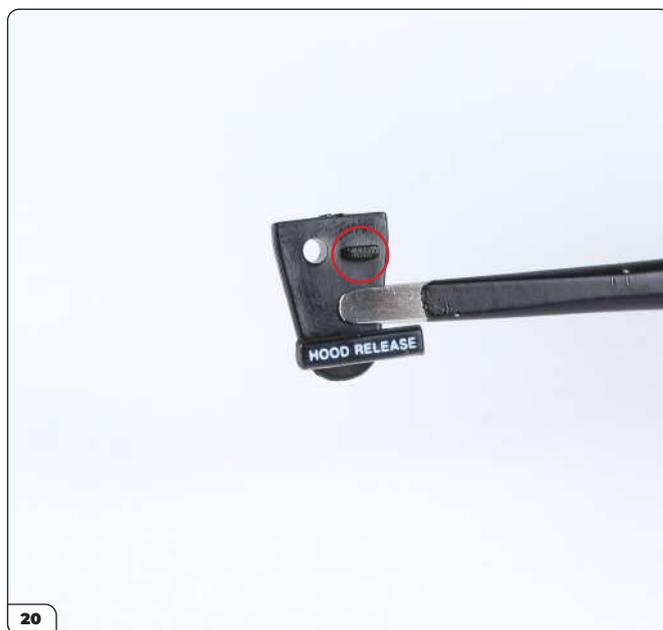
Notez l'emplacement de la languette sur le support (entourée sur la photo).
