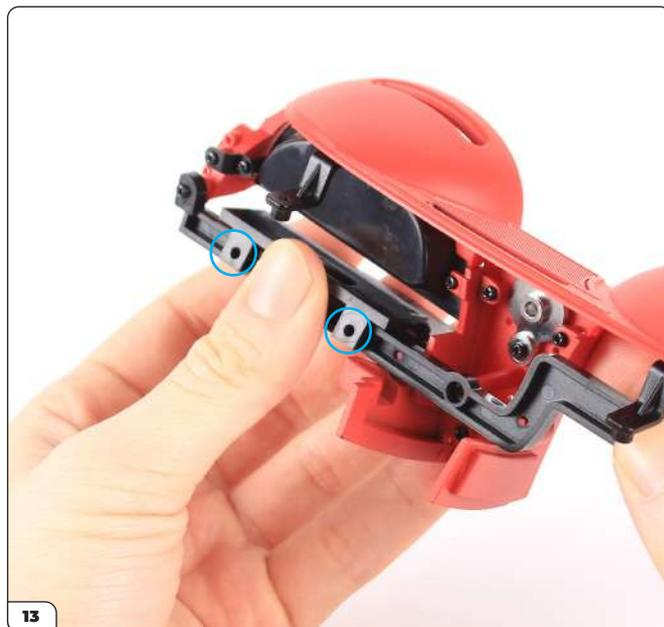
Alignez les trous de vis dans le joint de couvercle et le cadre (entourés sur la photo).
