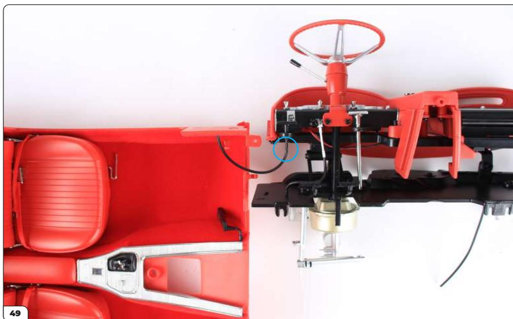
Insérez le tuyau sur le levier. Vous pouvez appliquer de la superglue sur les broches afin d'empêcher le tuyau de se déconnecter lors des étapes suivantes.
