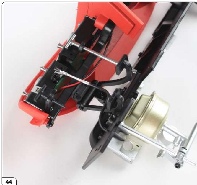
Cette image montre le tuyau inséré sur le loquet de capot.
