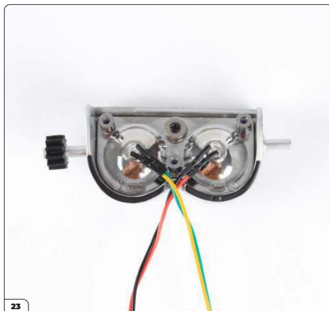
Tournez les ampoules de sorte que les fils soient orientés vers le centre (entouré sur la photo) puis pliez délicatement les fils dans le renforcement. Appuyez fermement sur les ampoules pour les mettre en place une fois que vous êtes satisfait(e).
