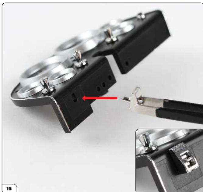
Enfoncez le commutateur de phares dans le trou correspondant sur la partie inférieure du panneau d'instruments.
