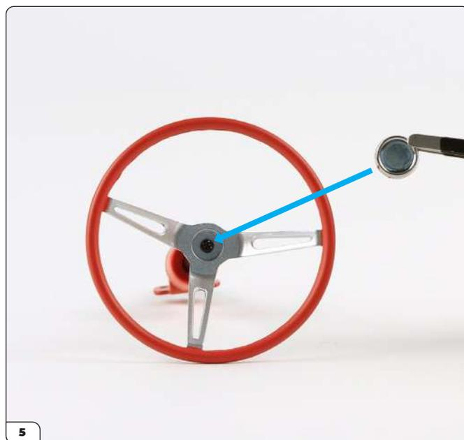
Pressez le bouton du volant dans le centre du volant pour couvrir la vis.
