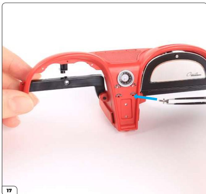
Prenez l'un des commutateurs du tableau de bord et pressez-le dans le tableau de bord.
