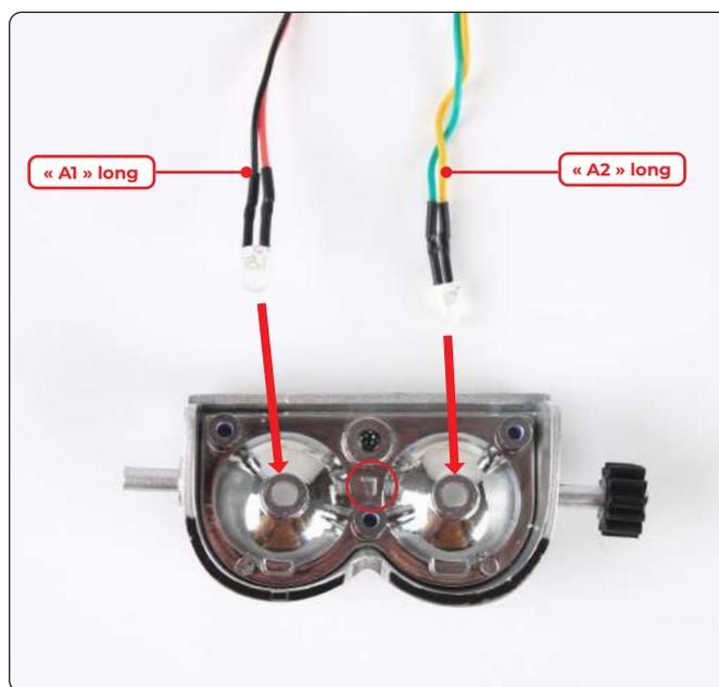
Alignez les LED sur les fils longs avec le réflecteur de phare gauche, tel qu'illustré. « A1 » est aligné avec le phare extérieur et « A2 » avec le phare intérieur.
