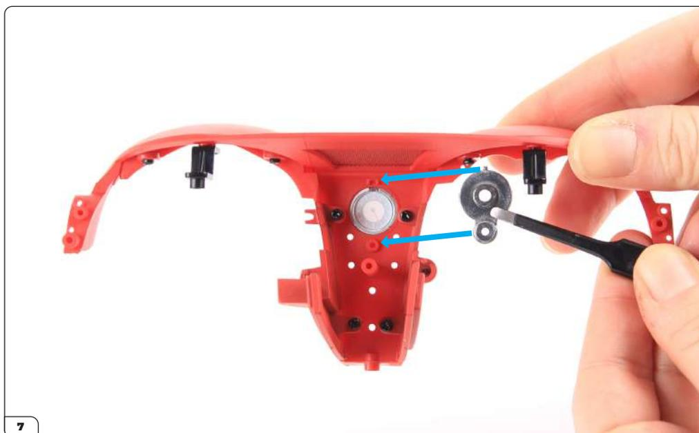
Montez le réflecteur d'horloge sur l'arrière du tableau de bord.
