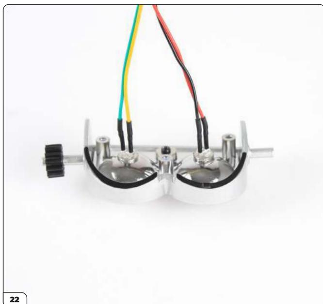
Mettez les ampoules LED en place. Ne poussez pas les ampoules à fond (voir l'étape suivante).
