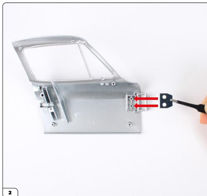
Monta il supporto della cerniera, quindi allinea la piastra di fissaggio della cerniera come mostrato nella foto.
