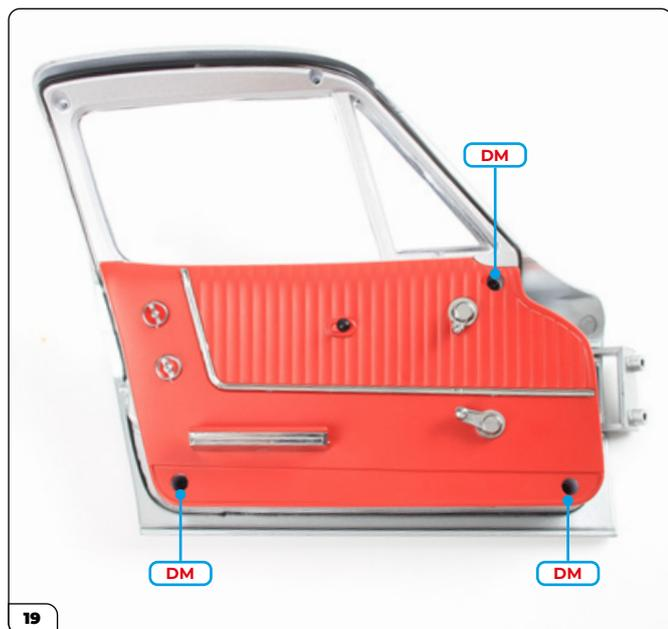
Usa tre viti DM per fissare le due parti.
