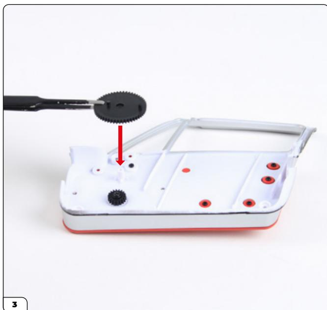
Ora prendi la parte interna della porta assemblata (vedi fase 83) e monta l'ingranaggio grande. Il perno presente sull'ingranaggio deve essere orientato verso l'alto, come mostrato nella foto.
