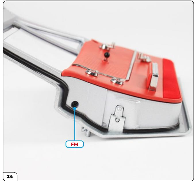
Ora monta una vite FM nel foro che si trova vicino al perno di blocco.
