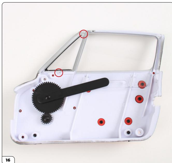
Mettez la vitre de custode gauche en place. Veillez à ce que les broches soient bien positionnées dans les renforcements.
