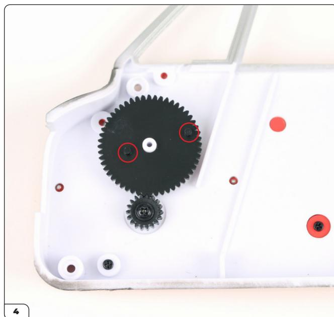
Vérifiez que les dents et les engrenages sont correctement engagés, puis tournez ces derniers de sorte que les broches du large engrenage soient orientées tel qu'indiqué.
