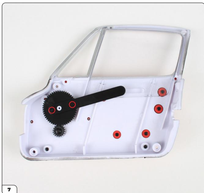
Pressez les petits trous du bras de transmission sur les broches du large engrenage.
