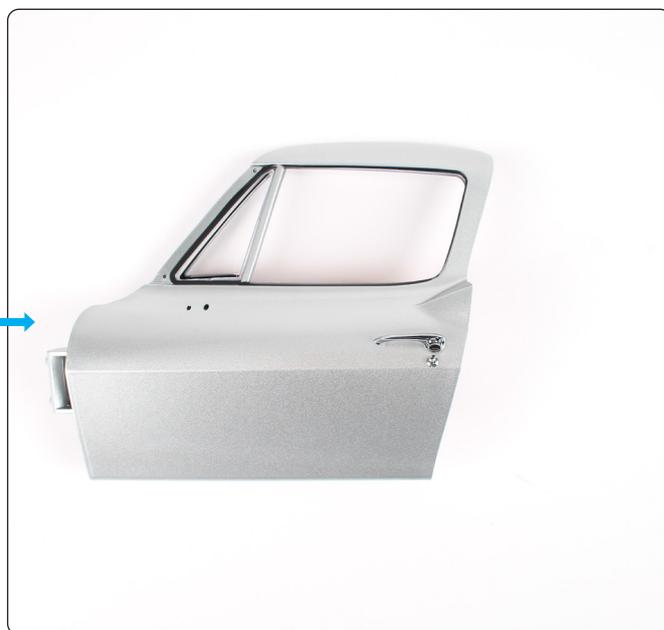
Les fenêtres sont détachées afin de faciliter le montage de la portière sur le panneau. Assemblez les pièces en veillant à ce que les broches de la vitre de custode restent bien en place (voir étape 16).
