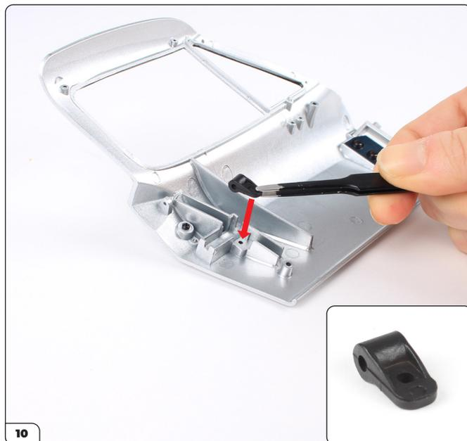
Prenez la portière assemblée à l'étape 82 et alignez la bague de l'ergot d'arrêt avec celle-ci, tel qu'indiqué. Veillez à ce que la bague soit orientée dans le bon sens (cf. encadré).
