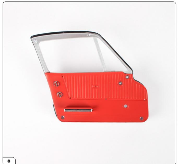
Mettez le panneau intérieur en place en insérant les montants filetés dans les trous.
