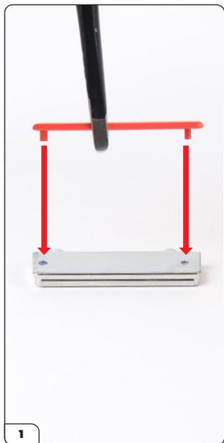
Installez la housse par-dessus l'accoudoir en appuyant. Les broches et les trous sont de tailles différentes afin de garantir un positionnement correct.
