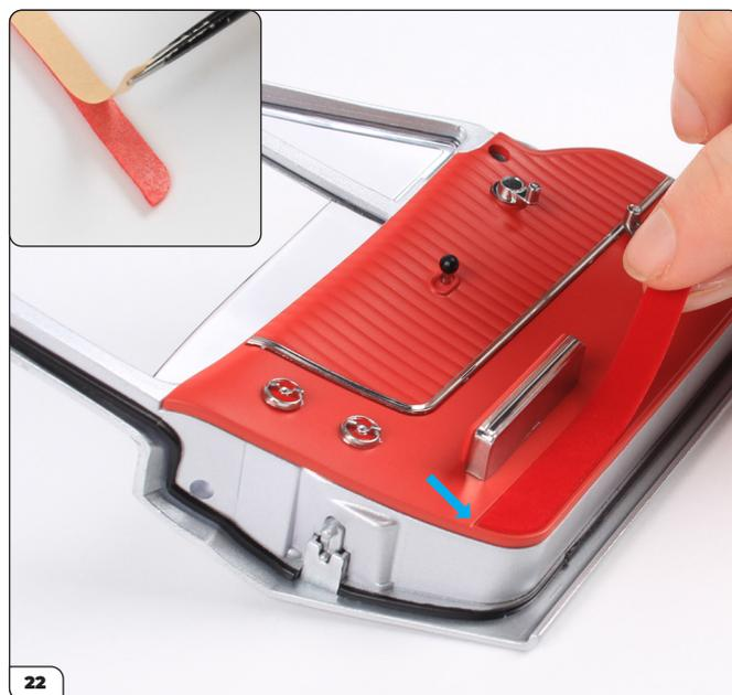
Découlez le film de protection de la garniture moquettée de la portière gauche (cf. encadré), puis collez soigneusement le coin dans le renforcement du panneau intérieur.
