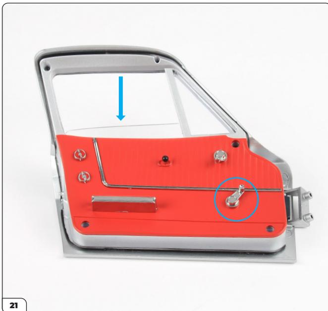
Testen Sie den Fensterheber, indem Sie die Fensterkurbel drehen.
