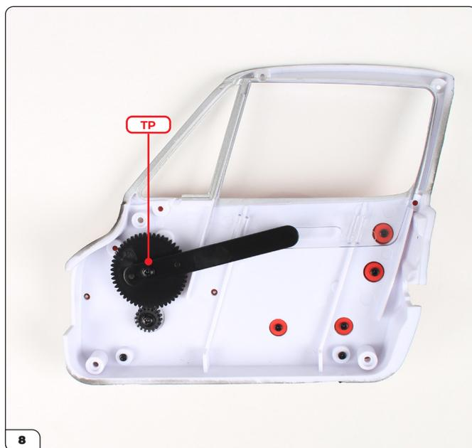
Befestigen Sie den Ritzelarm mit einer TP-Schraube.
