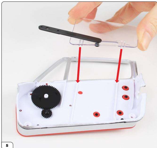
Nehmen Sie die linke Scheibe und richten Sie sie wie gezeigt auf die Baugruppe aus. Die Kanäle in der Scheibe passen über die Rillen im Türblech.
