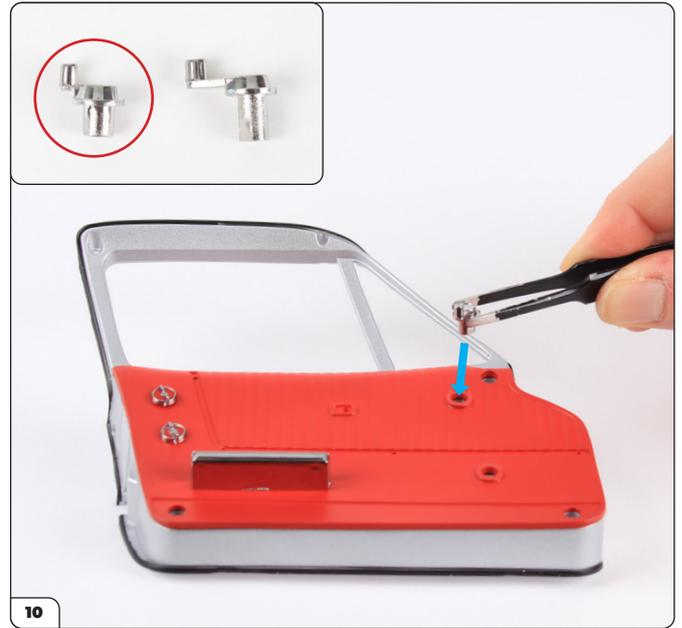
Nehmen Sie die Kurbel für das Dreiecksfenster (eingekreist) und stecken Sie sie in das geformte Loch.
