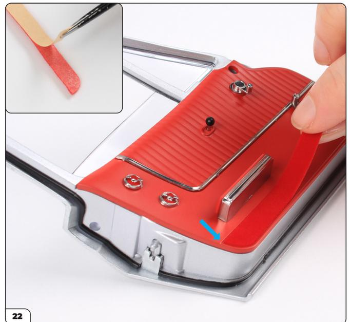
Ziehen Sie die Schutzfolie von der Teppichleiste für die linke Tür ab (siehe kleines Bild) und kleben Sie dann die Ecke vorsichtig an die Türverkleidung.
