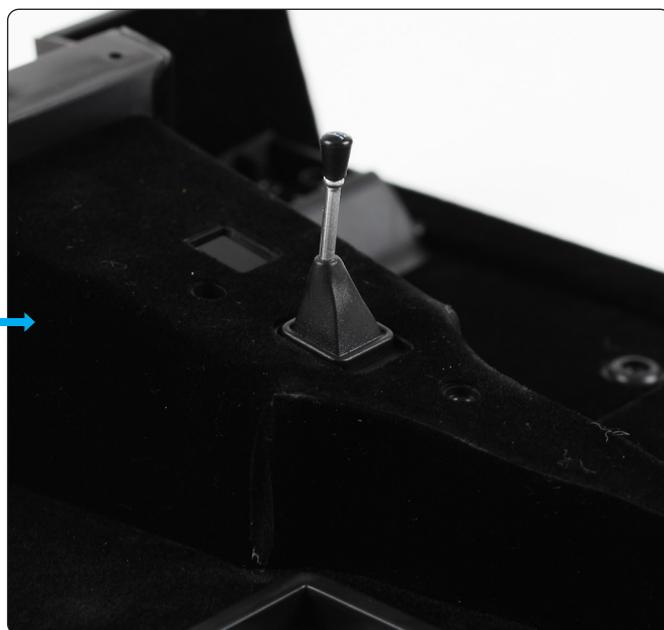
Inserisci la cuffia del cambio nell'apposito alloggiamento sopra il tunnel della trasmissione.
