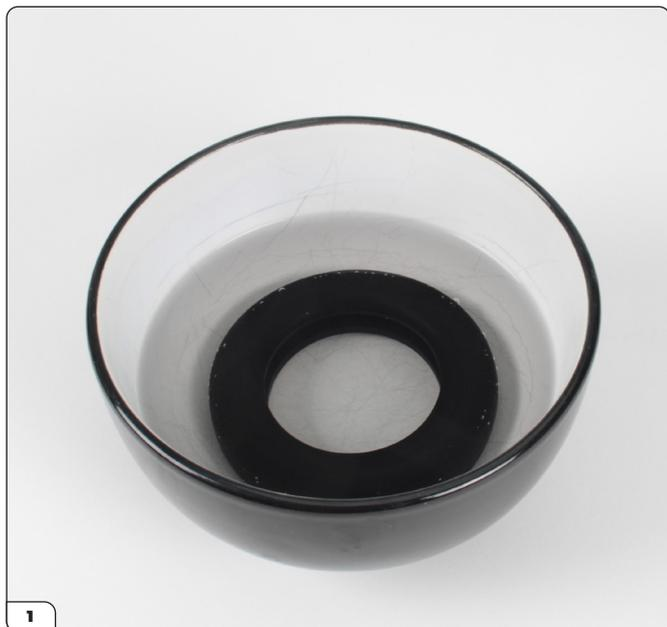
Immergi delicatamente lo pneumatico (41-A) in un recipiente riempito di acqua calda per ammorbidirlo. Fai attenzione, immergendolo, a non far schizzare l'acqua calda.
