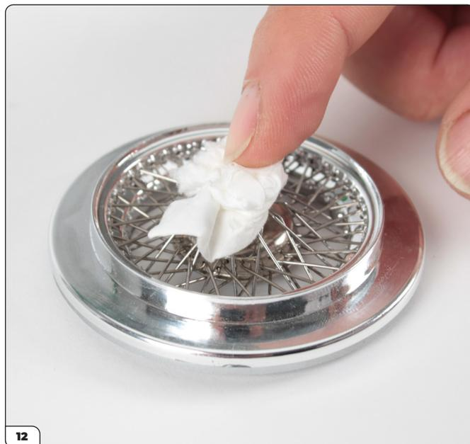
Una volta verificato che tutti i raggi sono stati montati in modo corretto, essi possono essere agganciati ai dentini larghi. Comincia l'operazione spingendo un pezzo di panno carta nel foro del mozzo per mantenere in posizione i raggi.
