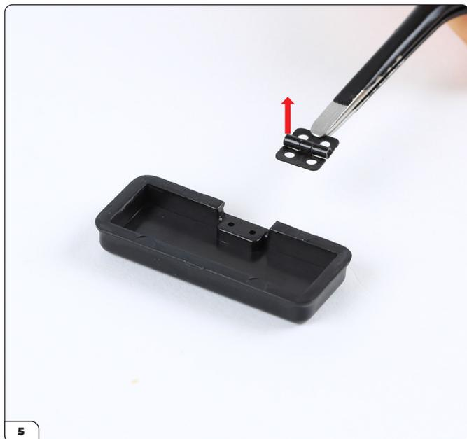
Allinea la cerniera (44-I) e il coperchio della console centrale (44-B). Assicurati che il cilindretto sia orientato verso l'alto come mostrato nella foto.
