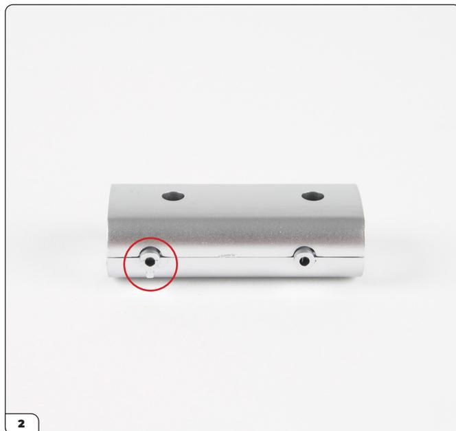
Assembla le due parti usando gli attacchi per le viti in rilievo. Nota il foro sagomato per il montaggio del silenziatore nel passaggio 5.
