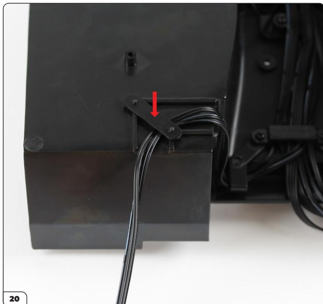
Usa una delle staffe fermacavi (45-C) per fissare i fili, flettendoli in modo da seguire il tracciato della canalina.
