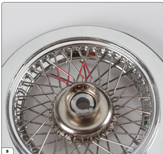
Una volta soddisfatto del montaggio del primo raggio, fanne passare un altro del tipo A attraverso il successivo foro della fila inferiore e attraverso la seconda forma di diamante a partire dalla prima, evidenziata nella foto. In questa fase, le estremità possono essere lasciate libere sul lato opposto.
