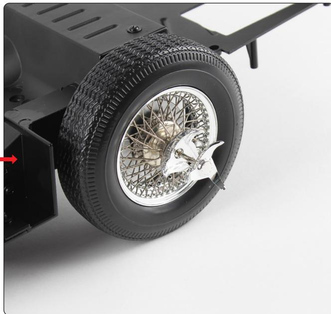
Il montaggio e la lunghezza dell'asse della ruota consentono alla lama tagliagomme di spostarsi verso l'esterno e di ruotare indipendentemente dalla ruota. Prova questi movimenti prendendo il gallettone per una delle alette e tirandolo verso l'esterno.
