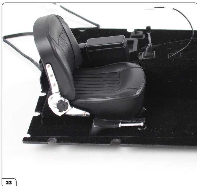
Posiziona il sedile sui quattro punti di montaggio.
