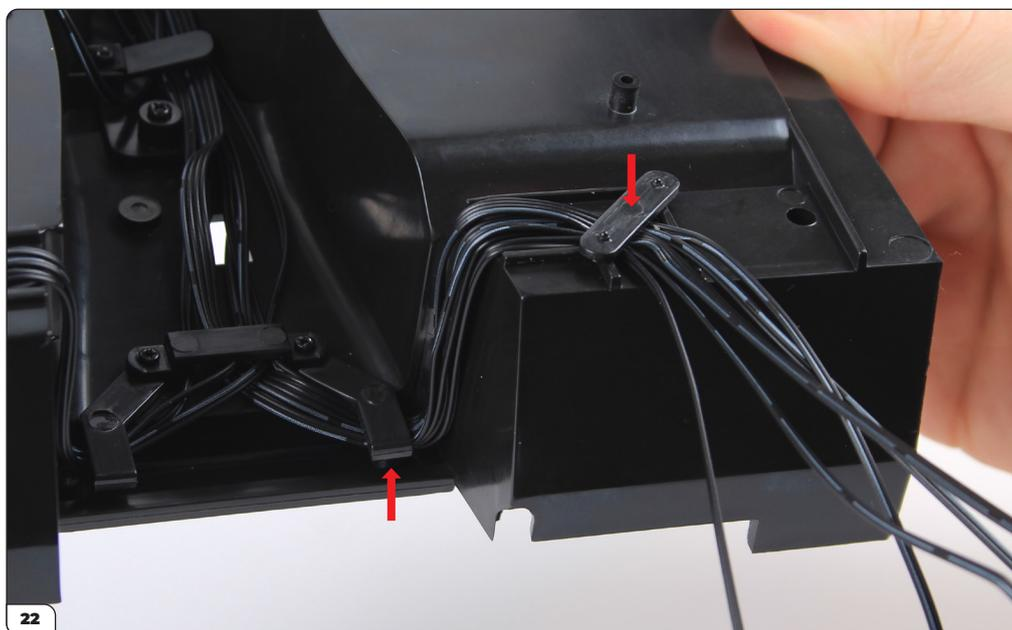
Ripeti la stessa operazione per fissare i cavi nella canalina di destra, servendoti dell'altra staffa apposita (45-C).
