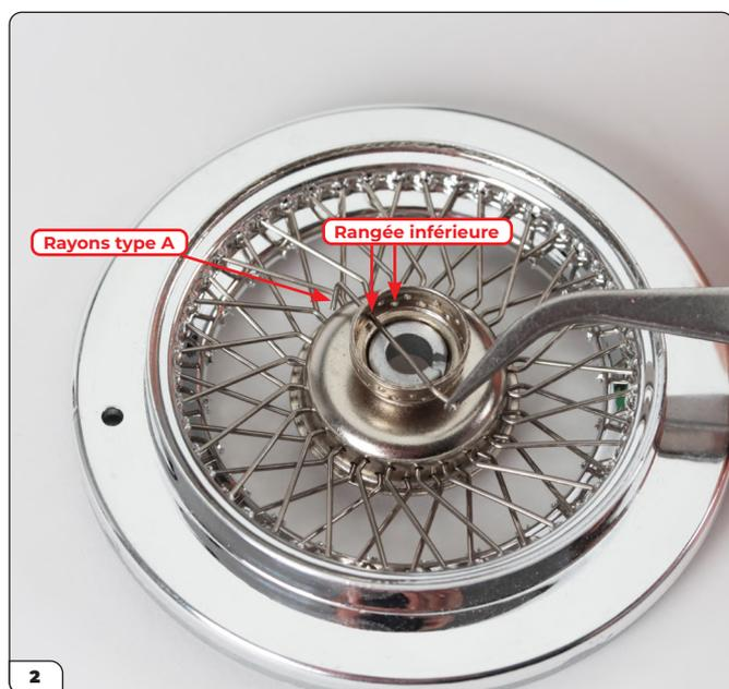
Retournez le groupe et introduisez l'embout d'un rayon de type A dans l'un des trous de la rangée inférieure.
