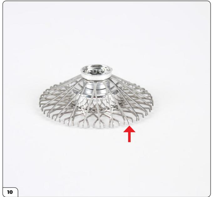
Une fois les rayons assemblés, les extrémités des rayons externes doivent se trouver à l'intérieur des V formés par les extrémités des rayons internes.
