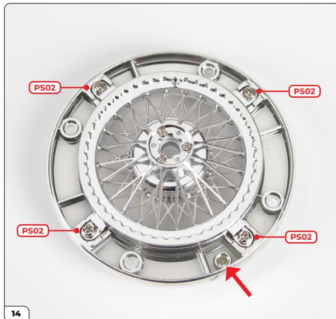
Fixez à l'aide de quatre vis PS02. Faites attention au trou indiqué pour le pivot à l'étape suivante (flèche).
