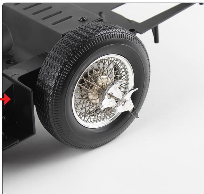
Le montage et la longueur de l'essieu de la roue permettent à la lame de déchetage des pneus de se déplacer vers l'extérieur et de tourner indépendamment de la roue. Testez ces mouvements en prenant le cache moyeu par l'une des ailettes et en la tirant vers l'extérieur.
