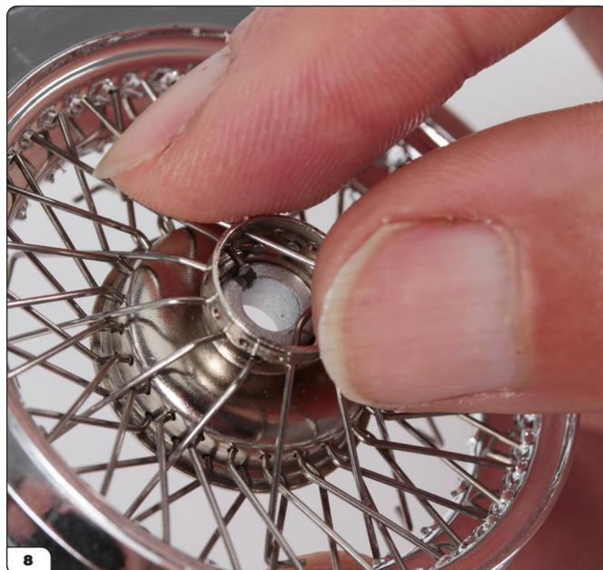
Pressez l'embout à travers le losange avec l'index tout en poussant le rayon en place avec le pouce, comme indiqué sur la photo.
