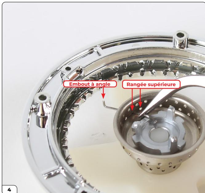
Ouvrez l'un des sachets de rayons (39-D), prenez l'un d'entre eux et passez son embout à angle à travers l'un des trous de la rangée inférieure.
