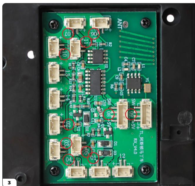
Notez que les logements des connecteurs sur la carte sont marqués par des numéros qui correspondent aux étiquettes des connecteurs. Dans la figure, les logements 01 à 11 sont indiqués par un cercle.
