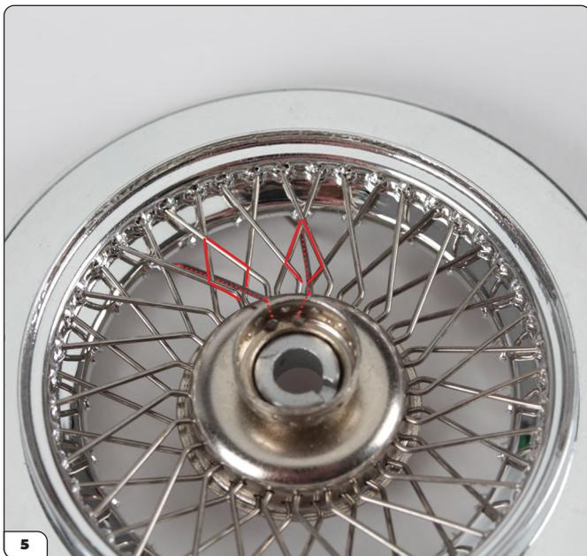
Une fois que vous êtes satisfait de l'assemblage du premier rayon, passez un autre rayon de type A dans le trou suivant de la rangée inférieure et à travers le losange à deux distances du premier, mis en évidence sur la photo. À ce stade, les embouts peuvent être laissées libres sur le côté opposé.
