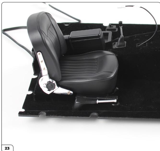
Positionnez le siège sur les quatre points de fixation.
