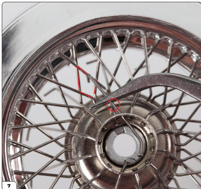
Prenez maintenant un rayon de type B (40-D) et passez-le dans un trou de la rangée supérieure. Croisez-le sur le rayon de la rangée inférieure à sa gauche (entouré) et guidez l'embout vers le losange vide sans rayon (mis en évidence sur la photo).
