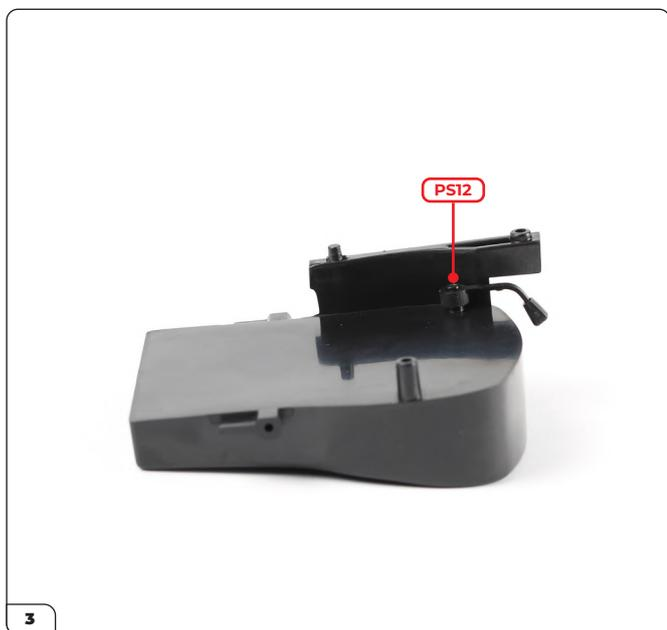
Mettez le levier en place et fixez-le à l'aide d'une vis PS12.
