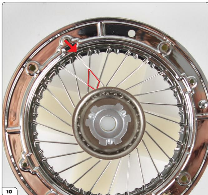
Faites passer un autre rayon par le trou suivant de la rangée supérieure et accrochez l'embout à une autre dent large (flèche). Notez que les rayons créent une forme de losange, mise en évidence sur l'image.
