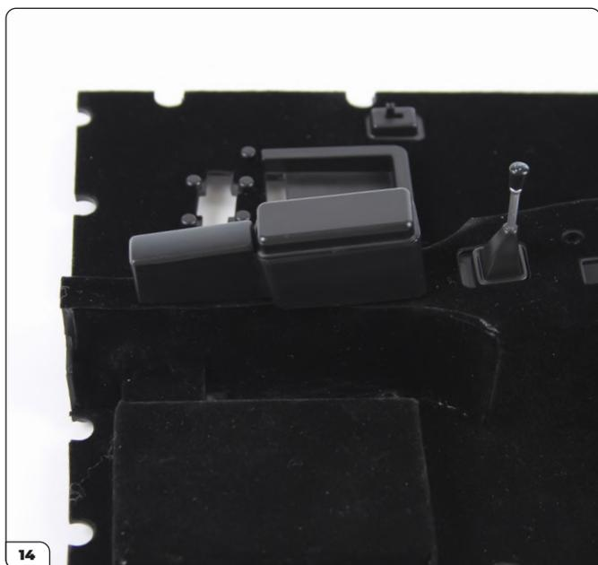
Alignez la console centrale sur le tunnel de transmission et positionnez-la comme indiqué sur la photo.
