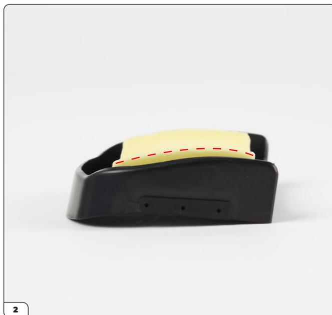
Positionnez le rembourrage de manière à ce que la courbe supérieure s'aligne sur la base, comme indiqué par la ligne en pointillés.
