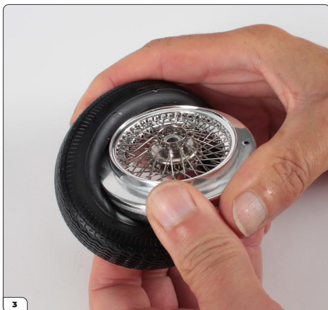
Placez le pneu, tant qu'il est souple, sur la jante assemblée à l'étape 039VB ou à l'étape 040. Appuyez sur le pneu et travaillez ensuite sur les bords pour le positionner correctement.
