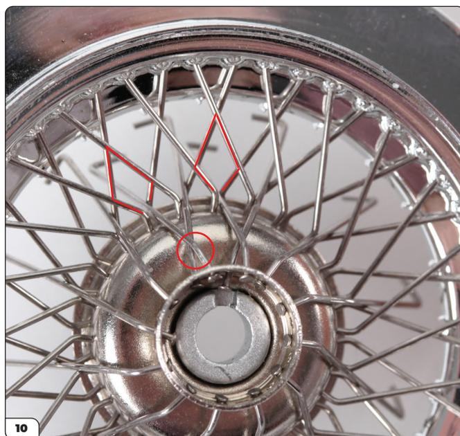
Retournez l'ensemble et passez un autre rayon type B dans le trou suivant de la rangée supérieure, en le faisant passer par-dessus le rayon de type A à sa gauche et en le faisant entrer dans le prochain losange vide à gauche.
