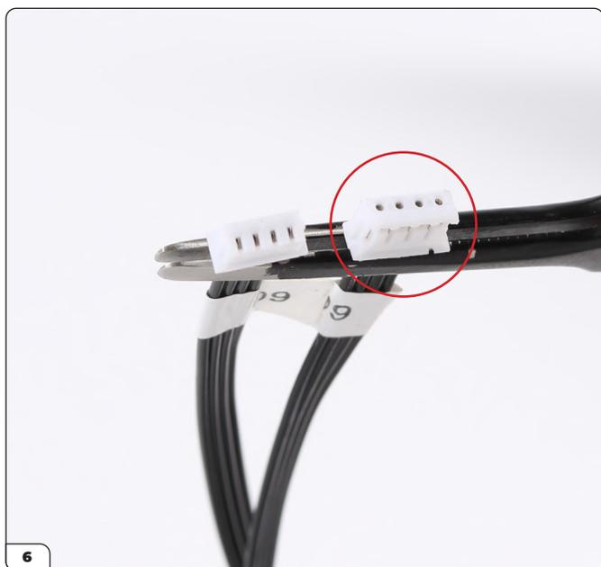
Les connecteurs à 4 broches aux extrémités des câbles 45-K (08) et 45-L (09) sont très similaires. Utilisez le connecteur avec les trous (dans les cercles) pour brancher sur le circuit.
