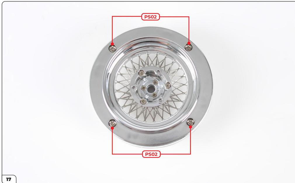
Retournez l'assemblage et fixez-le à l'aide de quatre vis PS02.
