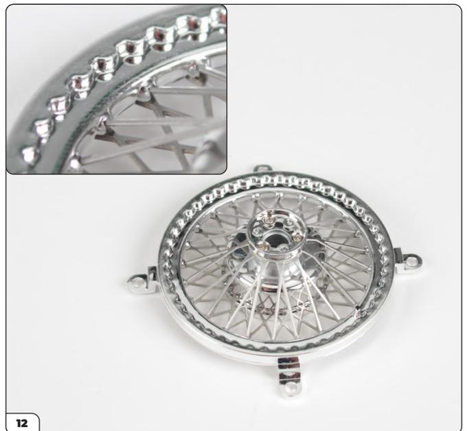
Montez l'anneau de fixation de manière à ce que les rayons externes s'insèrent dans les cavités du bord (détail de la figure). Vérifiez que tous les rayons sont en place.
