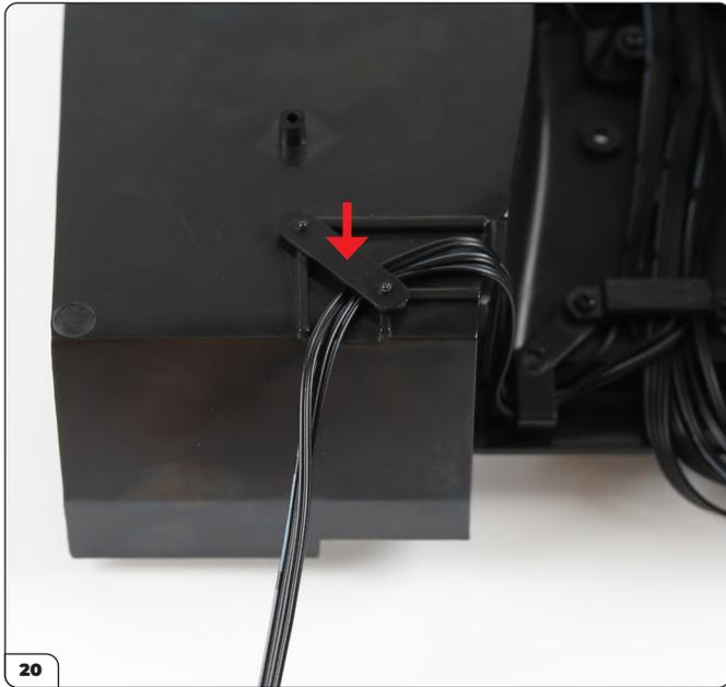
Utilisez l'un des serre-câbles pour rainure (45-C) pour fixer les fils, en les pliant pour qu'ils suivent le tracé de la rainure.
