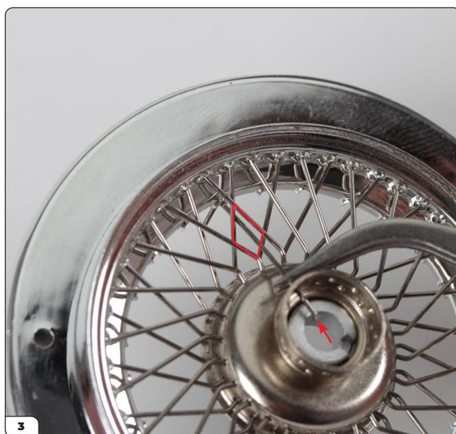
Tirez sur le rayon et guidez l'embout à travers la forme de losange à gauche et vers l'extérieur de l'autre côté.
