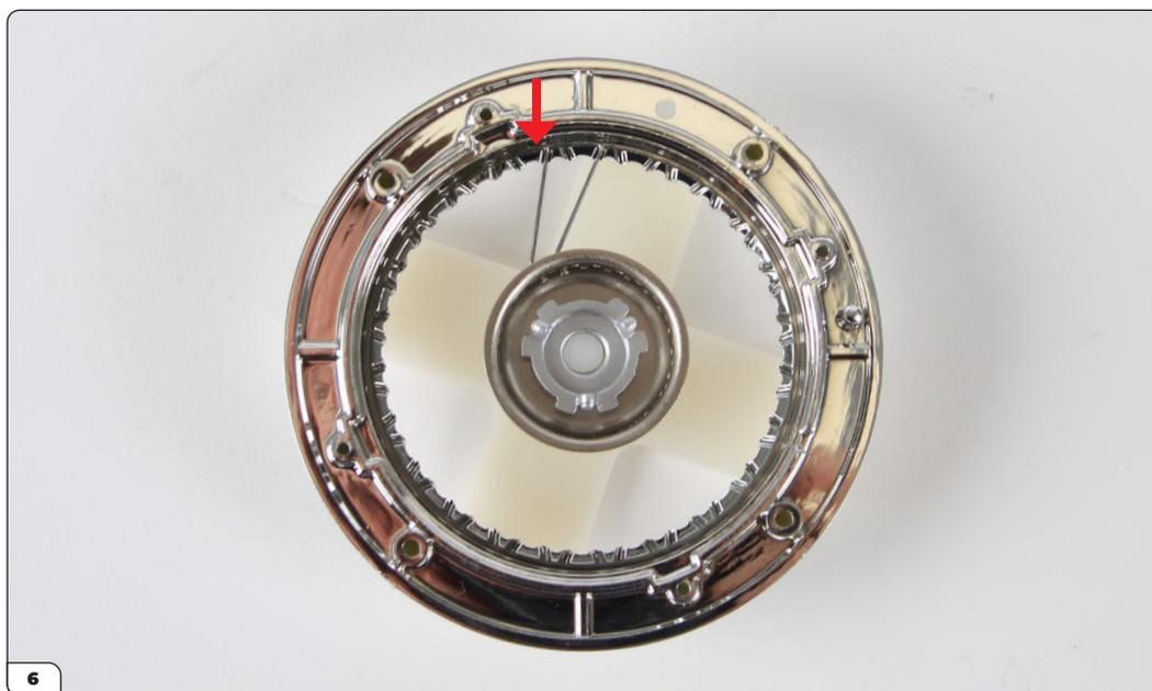
Faites passer un deuxième rayon par le trou suivant dans la rangée inférieure et fixez-le sur la jante externe comme indiqué sur la photo. Au fur et à mesure que vous montez les rayons, réglez la tension en tournant doucement le moyeu avec le pouce.
