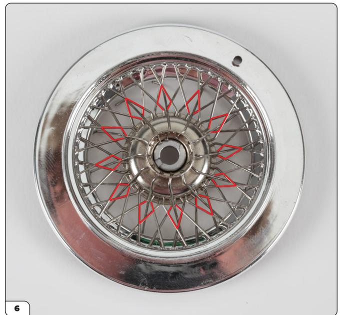
Continuez à faire passer les rayons de type A dans les trous de la rangée inférieure, puis en poussant l'embout dans les losanges successifs, en en sautant toujours un. Continuez à laisser leurs extrémités décrochées pour l'instant, car elles ne doivent pas encore être montées sur les dents larges.
