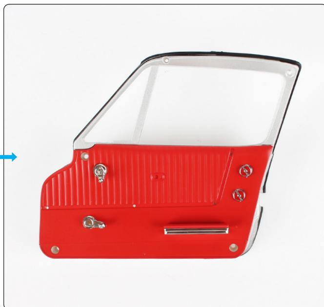
Insérez l'autre manivelle de lève-vitre (la plus grande) dans le trou correspondant, tel qu'indiqué. La rotation de cette pièce permettra de lever ou d'abaisser la vitre. Elle peut donc être montée dans n'importe quel sens.
