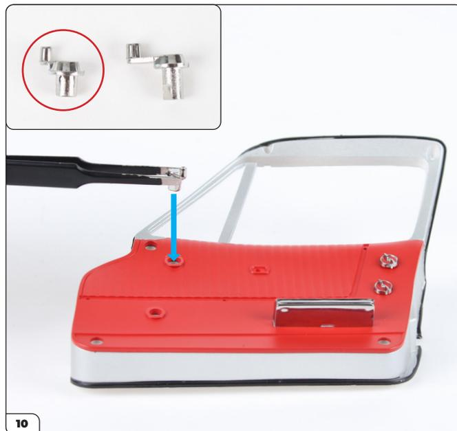
Prenez la petite manivelle du lève-vitre de quart de fenêtre (entourée sur la photo) et insérez-la dans le trou correspondant.
