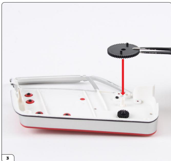
Prenez le panneau intérieur (assemblé à l'étape 88) et installez l'engrenage de la grande fenêtre. Les broches de l'engrenage doivent être orientées vers le haut, tel qu'indiqué.
