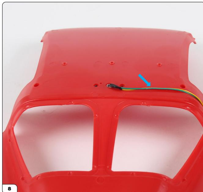
Insérez l'ampoule dans le trou, puis pliez soigneusement les fils et faites-les passer dans la rainure tel qu'indiqué.
