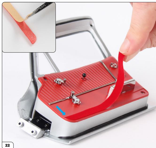
Décolliez le film de protection de la garniture moquettée de la portière droite (cf. encadré), puis collez soigneusement le coin dans le renforcement du panneau intérieur.
