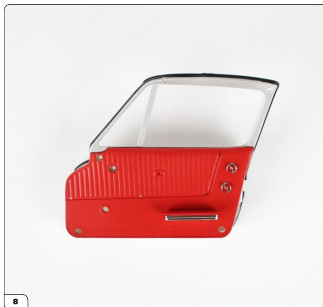
Mettez le panneau intérieur en place en insérant les montants filetés dans les trous.
