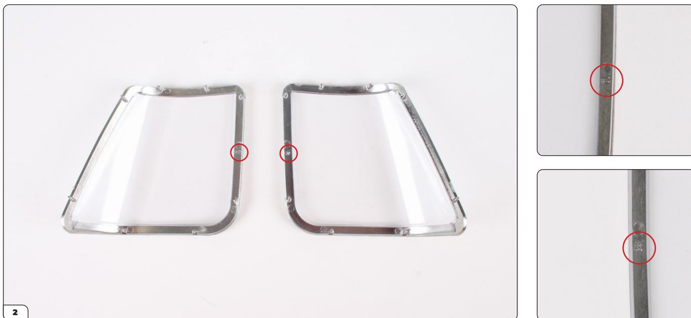
Assemblez la vitre et le cadre de la lunette arrière droite de la même manière. Notez que les cadres sont marqués d'un « L » (gauche) et d'un « R » (droite) (entourés sur la photo) pour vous guider lors du montage sur la carrosserie.
