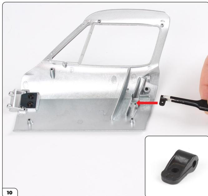
Prenez la portière assemblée à l'étape 87 et alignez la bague de l'ergot d'arrêt avec celle-ci, tel qu'indiqué. Veillez à ce que la bague soit orientée dans le bon sens (cf. encadré).
