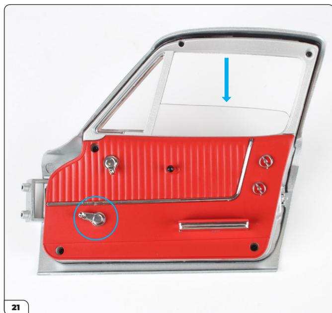
Testez le mouvement de la vitre en tournant la manivelle.
