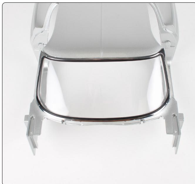
Alignez le cadre du pare-brise avec la carrosserie (étape 85) tel qu'indiqué sur la photo. Insérez les languettes du cadre du pare-brise dans les onglets (cf. flèches) et alignez avec les pas de vis (entourés sur la photo) de la carrosserie.
