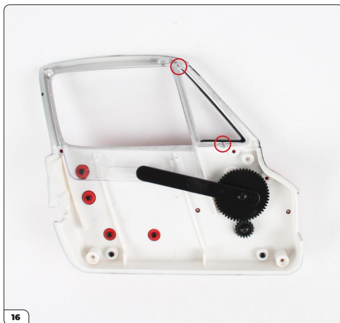
Mettez le quart de fenêtre droite en place. Veillez à ce que les broches soient bien positionnées dans les renforcements.
