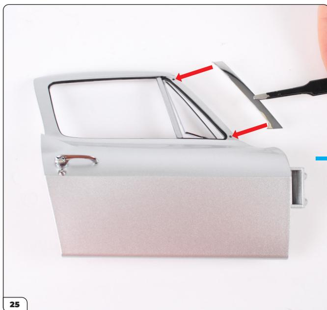
Alignez la garniture chromée de la portière droite avec la section située à côté du quart de fenêtre, tel qu'indiqué. Appuyez fermement sur la garniture pour l'enfoncer dans les deux trous.
