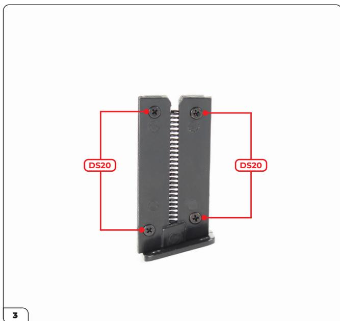
Coloque la cubierta en su lugar y asegúrela con 4 tornillos DS20.
