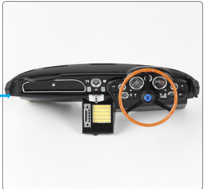
Coloque la cubierta del volante en el tablero de instrumentos (etapa 056). El orificio está moldeado para garantizar la orientación correcta.
