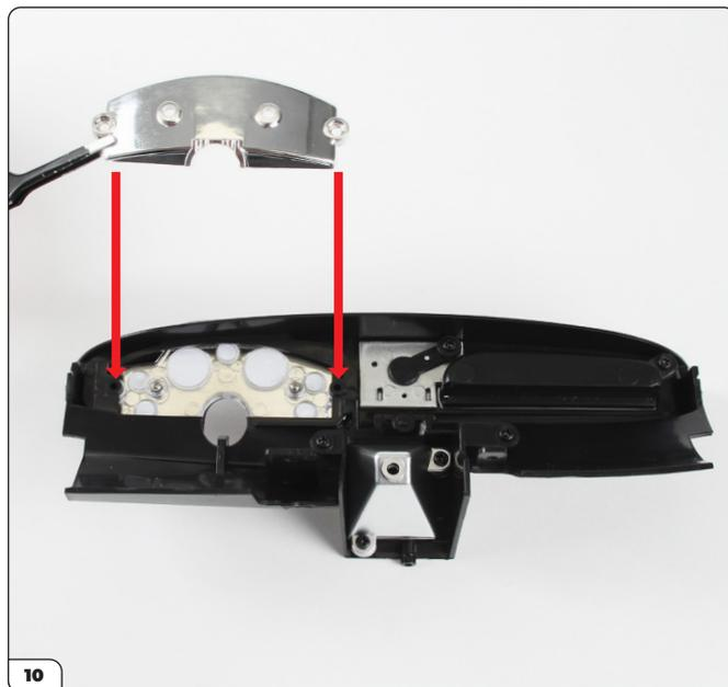
Alinee el reflector de los diales (56-C) con el tablero de instrumentos, tal y como se muestra en la imagen.
