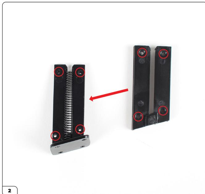
Alinee la cubierta de los carriles guía del eyector (50-B) con el conjunto. Hay cuatro orificios para tornillos en cada pieza (rodeados con un círculo).
