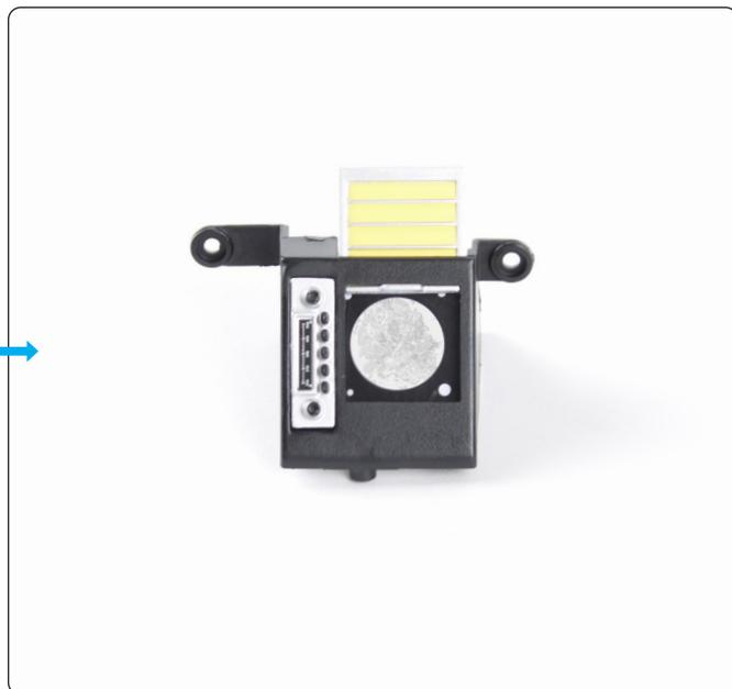
Compruebe que la cubierta del GPS se desliza para abrirse y mostrar la pantalla inferior, tal y como se muestra en la imagen.
