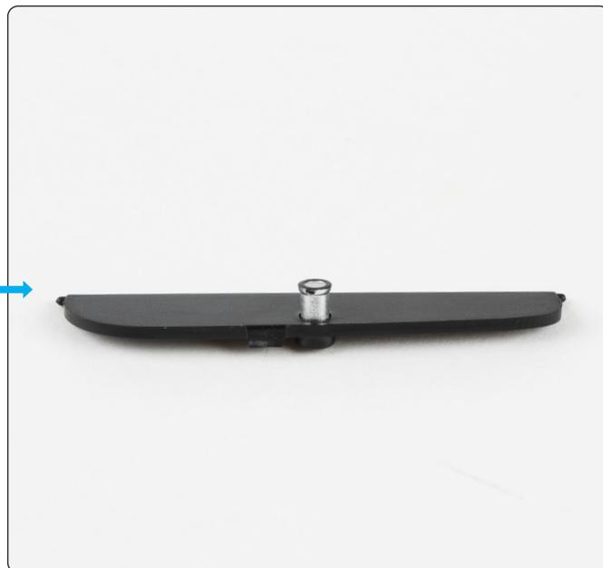
Tome el asa de la tapa de la guantera (54-G) e introdúzcalo en el orificio moldeado de la tapa de la guantera (54-B).
