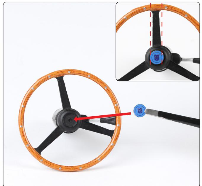
El extremo plano de la columna de dirección se alinea con el radio superior del volante (imagen izquierda). Alinee el emblema del volante (57-E) con el volante y presione para introducirlo en el hueco. El emblema debe quedar alineado con el radio superior (recuadro).
