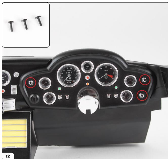
Inserisci i tre pulsanti (56-G, in figura) nelle rispettive sedi (cerchiate) sul telaio del blocco strumentazione.
