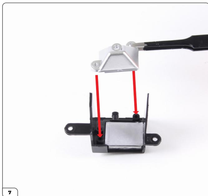
Allinea il riflettore GPS (55-E) ai fori per viti nel telaio.
