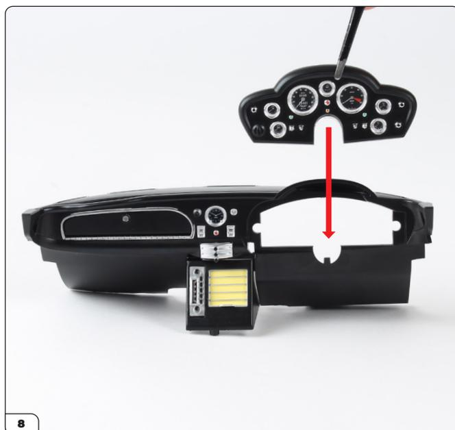
Allinea il telaio del blocco strumentazione all'apposita apertura nel cruscotto (fase 055), come mostrato nella foto.
