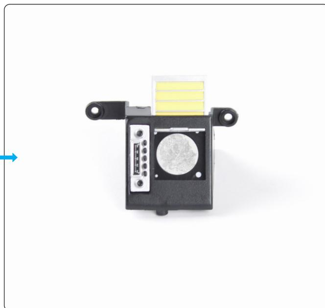
Assicurati che la copertura del GPS scorra agevolmente verso l'alto, rivelando lo schermo del localizzatore sottostante.
