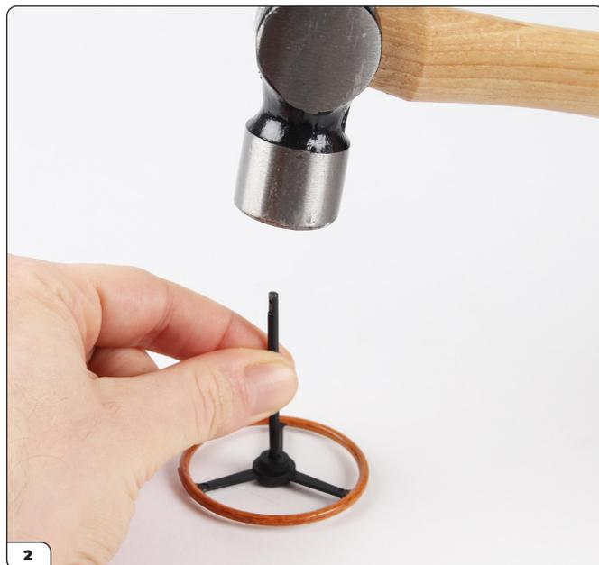
Picchiando delicatamente con un martelletto, inserisci il piantone dello sterzo nel volante.
