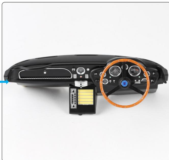
Monta la copertura del piantone dello sterzo nel cruscotto (fase 056). Il foro è sagomato in modo da assicurare l'orientamento corretto.
