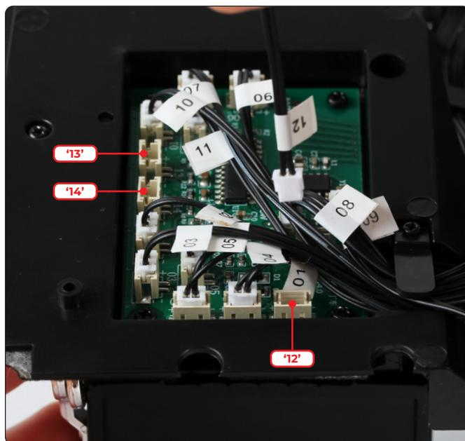
Ora, collega alla scheda elettronica i cavi rimanenti. Nell'immagine sono state evidenziate le sedi di cablaggio 12, 13 e 14.
