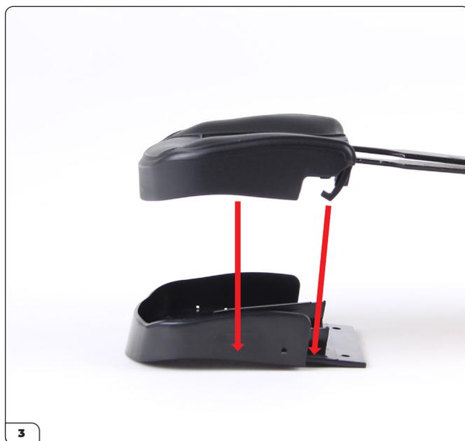
Prendi il rivestimento dello schienale passeggero (49-A) e allinealo al telaio dello schienale (49-B).
