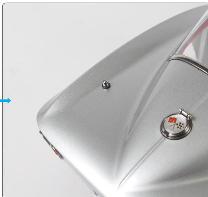
Stecken Sie den Antennenboden in das Loch hinten links in der Hauptkarosserie. Der Stift ist so geformt, dass der Antennenboden nur in einer Richtung eingesteckt werden kann.
