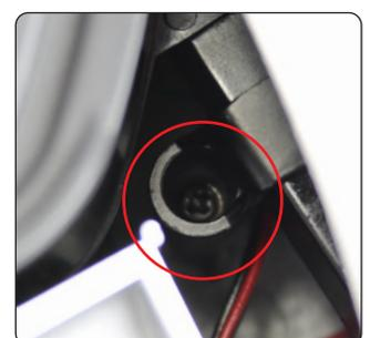
Bringen Sie die hintere Stoßstange an und befestigen Sie sie dann, indem Sie 4 CM-Schrauben durch die Halterungen in die Schraublöcher hineindrehen.
