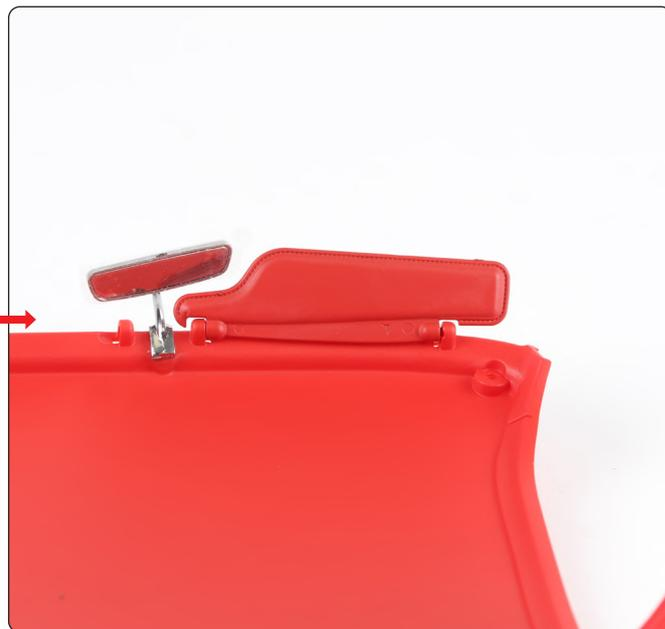
Richten Sie die linke Sonnenblende auf die Dachverkleidung aus und bringen Sie sie dann wie gezeigt mithilfe der Stifte und Löcher an.
