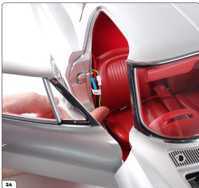
Stecken Sie das mittlere Kabel „A4“ in den Spalt zwischen der Innenverkleidung und der Karosserie.
