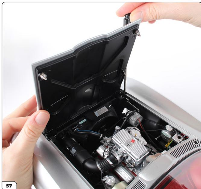
Zum Befestigen der Scharniere benötigen Sie einen schmalen Schraubendreher (wie im Bild gezeigt), damit Sie zu den Schraubblöchern gelangen können. Seien Sie vorsichtig, damit Sie nicht den Lack der Haube beschädigen.
