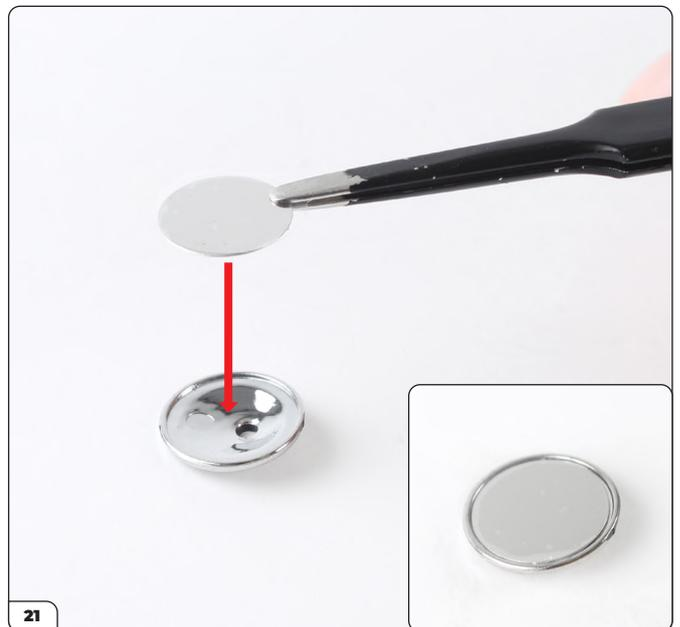
Legen Sie die klebrige Seite des Reflektors in den Seitenspiegel und kleben Sie den Reflektor an.
