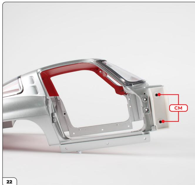
Bringen Sie die rechte Karosseriestütze an der gegenüberliegenden Seite an und befestigen Sie sie mit 2 CM-Schrauben.
