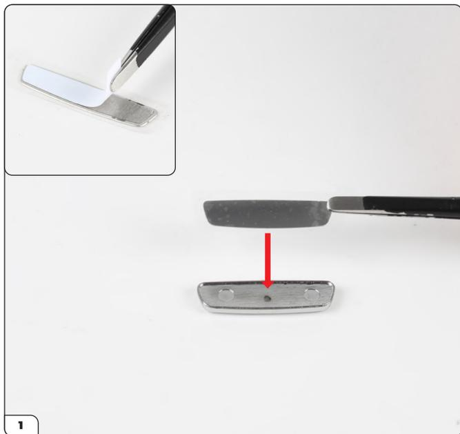
Ziehen Sie die weiße Schutzfolie (siehe kleines Bild) vom Rückspiegel ab und richten Sie den Rückspiegel dann auf den Rückspiegelrahmen aus.
