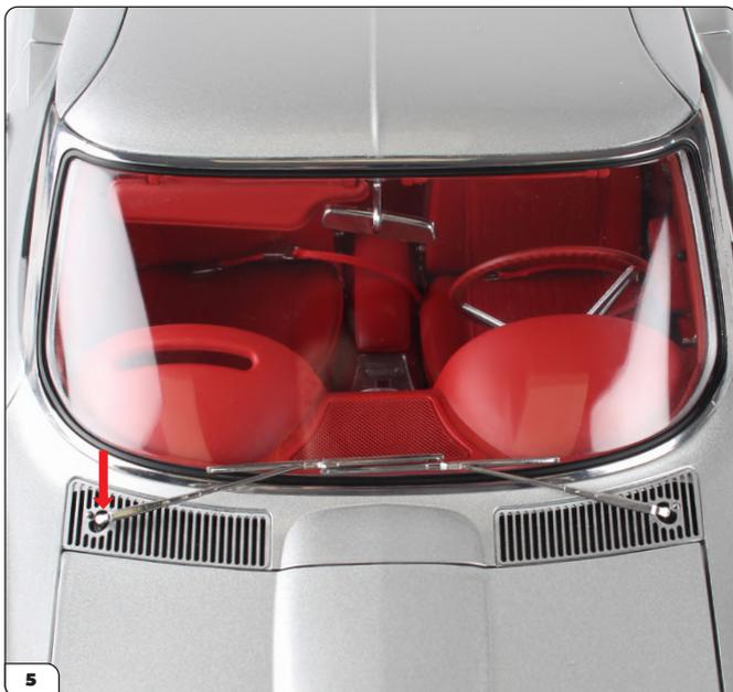
Bringen Sie den rechten Scheibenwischer auf die gleiche Weise an. Der rechte Scheibenwischer muss über den linken Scheibenwischer gelegt werden.
