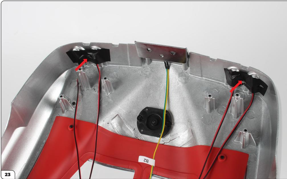
Befestigen Sie die LEDs mit zwei Klebebandstücken.
