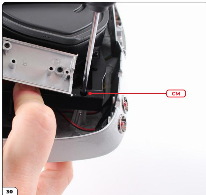
Befestigen Sie den hinteren Teil mit 2 CM-Schrauben in den Löchern neben den Auspufftöpfen (D) (jeweils eine Schraube an jeder Seite).
