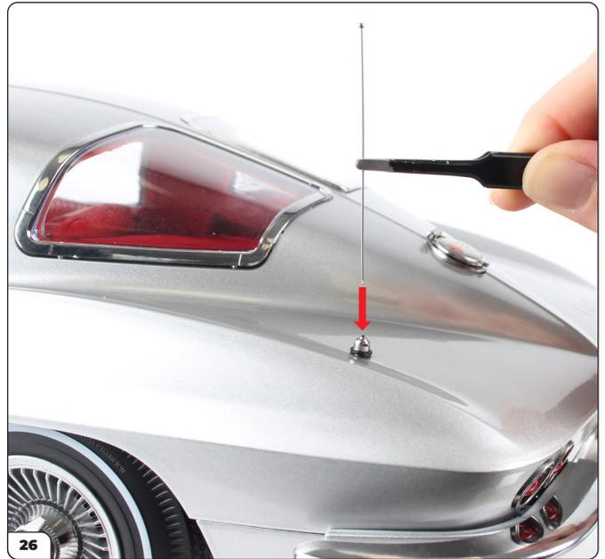
Richten Sie die Antenne auf den Antennenboden aus.
