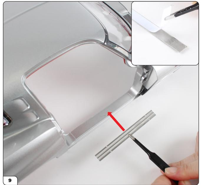
9 Ziehen Sie die Schutzfolie von einer der Türschwellen (siehe kleines Bild) ab und richten Sie die Türschwelle dann auf die Hauptkarosserie aus.
