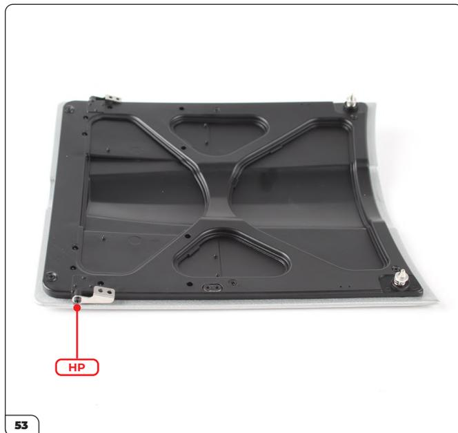
Bringen Sie das rechte Haubenscharnier an und befestigen Sie es mit einer HP-Schraube.
