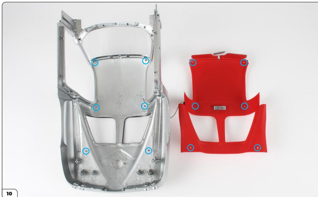
Nehmen Sie die Hauptkarosserie (Bauphase 91) und richten Sie sie wie gezeigt auf die Dachverkleidung aus. Identifizieren Sie die sechs Befestigungspunkte (eingekreist). Hinweis: Damit der Lack nicht zerkratzt, legen Sie die Karosserie am besten auf eine weiche Unterlage.
