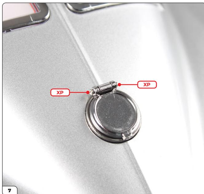
Befestigen Sie den Tankdeckel mit 2 XP-Schrauben.
