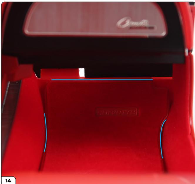
Kleben Sie die Fußmatte so in den Fußraum, dass die Ränder der Fußmatte glatt im Fußraum anliegen (siehe blaue Linien).
