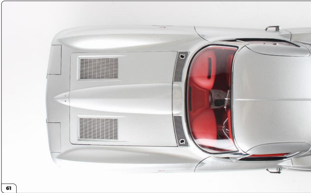
Schließen Sie die Haube. Wenn die Haube nicht bündig aufliegt, prüfen Sie die elektrischen Kabel, schauen Sie nach, ob Teile falsch ausgerichtet sind, und ziehen Sie die Schrauben an den Haubenscharnieren an.
