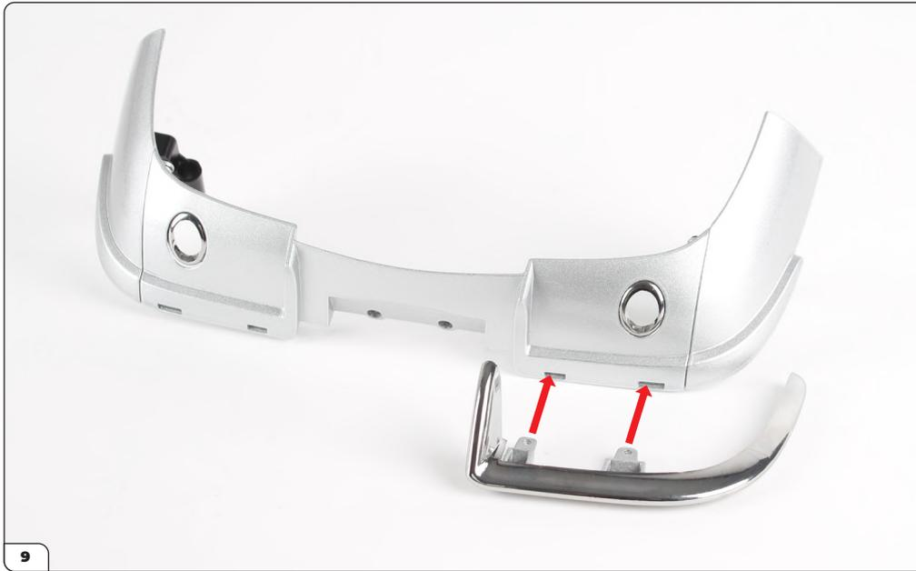
Richten Sie die linken Stoßstangenhalterungen auf die Schlitzte in der hinteren Karosserieverkleidung (Bauphase 96) aus.
