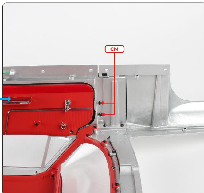
Bringen Sie die rechte Tür auf die gleiche Weise an und befestigen Sie sie ebenfalls mit 2 CM-Schrauben.
