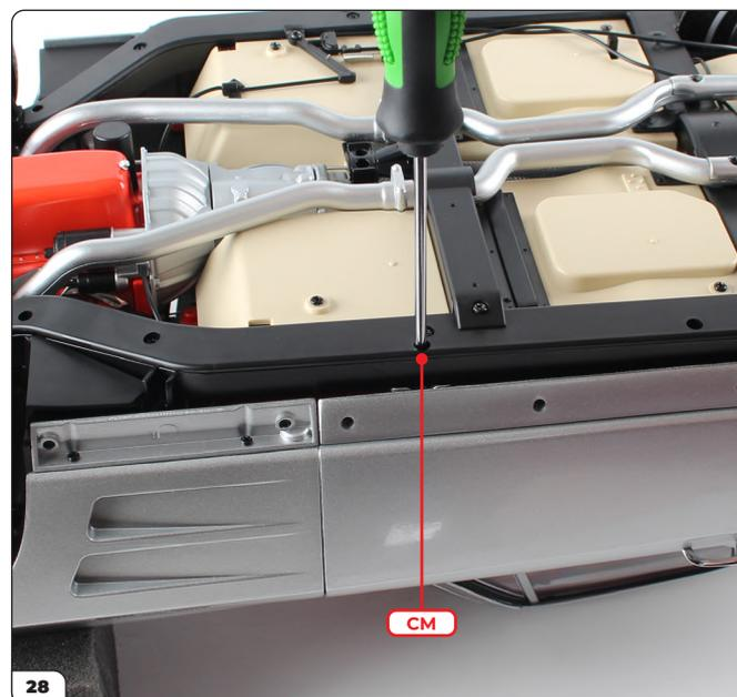
Befestigen Sie den mittleren Teil zunächst mit 2 CM-Schrauben entlang des Chassis (B) (jeweils eine Schraube an jeder Seite).
