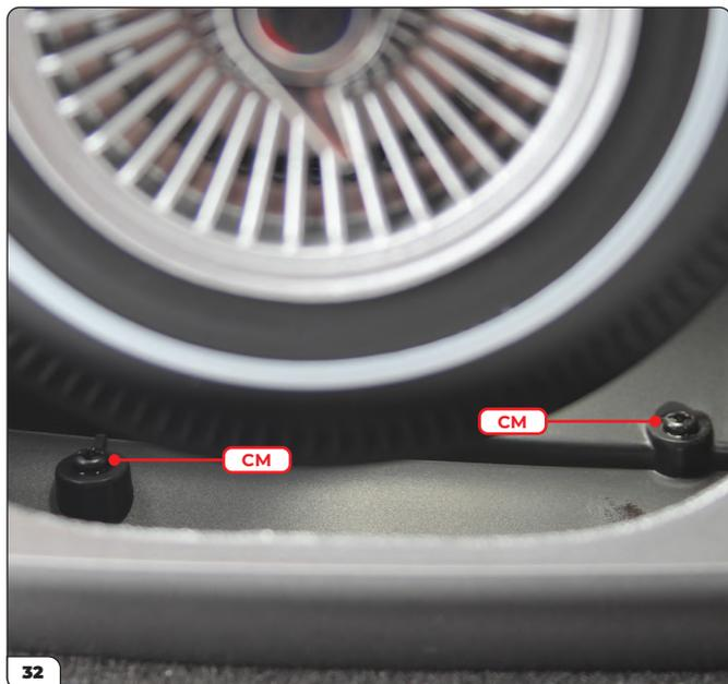
Drehen Sie 2 CM-Schrauben in die Schraublöcher in der rechten Radhausverkleidung.
