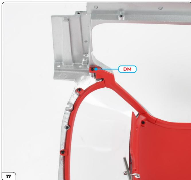
Bringen Sie die linke Innenverkleidung an und befestigen Sie sie dann mit einer DM-Schraube.
