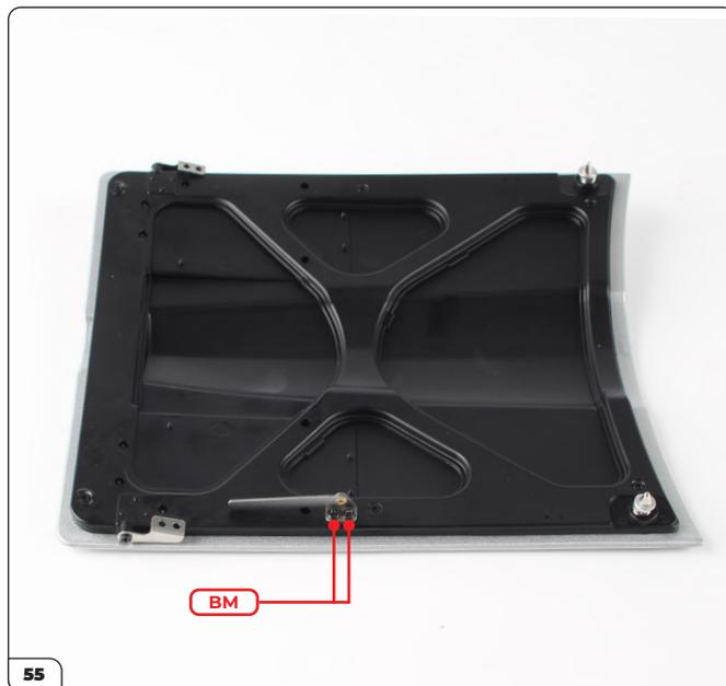
Befestigen Sie die Haubenstütze mit 2 BM-Schrauben.
