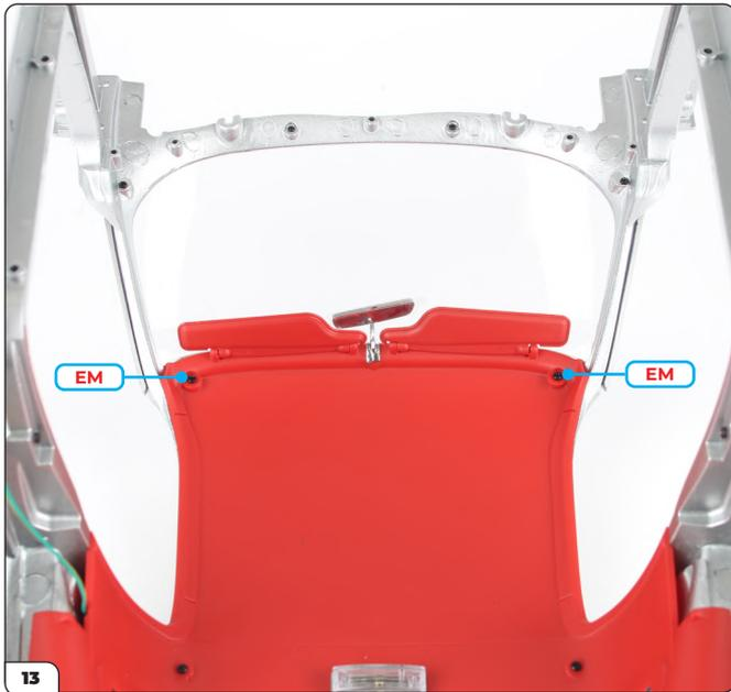
Befestigen Sie dann die Dachverkleidung mit 2 EM-Schrauben an der Vorderseite.
