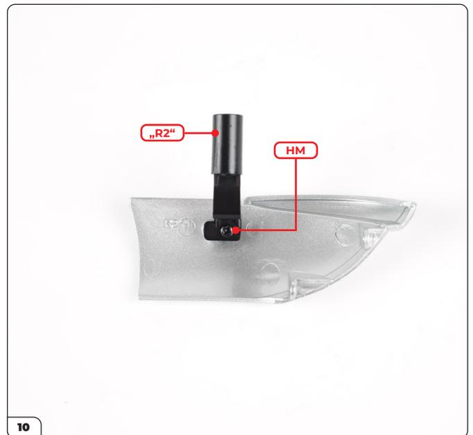
Bringen Sie die mit „R2“ beschriftete Halterung an der rechten hinteren Karosserieverkleidung an und befestigen Sie sie mit einer HM-Schraube.
