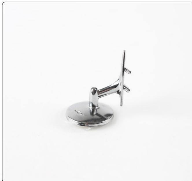
Richten Sie die Seitenspiegelhalterung wie gezeigt auf den Seitenspiegel aus und stecken Sie die Halterung dann vorsichtig in das Loch.
