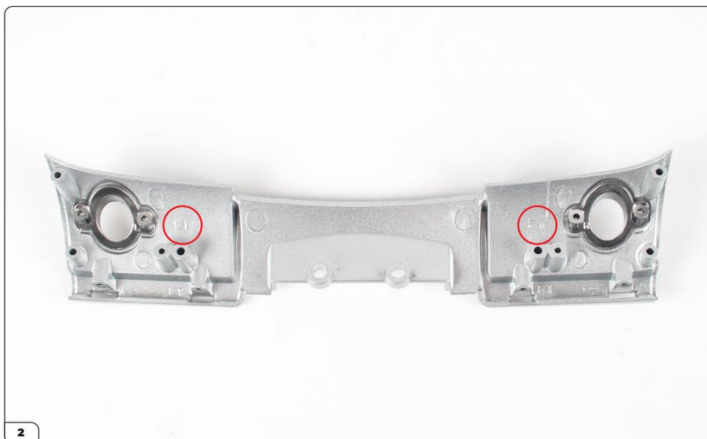
Setzen Sie die Auspuffblenden ein. Beachten Sie die Beschriftungen „L1“ und „R1“ auf der hinteren Karosserieverkleidung.
