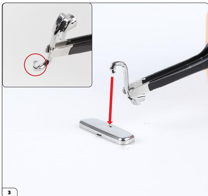
Nehmen Sie die Rückspiegelhalterung. Sie hat einen geformten Stift (eingekreist). Richten Sie den Stift wie gezeigt auf die Rückseite des Rahmens aus.
