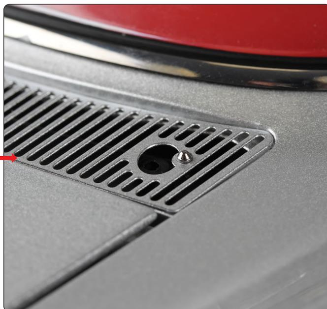
Prenez l'une des buses de lavage et insérez-la dans le petit trou situé à l'avant du pare-brise.
