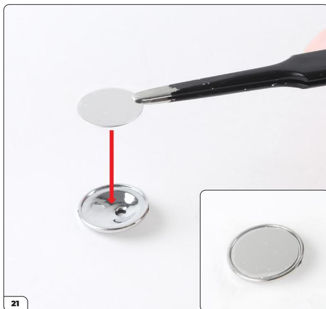
Insérez le réflecteur dans le rétroviseur latéral, en utilisant le côté adhésif pour le fixer.
