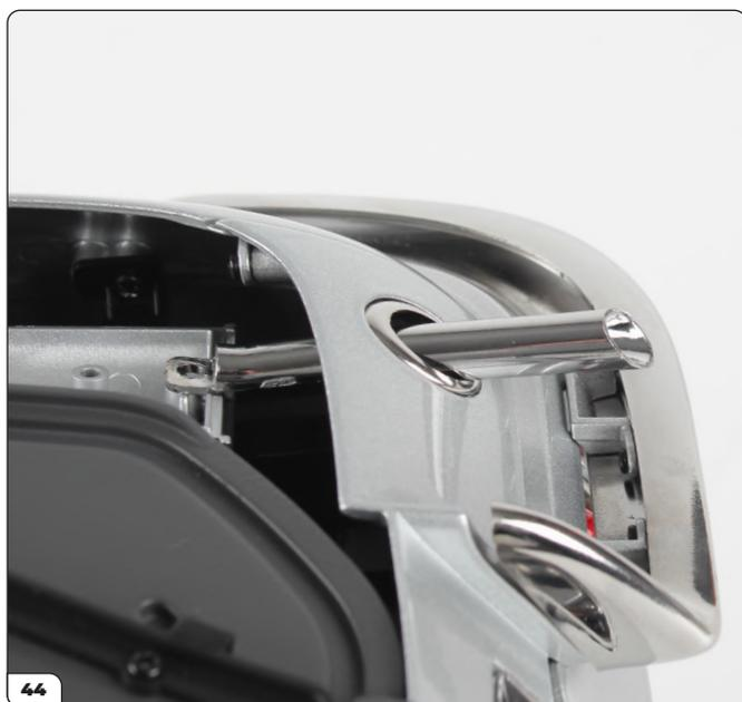
La suspension arrière gauche doit ressembler à ceci une fois installée.
