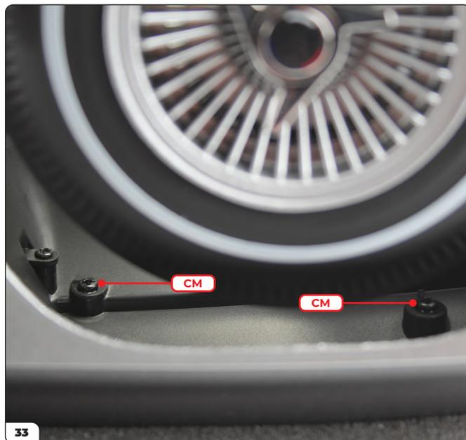
Répétez l'opération pour le passage de roue gauche avec 2 vis CM.
