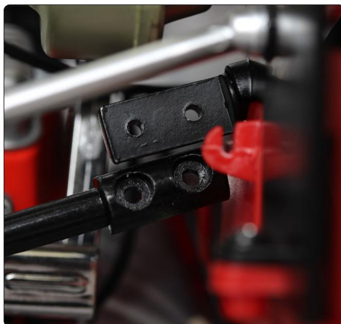
Repérez la connexion de la colonne de direction (entourée sur la photo) du côté conducteur. Veillez à ce que les deux parties se fassent face tel qu'indiqué (image de droite).
