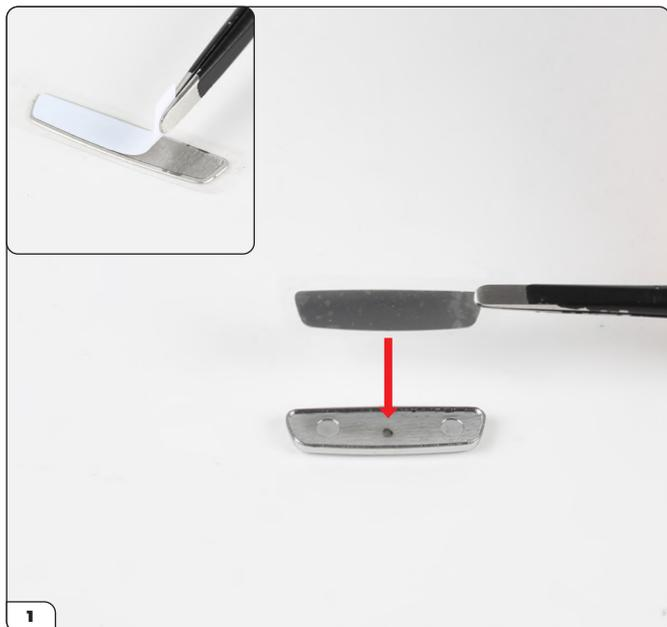
Découpez le papier support (cf. encadré) du miroir de rétroviseur et alignez-le sur le cadre du rétroviseur.
