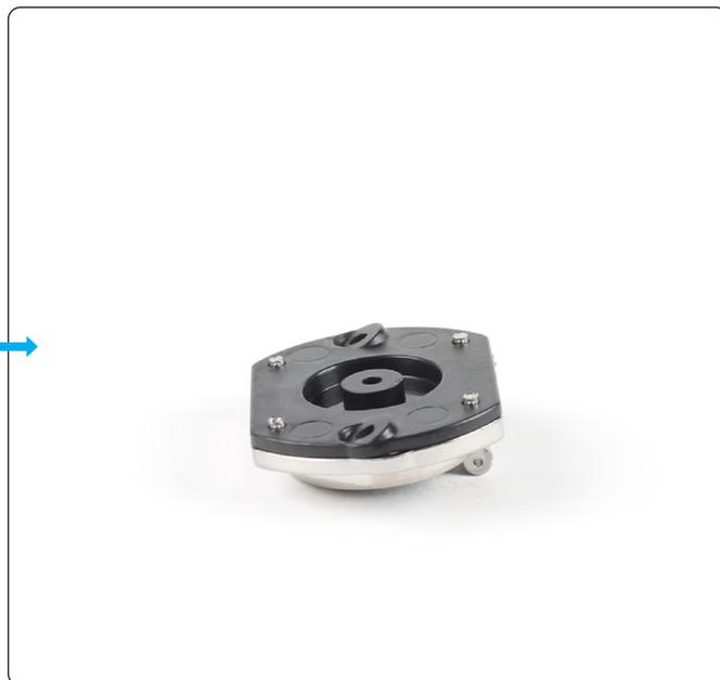
Prenez le cache et la garniture du réservoir de carburant. Alignez les pièces tel qu'indiqué, en notant l'inclinaison des pas de vis sur le cache et la position de la monture saillante sur la garniture (entourés sur la photo). Assemblez les pièces.
