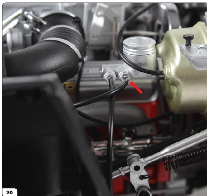
Connectez le tuyau sur la broche droite de la pompe d'embrayage, en réduisant la longueur du tuyau si nécessaire.
