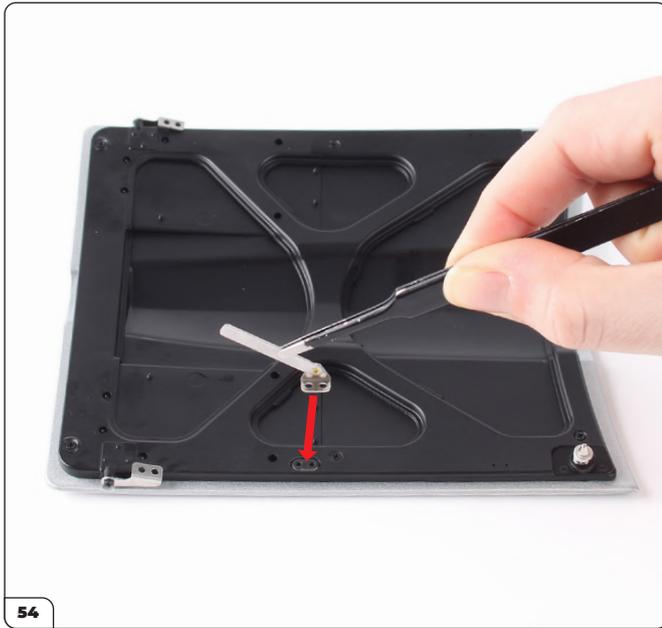
Placez le support de capot (intérieur) sur les deux pas de vis du côté droit.
