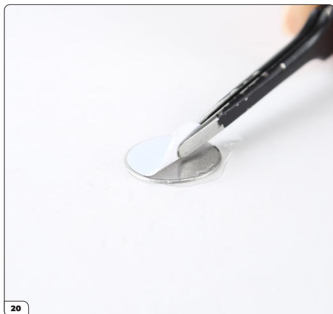
Décolliez le papier support blanc du réflecteur du rétroviseur latéral. Laissez le film de protection en place pour le moment ; vous le retirerez une fois le rétroviseur latéral installé.
