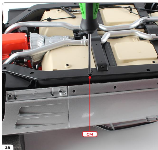
Commencez à fixer la partie centrale avec 2 vis CM enfoncées le long du châssis (B), une de chaque côté.
