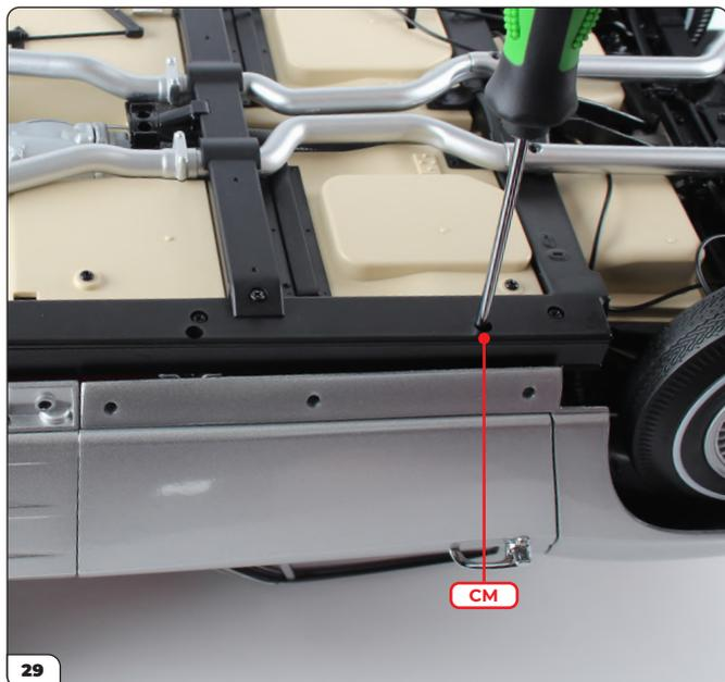
Continuez à fixer la partie centrale avec 2 vis CM enfoncées le long du châssis (C), une de chaque côté.
