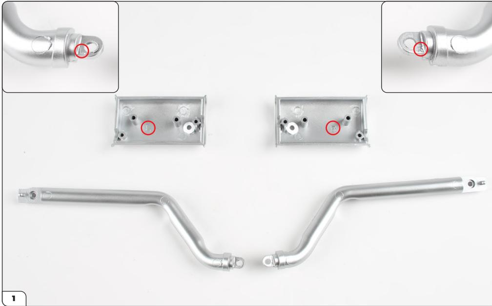
Associez les tuyaux d'échappement arrière gauche et droit aux silencieux. Les pièces sont marquées d'un « L » et d'un « R ».
