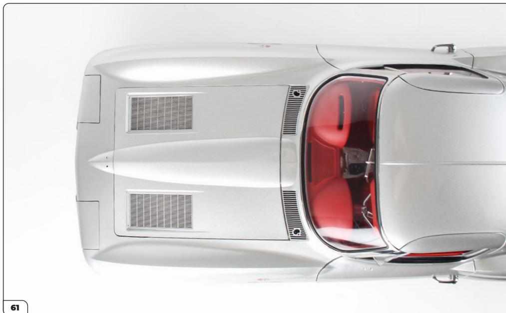
Fermez le capot. S'il n'est pas à niveau, vérifiez que cela n'est pas dû à des fils électriques ou des pièces mal alignées et resserrez les vis au niveau des charnières.
