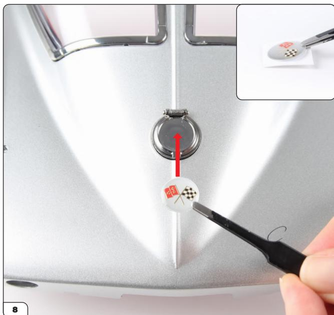
Détachez soigneusement l'emblème du réservoir de carburant de son papier support (cf. encadré) et alignez-le avec le couvercle.
