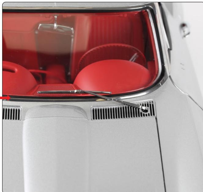
Prenez l'essuie-glace gauche et insérez-le dans le trou situé à côté de la buse.
