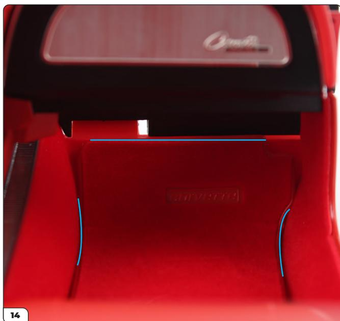
Collez le tapis sur le plancher, en alignant la forme du tapis sur la courbe du plancher (lignes bleues).
