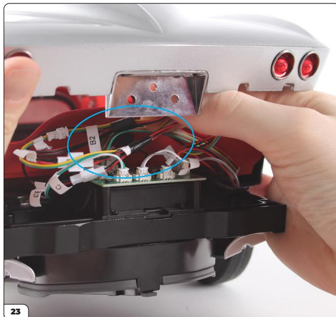
23 Rentrez le faisceau de fils arrière dans la zone située entre le circuit imprimé et le réservoir de carburant.
