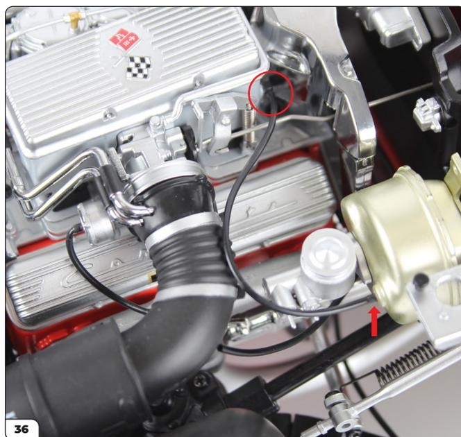
Localisez l'extrémité du tuyau du système d'injection et raccordez-le au servofrein (cf. flèche).
