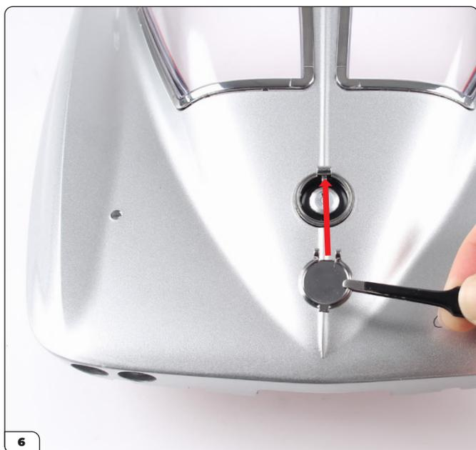
Retournez l'ensemble et placez le couvercle du réservoir de carburant sur la monture saillante.
