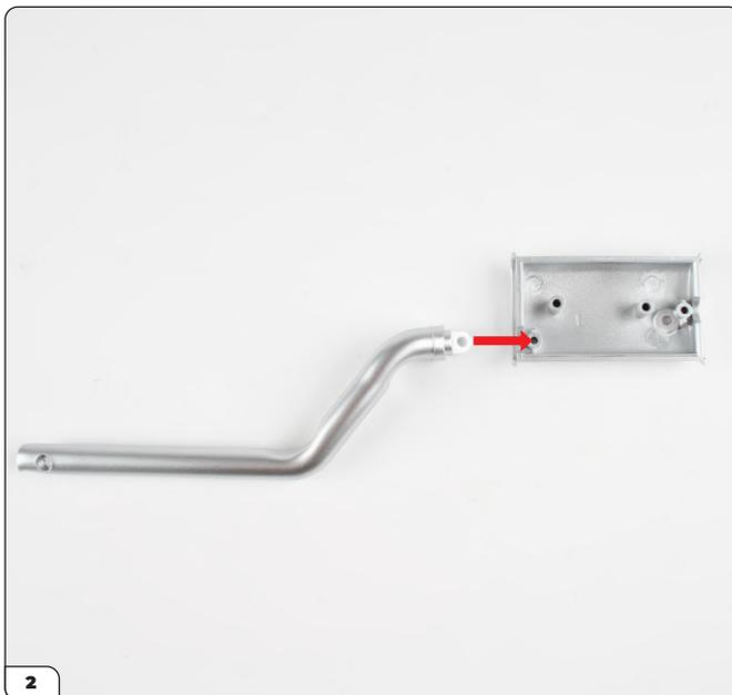
Montez le tuyau d'échappement gauche sur le silencieux gauche.
