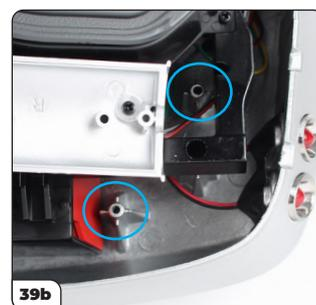
Alignez le pare-chocs arrière avec l'ensemble tel qu'indiqué. Les supports du pare-chocs arrière se fixent sur quatre vis (39a et 39b).
