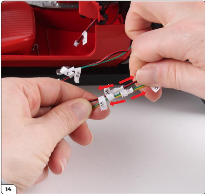
Déconnectez les fils LED marqués « A5 » et « A6 » du châssis.
