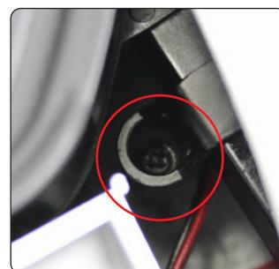
Fixez le pare-chocs arrière avec 4 vis CM, en les enfonçant dans les supports et dans les pas de vis.
