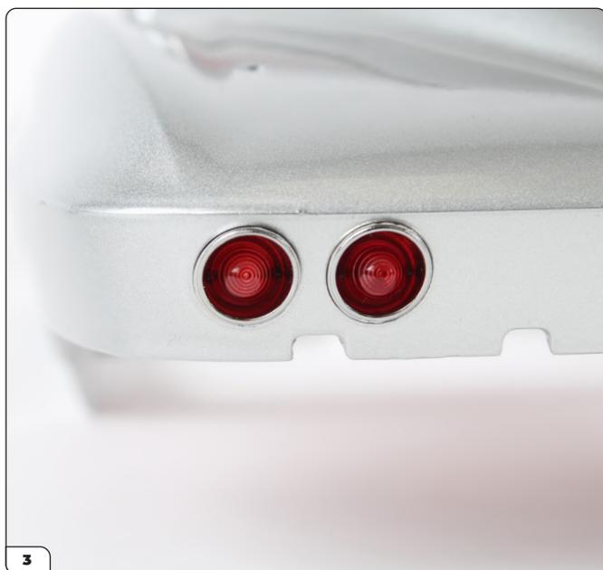
Installez les feux arrière gauches dans le renforcement.
