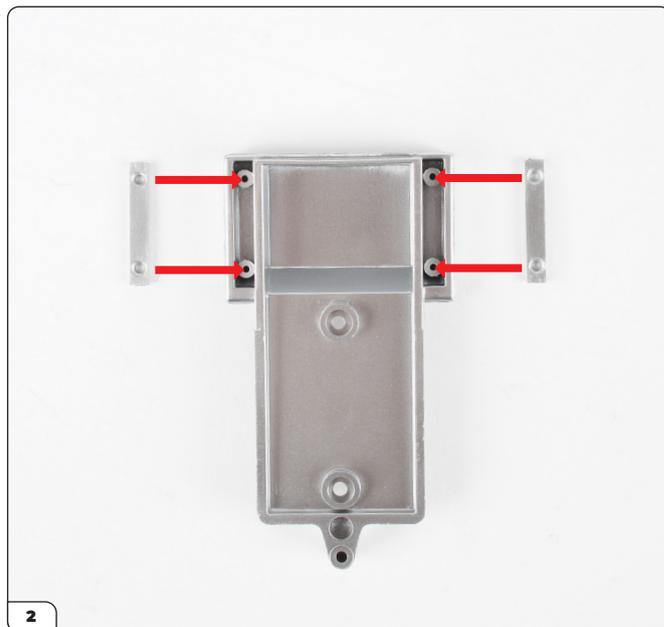
Alignez les plaques avec le carter d'huile (24-A) de sorte que les trous de vis avec un léger renforcement soient orientés vers le haut.
