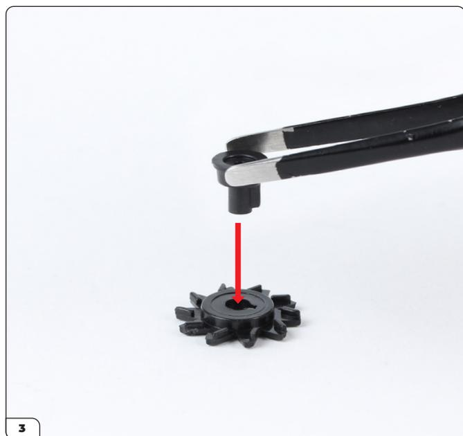
Installez la poulie d'alternateur (21-F) dans le trou correspondant du rotor d'alternateur (21-E). Assurez-vous que les dents du rotor sont orientées comme indiqué.
