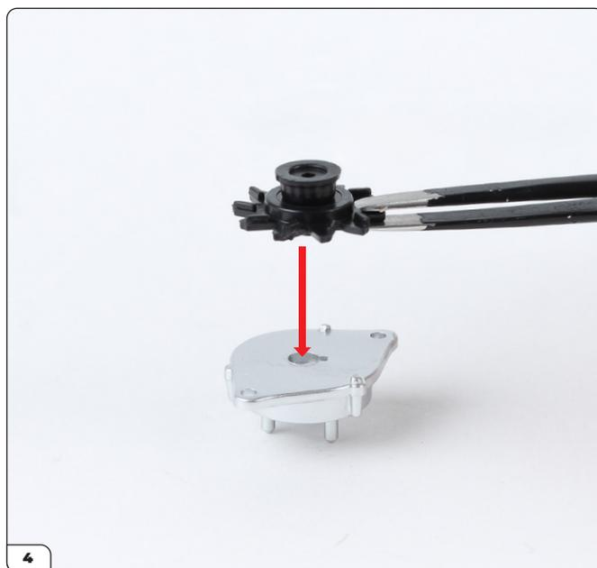
Prenez la partie B (21-C) de l'alternateur. Insérez le rotor et la poulie dans le trou prévu à cet effet.
