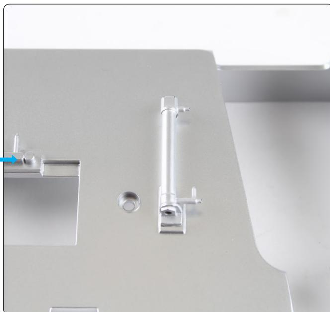
Insérez le piston gauche dans les trous correspondants. Il ne peut pas être mis dans le mauvais sens.
