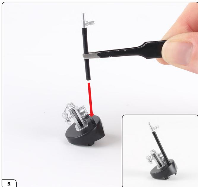
Installez l'autre extrémité du tuyau sur la tige du support du servo-frein.
