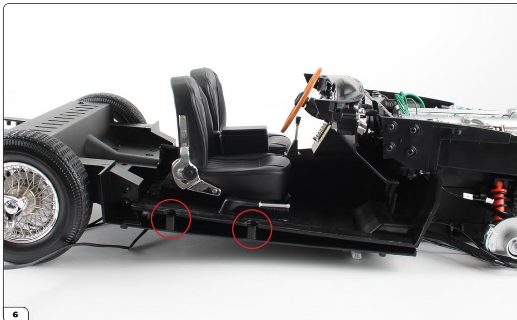
Placez soigneusement l'intérieur en alignant les indentations avec les trous de vis. Vérifiez qu'aucun des câbles ne soit coincé.
