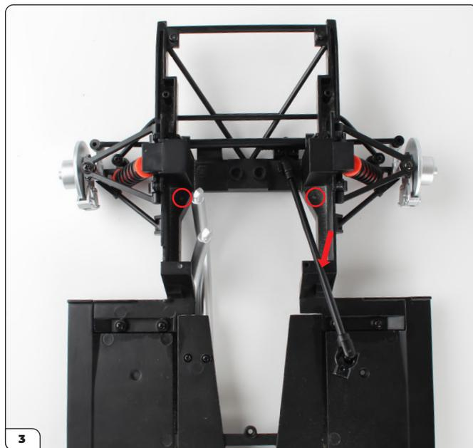
Prenez le châssis (étape 042) et positionnez la colonne de direction sur le pilier droit (flèche). Veuillez repérer les trous de vis (encerclés) pour assembler le compartiment moteur.
