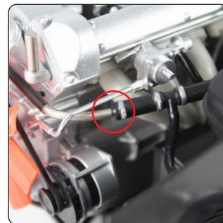
Mettez le moteur en place. L'arbre d'entraînement doit pouvoir rentrer dans la boîte de vitesses (encerclé). Assurez-vous que le moteur est placé dans les deux trous de vis mis en évidence à l'étape 3. Connectez le tuyau du réservoir à la broche argentée (image de droite).
