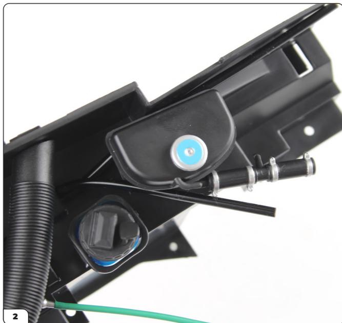
Installez le tuyau du réservoir sur le réservoir. Le raccord est en forme de D.
