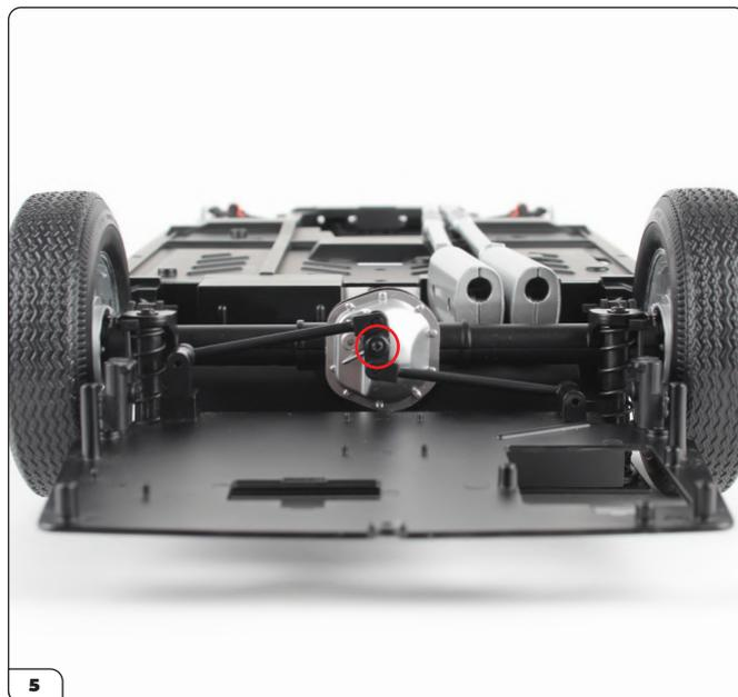
Remettez l'arrière du châssis en place. Positionnez le raccord de la barre stabilisatrice comme indiqué puis fixez-la avec la vis PS14 retirée à l'étape 1 (encerclée).
