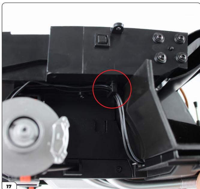
Fixez les câbles n°02, n°04 et n°06 sous le mur gauche du compartiment moteur de la même manière.
