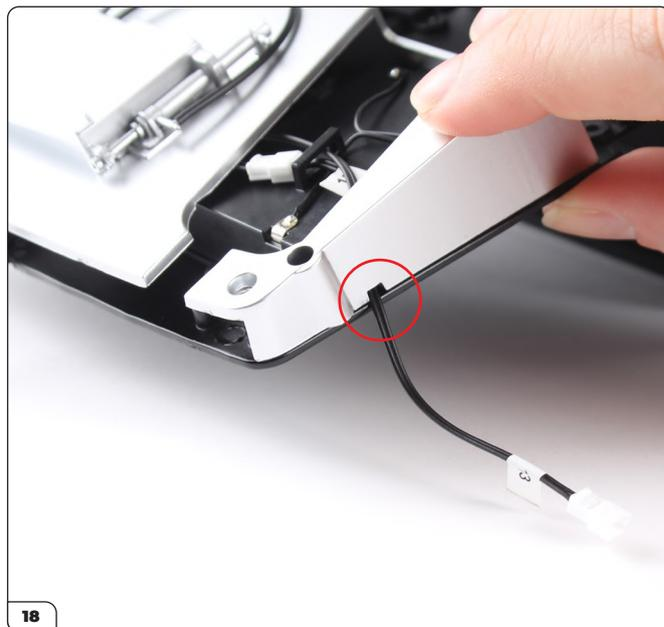
Mettez la plaque inférieure en place, en veillant à ce que les câbles n°13 et n°14 soient positionnés dans les encoches.
