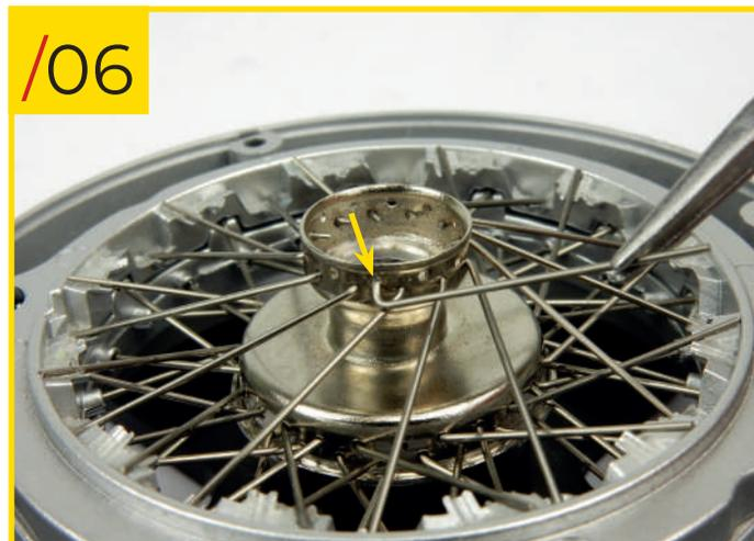
23/06 Insérez maintenant l'extrémité crochue d'un rayon de type C dans l'un des trous de la rangée supérieure sur le moyeu de type C.
