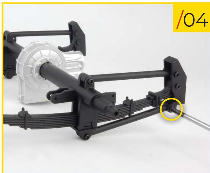
29/04 Vissez l'autre extrémité de la biellette sur le support avant du ressort à lame à l'aide d'une vis de type H.
