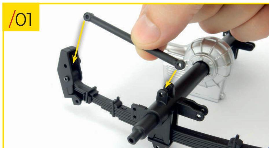
27/01 Reprenez l'assemblage de l'étape 26. Posez l'une des biellettes sur le ressort à lame comme sur la photo.
