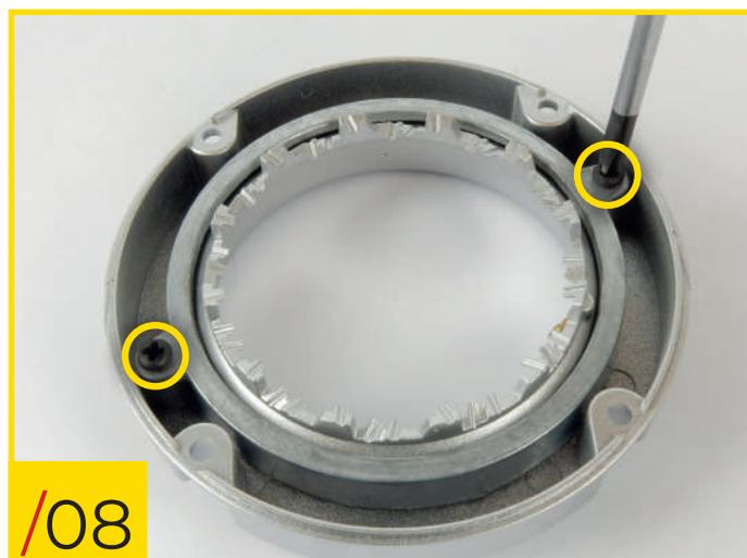
23/08 Posez la bague d'étanchéité sur la jante externe comme sur la photo. Vissez à l'aide de deux vis de type B.
