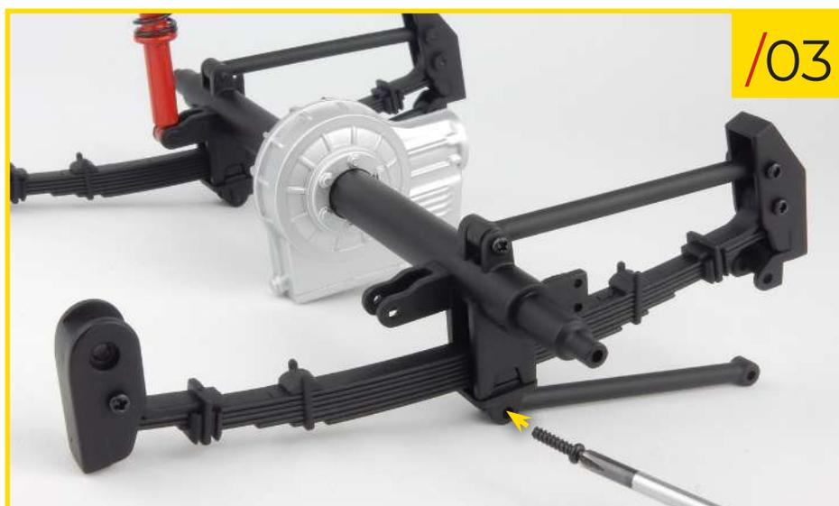
29/03 Posez l'autre biellette sur le support central et vissez-la à l'aide d'une vis de type G dans le trou indiqué.
