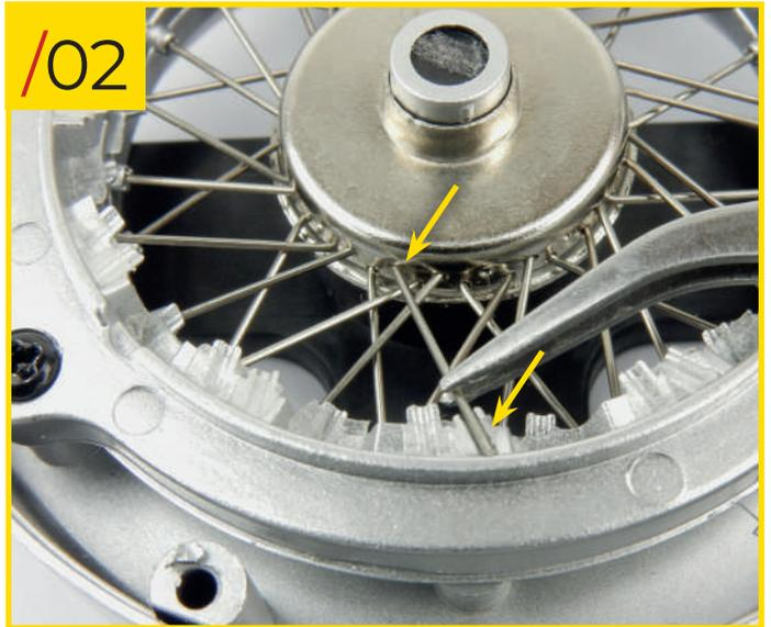
23/02 Insérez chaque extrémité crochue des rayons de type A dans les trous restants du moyeu de type A. Servez-vous de la photo pour l'orientation correcte des rayons et pour vérifier que les autres extrémités soient bien dans les encoches correspondantes au niveau supérieur de l'anneau de fixation.
