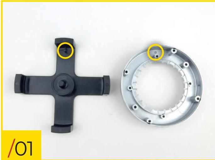
21/01 Placez le gabarit et la jante interne sur votre plan de travail. Le support de roue est muni d'un petit ergot qui doit être inséré dans le trou correspondant dans la jante.
