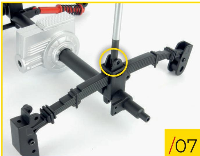
28/07 Vissez le support central sur l'assemblage à l'aide d'une vis de type B.
