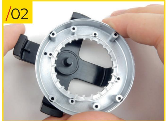
21/02 Insérez l'ergot dans le trou pour fixer la jante sur le gabarit. Avant de procéder à l'assemblage, nous vous recommandons de coller un petit morceau de scotch double face sur l'ergot central du gabarit. Cela aidera à maintenir les moyeux en place. Sinon, vous pouvez placer tous les rayons en position puis déposer une goutte de colle sur chacun des rayons après l'étape 21/08.
