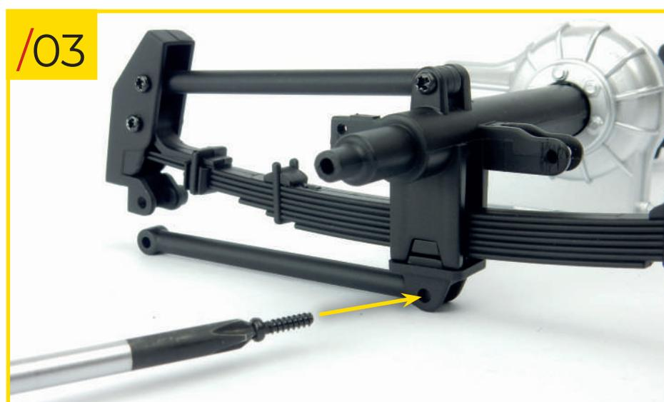
27/03 Posez l'autre biellette comme sur la photo sur le support central et vissez une vis de type G dans le trou indiqué.
