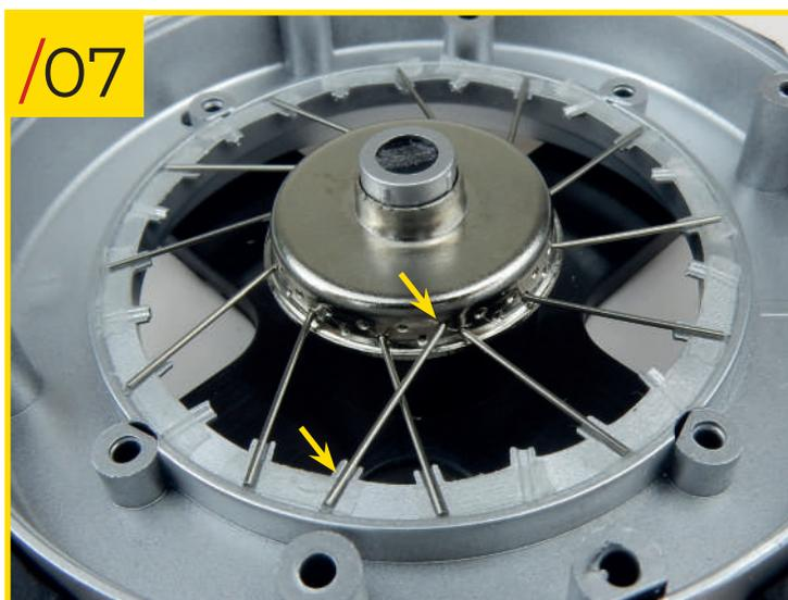
21/07 Maintenant mettez les rayons de type A (qui sont plus longs que ceux de type B) en insérant leur extrémité crochue dans les trous de la rangée supérieure directement à gauche des rayons de type B en veillant à ce qu'ils passent par-dessus les rayons insérés dans les trous de la rangée inférieure. Regardez la photo pour repérer l'encoche sur laquelle vous devez positionner l'autre extrémité du rayon. Laissez toujours un trou vide entre chaque rayon dans le moyeu.
