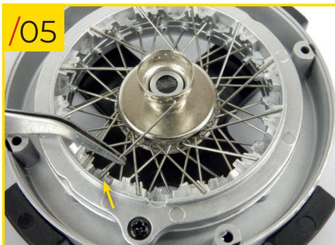
23/05 Placez l'autre extrémité du rayon sur l'encoche au niveau inférieur de l'anneau de fixation comme indiqué sur la photo. Répétez ces étapes pour les onze autres rayons de type C, jusqu'à ce que tous les trous de la rangée inférieure sur le moyeu soient remplis.
