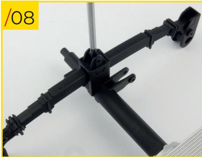
26/08 Vissez le support central sur l'assemblage à l'aide d'une vis de type B.
