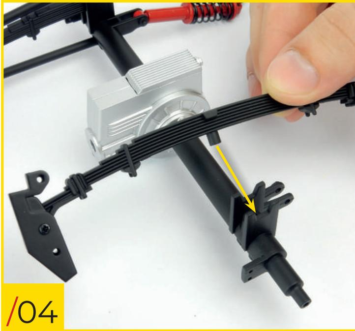
28/04 Reprenez l'assemblage du boîtier du différentiel assemblé lors des étapes précédentes. Alignez les pièces comme indiqué et posez le ressort à lame arrière droit sur l'essieu droit.
