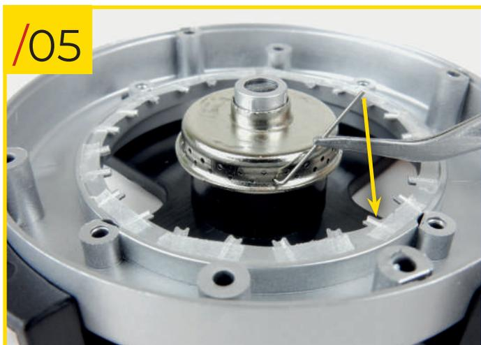
21/05 Mettez les rayons de type B (qui sont plus courts que ceux de type A) en insérant leur extrémité crochue dans les trous de la rangée inférieure du moyeu de type A. Mettez l'autre l'extrémité des rayons dans l'encoche correspondante du bord de la jante (sur le scotch double face). Laissez toujours un trou vide entre chaque rayon sur le moyeu.
