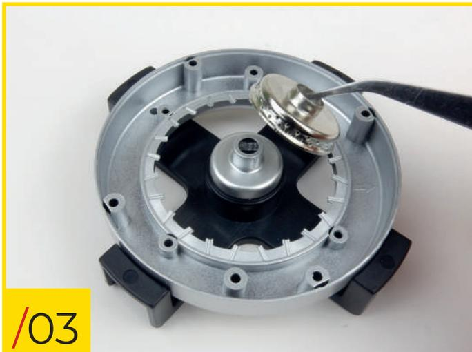
21/03 Posez le moyeu de type B sur l'ergot central du gabarit. Une fois en place, appuyez sur le moyeu de type A, comme le montre la photo.
