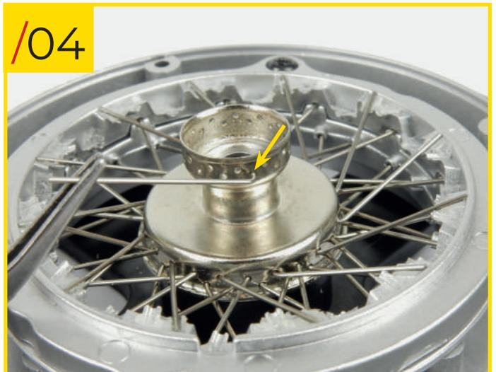
23/04 Insérez l'extrémité crochue de l'un des rayons de type C dans l'un des trous de la rangée inférieure sur le moyeu de type C.
