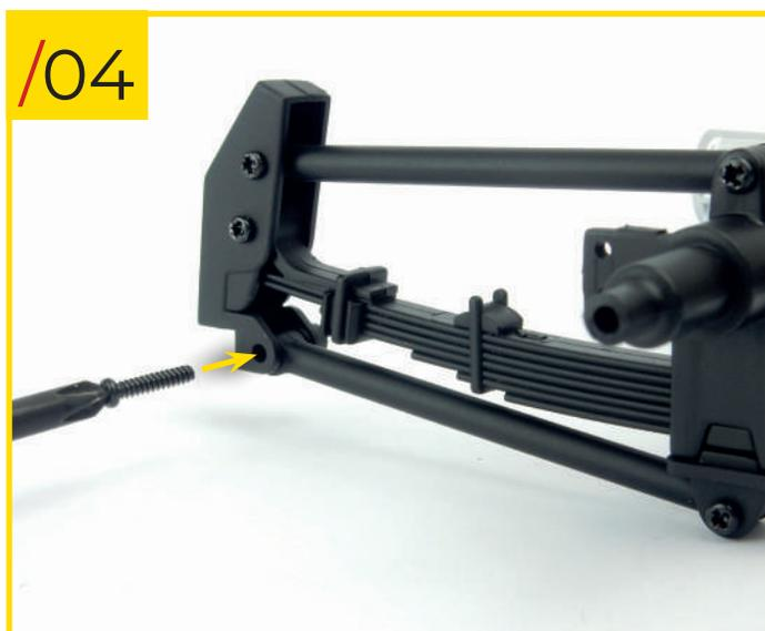
27/04 Vissez l'autre extrémité de la biellette sur le support avant du ressort à lame à l'aide d'une vis de type H.
