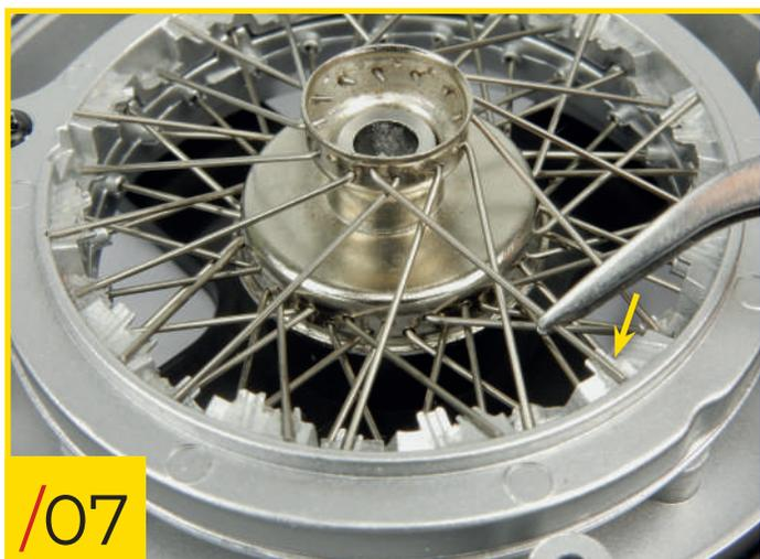
23/07 Placez l'autre extrémité du rayon sur l'encoche correspondante sur le niveau supérieur de l'anneau de fixation. Répétez ces étapes pour les onze autres rayons de type C, jusqu'à ce que tous les trous de la rangée supérieure sur le moyeu soient remplis.
