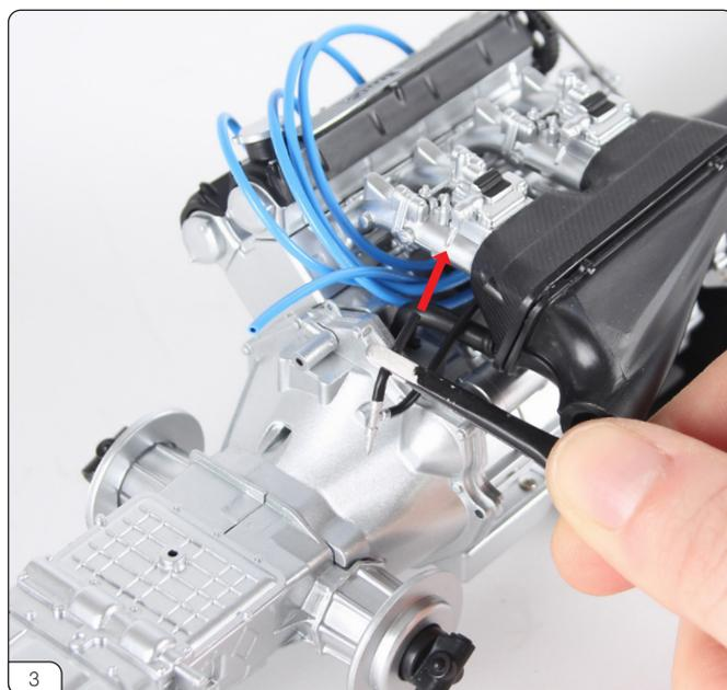
L型パイプ (26-D) の短い端を、リアキャブレターの突起に差し込みます (赤矢印)。
