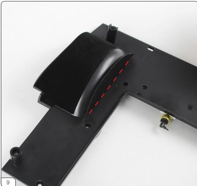
カーペットシート「R-3」を右ホイールアーチの内側に貼り付けます。直線の側をフロア（赤破線）に合わせます。
