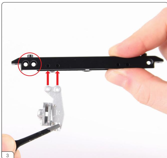
右ブレーキキャリパーマウント(29-B)をクロスメンバー(29-A)に合わせます。右ブレーキキャリパーマウントは、2つの穴(赤丸印)の横に取り付けてください。
