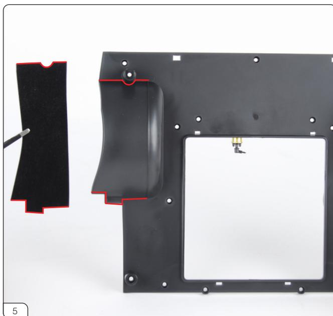
カーペットシート「R-2」を、リアフロア (31-A) の右リアホイールアーチ上部に合わせます。赤い線で示された部分が合うように貼り込みます。
