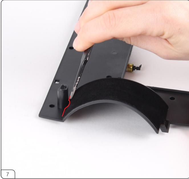
カーペットシート「R-2」を引っ張るような気持ちで貼っていき、ネジポストの凹み部分を最後に合わせます。ピンセットの先などで押して、しっかりと貼ってください。
