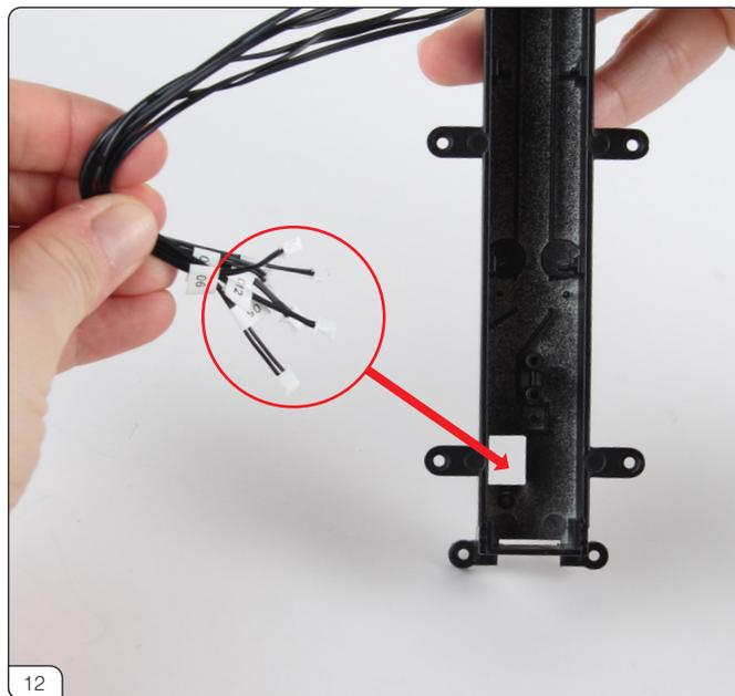
トランスミッショントンネルの端にある長方形の開口部にケーブルを通します。
