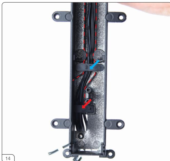
ケーブルを溝(赤破線)にはめ込み、青矢印部分をラージケーブルブラケット(32-B)で固定します。続いて赤矢印部分をミディアムケーブルブラケット(32-C)で固定します。
