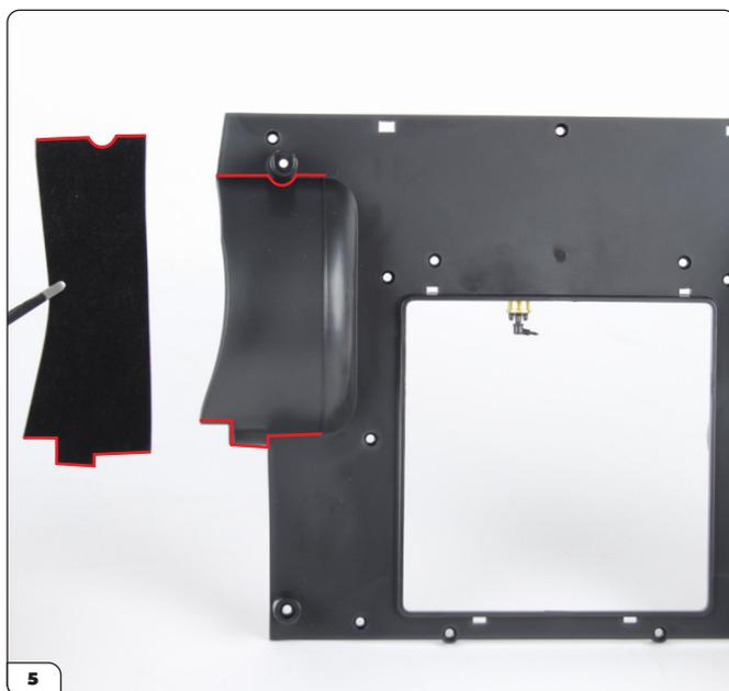
Alinea D-2 con la parte superior del paso de rueda trasero derecho en el piso interior. Nota la forma tal como se indica por las líneas rojas.
