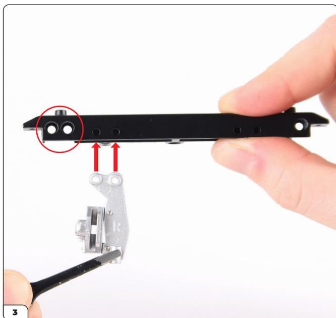
Alinea el soporte con el refuerzo transversal (29-A). Verifica cuidadosamente la orientación de las piezas en la imagen, el soporte de la pinza de freno derecha debe colocarse junto a los dos grandes orificios (en círculo).
