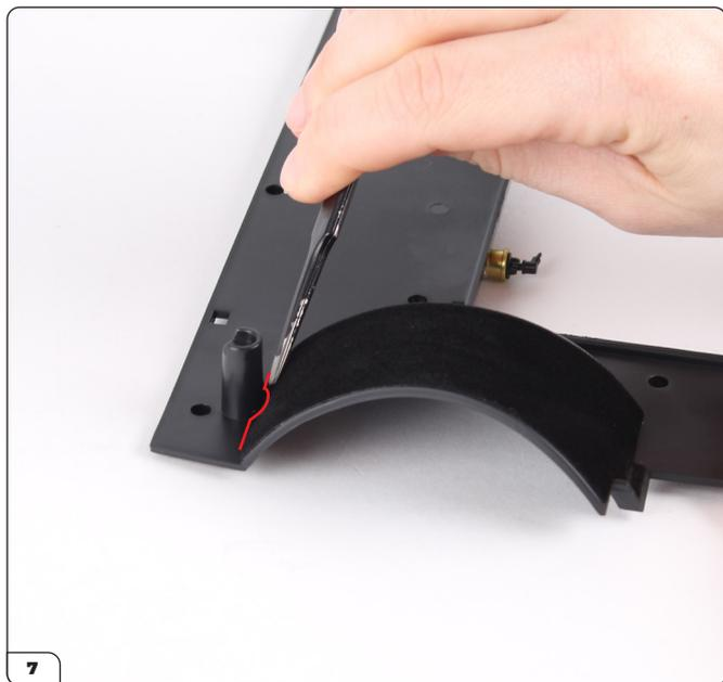
Aplica el adhesivo suavemente sobre el arco, presionando la hendidura curvada alrededor del poste del tornillo.
