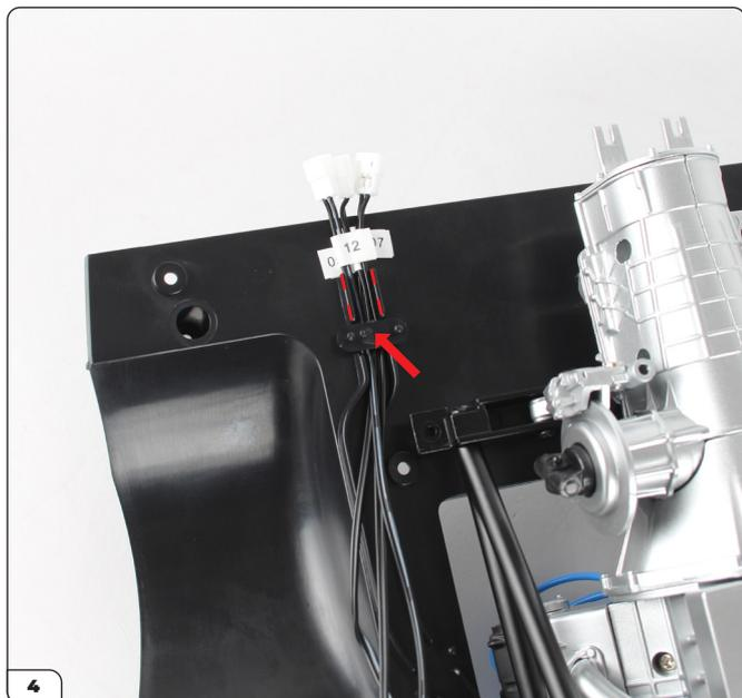
Manteniendo los extremos en su lugar, coloca los cables en el canal (líneas discontinuas) y asegura con un pequeño soporte de cable (32-A).
