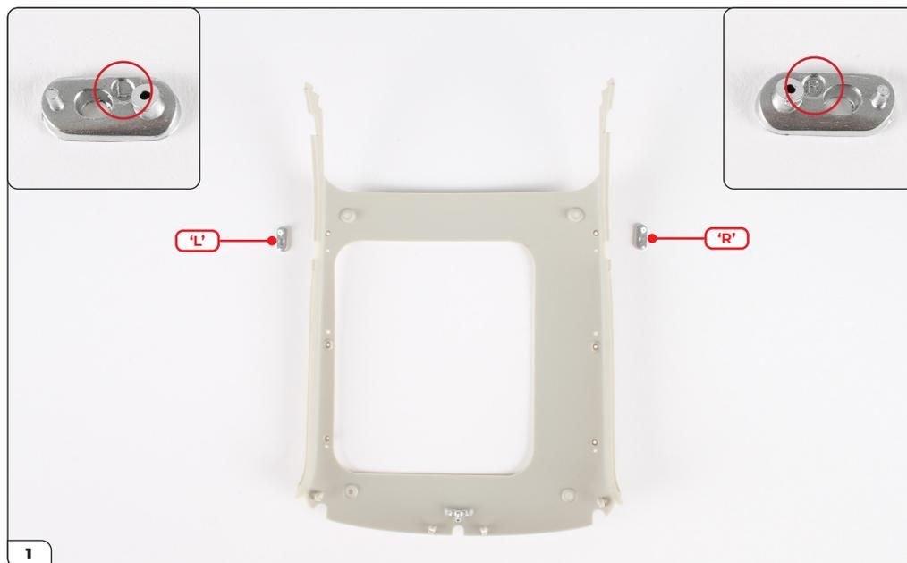
Coloca el revestimiento del techo (79-A) en tu superficie de trabajo en la orientación mostrada. Toma los ganchos traseros izquierdo (79-B) y derecho (79-D), que están marcados con una 'L' y una 'R' (recuadros), y colócalos junto al revestimiento del techo.
