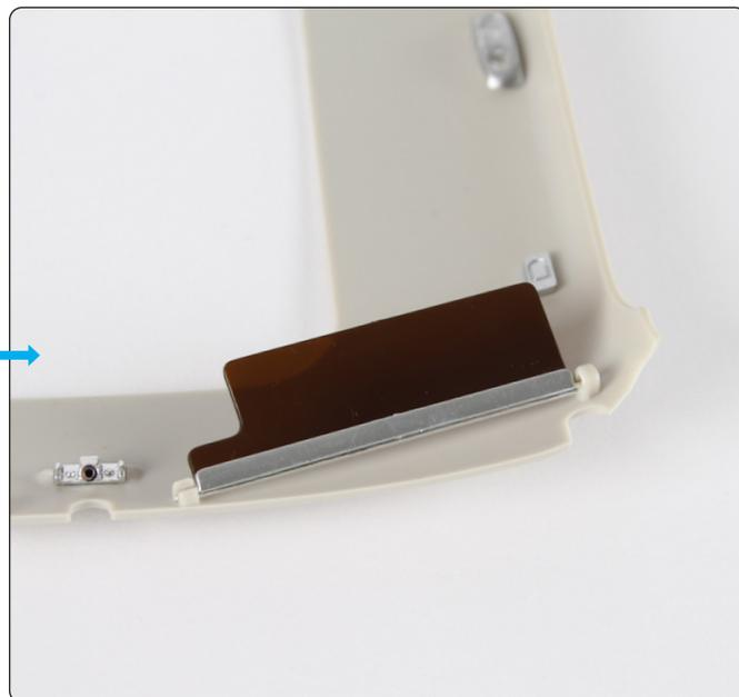
Instala la visera derecha colocando primero el pasador en el agujero exterior (en círculo) y luego presionando el otro pasador en el clip (flecha).
