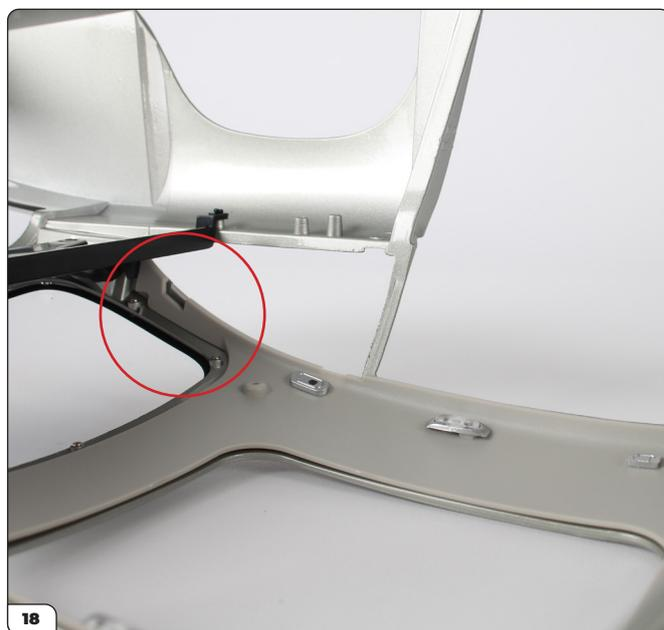
Comprueba que los extremos del revestimiento del techo estén colocados correctamente debajo de la cubierta trasera.
