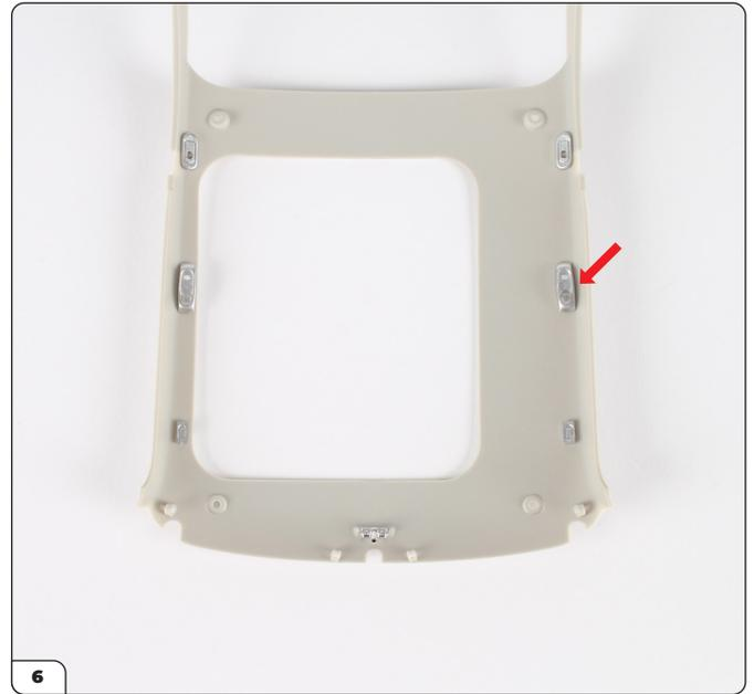
Coloca la lente de luz restante en el reflector derecho, luego presiónala en el lado opuesto del revestimiento del techo de la misma manera.
