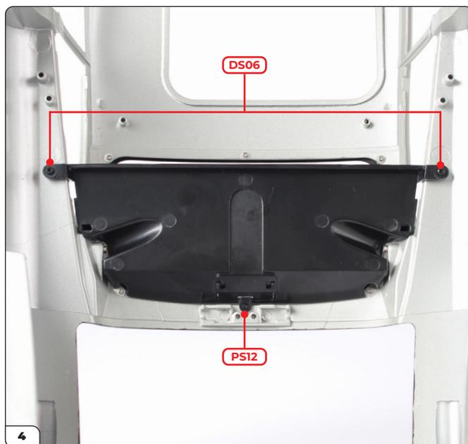
Fija la cubierta trasera utilizando 2 tornillos DS06 en los lados y 1 tornillo PS12 en el medio.
