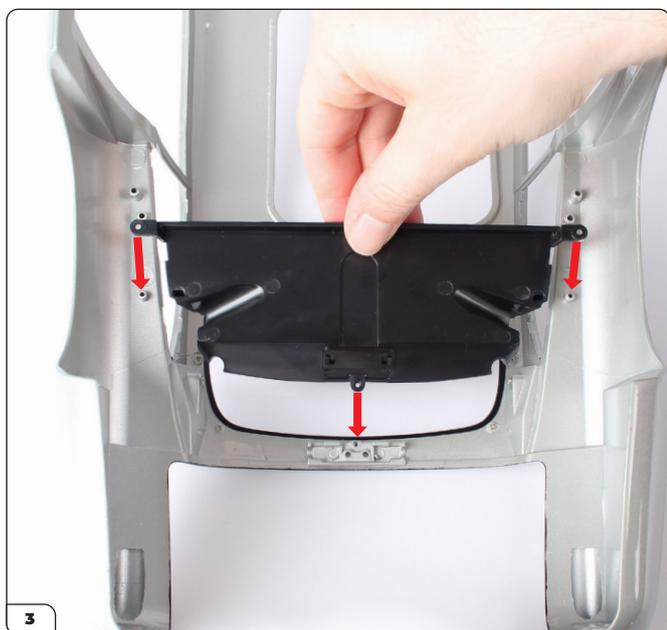
Placez soigneusement la carrosserie à l'envers sur votre surface de travail (n'oubliez pas d'utiliser une surface douce pour protéger la peinture). Alignez la plage arrière avec les trous de vis situés près de la fenêtre arrière.
