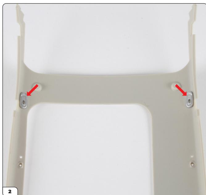
Enfoncez les crochets arrière dans le ciel de toit.
