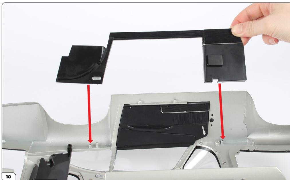
Placez soigneusement l'assemblage à l'envers sur votre surface de travail. Alignez le panneau avec l'assemblage comme indiqué, puis positionnez le panneau sur les trous de vis.
