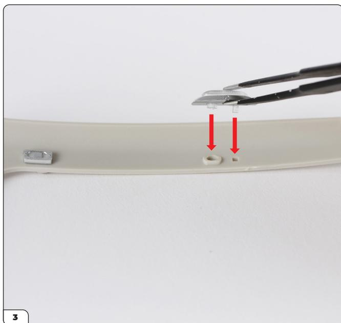
Enfoncez la lumière sur le côté gauche du ciel de toit (flèches) entre les crochets avant et arrière (encerclé).
