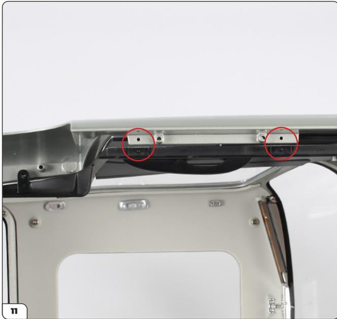
Enfoncez le panneau sous le seuil de porte. Il y a deux ergots sur le panneau qui s'insèrent dans les trous du seuil de porte (encerclés).
