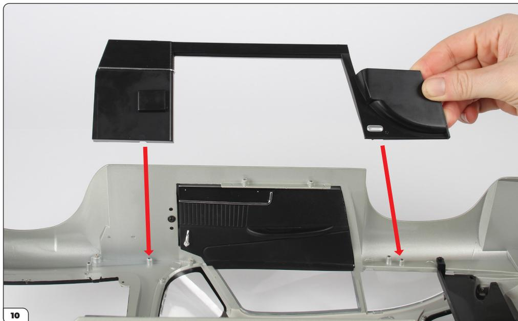
Placez soigneusement l'assemblage à l'envers sur votre surface de travail. Alignez le panneau avec l'assemblage comme indiqué, puis positionnez le panneau sur les trous de vis.
