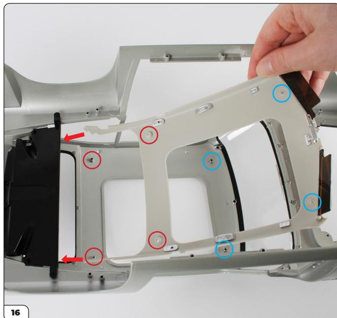
Placez soigneusement la carrosserie à l'envers sur votre surface de travail. Installez le ciel de toit sur la carrosserie en plaçant les extrémités sous la plage arrière (flèches) et en faisant correspondre les trous de vis (encerclés).
