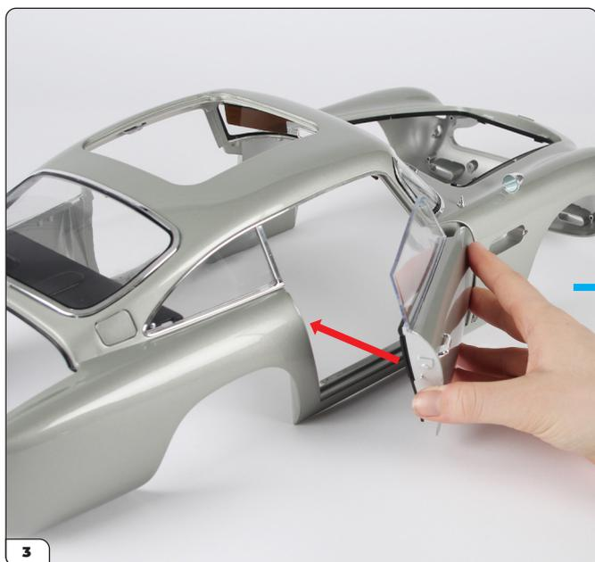
Avec le support en place, poussez la portière jusqu'à ce qu'elle soit fermée et alignée avec la carrosserie.
