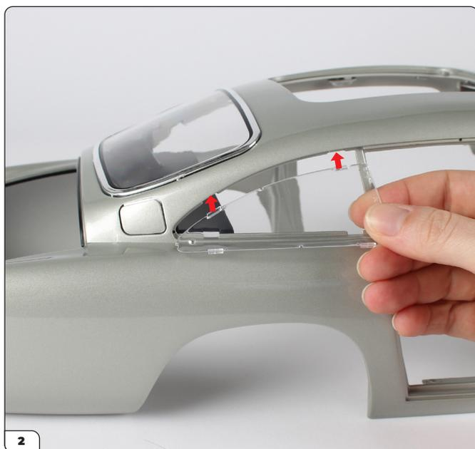
Positionnez les deux languettes le long du bord supérieur de la fenêtre dans les emplacements situés sur le côté droit de la carrosserie.
