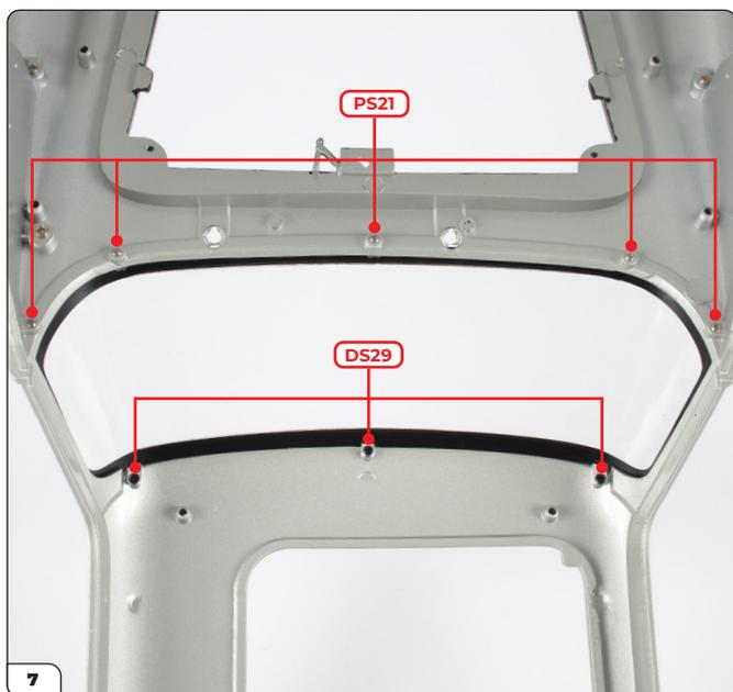
Fixez le pare-brise et le montant de l'autre côté en utilisant 5 vis PS21 et 3 vis DS29 comme indiqué.
