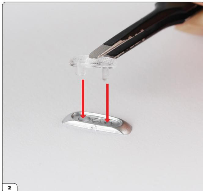
Enfoncez l'une des lentilles de lumière (80-D) dans le réflecteur de lumière gauche. Les trous sont de tailles différentes pour correspondre aux fixations.
