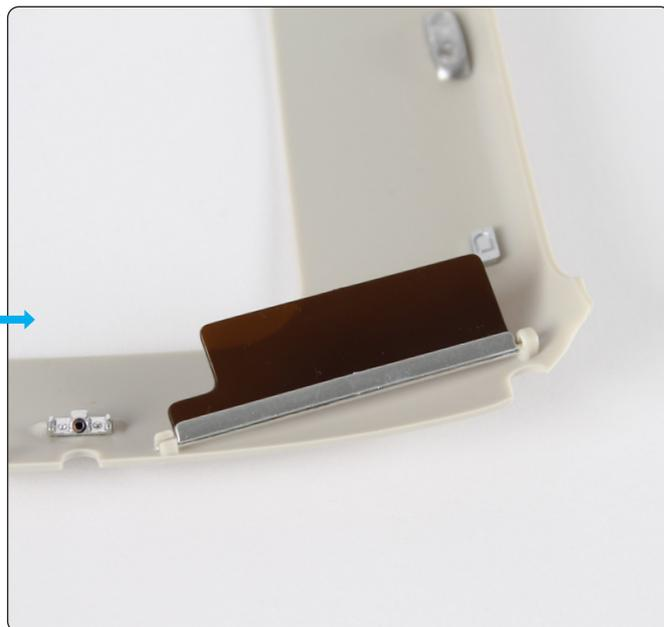
Installez le pare-soleil droit en insérant d'abord l'embout le plus distant (encerclé) puis l'autre embout dans le clip de fixation (flèche).
