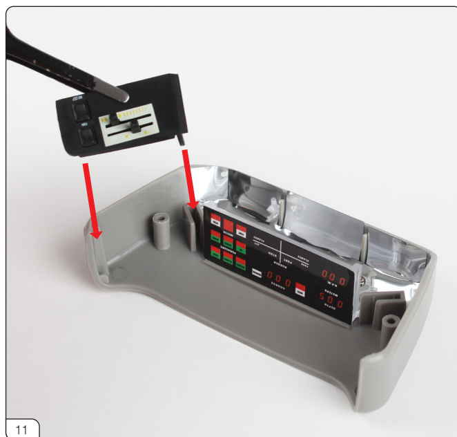
右ディスプレイ(36-D)を、インストルメントパネルトップ (36-A) に押し込みます (赤矢印)。
