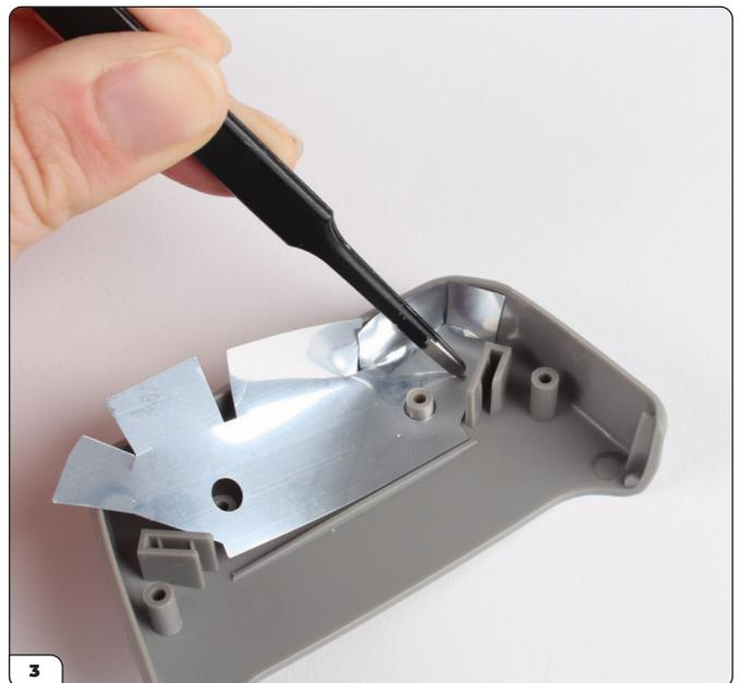
Prenez l'autocollant réfléchissant. Notez qu'il possède des languettes qui correspondent aux parois de la partie supérieure du tableau de bord (36-A) comme le montrent les lignes pointillées.
