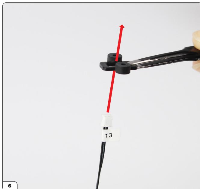
Passez la prise du câble de l'interrupteur d'alimentation n° 13 (42-F) à travers le support (42-E). Assurez-vous que le support soit orienté comme indiqué.
