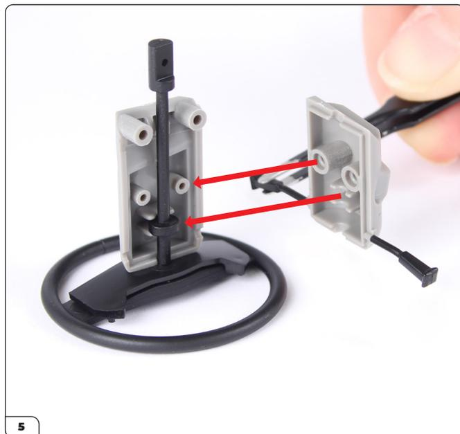
Placez la partie inférieure du cache de la colonne de direction (38-D) sur la partie supérieure.
