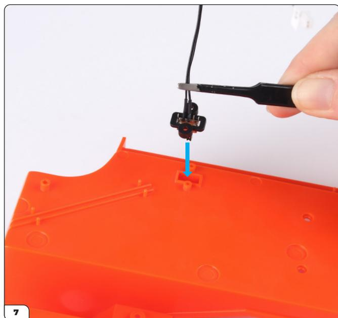
Faites glisser le support le long du câble jusqu'à l'interrupteur puis enfoncez l'interrupteur dans l'ouverture rectangulaire en dessous du plancher du cockpit.
