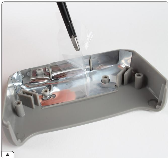
Une fois l'autocollant réfléchissant en place, retirez le film protecteur du côté argenté comme le montre l'image.
