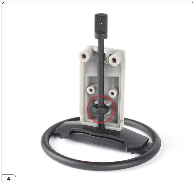
Placez la partie supérieure du cache de la colonne de direction (38-E) sur la colonne, en positionnant l'anneau dans le support (cercle).
