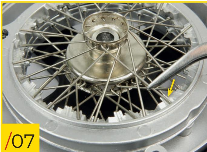
33/07 Coloca el extremo recto del radio en la muesca correspondiente en el nivel superior de la carcasa. Repite estos pasos para los otros once radios tipo C, hasta que todos los agujeros en la fila superior del cubo estén llenos.
