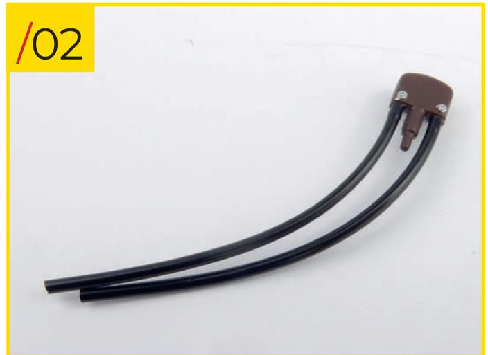
37/02 Recupera el segundo conector de la tapa del distribuidor que recibiste con la etapa 19. Desliza dos cables largos (etapa 36) en los dos pernos laterales del conector.
