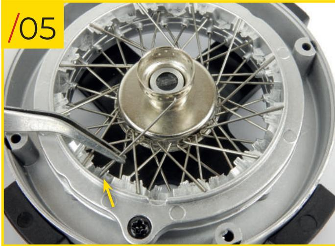
33/05 Usa la foto para ayudarte a colocar el extremo recto del radio en la muesca en el nivel inferior de la carcasa. Repite estos pasos para los otros once radios tipo C, hasta que todos los agujeros en la fila inferior del cubo estén llenos.
