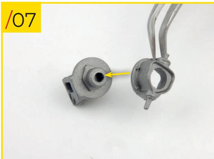
39/07 Coloca la sección central de la bomba de combustible en la sección inferior, orientando las piezas como se muestra.
