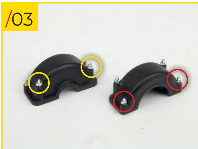
38/03 Mira cuidadosamente la foto para que las piezas estén orientadas correctamente para el paso 4: los tornillos frontales (indicados por los círculos amarillos) están más altos que los tornillos traseros (indicados por los círculos rojos).
