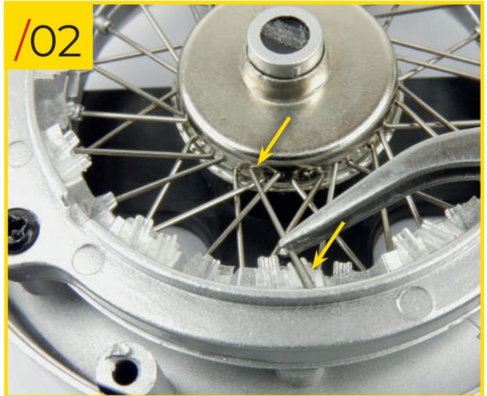
33/02 Inserta el extremo con gancho de los radios tipo A que recibiste con esta etapa en los agujeros restantes en el cubo tipo A. Usa la foto para ayudarte a orientar correctamente los radios. Coloca su extremo recto en la muesca correspondiente en el nivel superior de la carcasa.
