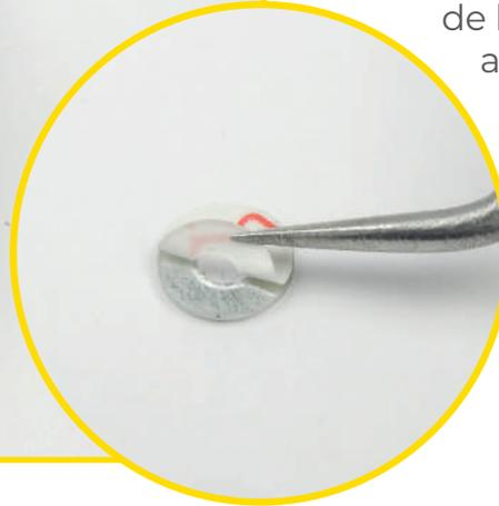
34/02 Con el lado de la arandela que tenía la película quitada hacia abajo, insértala en el cubo tipo C, como se muestra en la foto.
