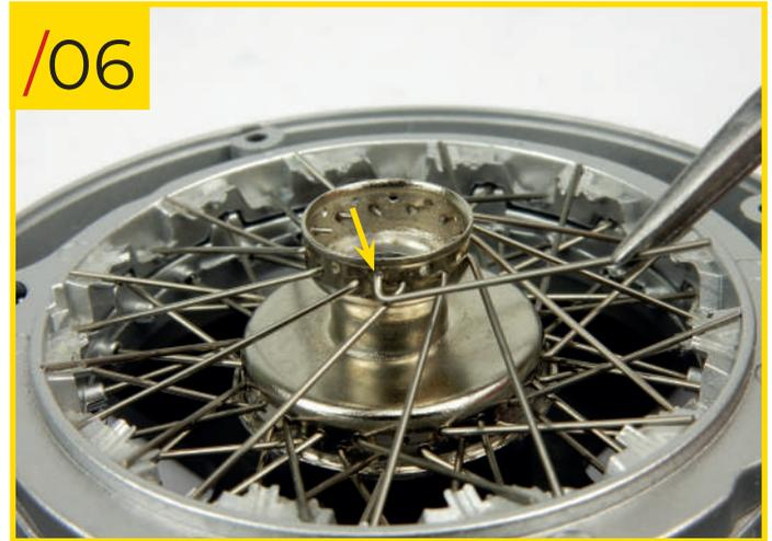
33/06 Ahora inserta el extremo con gancho de un radio tipo C en uno de los agujeros en la fila superior del cubo tipo C.
