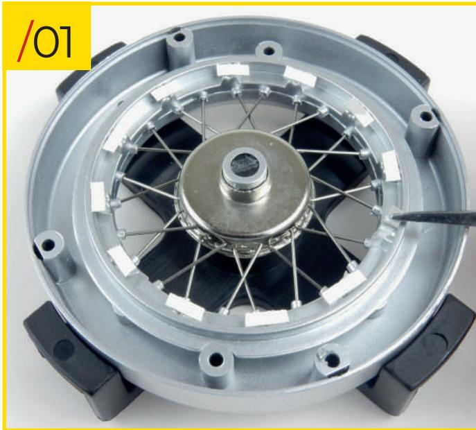
32/01 Coloca la rueda delantera derecha que ensamblaste en la etapa 31 sobre tu superficie de trabajo. Antes de proceder, te recomendamos que pegues pequeñas tiras de cinta adhesiva de doble cara en el borde lateral del anillo retenedor de radios 1. Como alternativa, puedes colocar todos los radios en posición y luego aplicar un punto de pegamento en cada uno después de la etapa 32/03.
