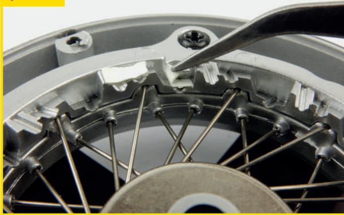
33/01 Coloca la rueda delantera derecha que ensamblaste en las etapas anteriores sobre tu superficie de trabajo. Antes de proceder con el ensamblaje, te recomendamos que pegues pequeñas tiras de cinta adhesiva de doble cara en el borde lateral de la carcasa del radio 2.
