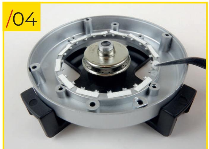
31/04 Antes de añadir los radios, te recomendamos que pegues algunas tiras pequeñas de cinta adhesiva de doble cara en el borde interno de la llanta de la rueda. Esto ayudará a mantener los radios en su lugar durante el montaje. Alternativamente, puedes aplicar una gota de pegamento en cada radio una vez que estén en posición.
