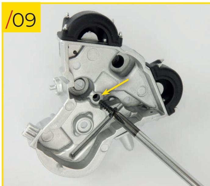
38/09 Gira la caja de la distribución y asegura el soporte del ventilador al resto del ensamblaje con un tornillo tipo B.
