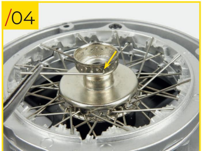
33/04 Inserta el extremo con gancho de un radio tipo C en uno de los agujeros en la fila inferior del cubo tipo C.
