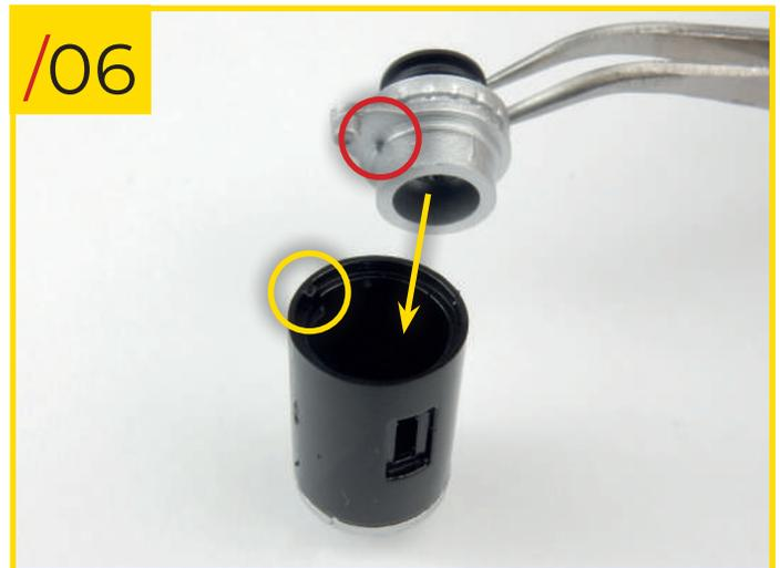
40/07 Ahora ajusta el brazo al cuerpo del dinamo insertando el extremo del brazo, indicado por el círculo rojo en la foto, en el agujero correspondiente en el cuerpo del dinamo, indicado por el círculo amarillo.
