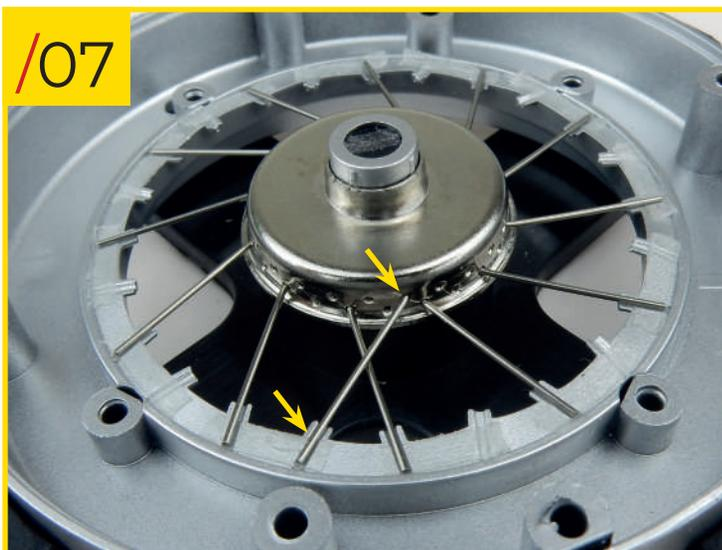
31/07 Ahora instala los radios tipo A (son más largos que los tipo B) insertando su extremo con gancho en la fila superior de agujeros inmediatamente a la izquierda de los radios tipo B, asegurándote de que pasen por encima de los radios insertados en la fila inferior de agujeros. Usa la foto para ayudarte a identificar en qué muesca debes colocar el otro extremo del radio. Siempre deja un agujero vacío entre cada radio.
