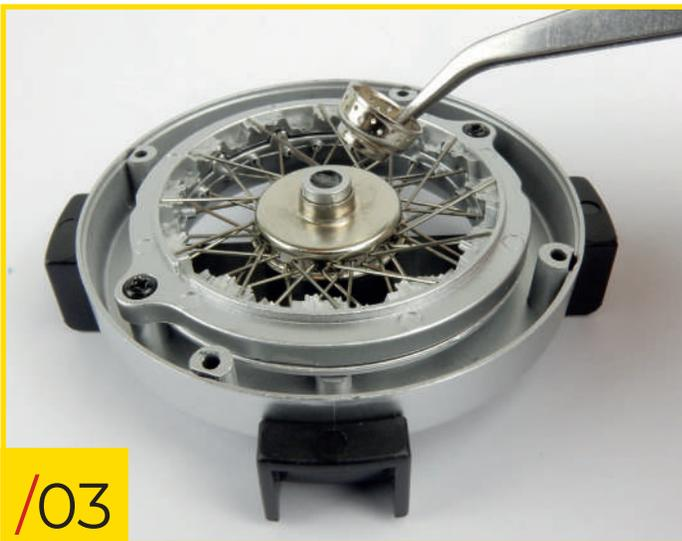
33/03 Una vez que se hayan agregado todos los radios tipo A, coloca el cubo tipo C que recibiste en la etapa 31 como se muestra en la foto.
