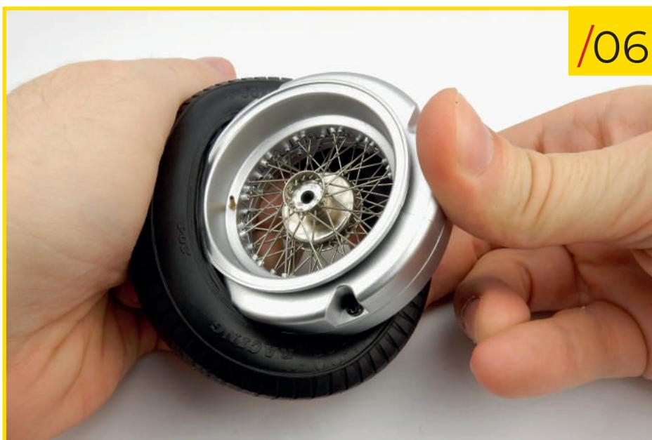
34/06 Desliza el neumático sobre el borde de la rueda delantera derecha.
