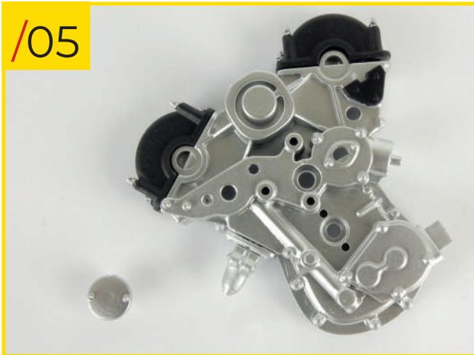
38/05 Coloca el disco de cobertura derecho en tu superficie de trabajo. Asegúrate de no confundirlo con el disco izquierdo: las superficies de los dos discos son diferentes.
