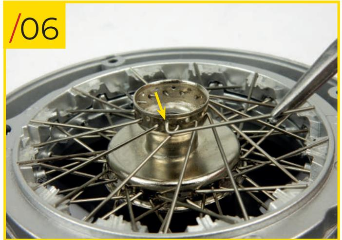
33/06 Insérez maintenant l'extrémité crochue d'un rayon de type C dans l'un des trous de la rangée supérieure sur le moyeu de type C.
