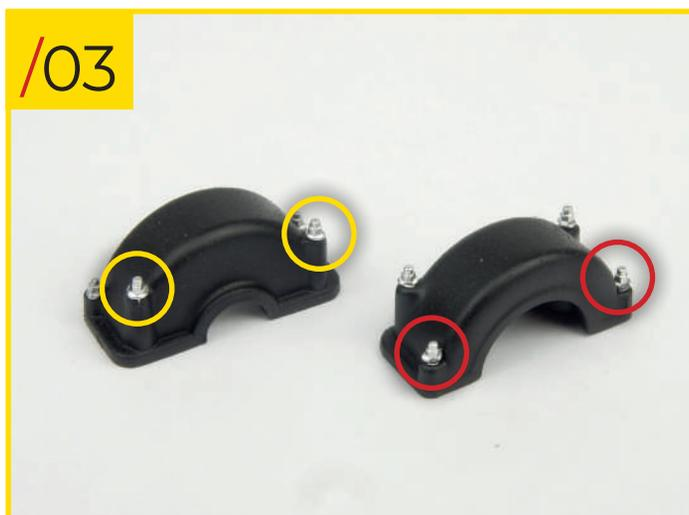
38/03 Regardez bien la photo pour mettre les pièces dans le bon sens lors de la phase suivante (4) : les boulons situés à l'avant (cf. cercles jaunes) sont plus élevés que ceux situés à l'arrière (cf. cercles rouges).
