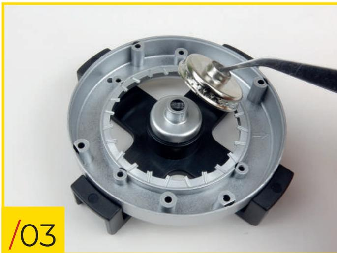
31/03 Posez le moyeu de type B sur l'ergot central du gabarit. Une fois en place, mettez le moyeu de type A par-dessus, comme le montre la photo.
