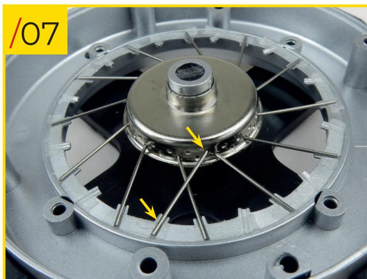
31/07 Maintenant mettez les rayons de type A (qui sont plus longs que ceux de type B) en insérant leur extrémité crochue dans les trous de la rangée supérieure directement à gauche des rayons de type B en veillant à ce qu'ils passent par-dessus les rayons insérés dans les trous de la rangée inférieure. Regardez la photo pour repérer l'encoche sur laquelle vous devez positionner l'autre extrémité du rayon. Laissez toujours un espace entre chaque rayon dans le moyeu.
