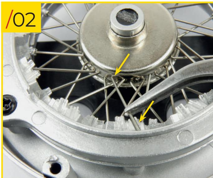
33/02 Insérez chaque extrémité crochue des rayons de type A dans les trous restants du moyeu de type A. Servez-vous de la photo pour l'orientation correcte des rayons et pour vérifier que les autres extrémités soient bien dans les encoches correspondantes au niveau supérieur de l'anneau de fixation.
