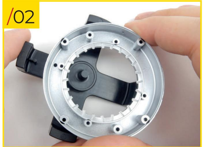
31/02 Insérez l'ergot dans le trou pour fixer la jante sur le gabarit. Avant de procéder à l'assemblage, nous vous recommandons de coller un petit morceau de scotch double face sur l'ergot central du gabarit. Cela aidera à maintenir les moyeux en place. Sinon, vous pouvez placer tous les rayons puis déposer une goutte de colle sur chacun des rayons après l'étape 31/08.
