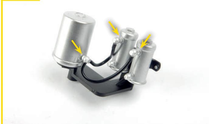
35/06 Attachez les deux filtres sur le support de la pompe et insérez les raccords dans les trous des composants, comme indiqué sur la photo.
