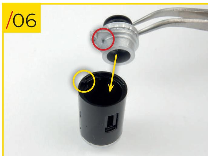
40/07 Enfoncez la fixation dans le boîtier de la dynamo en mettant l'extrémité entourée d'un cercle rouge dans la fente entourée d'un cercle jaune (cf. photo).
