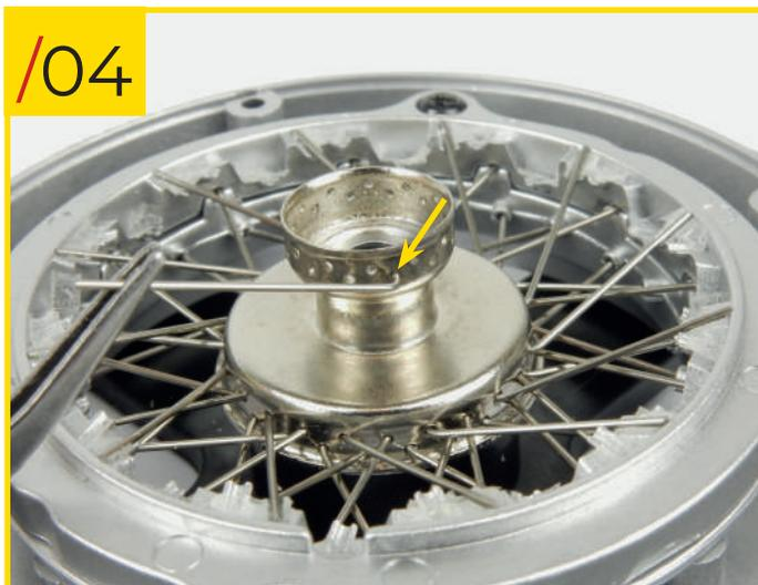
33/04 Insérez l'extrémité crochue de l'un des rayons de type C dans l'un des trous de la rangée inférieure sur le moyeu de type C.
