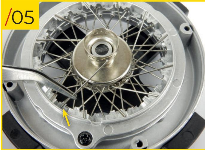
33/05 Servez-vous de la photo pour mettre l'autre extrémité du rayon dans l'encoche sur la rangée inférieure. Faites la même chose pour les onze autres rayons de type C jusqu'à ce que tous les trous de la rangée inférieure soient comblés.
