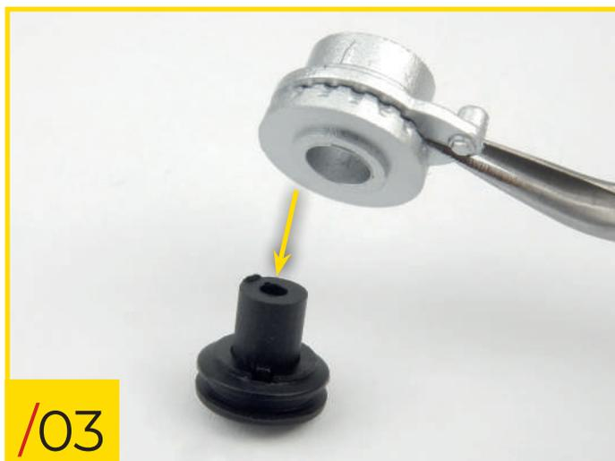
40/03 Enfoncez la poulie dans le trou du support pour assembler les pièces.
