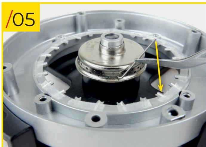
31/05 Mettez les rayons de type B (qui sont plus courts que ceux de type A) en insérant leur extrémité crochue dans les trous de la rangée inférieure du moyeu de type A. Mettez l'autre l'extrémité des rayons dans l'encoche correspondante du bord de la jante (sur le scotch double face). Laissez toujours un espace entre chaque rayon sur le moyeu.
