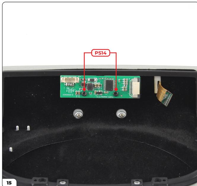
Mettez le circuit imprimé en place et vissez-le à l'aide de deux vis PS14.
