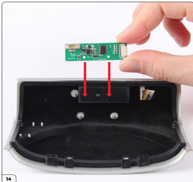
Faites correspondre les trous du circuit imprimé avec ceux du support comme indiqué par les flèches.
