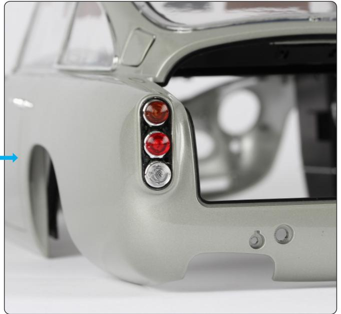
Enfoncez l'ergot du logement pour les feux arrière dans le trou (indiqué par une flèche) en vérifiant que le feu de clignotant soit en haut. Si le câble du feu de freinage fait sortir la lentille, appliquez, si besoin est, un peu de colle transparente pour maintenir la lentille en place.
