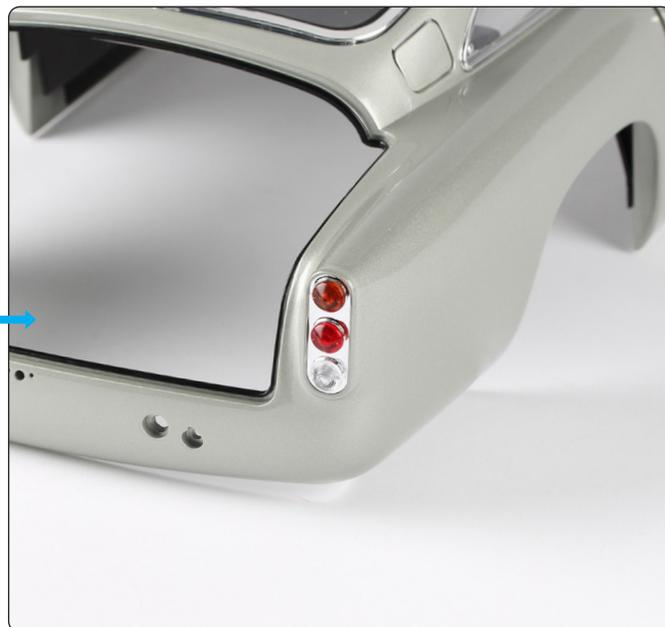
Enfoncez l'ergot du logement pour les feux arrière dans le trou (indiqué par une flèche) en vérifiant que le feu de clignotant soit en haut. Si le câble du feu de freinage fait sortir la lentille, appliquez, si besoin est, un peu de colle transparente pour maintenir la lentille en place.
