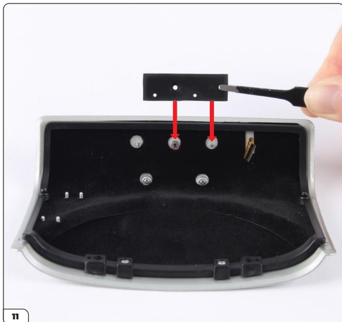
Alignez le support du circuit imprimé (92-D) et enfoncez-le comme indiqué par les flèches.
