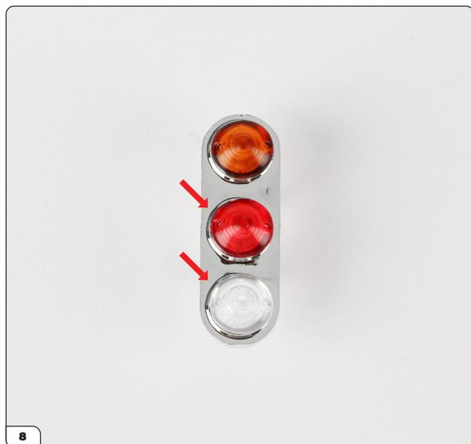
Premi la luce di stop rossa (86-E) nel foro centrale e la luce di retromarcia trasparente (86-D) nel foro inferiore.
