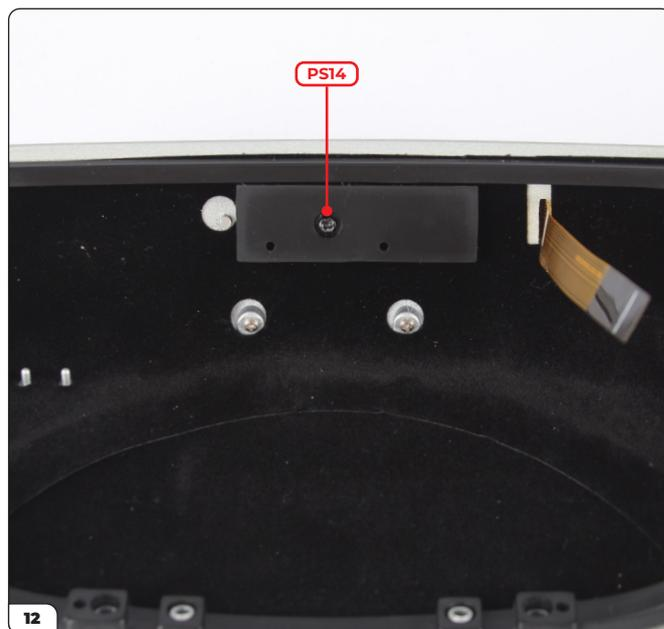
Fissa il supporto della scheda elettronica e la targa con una vite PS14.
