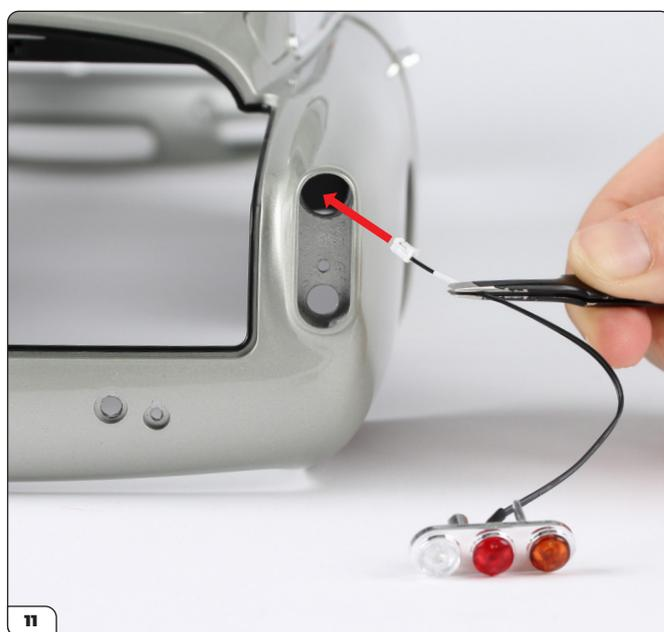
Fai passare la spina attraverso il foro superiore nella cavità posteriore destra sul corpo principale.
