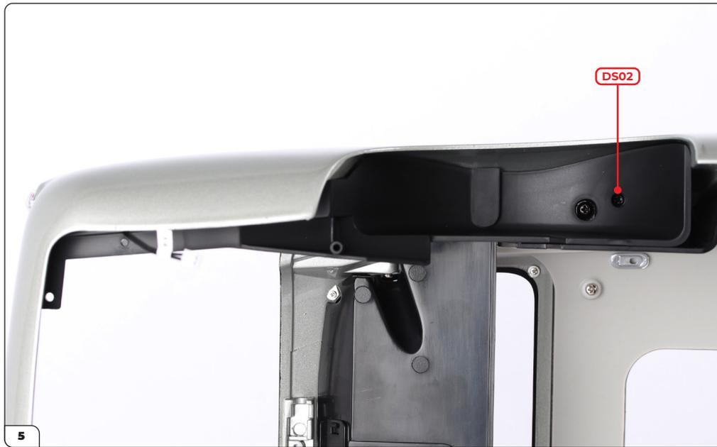
Fissare il passaruota posteriore con una vite DS02.
