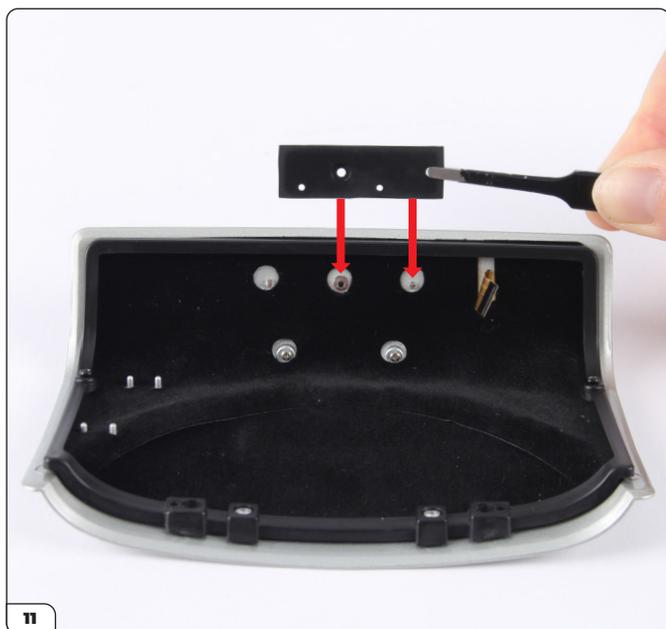
Allinea il supporto della scheda elettronica (92-D) con l'interno del coperchio del bagagliaio. Premilo sul montante della vite e sul perno come mostrato dalle frecce.
