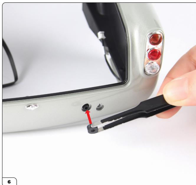
Prendi uno dei tappi del telaio posteriore (89-D). Inserisci il tappo sul montante della vite sporgente.
