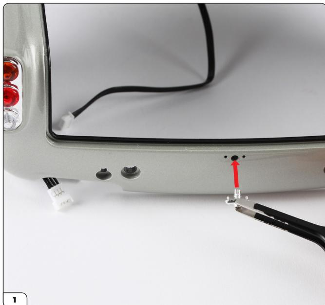
Posiziona l'assemblaggio del corpo principale sulla tua superficie di lavoro. Premi la serratura del bagagliaio (89-G) nei tre fori. La serratura può essere messa solo in una posizione.
