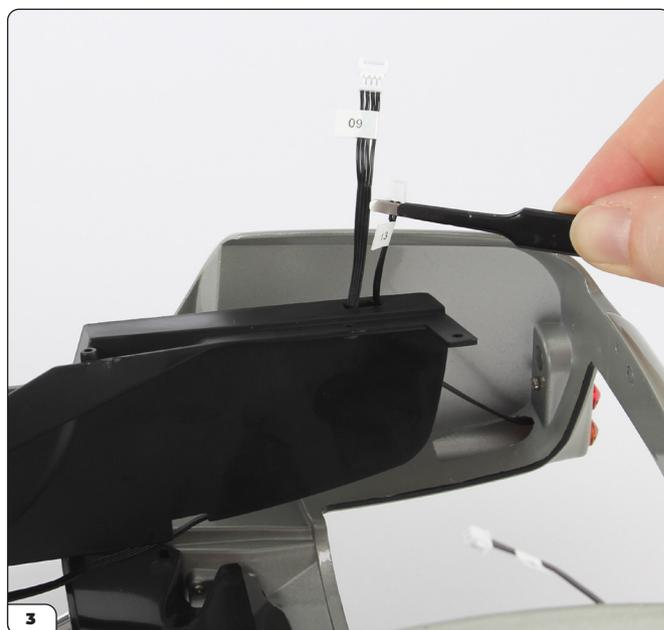
Posiziona il corpo principale capovolto sulla tua superficie di lavoro. Fai passare la spina del filo (N. 13) attraverso il foro rettangolare nel passaruota come mostrato.
