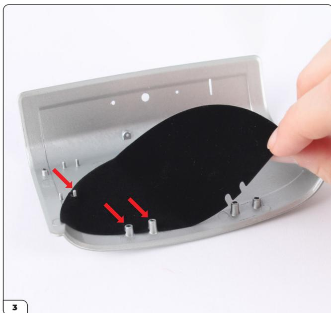
Inizia a premere la moquette sul coperchio del bagagliaio, assicurandoti di adattare i fori della moquette attorno ai perni e ai montanti delle viti (frecce).
