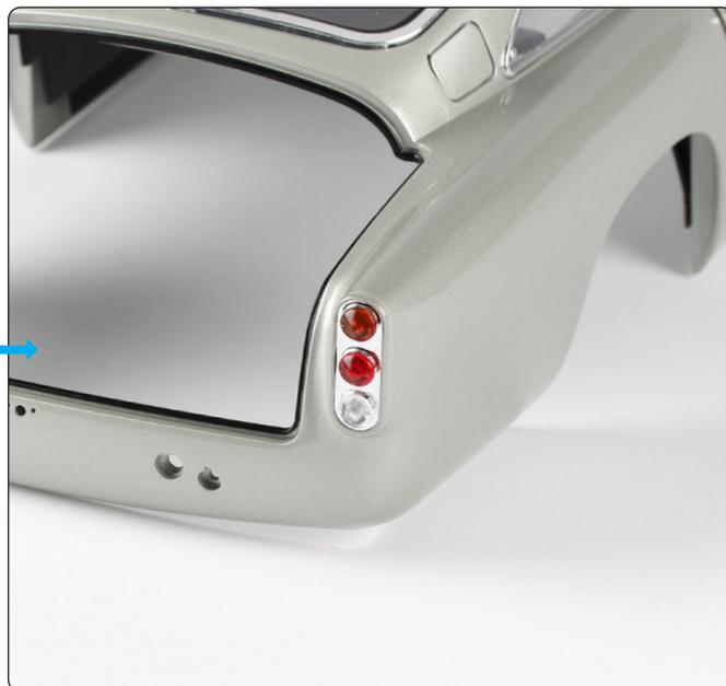
Inserisci la finitura del fanale posteriore nella cavità, orientandola con l'indicatore arancione in alto. Se il filo spinge fuori la luce di stop durante l'installazione, prova a usare della colla trasparente per tenere la luce di stop in posizione.
