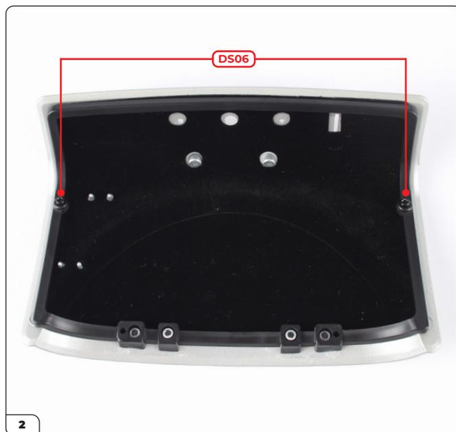
Inserisci il telaio del coperchio del bagagliaio e poi fissalo con 2 viti DS06.
