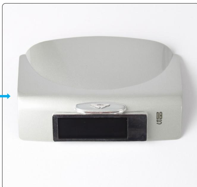
Allinea la targa posteriore con il coperchio del bagagliaio e premila in posizione, passando il cavo piatto allo stesso tempo. Assicurati che i perni e il montante della vite siano completamente inseriti nei fori per il prossimo passo.
