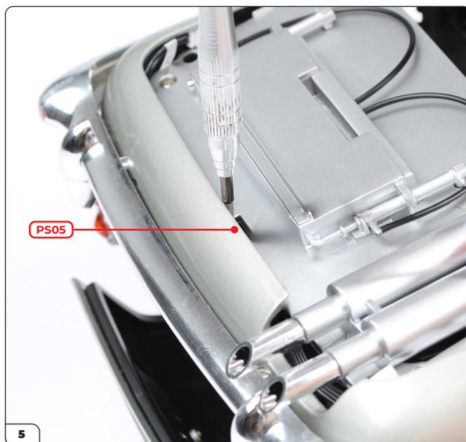
Vissez une vis PS05 à l'arrière du châssis.
