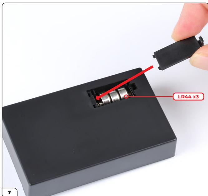
Insérez 3 piles LR44 dans le compartiment à piles de la télécommande et couvrez avec le cache-piles (99-B).
