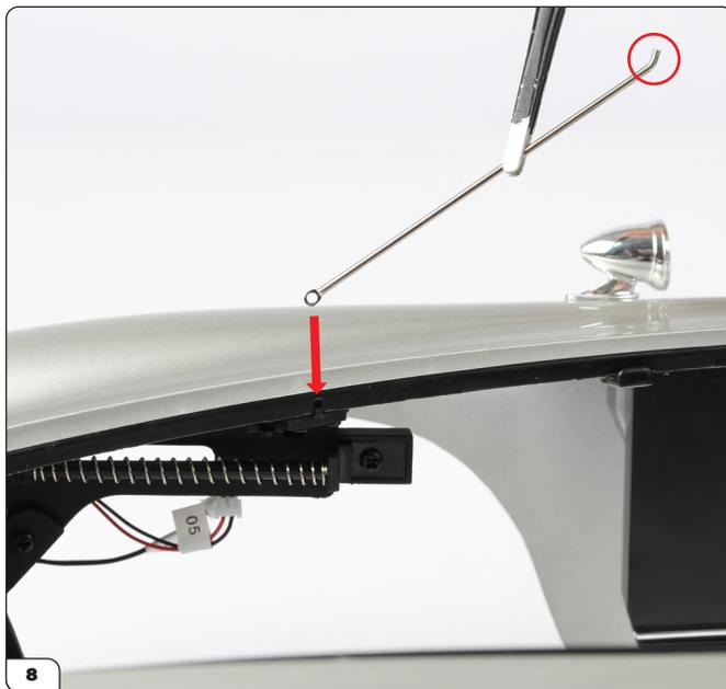
Alignez l'une des tiges de maintien de capot (99-A) avec le trou correspondant (flèche). Assurez-vous que l'extrémité encerclée soit orientée vers le haut.
