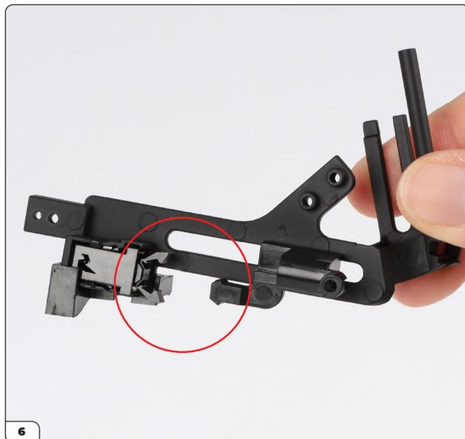
6 L'arrêt de la mitrailleuse devrait s'enfoncer dans l'attache lorsque vous le faites glisser.
