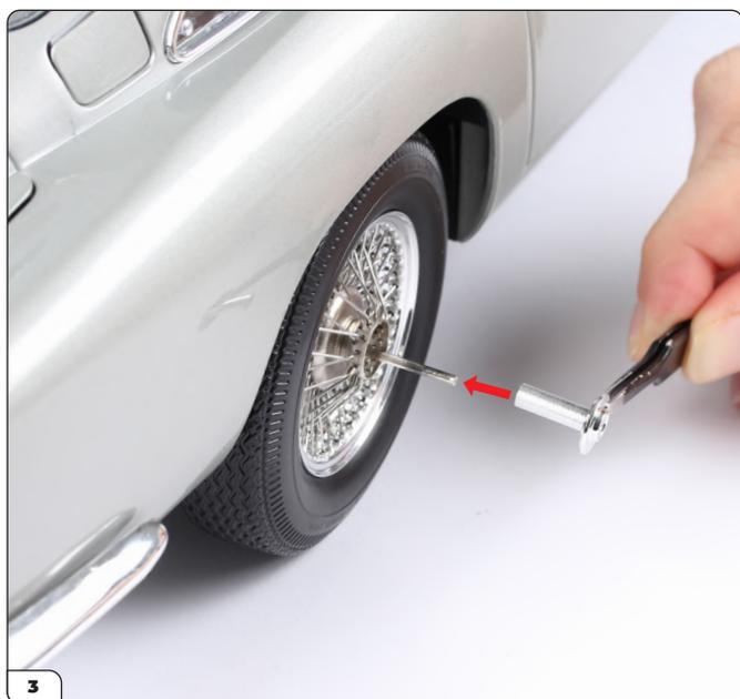
Enfoncez l'un des enjoliveurs arrière « slim-line » (100-B) sur le moyeu.
