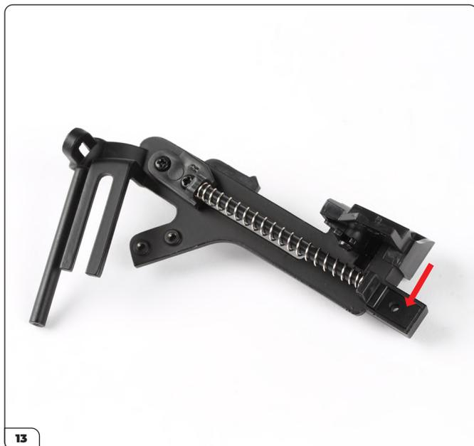
Mettez l'autre extrémité de l'axe dans le renforcement (cf. flèche).
