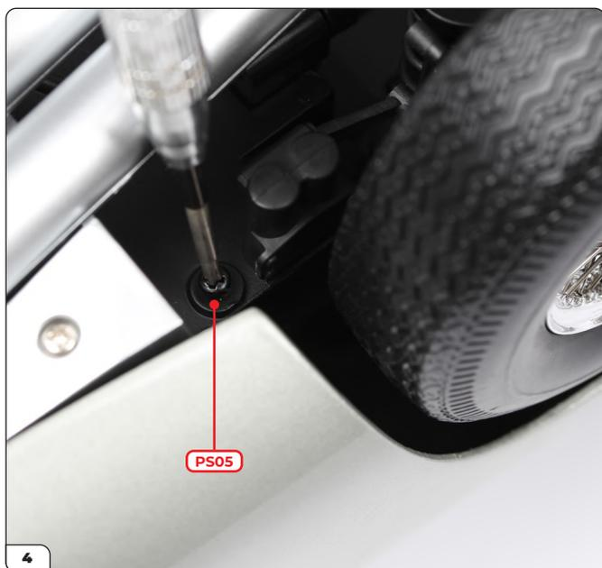
Vissez une vis PS05 dans le trou derrière la roue arrière.
