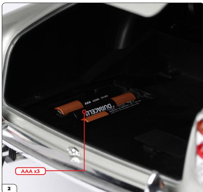
Remettez prudemment le modèle à l'endroit sur votre surface de travail. Ouvrez le coffre et insérez 3 piles AAA dans le compartiment.
