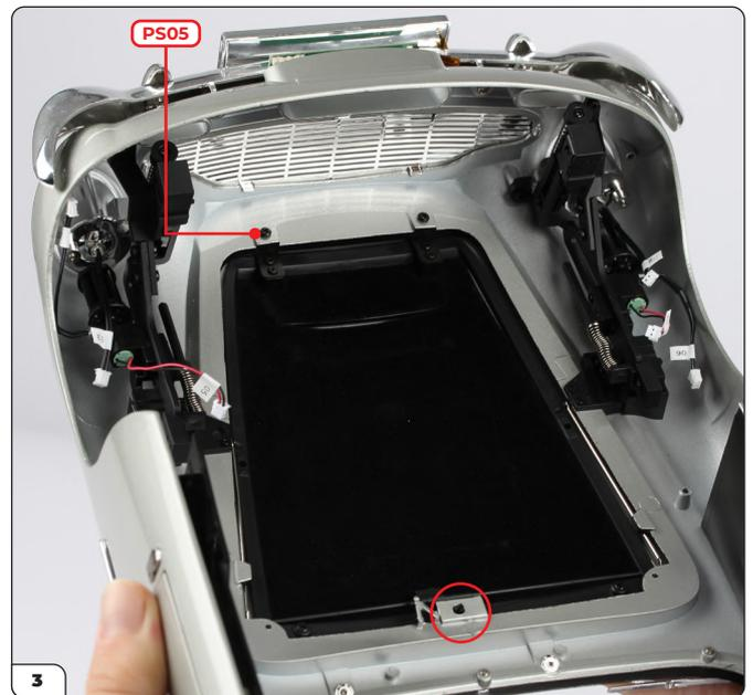
Fermez le capot en veillant à ce que le doigt de fermeture du capot passe par le trou (encerclé). Vissez une vis PS05 à moitié dans l'autre charnière. Serrez fermement les deux vis une fois que vous êtes satisfait du positionnement du capot.
