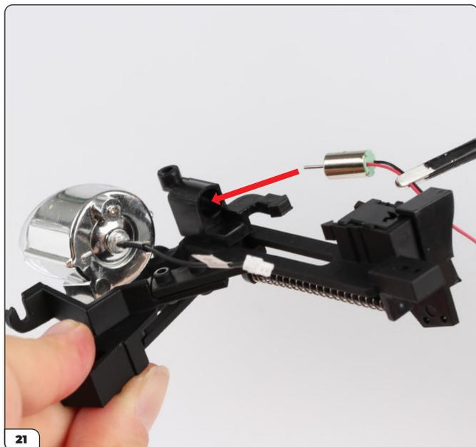
Enfoncez le moteur (98-L) dans l'arrêtoir de la mitrailleuse.
