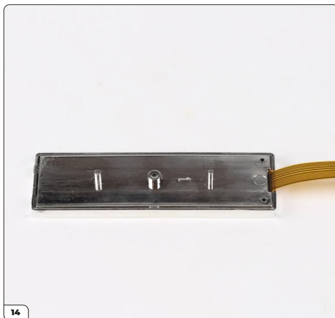
Mettez le couvercle en place. Il se peut que vous deviez ajuster légèrement la position de l'écran afin de faciliter l'emboîtement des pièces.
