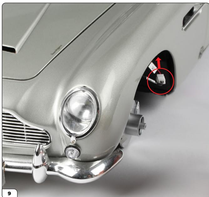
Rangez les câbles à l'avant du modèle dans les passages de roues.
