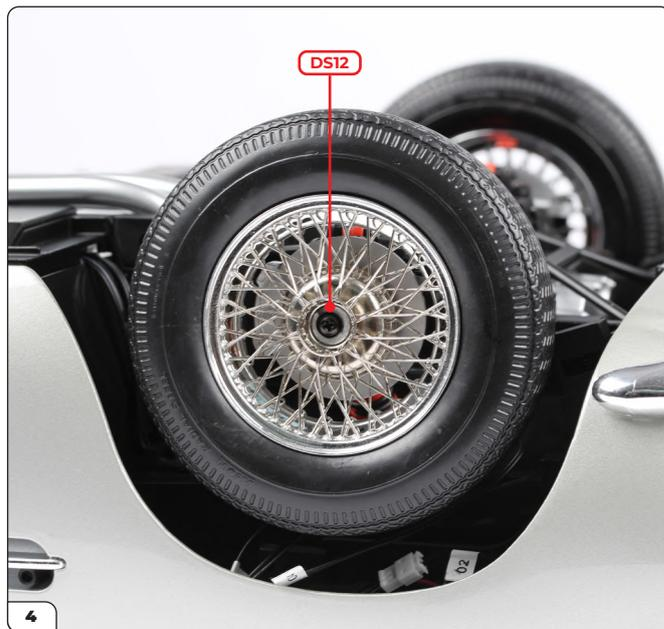
Enfoncez l'autre roue (étape 029) sur le moyeu avant gauche et vissez une vis DS12.
