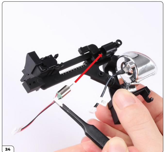
Enfoncez le moteur (96-L) dans l'arrêtoir de la mitrailleuse.
