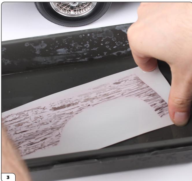
Placez la décalcomanie de la section arrière dans l'eau pendant 30 secondes. Maintenez-la à plat.
