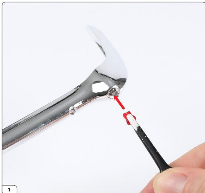
Enfoncez l'un des réflecteurs (93-D) dans l'emplacement sur le pare-chocs arrière (93-A). Il ne se met que dans un seul sens.
