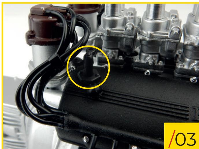
44/03 Prenez le bloc moteur. Enfoncez la base dans le trou hexagonal de la culasse droite. Les deux branches devraient être tournés vers l'arrière et le milieu du moteur.
