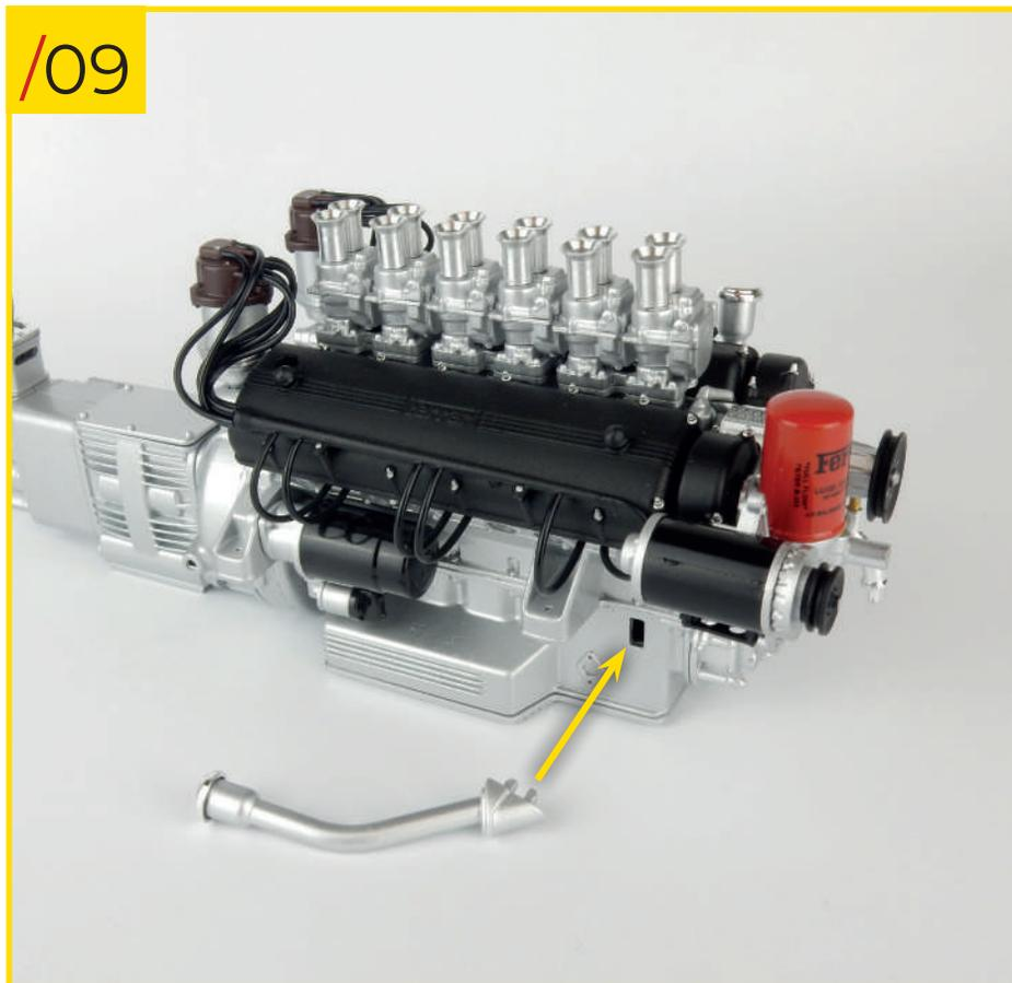
43/09 Enfoncez le deuxième tuyau de remplissage d'huile dans le trou situé sur le côté droit du bloc moteur.
