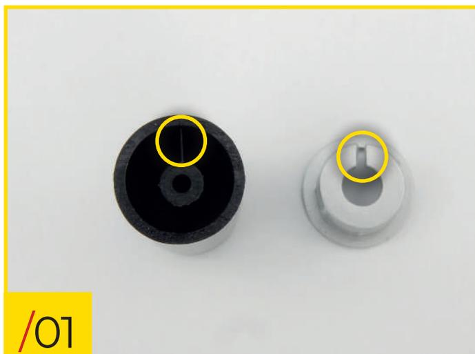
42/01 Mettez le joint par-dessus le boîtier du démarreur. Il n'y a qu'une seule façon de le mettre.
