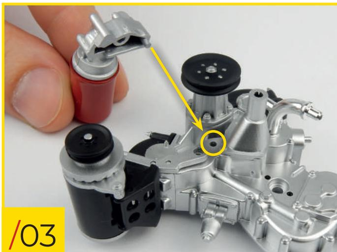
41/03 Ajoutez maintenant le filtre à huile en insérant l'ergot du socle dans le trou indiqué sur la photo.
