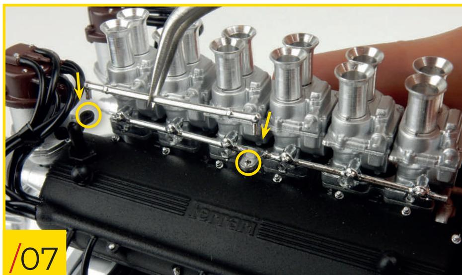
44/07 Placez le tuyau de raccordement comme indiqué en enfonçant les ergots dans les trous de la conduite d'alimentation A et dans la fixation de la culasse droite (entourés sur la photo).
