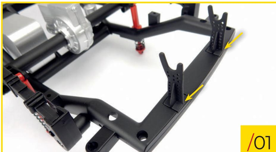
46/01 Prenez le châssis de votre modèle et placez les deux fixations pour le châssis dans le sens indiqué sur la photo.
