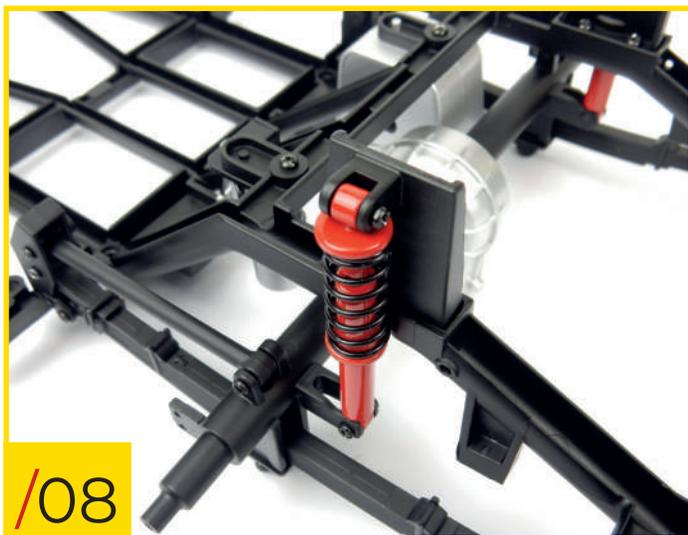
46/08 Répétez les étapes 06 et 07 pour mettre l'amortisseur gauche (marqué de la lettre "L") sur le côté gauche du châssis et vissez-le.
