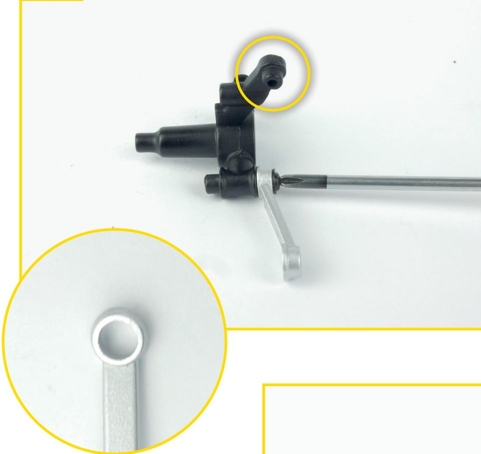
55/01 Befestigen Sie einen der oberen Querlenker am Achsschenkel und richten Sie die Teile wie gezeigt aus. Verwenden Sie den im Foto hervorgehobenen Stift als Referenz. Die Löcher an den Enden der Querlenker sind nicht identisch: Für diesen Schritt verwenden Sie das Ende mit dem größeren Loch (im runden Foto gezeigt). Befestigen Sie die Teile mit einer Typ-J-Schraube.
