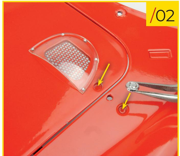
53/02 Arbeiten Sie an der linken Seite des vorderen Teils der Karosserie und setzen Sie die beiden Fanghaken in ihre Schlitze an der Karosserie und der Motorhaube ein, indem Sie die Teile wie gezeigt ausrichten.
