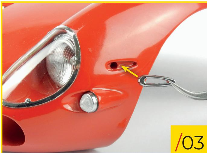
49/03 Befestigen Sie das Blinkergehäuse in der gezeigten Position, wie im Foto dargestellt...
