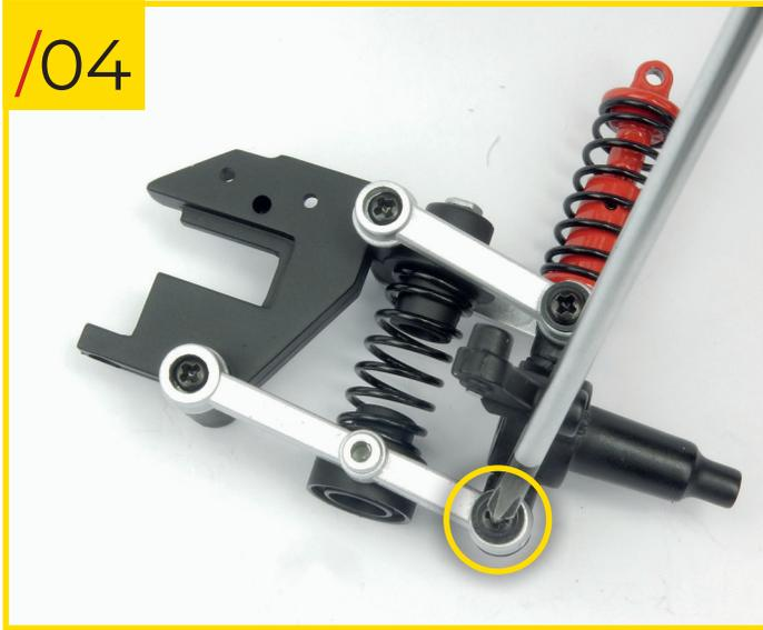
56/04 Befestigen Sie den Querlenker mit einer Typ-J-Schraube am Achsschenkel.
