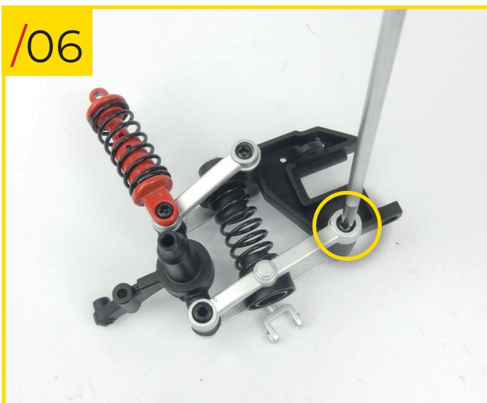
56/06 Arbeiten Sie auf der anderen Seite der Baugruppe und befestigen Sie den unteren Querlenker B (den ohne mittleres Loch). Stellen Sie sicher, dass das längere Ende des Querlenkers zur Befestigung und das kürzere Ende zum Achsschenkel zeigt, und setzen Sie dann den Stift in der Mitte des Querlenkers in das andere seitliche Loch der Federstütze ein. Schrauben Sie eine Typ-B-Schraube in das im Foto durch einen Kreis markierte Loch.
