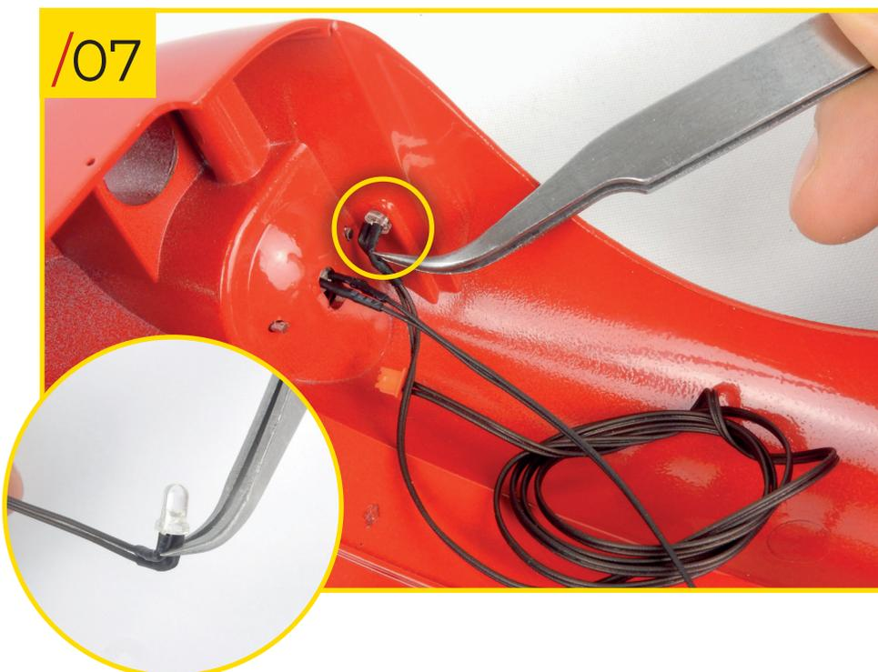
49/07 Arbeiten Sie von der Innenseite der Karosserie aus und stellen Sie sicher, dass die Kabelsätze zur richtigen Seite passen. Führen Sie die LED-Leuchten in die Löcher ein. Verwenden Sie eine Pinzette, um sicherzustellen, dass Sie die Komponenten nicht beschädigen, und biegen Sie die Leuchten wie im runden Foto gezeigt. Verwenden Sie keinen Kleber für die Leuchten und zwingen Sie sie nicht in die Löcher.
