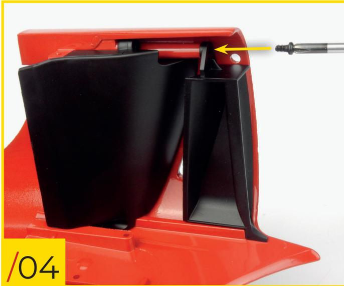
52/04 Befestigen Sie den linken Sekundärkanal an der Karosserie und sichern Sie die Teile mit einer weiteren Typ-C-Schraube.
