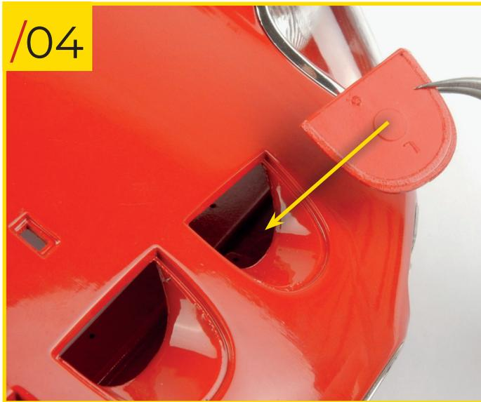
51/04 Entfernen Sie nun die Schutzfolie von der unteren Abdeckung mit einem „L“ darauf und befestigen Sie sie an der Karosserie, wie gezeigt.
