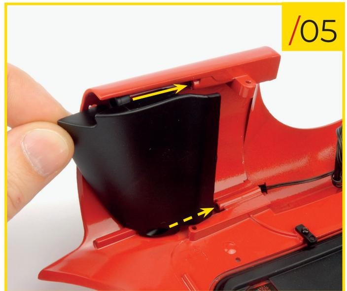
52/05 Befestigen Sie nun den rechten Hauptkanal, indem Sie die Teile wie auf dem Foto gezeigt ausrichten.
