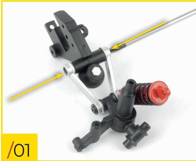
56/01 Legen Sie die Aufhängungseinheit, an der Sie in Phase 55 gearbeitet haben, und die Verbindungsbefestigung auf Ihre Arbeitsfläche. Richten Sie die Teile wie gezeigt aus und befestigen Sie sie, indem Sie zwei Typ-B-Schrauben Typ B in die angegebenen Löcher schrauben.
