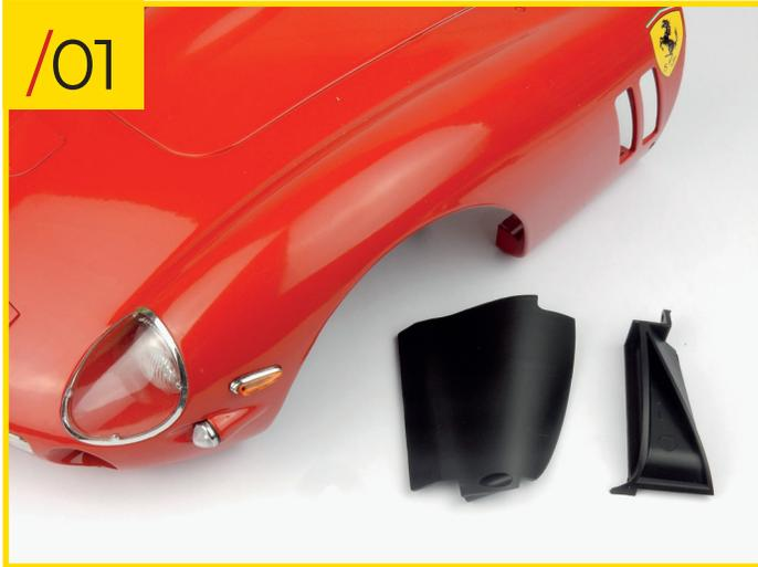
52/01 Legen Sie den vorderen Teil der Karosserie auf eine weiche Unterlage, zusammen mit dem linken Hauptkanal und dem linken Sekundärkanal.
