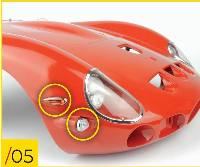
49/05 Wiederholen Sie diese Schritte, um das zweite Seitenlicht und die Komponenten für den rechten Blinker zu montieren, die sich in einem kleinen Beutel mit der Aufschrift „R“ befinden.
