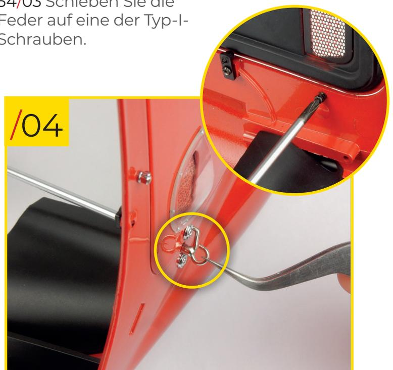
54/04 Setzen Sie den Riegel in das Loch in der Karosserie ein, das sich zwischen den beiden Fanghaken befindet. Um ihn zu befestigen, schrauben Sie die Schraube (mit der Feder) in das entsprechende Loch an der Unterseite der Karosserie. Setzen Sie den Haken des Riegels in den Fanghaken, den Sie an der Motorhaube angebracht haben.
