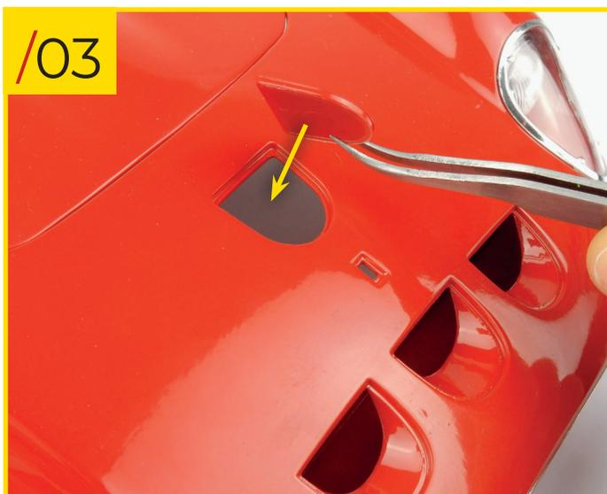
51/03 Befestigen Sie die obere Luftansaugabdeckung an der Vorderseite der Karosserie, wie gezeigt.
