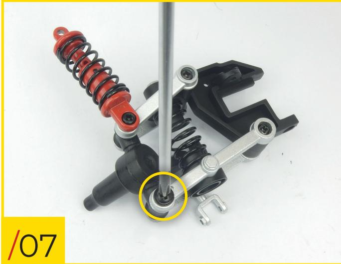
56/07 Schrauben Sie eine Typ-J-Schraube in das angegebene Loch, um den Querlenker am Achsschenkel zu befestigen.
