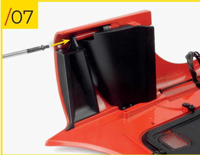
52/07 Befestigen Sie schließlich den rechten Sekundärkanal an der Karosserie und sichern Sie ihn mit einer weiteren Typ-C-Schraube.
