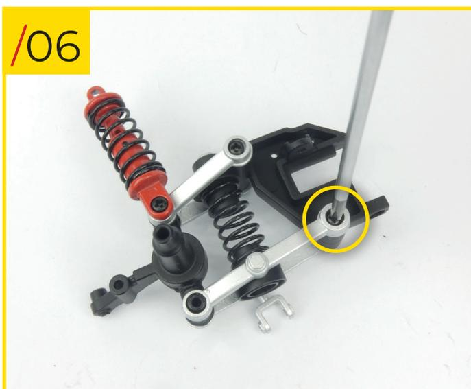
56/06 En travaillant de l'autre côté de l'assemblage, montez le bras inférieur B (celui qui n'a pas de trou central). Veillez à ce que l'extrémité la plus longue du bras soit orientée vers le support et l'extrémité la plus courte vers la fusée d'essieu, puis insérez le goujon central du bras dans l'autre trou latéral du support de ressort. Vissez une vis de type B dans le trou indiqué par un cercle sur la photo.
