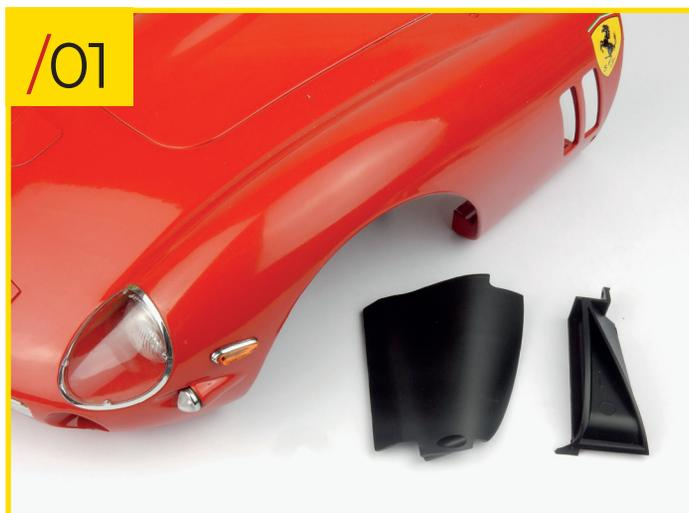
52/01 Placez la partie avant de la carrosserie sur votre plan de travail ainsi que le conduit principal d'air chaud gauche et le conduit secondaire d'air chaud gauche.
