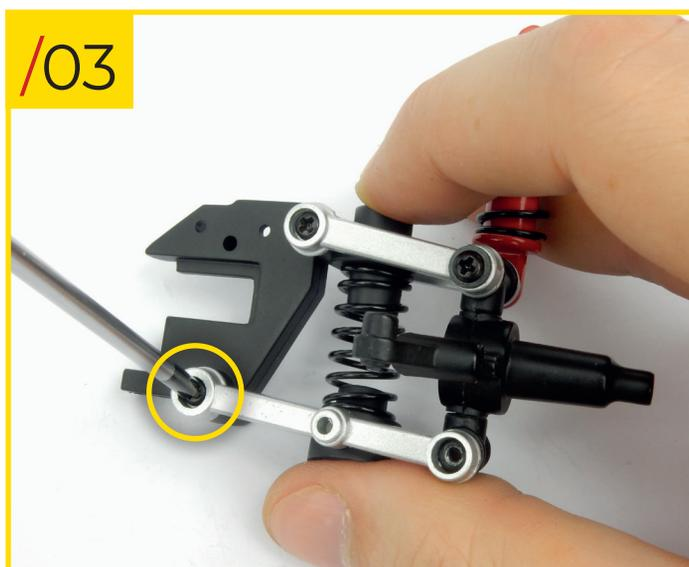
56/03 Reliez le bras inférieur A (qui possède un trou central) au reste de l'assemblage, en orientant les pièces comme indiqué. L'extrémité la plus longue du bras doit être montée sur le support ; l'extrémité la plus courte va sur la fusée d'essieu. Vissez une vis de type B dans le trou indiqué.
