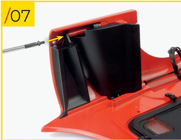
52/07 Enfin, placez le conduit secondaire droit sur la carrosserie et fixez-le à l'aide d'une autre vis de type C.
