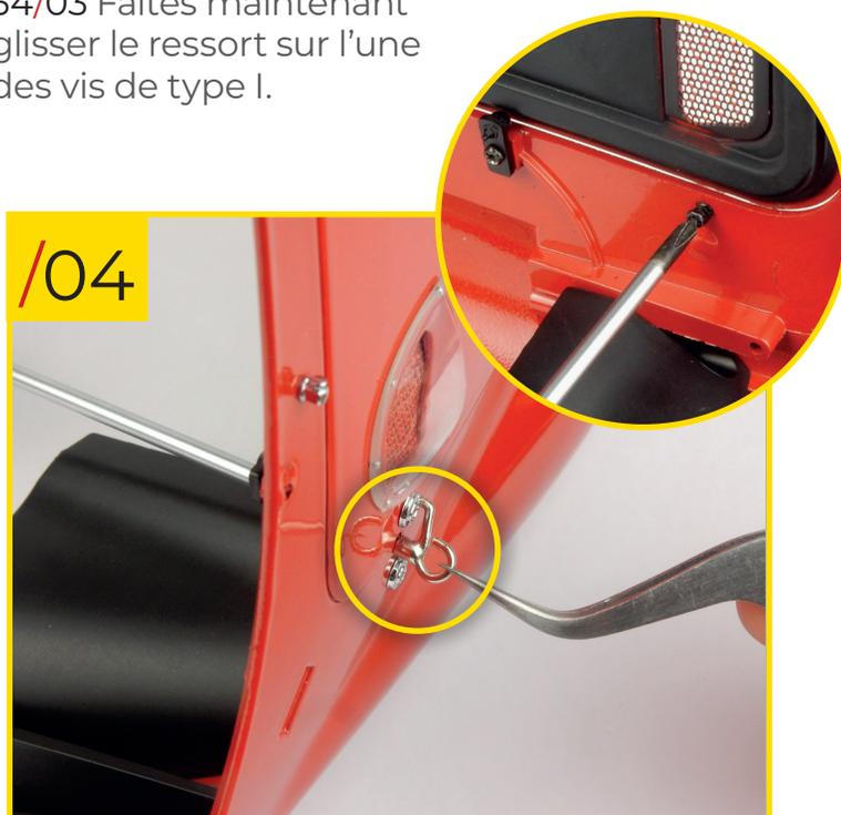
54/04 Insérez le crochet dans le trou qui se trouve entre les deux supports. Pour le maintenir en place, vissez la vis (avec le ressort) dans le trou correspondant. Mettez le crochet sur le support que vous avez placé sur le capot. Ne serrez pas les vis.
