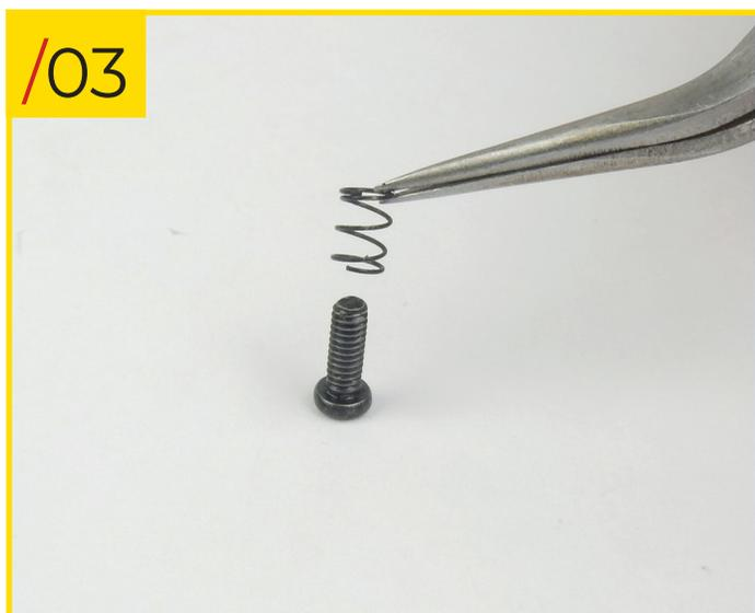
54/03 Faites maintenant glisser le ressort sur l'une des vis de type I.
