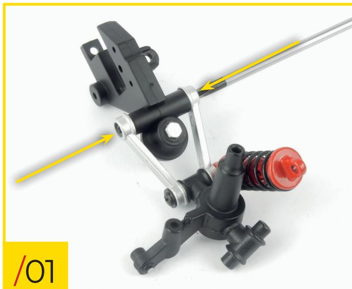
56/01 Placez l'assemblage de suspension sur lequel vous avez travaillé lors de l'étape 55 et la fixation sur votre surface de travail. Orientez les pièces comme indiqué et fixez-les ensemble en vissant deux vis de type B dans les trous indiqués.
