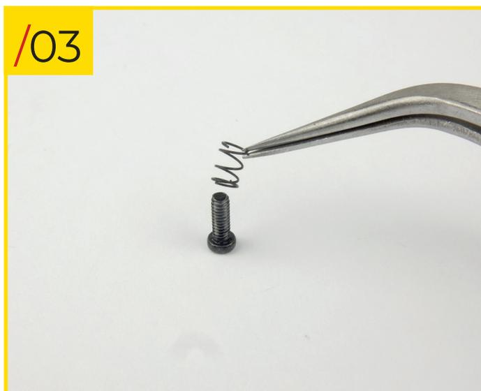
53/03 Faites maintenant glisser le ressort sur l'une des vis de type I.
