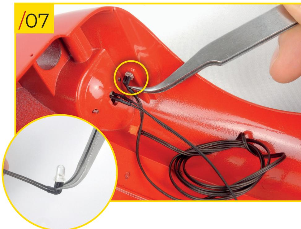
49/07 À partir de l'intérieur de la carrosserie, insérez les LEDs des feux de position dans les trous correspondants. En utilisant une pince pour vous assurer ne pas endommager les composants, pliez les câbles comme sur la photo arrondie. Ne forcez pas. Vous pouvez utiliser une goutte de colle PVA si nécessaire.
