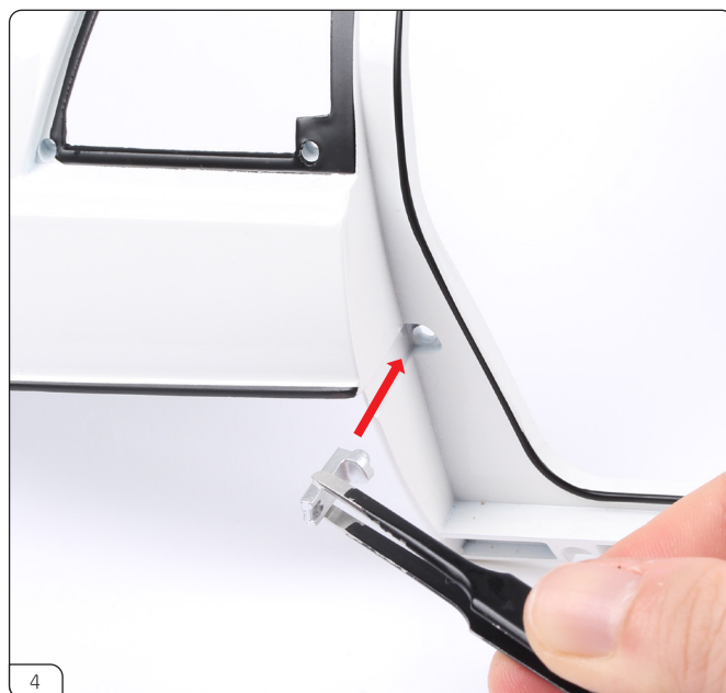
右ドアラッチ (66-C) を右側の窪みに押し込みます。
