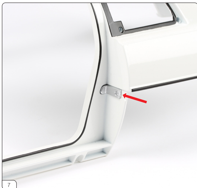
左ドアラッチ (66-B) をボディの左側に押し込みます。
