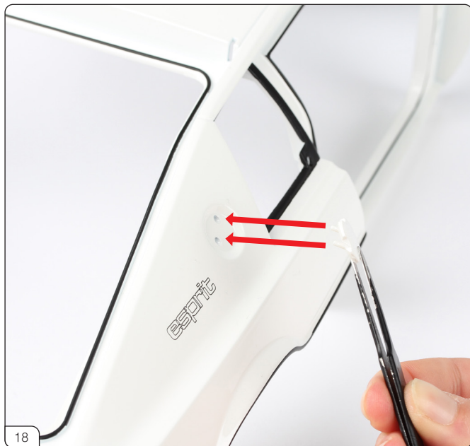
右フューエルキャップ (67-E) を、ステージ066で組み立てたボディの右側凹部に合わせます。
