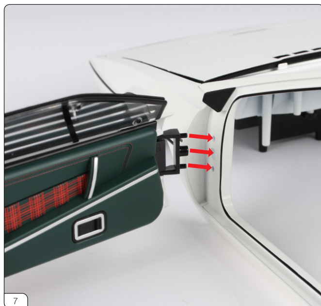
画像のように、左ドアのヒンジポストをボディの穴に合わせます。
